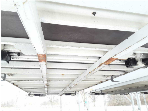
Gebrauchsspur 1: Koffer: Koffer - Korrosion - kein Abzug
