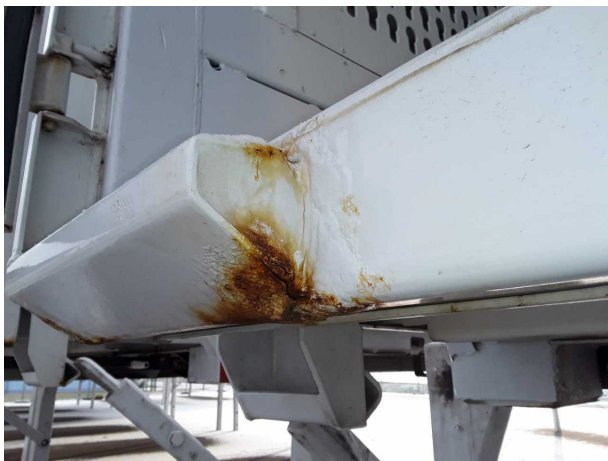
Beschädigung 2: Koffer: Portalrahmen - Korrosion - instandsetzen... und lackieren
