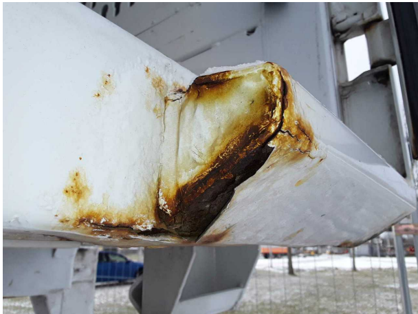
Beschädigung 2: Koffer: Portalrahmen - Korrosion - instandsetzen und lackieren
