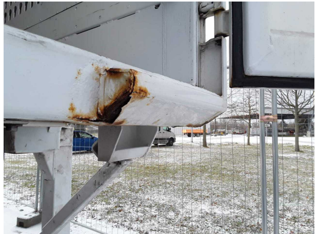
Beschädigung 2: Koffer: Portalrahmen - Korrosion - instandsetzen und lackieren
