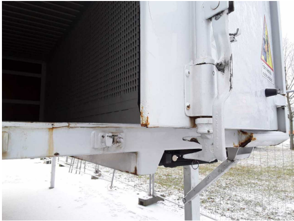
Beschädigung 1: Heckklappe/-tür: Hecktür rechts - Korrosion - instandsetzen und lackieren
