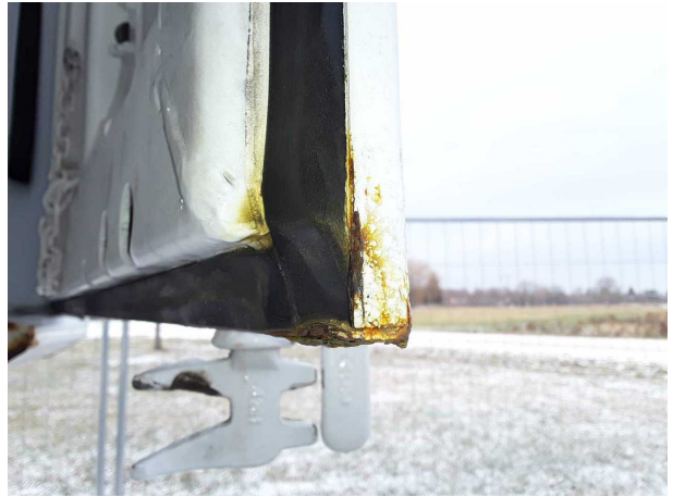
Beschädigung 1: Heckklappe/-tür: Hecktür rechts - Korrosio... instandsetzen und lackieren
