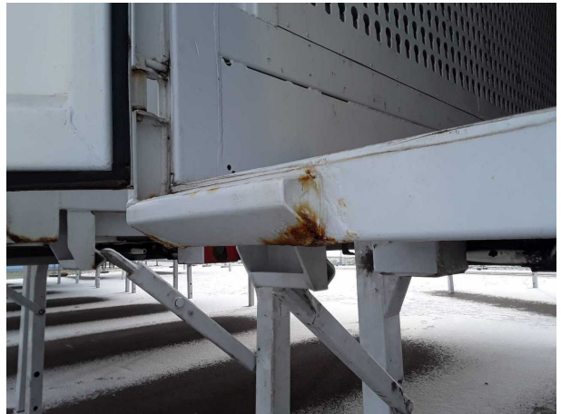
Beschädigung 2: Koffer: Portalrahmen - Korrosion - instandsetzen und lackieren
