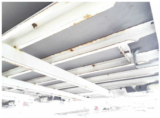
Gebrauchsspur 1: Koffer: Koffer - Korrosion - kein Abzug
