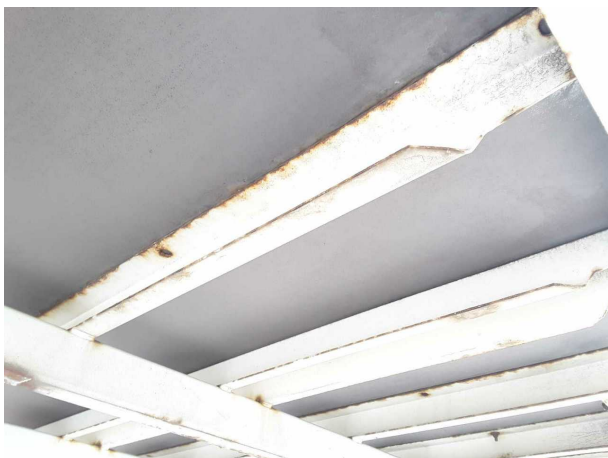
Gebrauchsspur 1: Koffer: Koffer - Korrosion - kein Abzug
