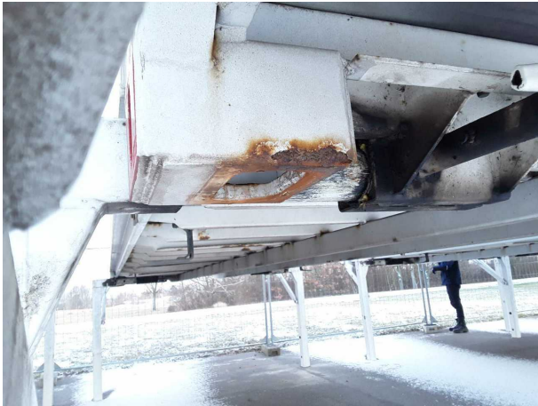
Gebrauchsspur 1: Koffer: Koffer - Korrosion - kein Abzug
