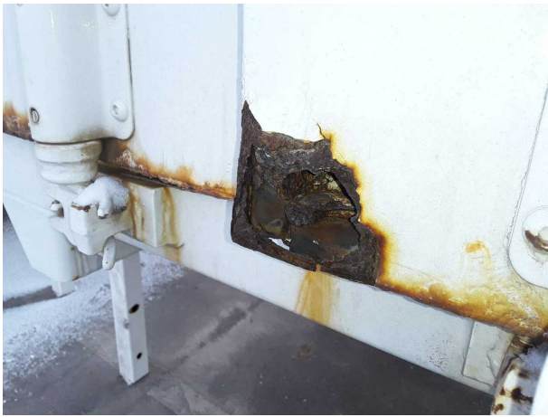
Beschädigung 2: Heckklappe/-tür: Hecktür rechts - Korrosion - instandsetzen und lackieren
