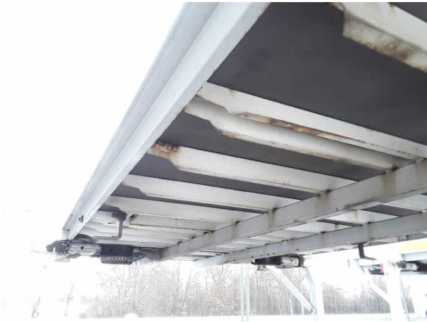
Gebrauchsspur 1: Koffer: Koffer - Korrosion - kein Abzug
