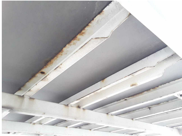
Gebrauchsspur 1: Koffer: Koffer - Korrosion - kein Abzug
