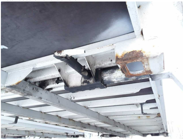
Gebrauchsspur 1: Koffer: Koffer - Korrosion - kein Abzug
