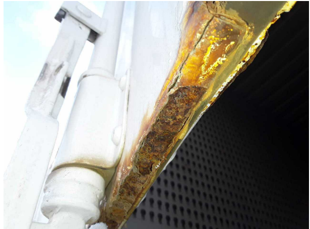
Beschädigung 1: Heckklappe/-tür: Hecktür links (Starke) - Korrosion - instandsetzen und lackieren
