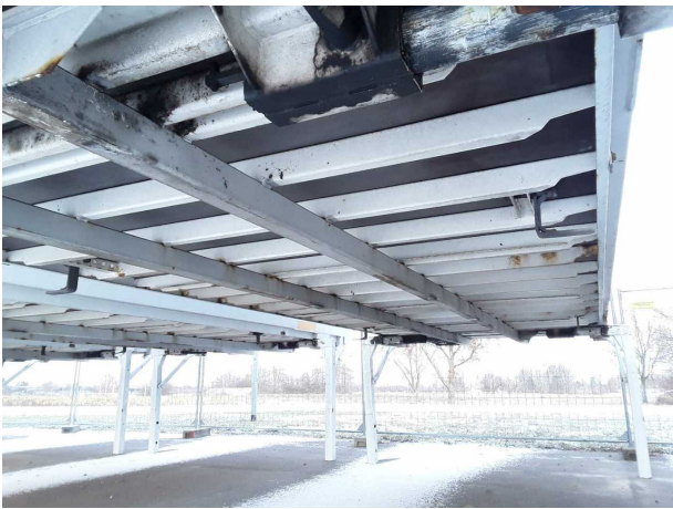
Gebrauchsspur 1: Koffer: Koffer - Korrosion - kein Abzug
