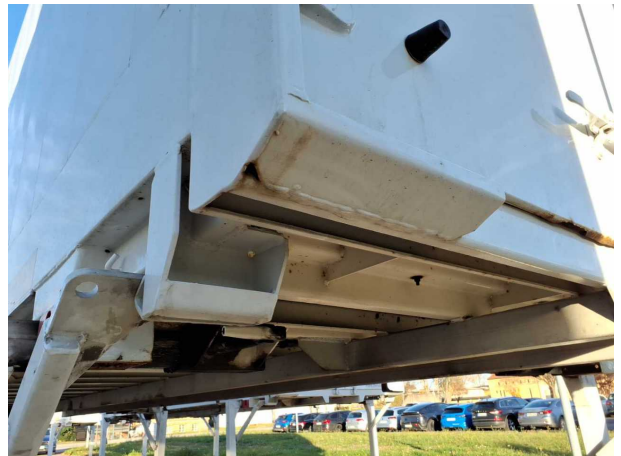
Gebrauchsspur 1: Koffer: Koffer - Korrosion - kein Abzug
