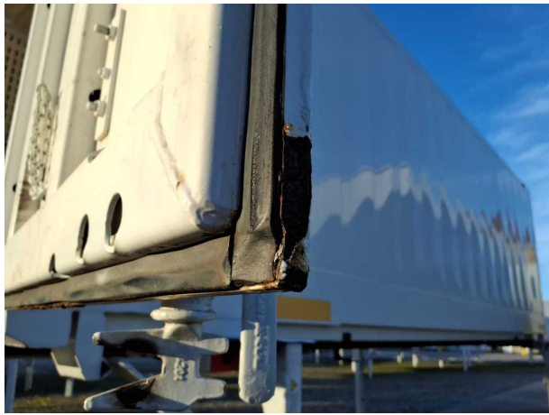
Beschädigung 2: Heckklappe/-tür: Hecktür rechts - Korrosion - instandsetzen und lackieren
