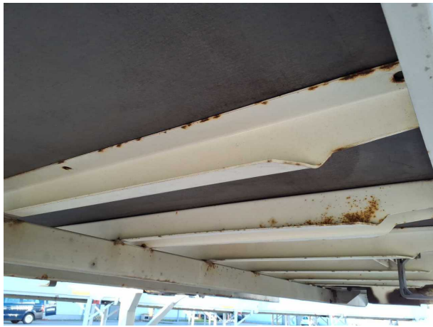
Gebrauchsspur 1: Koffer: Koffer - Korrosion - kein Abzug
