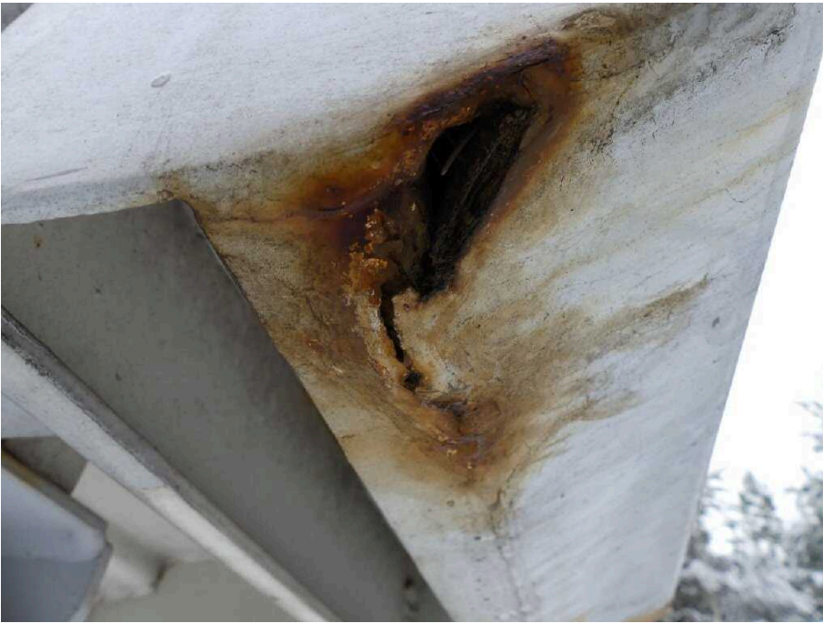
Bild 13 Fahrzeugheck Rahmen hinten hinten links stark korrodiert
