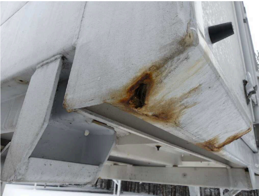
Bild 12 Fahrzeugheck Rahmen hinten hinten links stark korrodiert
