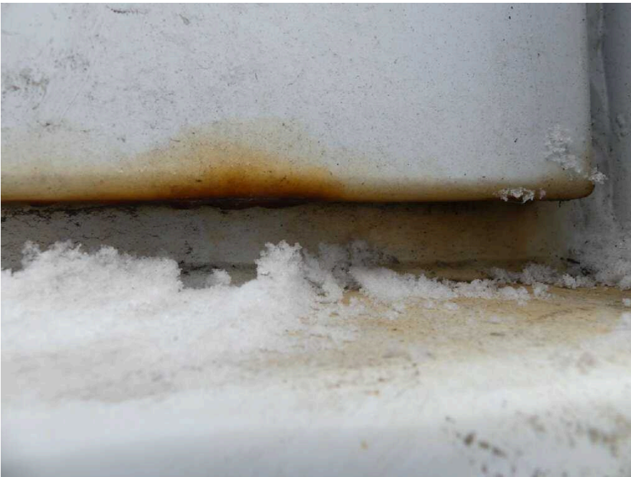
Bild 28 Fahrzeugheck Heckflügeltür rechts stark korrodiert
