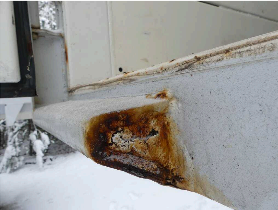
Bild 16 Fahrzeugheck Rahmen hinten hinten links stark korrodiert
