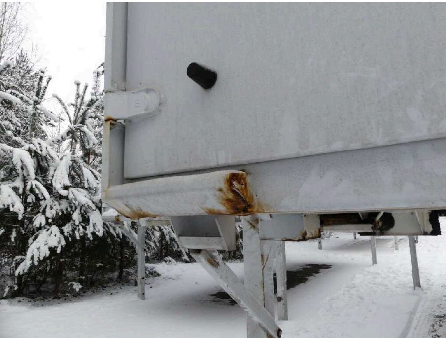
Bild 14 Fahrzeugheck Rahmen hinten hinten links stark korrodiert
