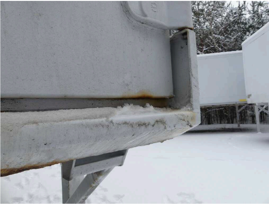
Bild 27 Fahrzeugheck Heckflügeltür rechts stark korrodiert
