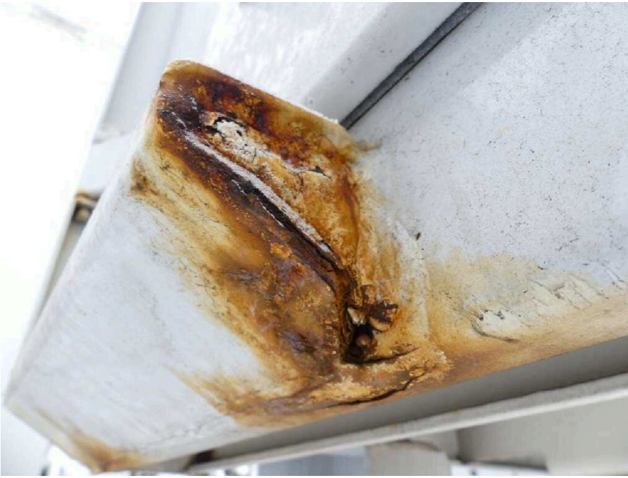
Bild 15 Fahrzeugheck Rahmen hinten hinten links stark korrodiert
