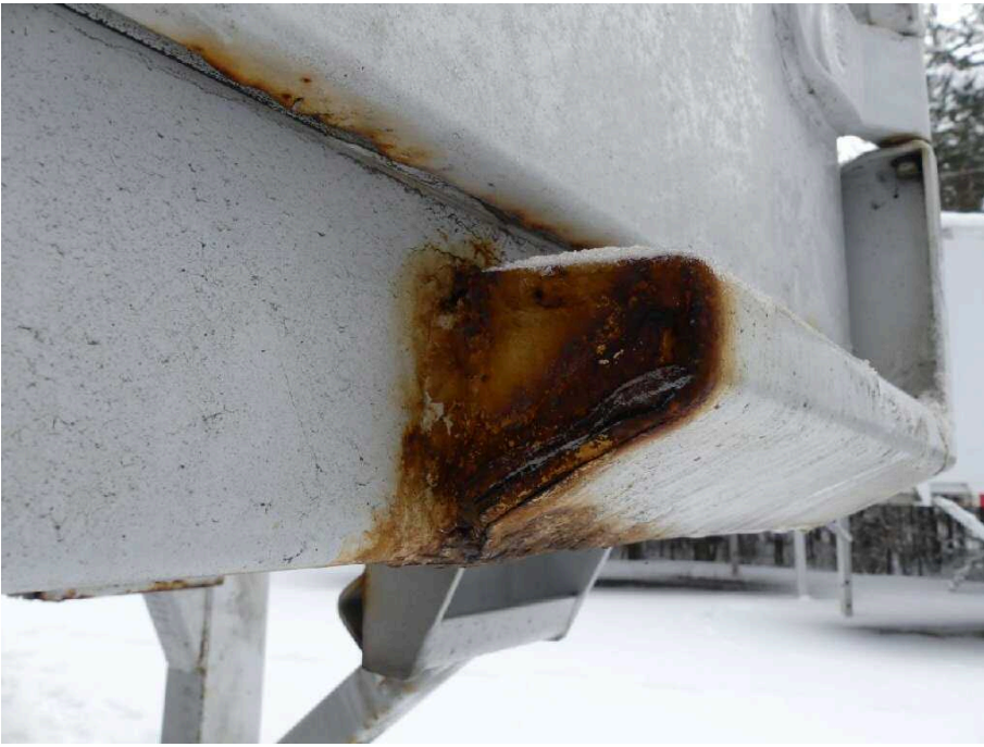
Bild 23 Fahrzeugheck Rahmen hinten hinten rechts stark korrodiert
