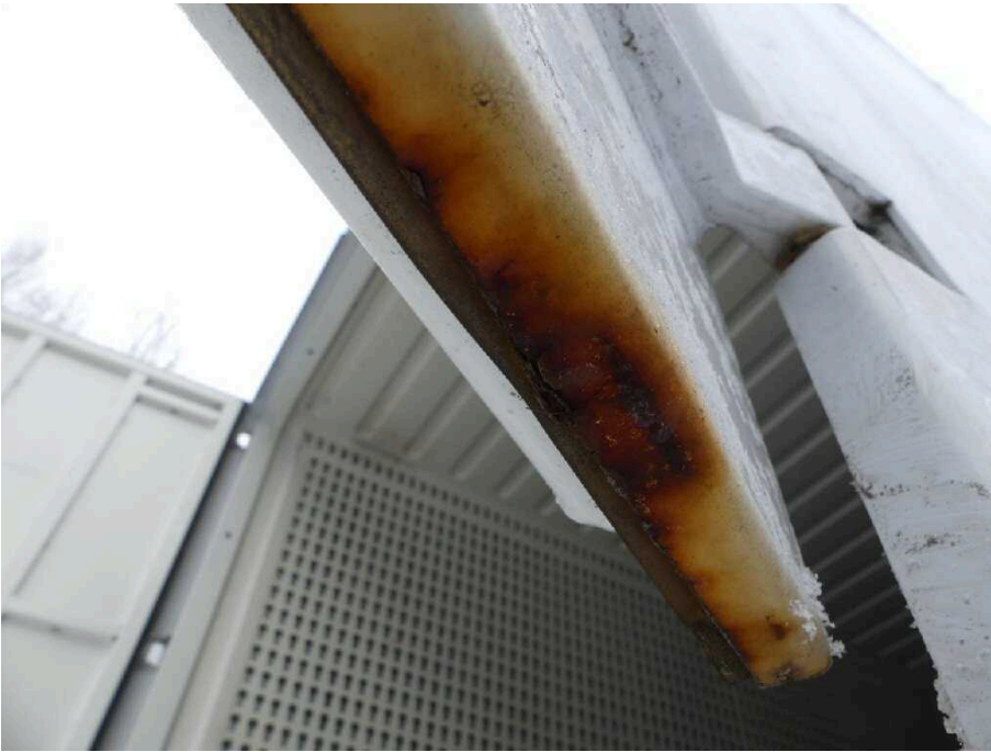
Bild 31 Fahrzeugheck Heckflügeltür rechts stark korrodiert
