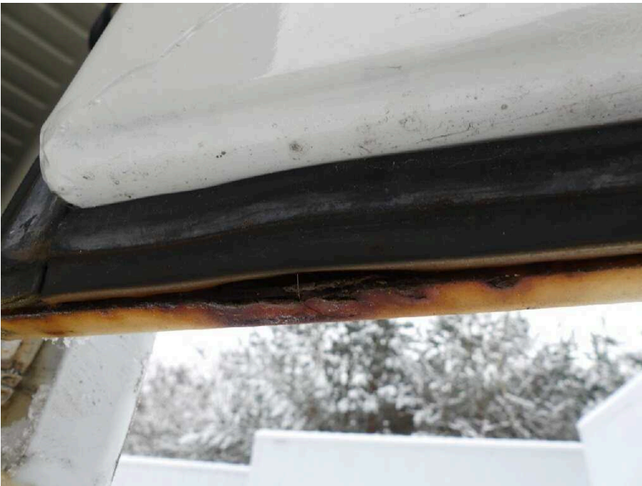
Bild 32 Fahrzeugheck Heckflügeltür rechts stark korrodiert
