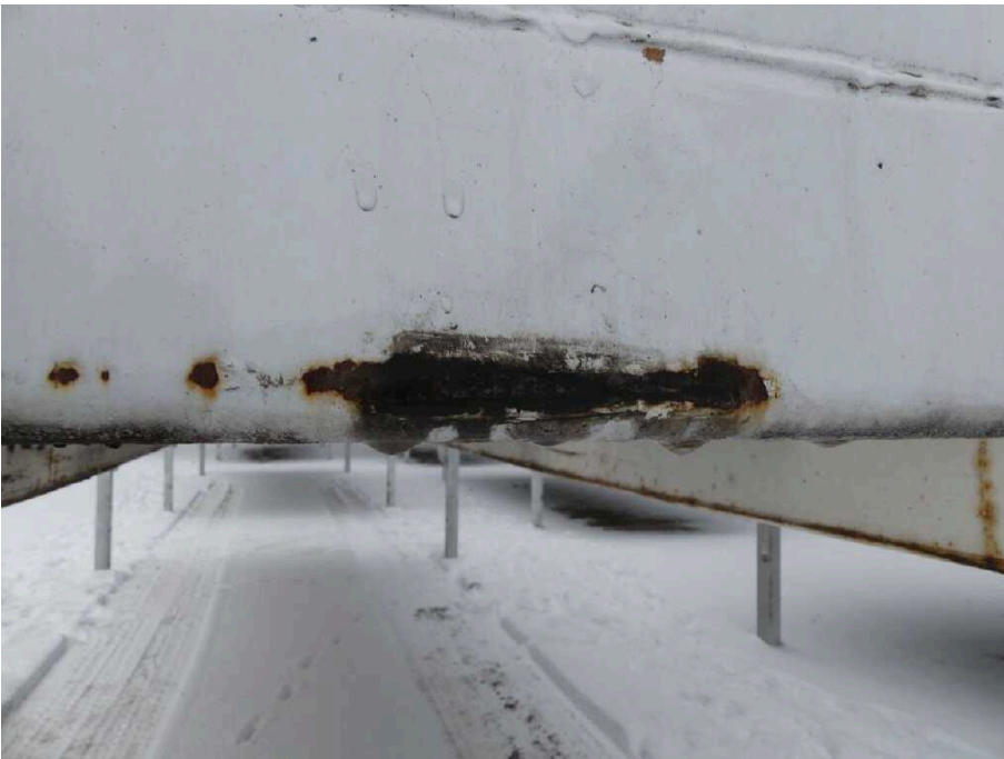
Bild 10 Aufbau Bodenrahmen vorne korrodiert
