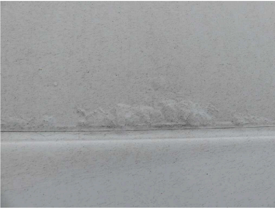
Bild 21 linke Seite Seitenwand links vorn korrodiert
