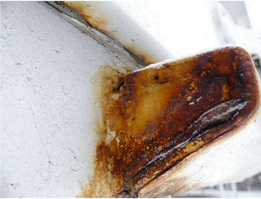
Bild 25 Fahrzeugheck Rahmen hinten hinten rechts stark korrodiert
