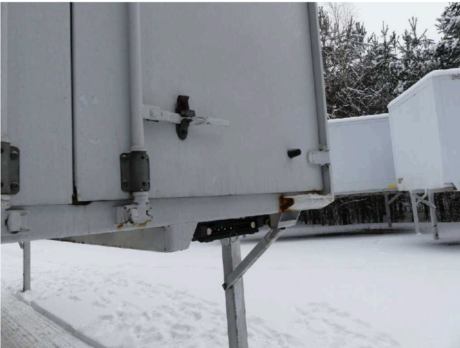
Bild 22 Fahrzeugheck Rahmen hinten hinten rechts stark korrodiert
