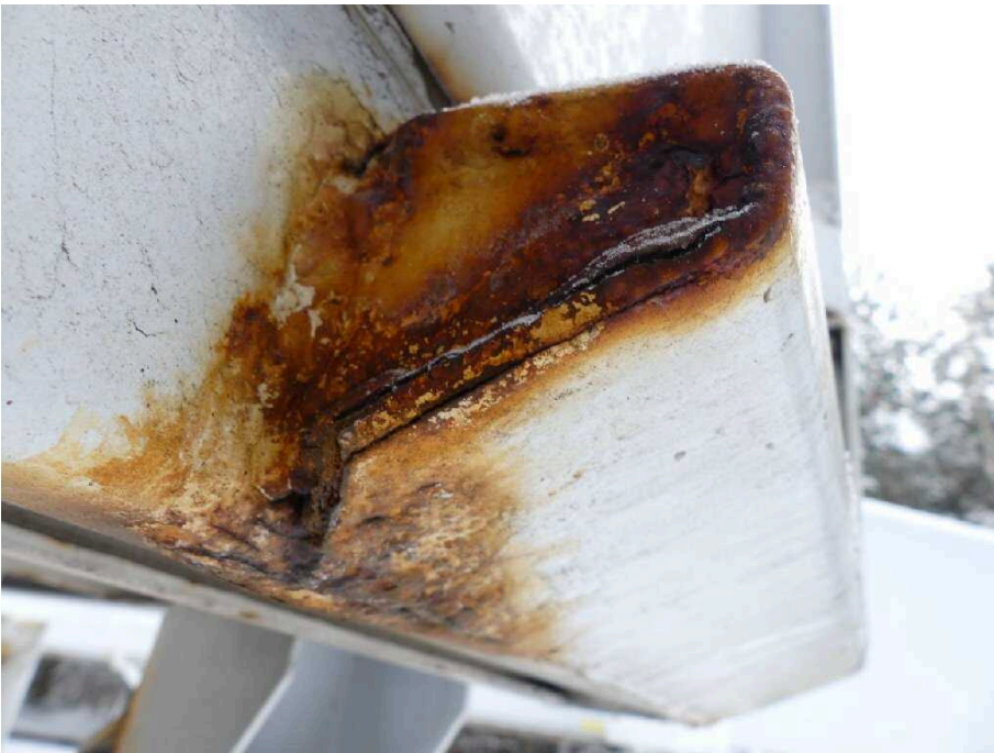
Bild 24 Fahrzeugheck Rahmen hinten hinten rechts stark korrodiert
