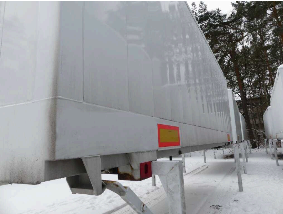
Bild 20 linke Seite Seitenwand links vorn korrodiert
