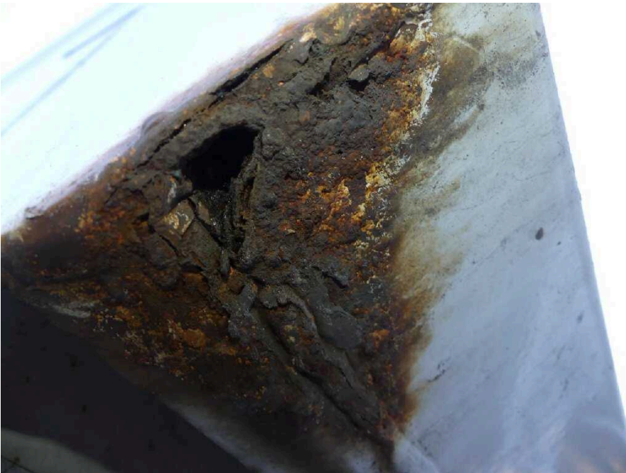
Bild 19 Fahrzeugheck Rahmen hinten links stark korrodiert
