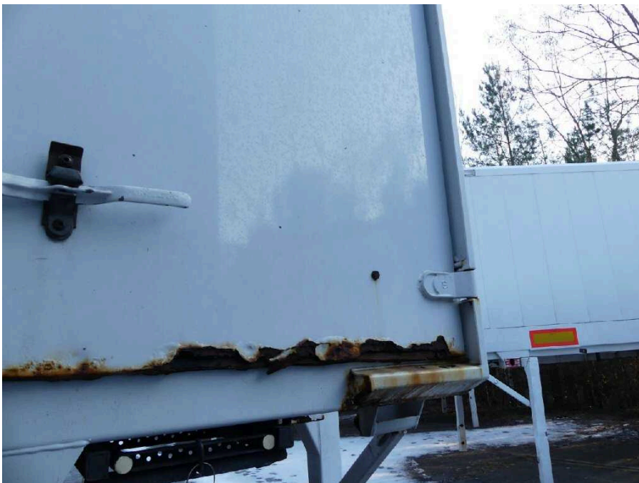
Bild 36 Fahrzeugheck Rahmen hinten rechts stark korrodiert
