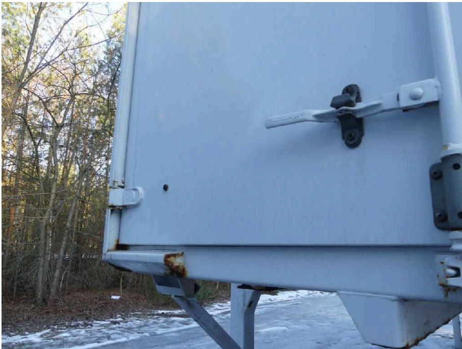
Bild 23 Fahrzeugheck Heckflügeltür links Anschlaggummi beschädigt
