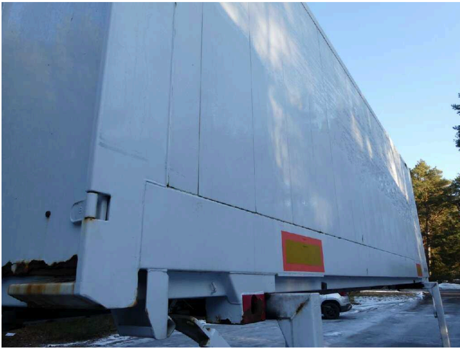
Bild 41 linke Seite Seitenwand links und Ecke hi.re. verschürft
