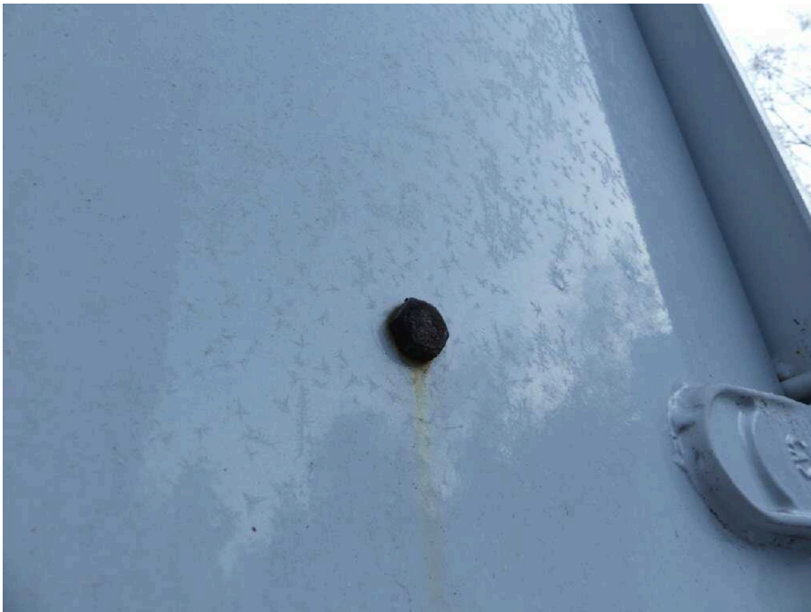
Bild 35 Fahrzeugheck Heckflügeltür rechts Anschlaggummi beschädigt
