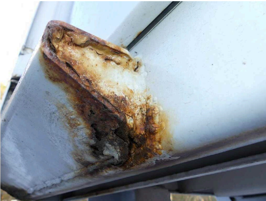
Bild 21 Fahrzeugheck Rahmen hinten links stark korrodiert
