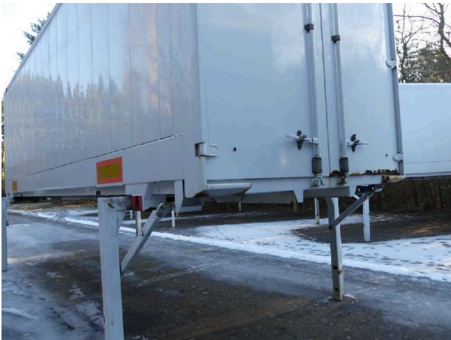
Bild 16 Fahrzeugheck Rahmen hinten links stark korrodiert
