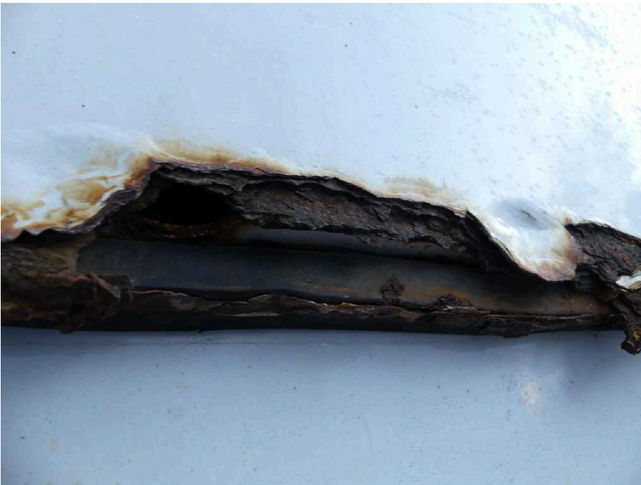
Bild 29 Fahrzeugheck Heckflügeltür rechts stark korrodiert
