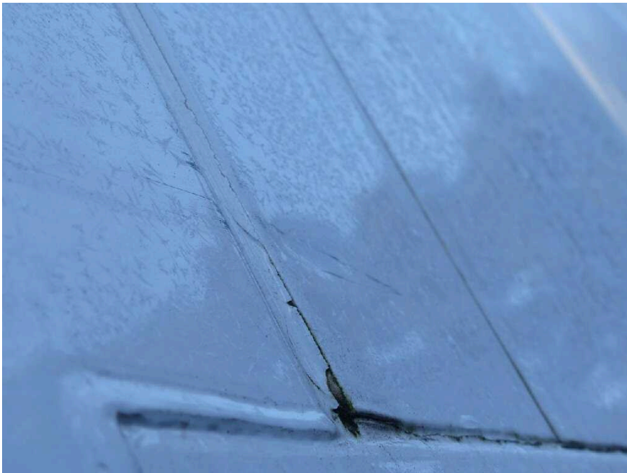
Bild 45 linke Seite Seitenwand links und Ecke hi.re. verschürft
