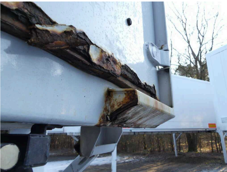
Bild 30 Fahrzeugheck Heckflügeltür rechts stark korrodiert
