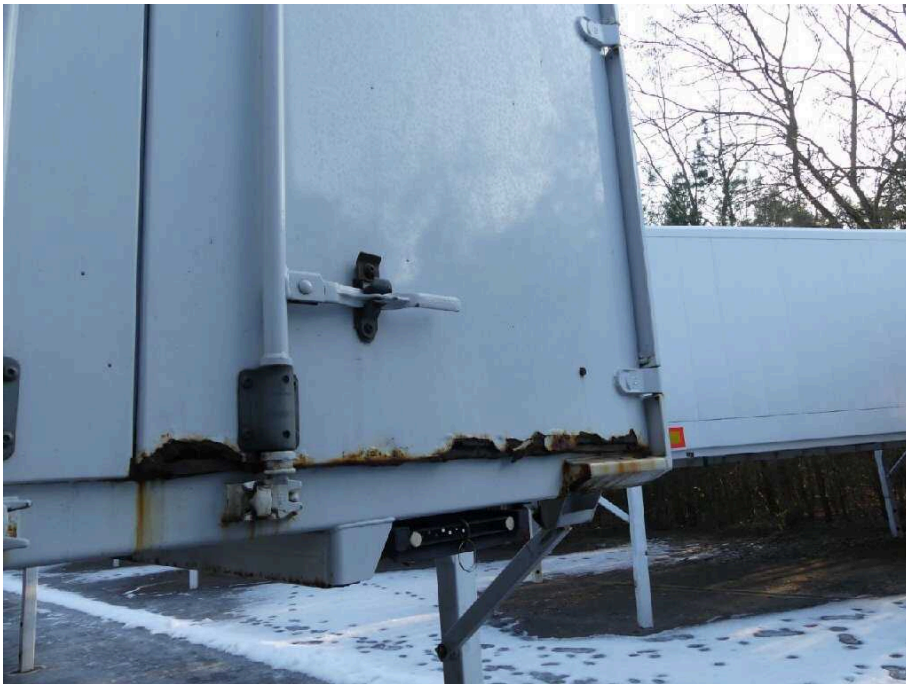
Bild 25 Fahrzeugheck Heckflügeltür rechts stark korrodiert
