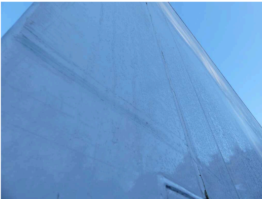
Bild 42 linke Seite Seitenwand links und Ecke hi.re. verschürft
