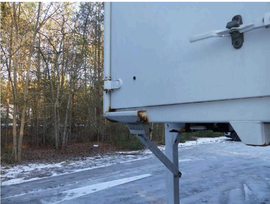
Bild 20 Fahrzeugheck Rahmen hinten links stark korrodiert
