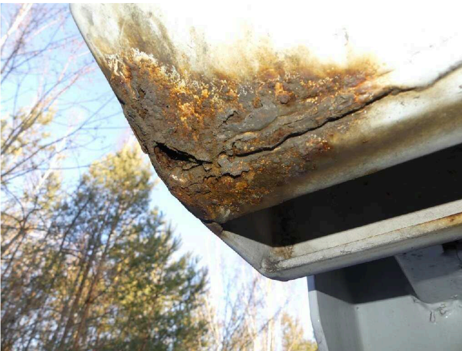
Bild 22 Fahrzeugheck Rahmen hinten links stark korrodiert
