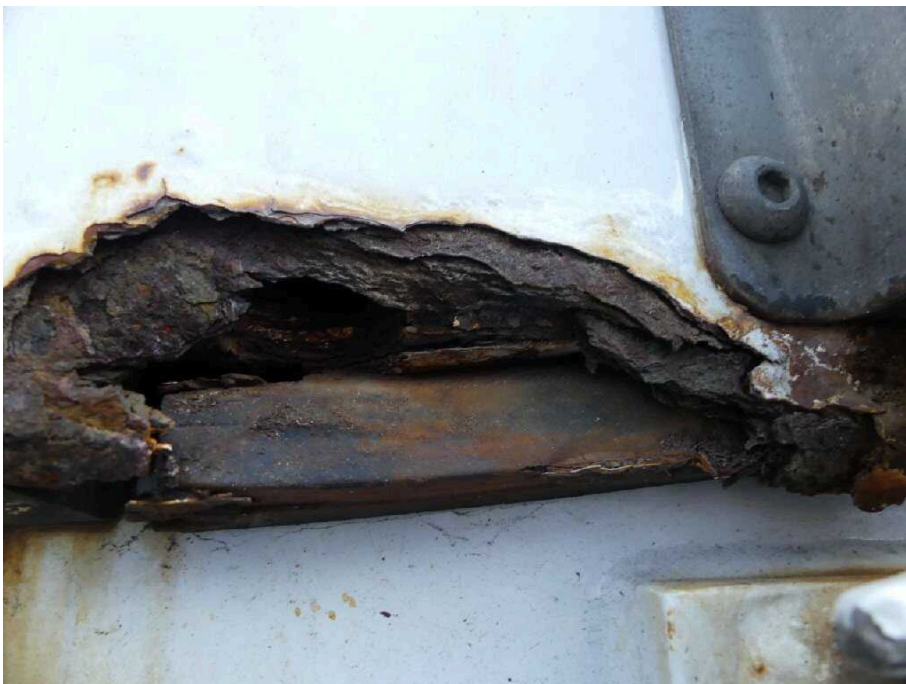
Bild 26 Fahrzeugheck Heckflügeltür rechts stark korrodiert
