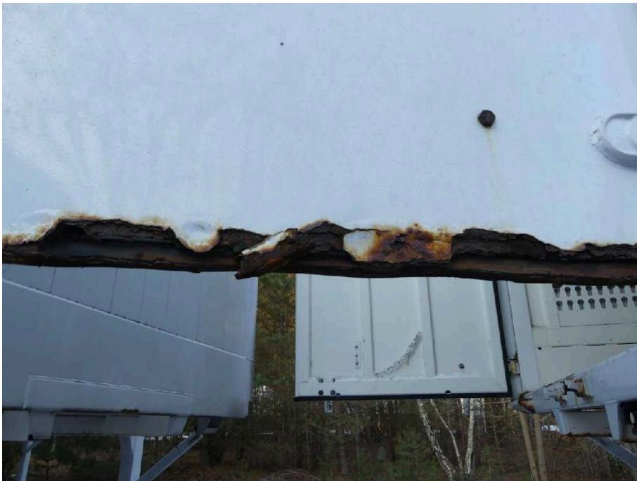
Bild 33 Fahrzeugheck Heckflügeltür rechts stark korrodiert
