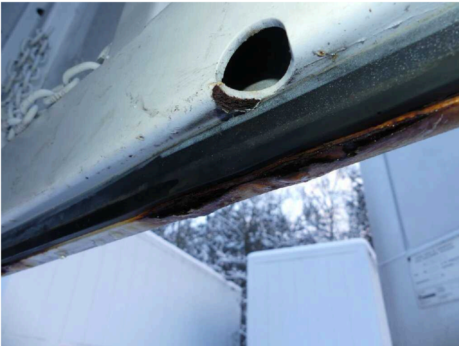
Bild 37 Fahrzeugheck Heckflügeltür rechts stark korrodiert
