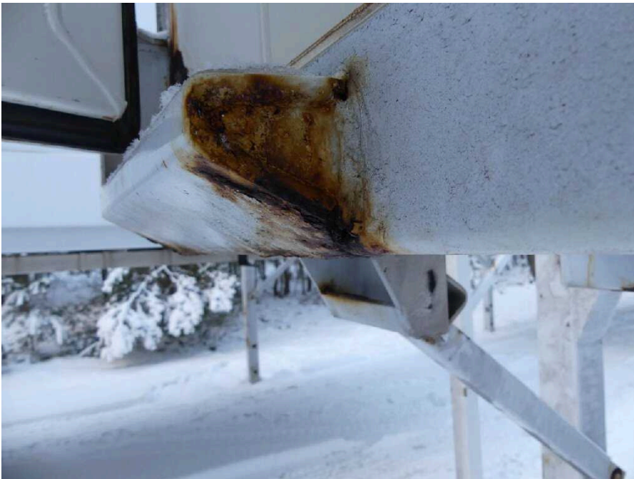
Bild 25 Fahrzeugheck Rahmen hinten hinten links stark korrodiert
