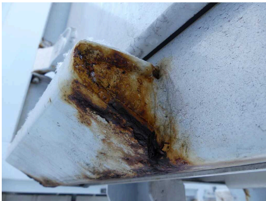
Bild 24 Fahrzeugheck Rahmen hinten hinten links stark korrodiert
