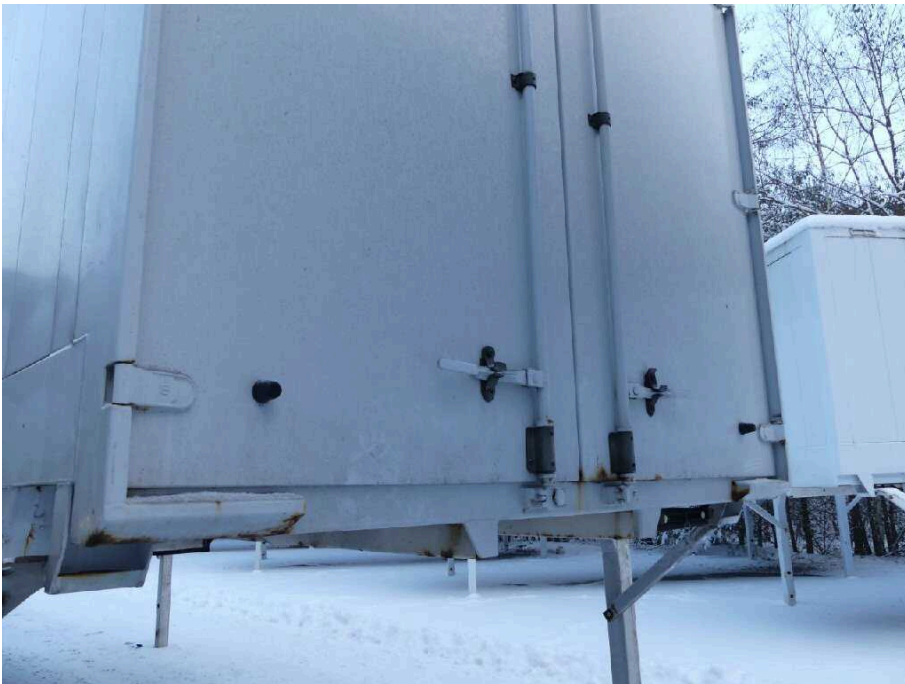
Bild 33 Fahrzeugheck Heckflügeltür rechts stark korrodiert
