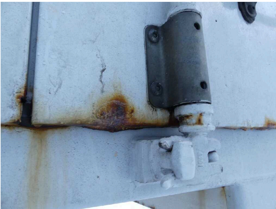
Bild 34 Fahrzeugheck Heckflügeltür rechts stark korrodiert
