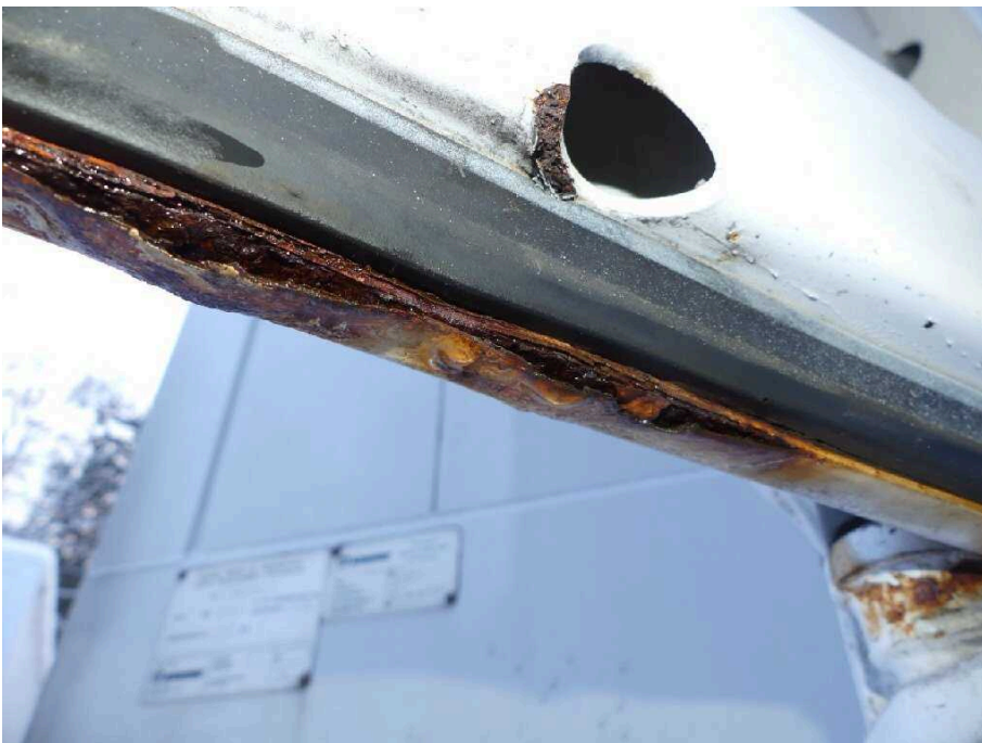
Bild 40 Fahrzeugheck Heckflügeltür rechts stark korrodiert
