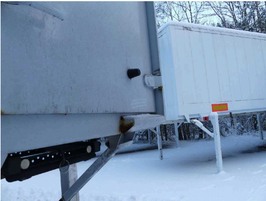
Bild 42 Fahrzeugheck Rahmen hinten hinten rechts stark korrodiert
