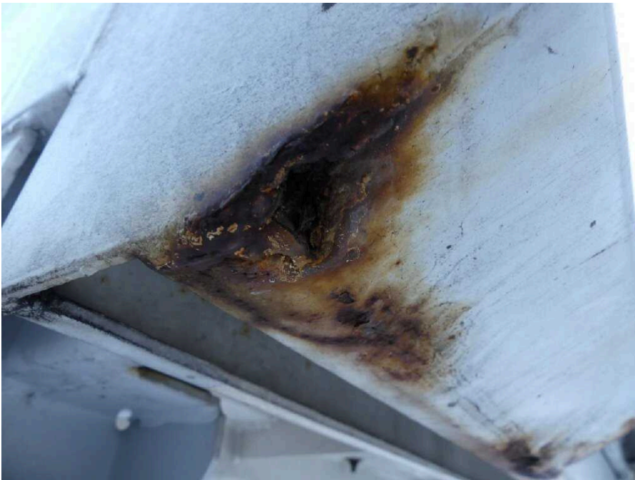
Bild 22 Fahrzeugheck Rahmen hinten hinten links stark korrodiert
