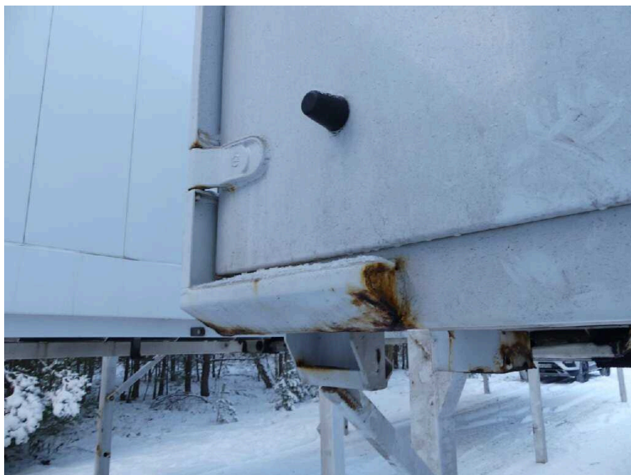
Bild 23 Fahrzeugheck Rahmen hinten hinten links stark korrodiert
