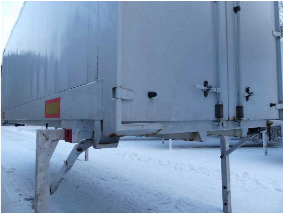
Bild 20 Fahrzeugheck Rahmen hinten hinten links stark korrodiert
