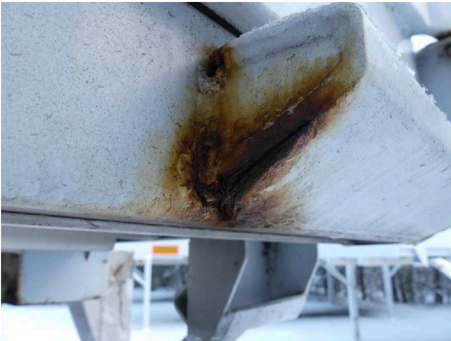
Bild 43 Fahrzeugheck Rahmen hinten hinten rechts stark korrodiert
