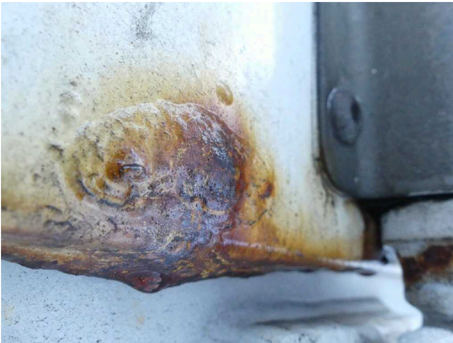
Bild 35 Fahrzeugheck Heckflügeltür rechts stark korrodiert
