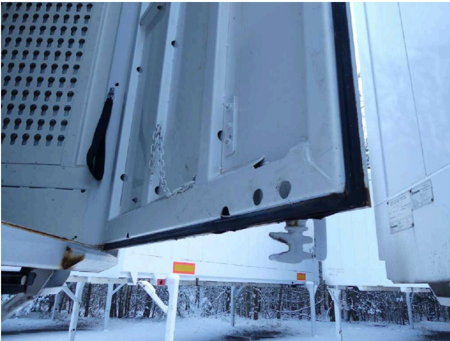
Bild 36 Fahrzeugheck Heckflügeltür rechts stark korrodiert
