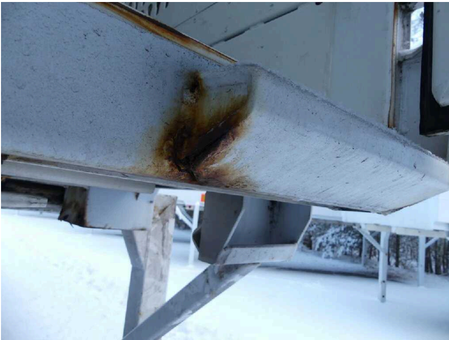
Bild 45 Fahrzeugheck Rahmen hinten hinten rechts stark korrodiert
