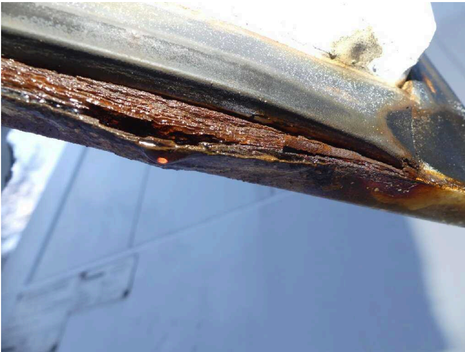
Bild 39 Fahrzeugheck Heckflügeltür rechts stark korrodiert
