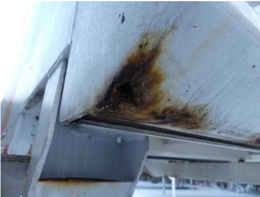
Bild 21 Fahrzeugheck Rahmen hinten hinten links stark korrodiert
