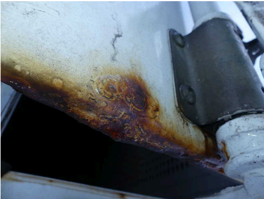
Bild 41 Fahrzeugheck Heckflügeltür rechts stark korrodiert
