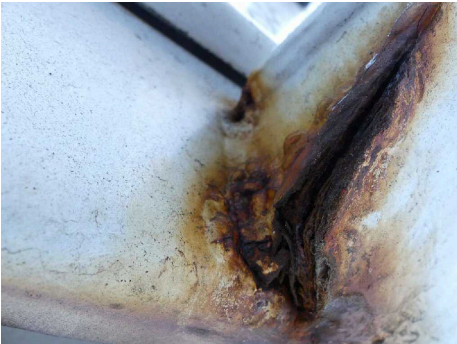
Bild 44 Fahrzeugheck Rahmen hinten hinten rechts stark korrodiert
