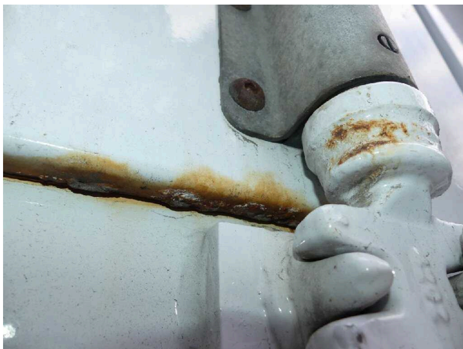
Bild 18 Fahrzeugheck Heckflügeltür links stark korrodiert
