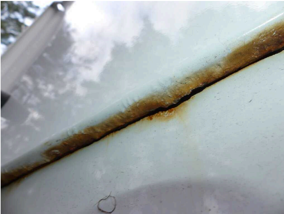
Bild 20 Fahrzeugheck Heckflügeltür links stark korrodiert
