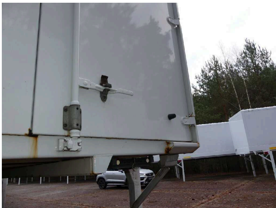
Bild 25 Fahrzeugheck Heckflügeltür rechts stark korrodiert
