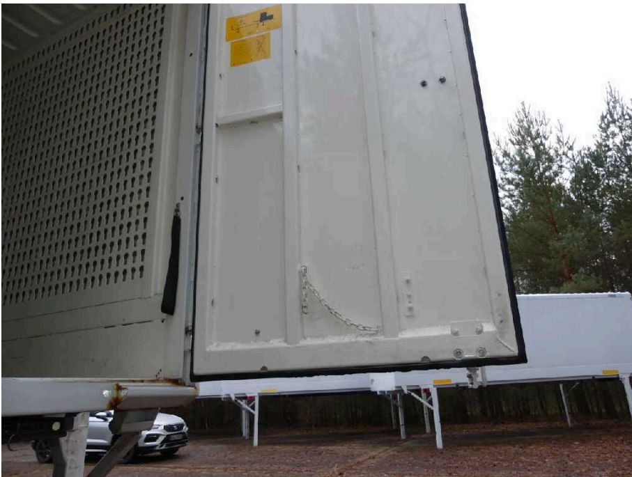
Bild 30 Fahrzeugheck Heckflügeltür rechts stark korrodiert
