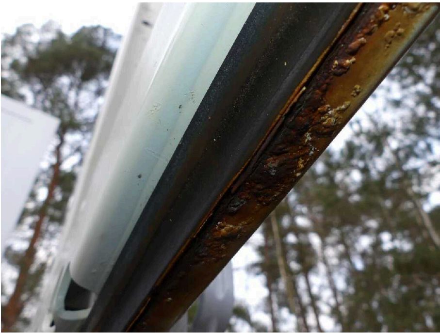
Bild 23 Fahrzeugheck Heckflügeltür links stark korrodiert
