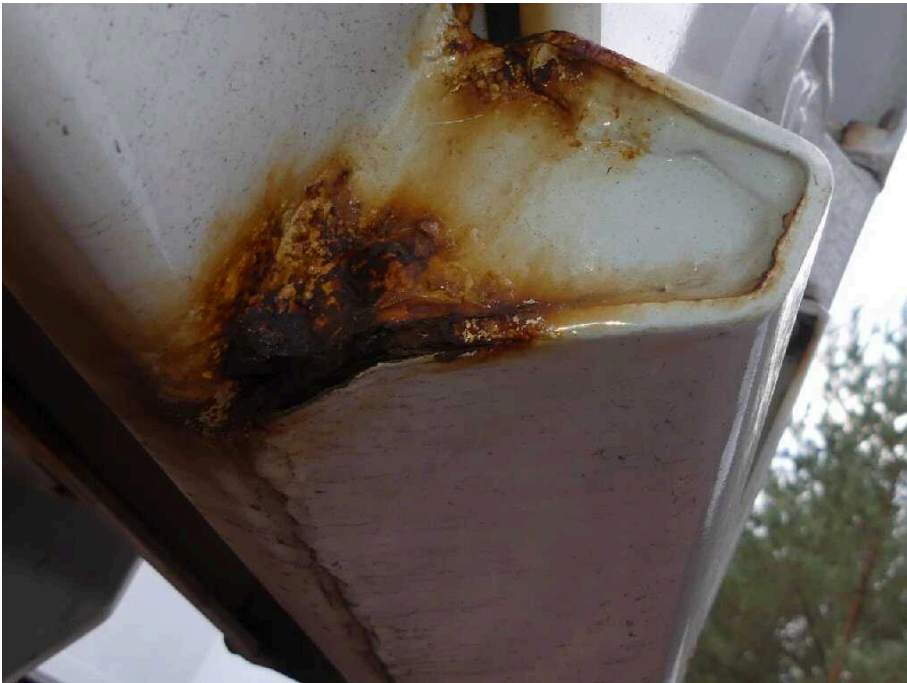
Bild 36 Fahrzeugheck Rahmen hinten rechts stark korrodiert
