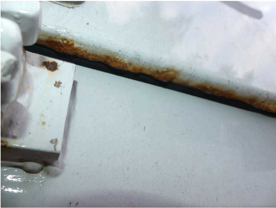
Bild 27 Fahrzeugheck Heckflügeltür rechts stark korrodiert
