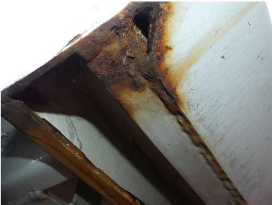
Bild 14 Fahrzeugheck Rahmen hinten hinten links stark korrodiert
