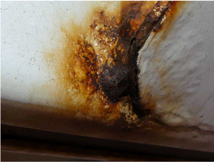
Bild 37 Fahrzeugheck Rahmen hinten rechts stark korrodiert
