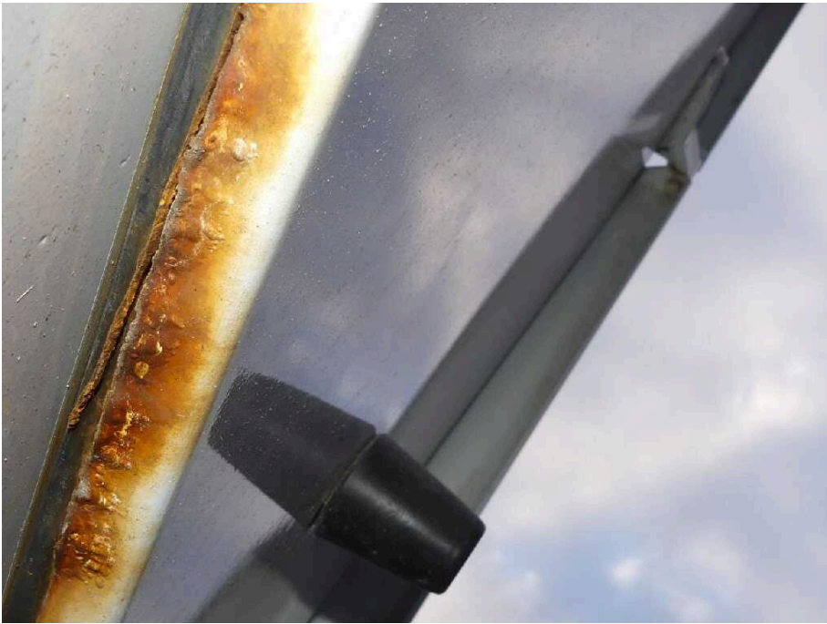
Bild 29 Fahrzeugheck Heckflügeltür rechts stark korrodiert
