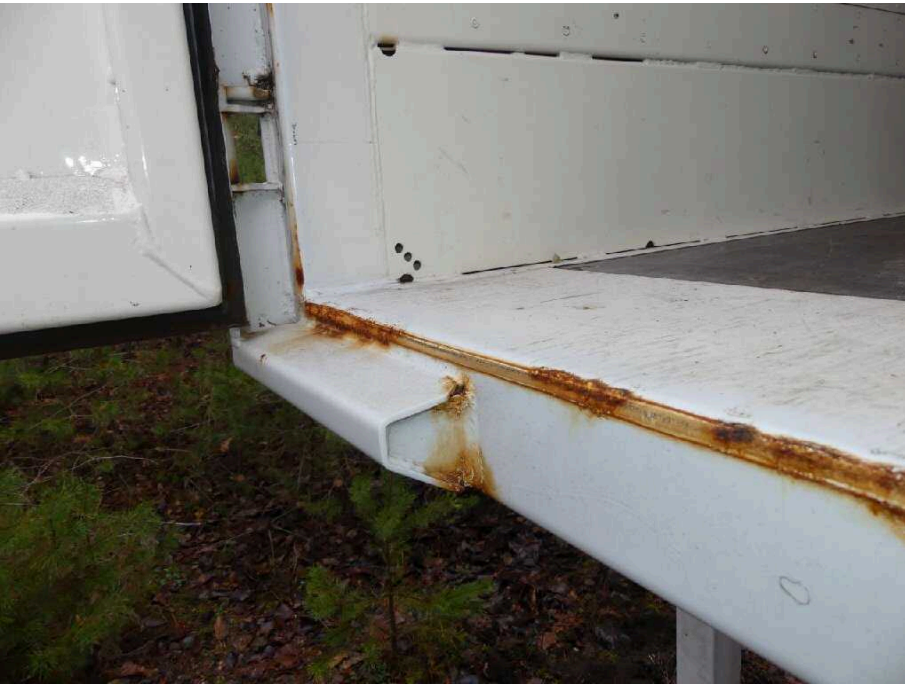
Bild 44 Fahrzeugheck Rahmen hinten Mitte stark korrodiert
