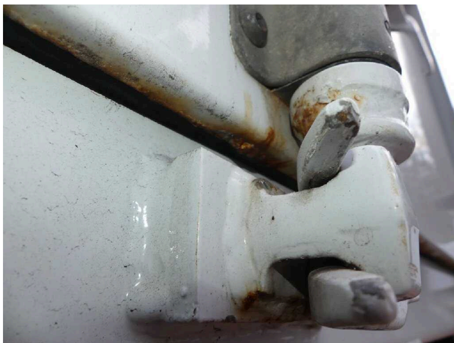
Bild 26 Fahrzeugheck Heckflügeltür rechts stark korrodiert
