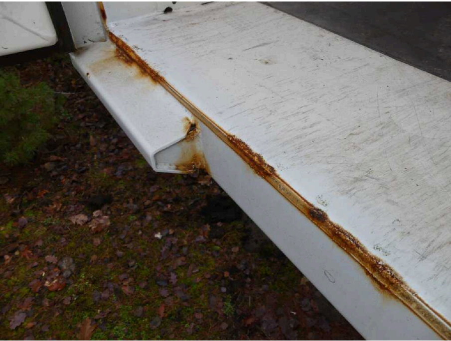
Bild 43 Fahrzeugheck Rahmen hinten Mitte stark korrodiert
