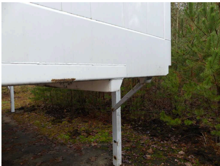
Bild 9 Aufbau Bodenrahmen vorne korrodiert
