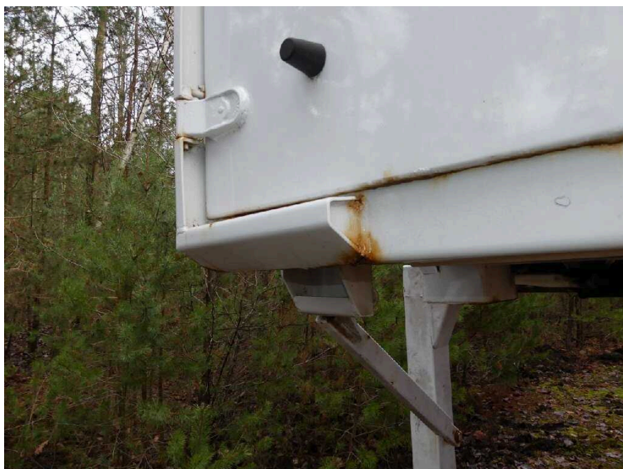
Bild 15 Fahrzeugheck Rahmen hinten hinten links stark korrodiert
