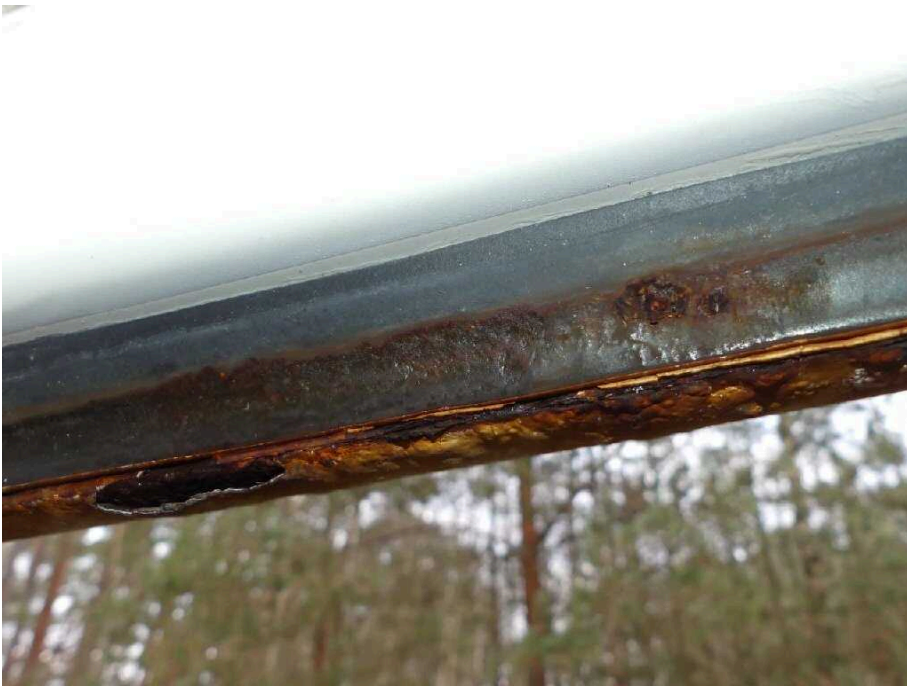
Bild 21 Fahrzeugheck Heckflügeltür links stark korrodiert
