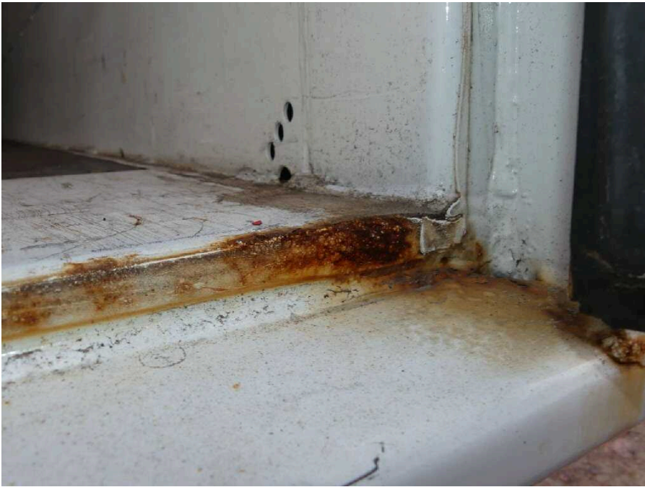
Bild 39 Fahrzeugheck Rahmen hinten rechts stark korrodiert
