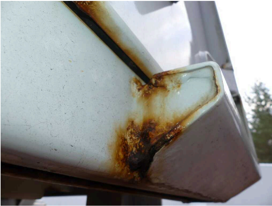
Bild 35 Fahrzeugheck Rahmen hinten rechts stark korrodiert
