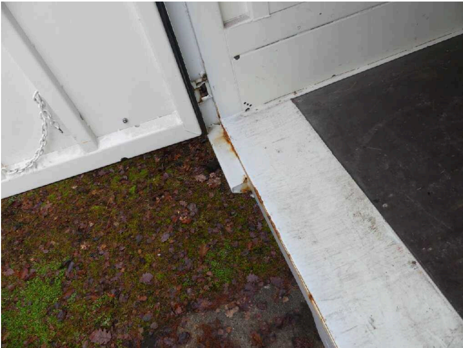
Bild 42 Fahrzeugheck Rahmen hinten Mitte stark korrodiert
