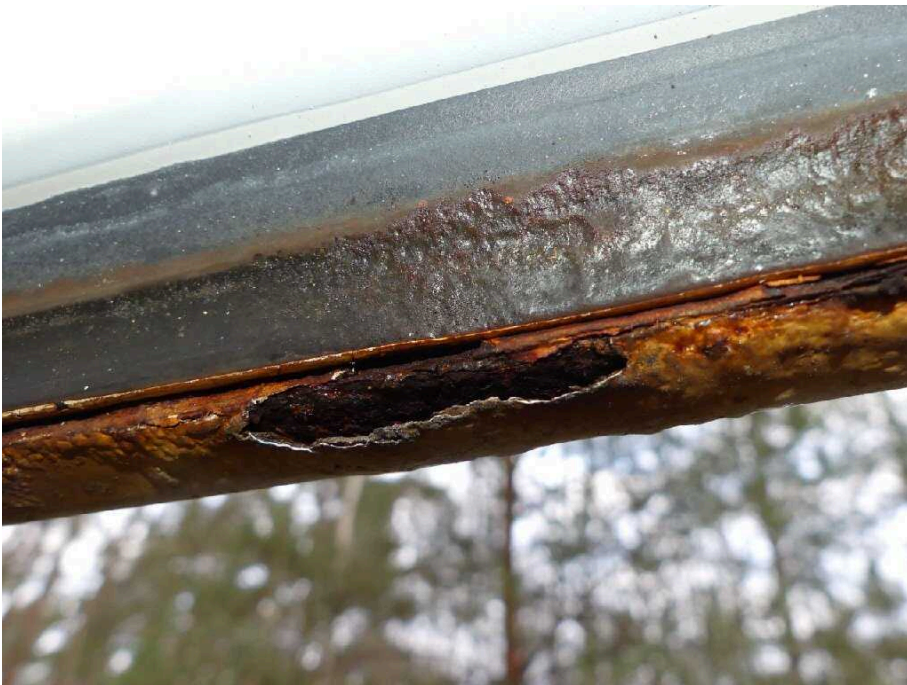
Bild 22 Fahrzeugheck Heckflügeltür links stark korrodiert
