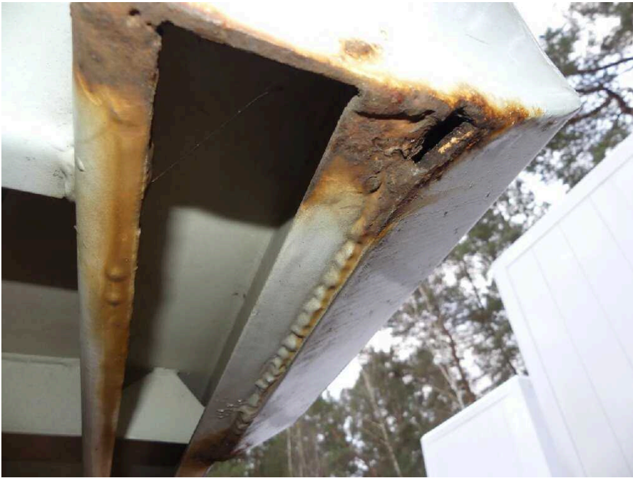
Bild 13 Fahrzeugheck Rahmen hinten hinten links stark korrodiert
