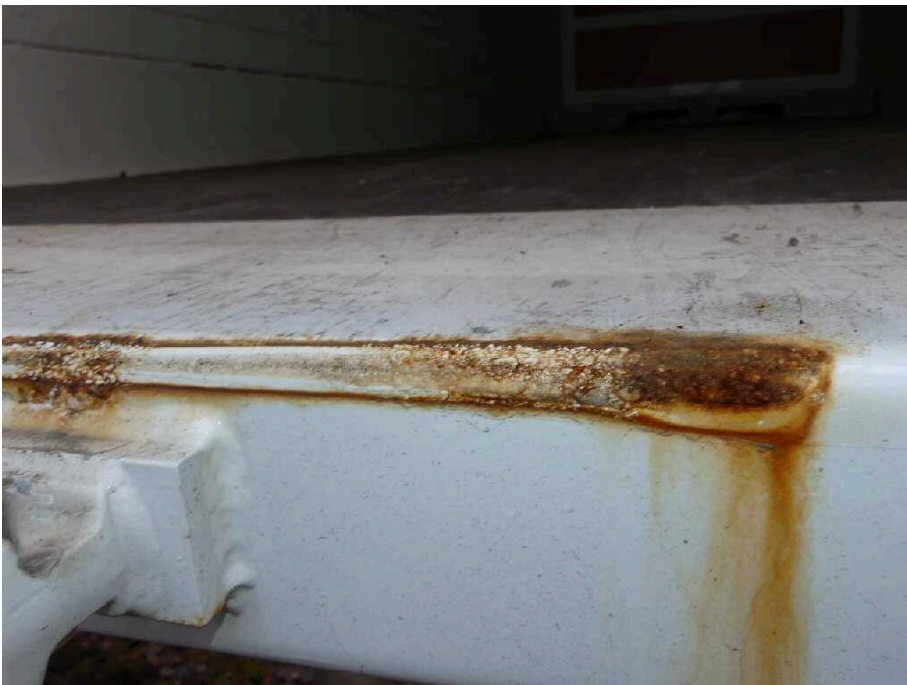
Bild 40 Fahrzeugheck Rahmen hinten Mitte stark korrodiert
