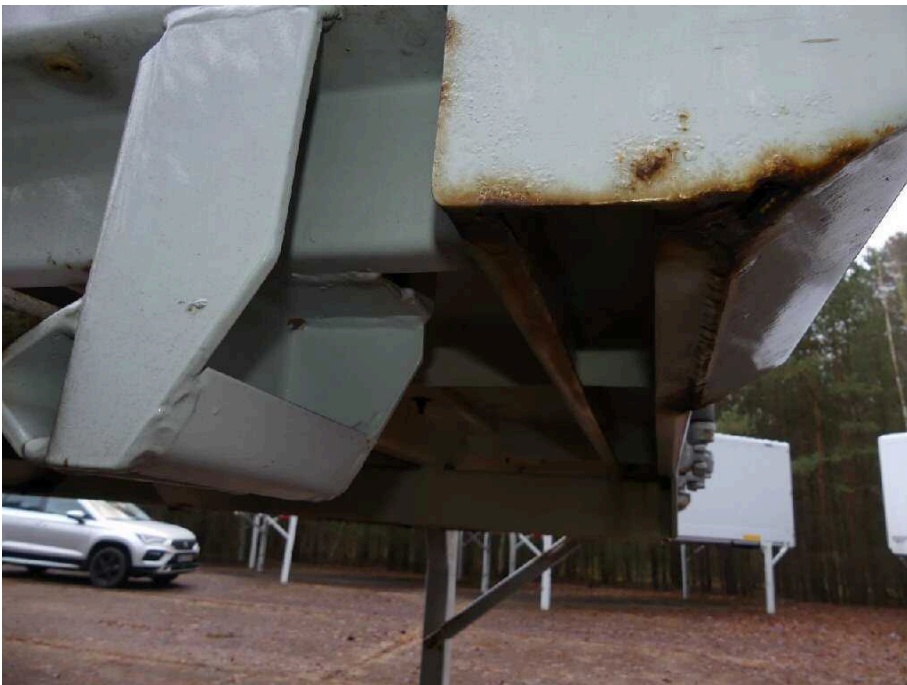
Bild 12 Fahrzeugheck Rahmen hinten hinten links stark korrodiert
