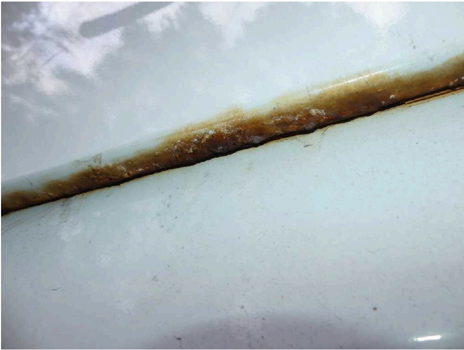
Bild 19 Fahrzeugheck Heckflügeltür links stark korrodiert
