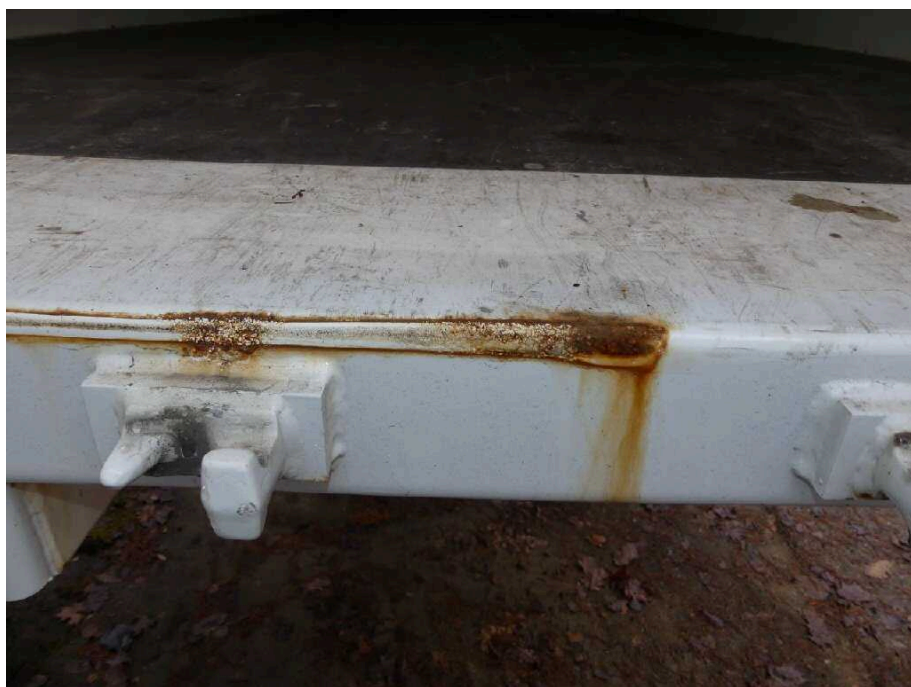
Bild 46 Fahrzeugheck Rahmen hinten Mitte stark korrodiert
