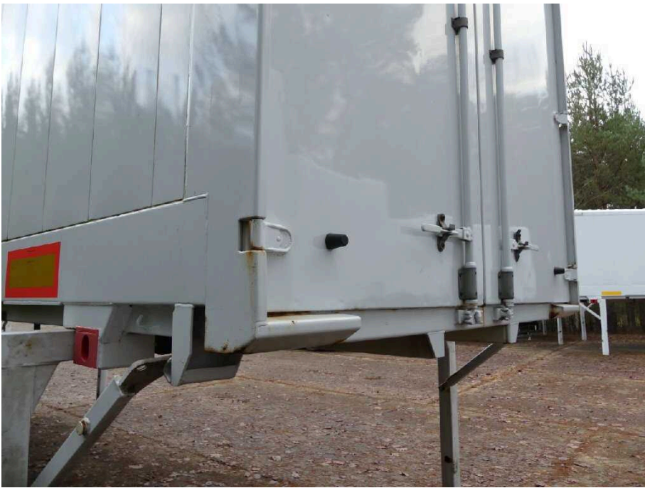
Bild 11 Fahrzeugheck Rahmen hinten hinten links stark korrodiert
