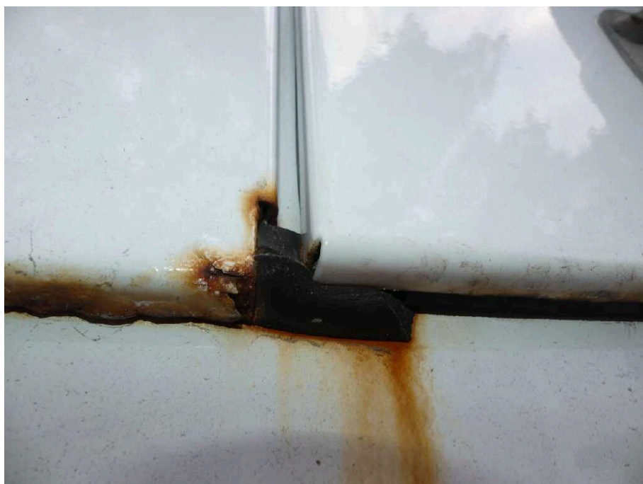
Bild 17 Fahrzeugheck Heckflügeltür links stark korrodiert
