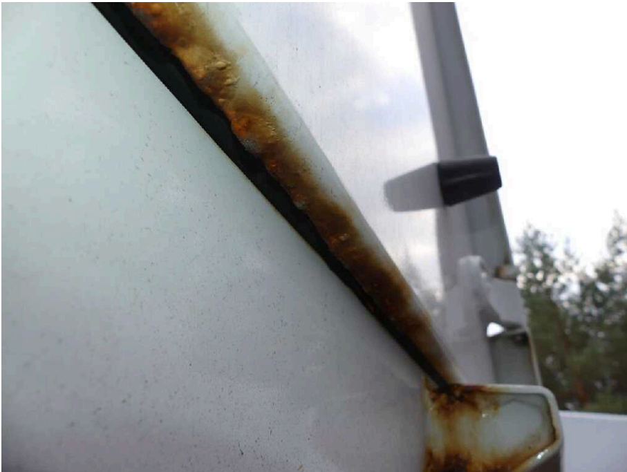
Bild 28 Fahrzeugheck Heckflügeltür rechts stark korrodiert
