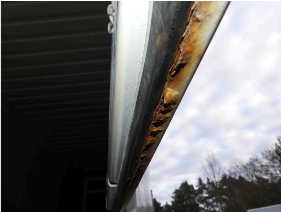
Bild 33 Fahrzeugheck Heckflügeltür rechts stark korrodiert
