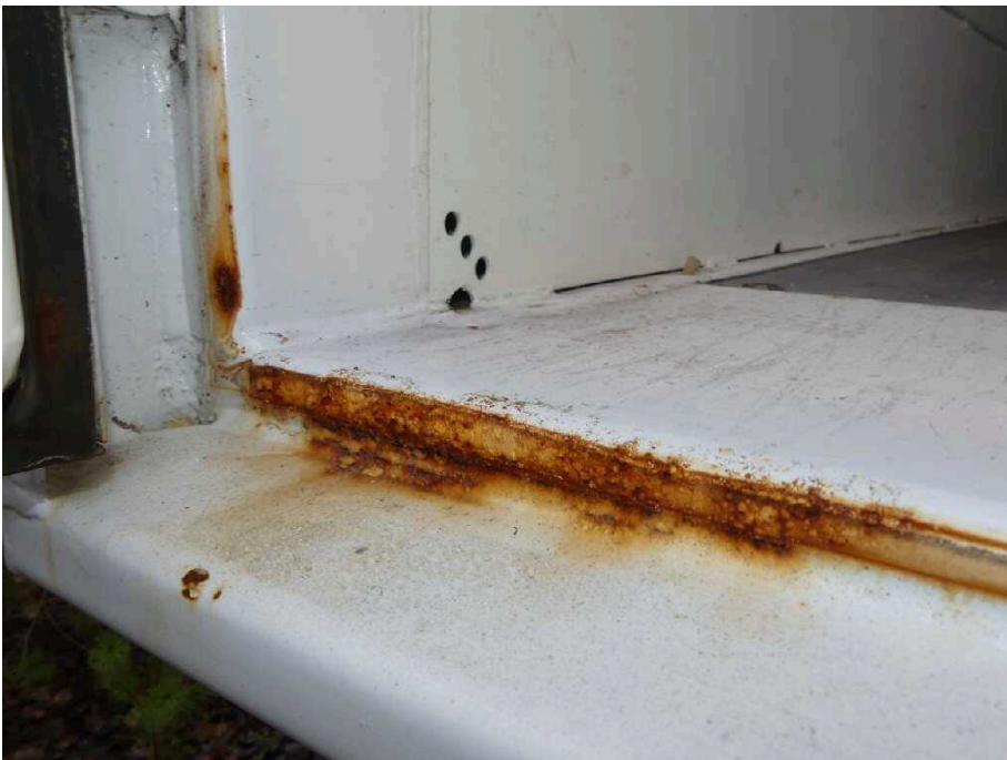
Bild 24 Fahrzeugheck Rahmen hinten hinten links stark korrodiert
