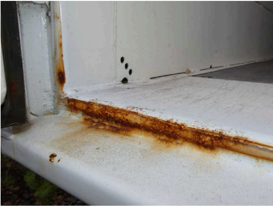
Bild 41 Fahrzeugheck Rahmen hinten Mitte stark korrodiert
