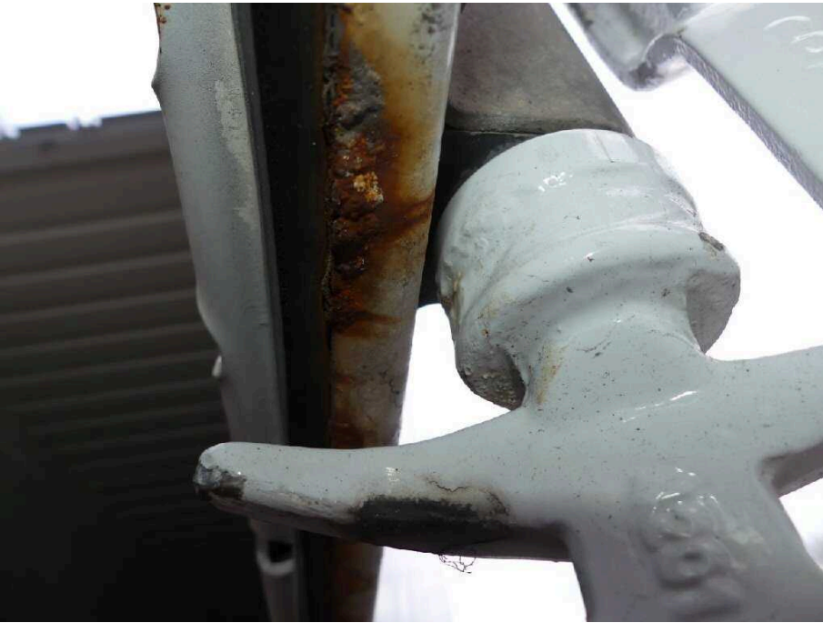
Bild 31 Fahrzeugheck Heckflügeltür rechts stark korrodiert
