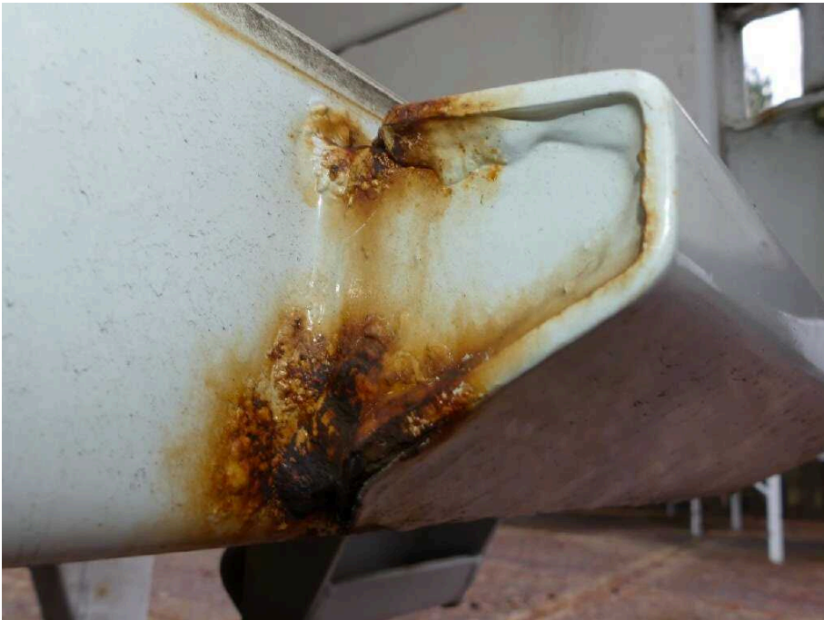
Bild 38 Fahrzeugheck Rahmen hinten rechts stark korrodiert
