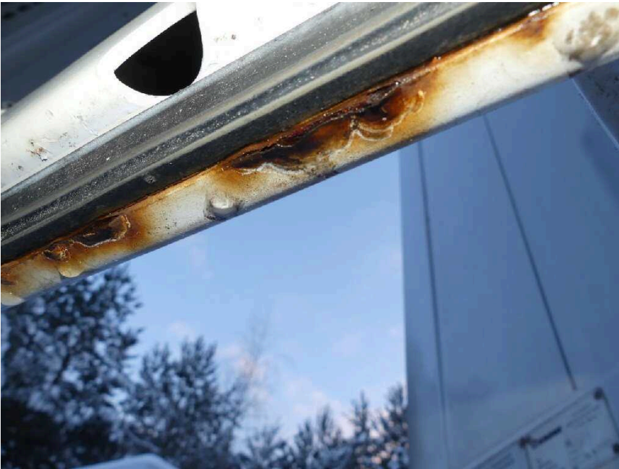
Bild 51 Fahrzeugheck Heckflügeltür rechts stark korrodiert
