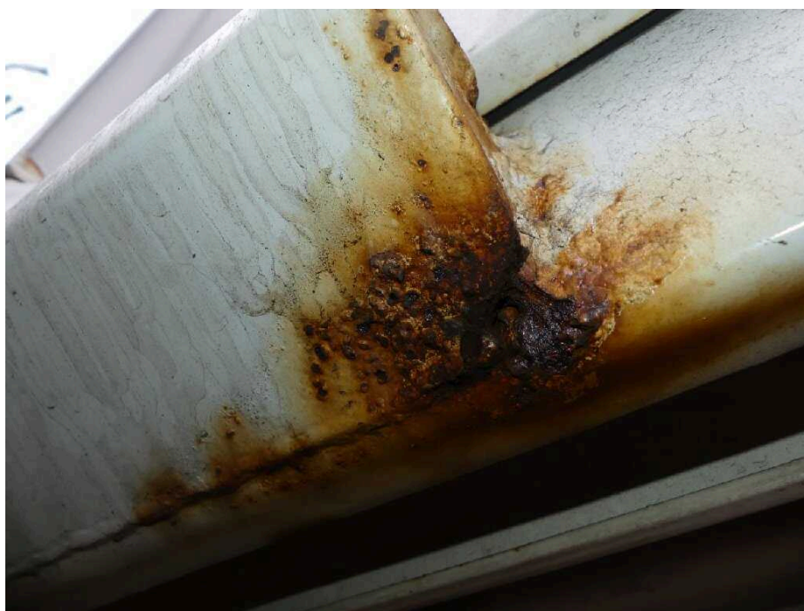
Bild 18 Fahrzeugheck Rahmen hinten links stark korrodiert
