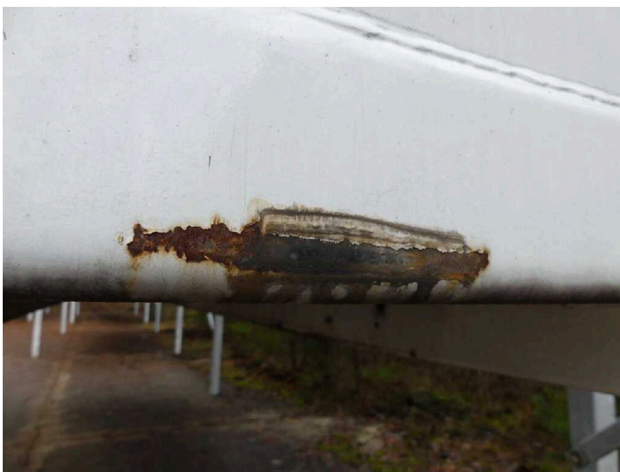
Bild 10 Aufbau Bodenrahmen vorne korrodiert
