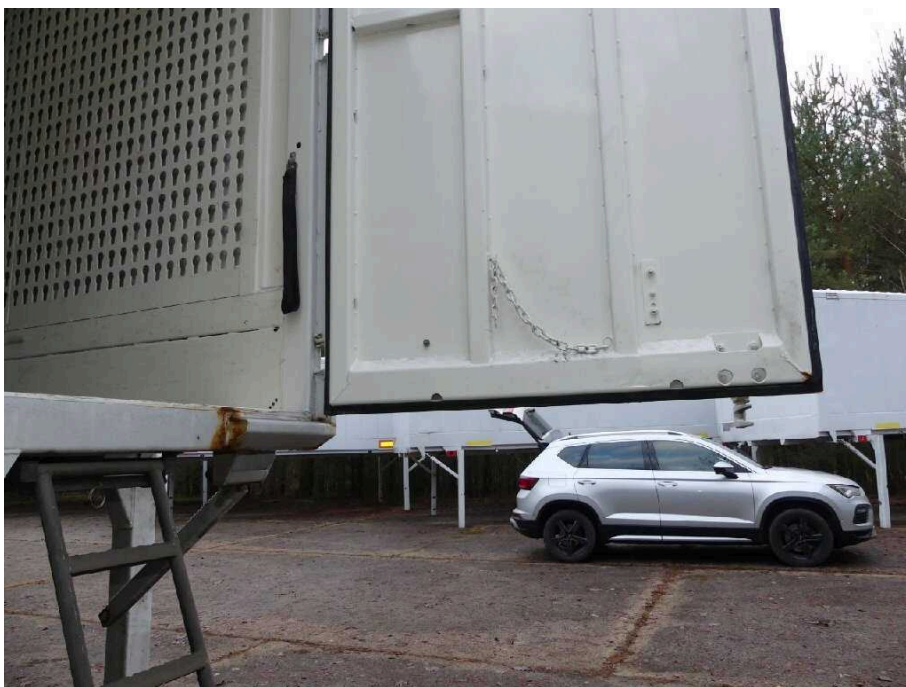
Bild 34 Fahrzeugheck Heckflügeltür rechts korrodiert
