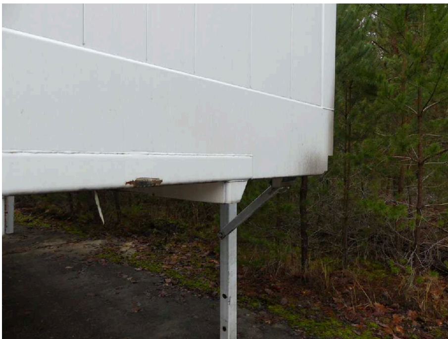
Bild 9 Aufbau Bodenrahmen vorne korrodiert
