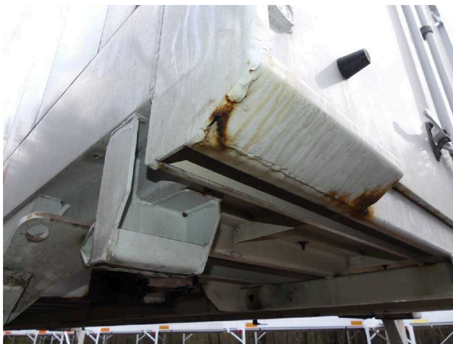
Bild 16 Fahrzeugheck Rahmen hinten links stark korrodiert
