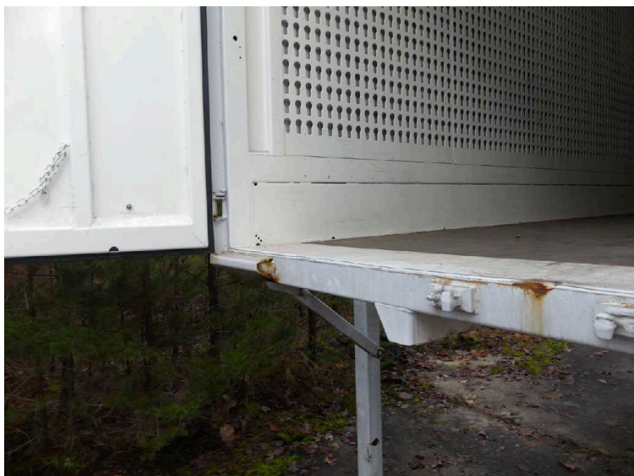
Bild 25 Fahrzeugheck Rahmen hinten Mitte korrodiert
