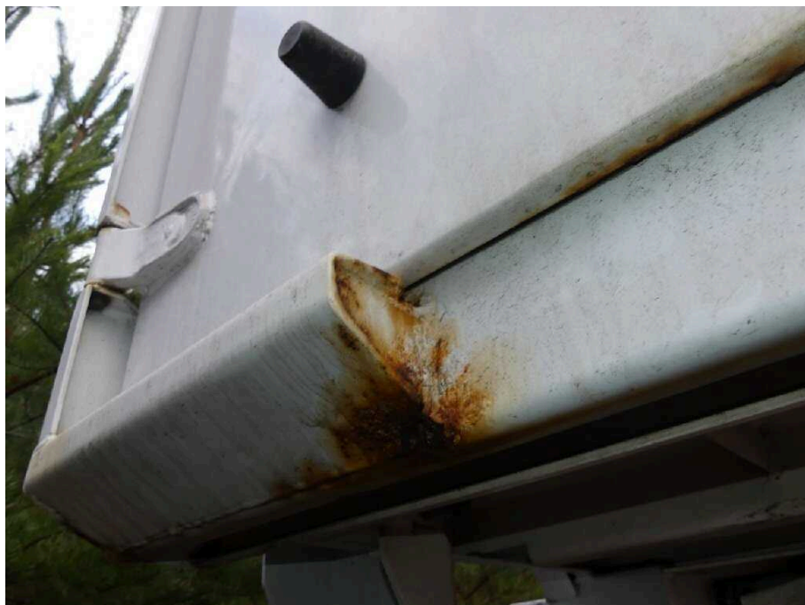
Bild 17 Fahrzeugheck Rahmen hinten links stark korrodiert
