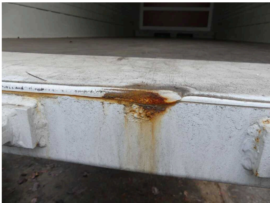
Bild 26 Fahrzeugheck Rahmen hinten Mitte korrodiert
