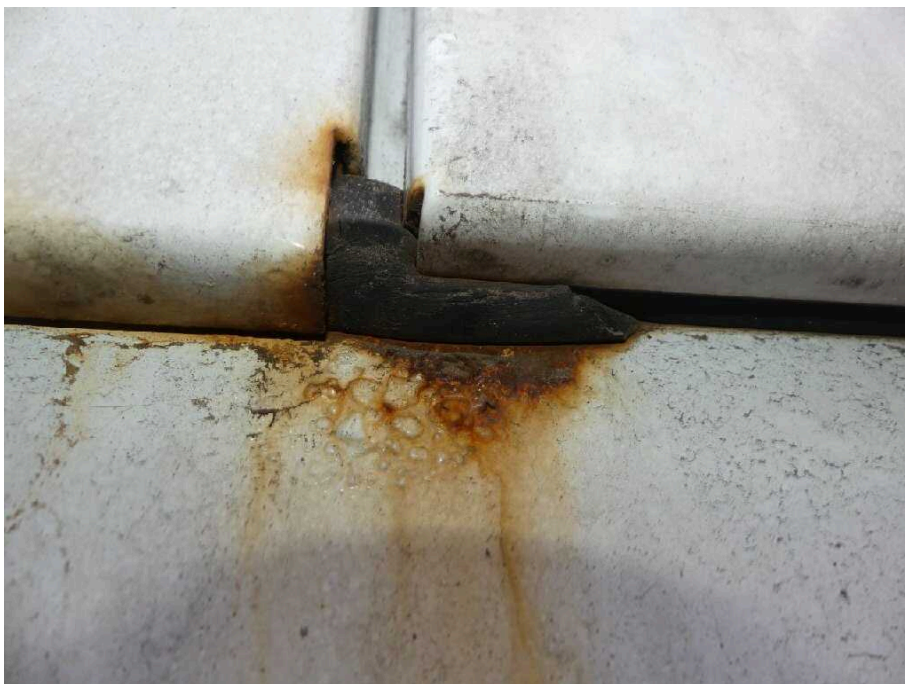
Bild 29 Fahrzeugheck Rahmen hinten Mitte korrodiert
