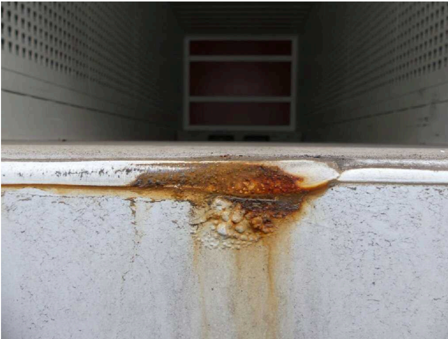
Bild 27 Fahrzeugheck Rahmen hinten Mitte korrodiert
