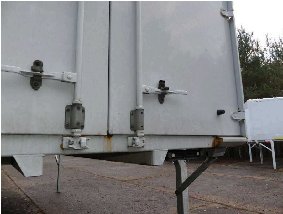
Bild 28 Fahrzeugheck Rahmen hinten Mitte korrodiert
