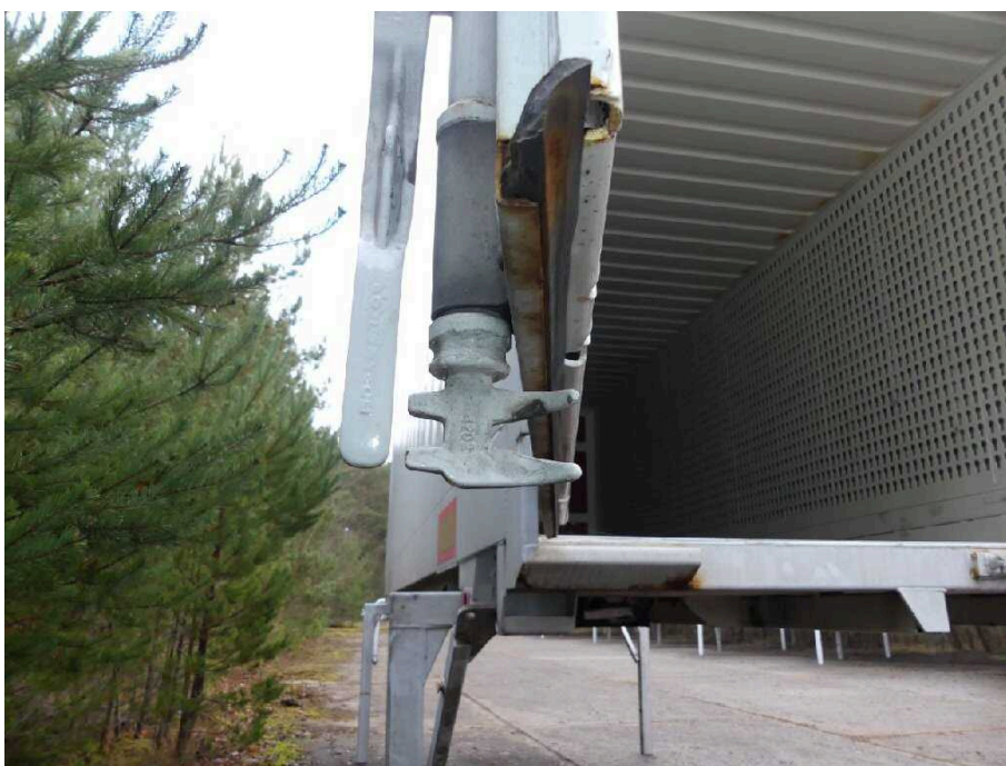
Bild 30 Fahrzeugheck Heckflügeltür links korrodiert
