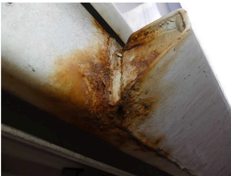
Bild 22 Fahrzeugheck Rahmen hinten rechts stark korrodiert
