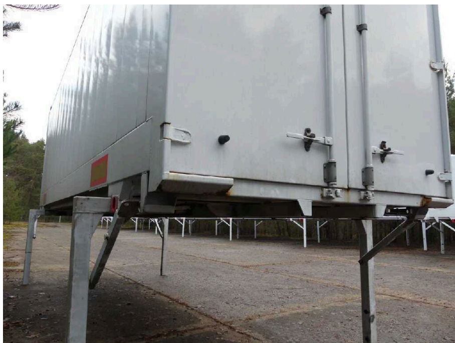
Bild 15 Fahrzeugheck Rahmen hinten links stark korrodiert
