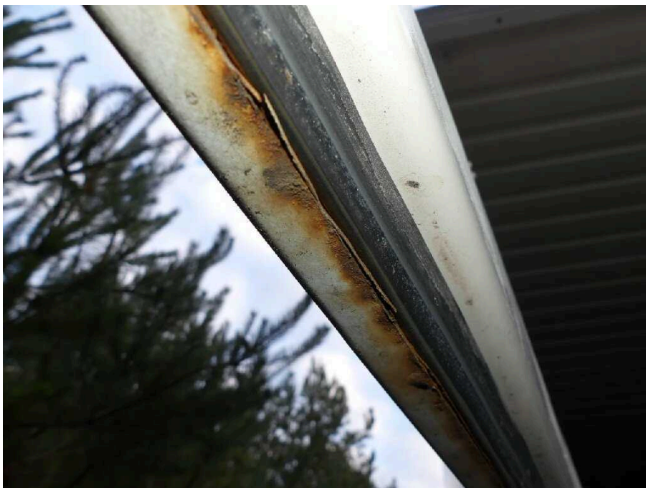
Bild 33 Fahrzeugheck Heckflügeltür links korrodiert
