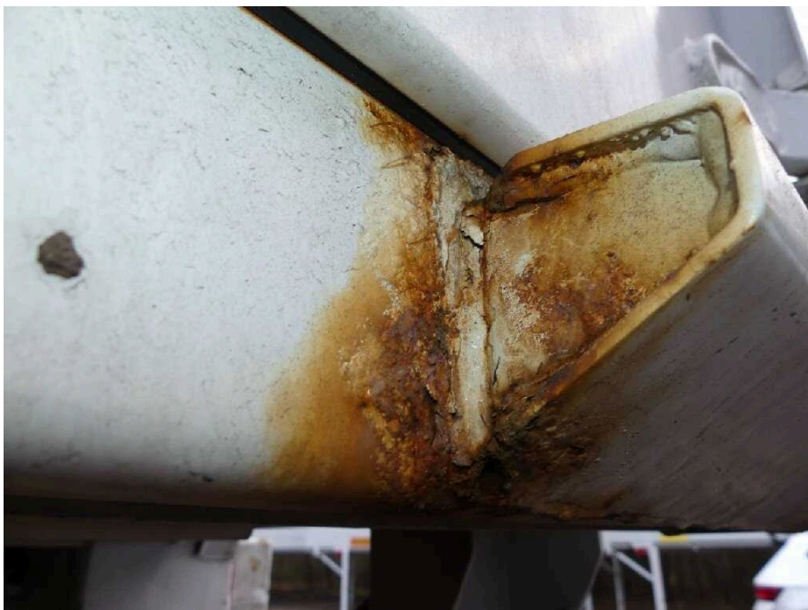
Bild 21 Fahrzeugheck Rahmen hinten rechts stark korrodiert
