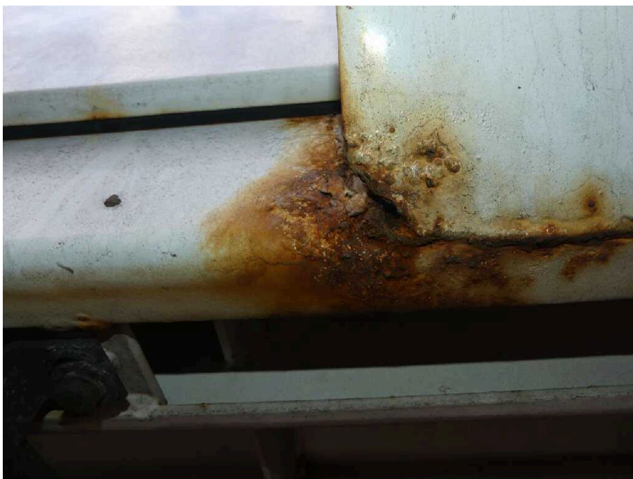
Bild 24 Fahrzeugheck Rahmen hinten rechts stark korrodiert
