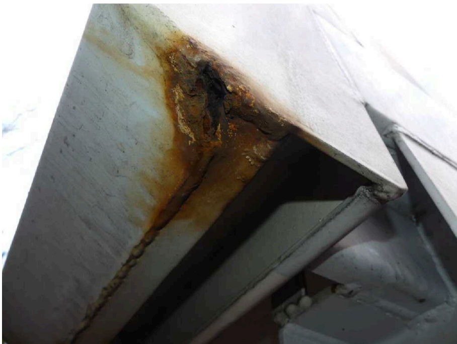
Bild 23 Fahrzeugheck Rahmen hinten rechts stark korrodiert
