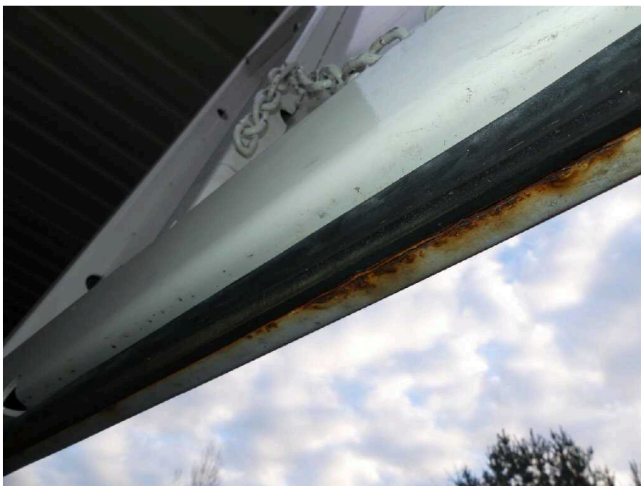
Bild 36 Fahrzeugheck Heckflügeltür rechts korrodiert
