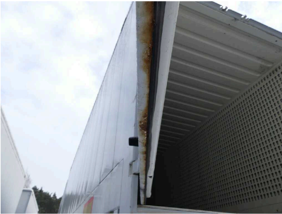
Bild 31 Fahrzeugheck Heckflügeltür links stark korrodiert
