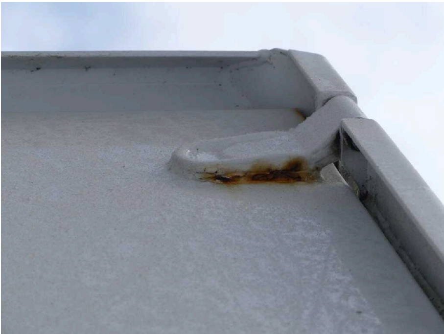
Bild 46 Fahrzeugheck Heckflügeltür rechts stark korrodiert
