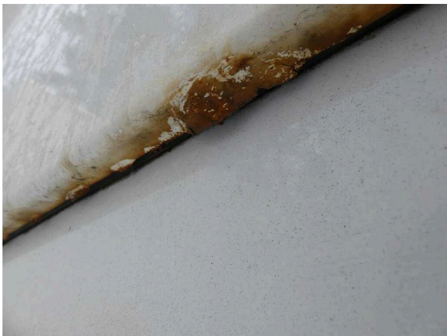
Bild 23 Fahrzeugheck Heckflügeltür links stark korrodiert
