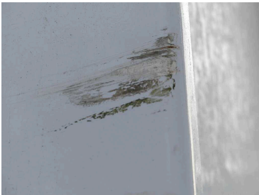
Bild 42 Fahrzeugheck Ecksäule hinten links verschürft
