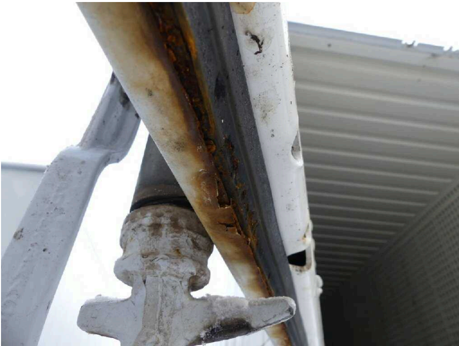
Bild 28 Fahrzeugheck Heckflügeltür links stark korrodiert
