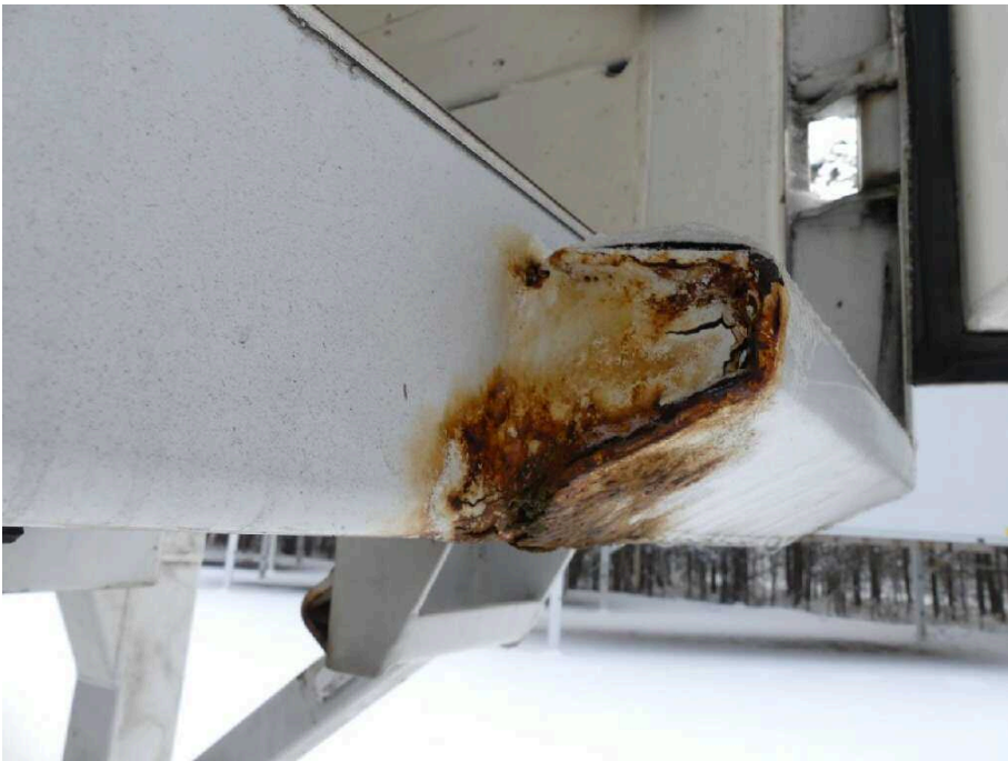
Bild 18 Fahrzeugheck Rahmen hinten hinten rechts stark korrodiert
