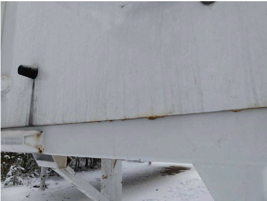
Bild 22 Fahrzeugheck Heckflügeltür links stark korrodiert
