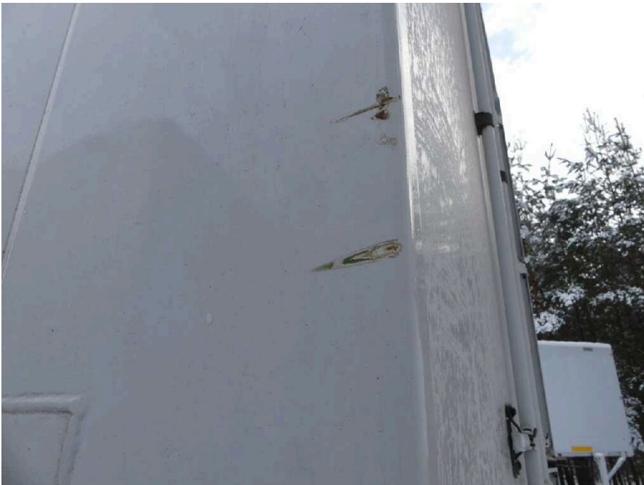
Bild 36 Fahrzeugheck Ecksäule hinten links verschürft
