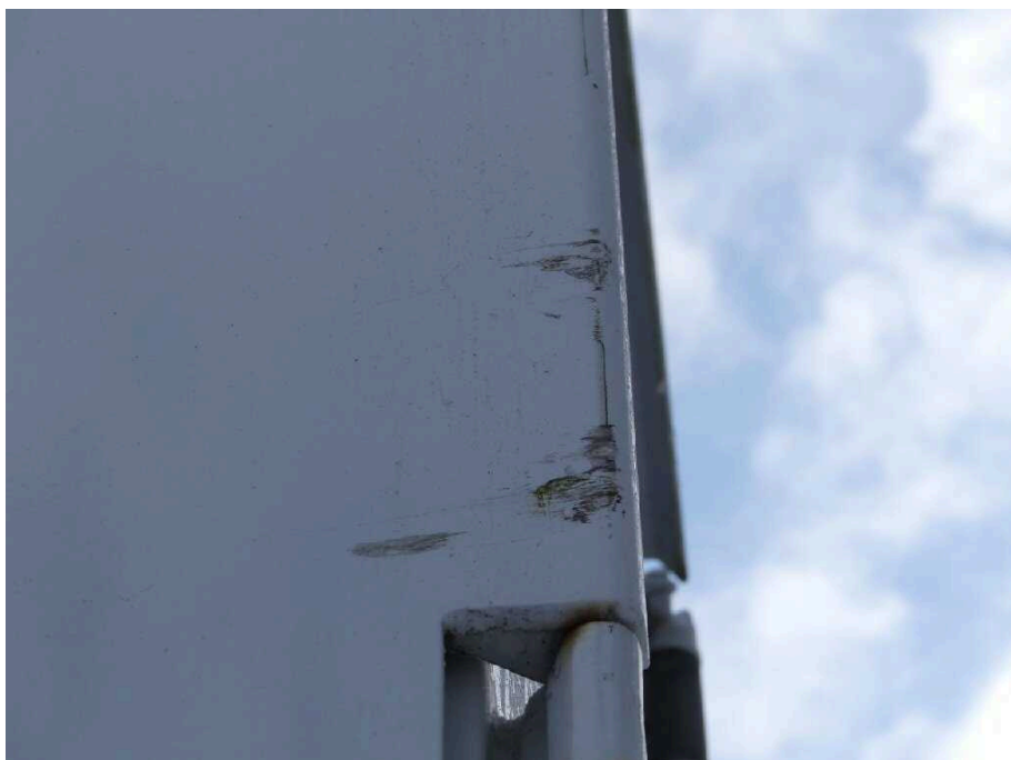
Bild 39 Fahrzeugheck Ecksäule hinten links verschürft
