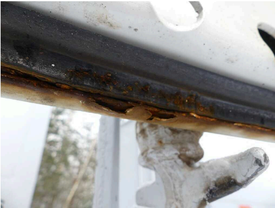
Bild 32 Fahrzeugheck Heckflügeltür links stark korrodiert
