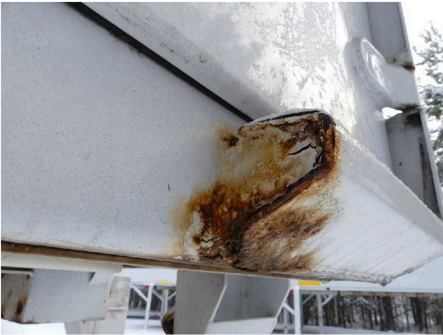
Bild 17 Fahrzeugheck Rahmen hinten hinten rechts stark korrodiert
