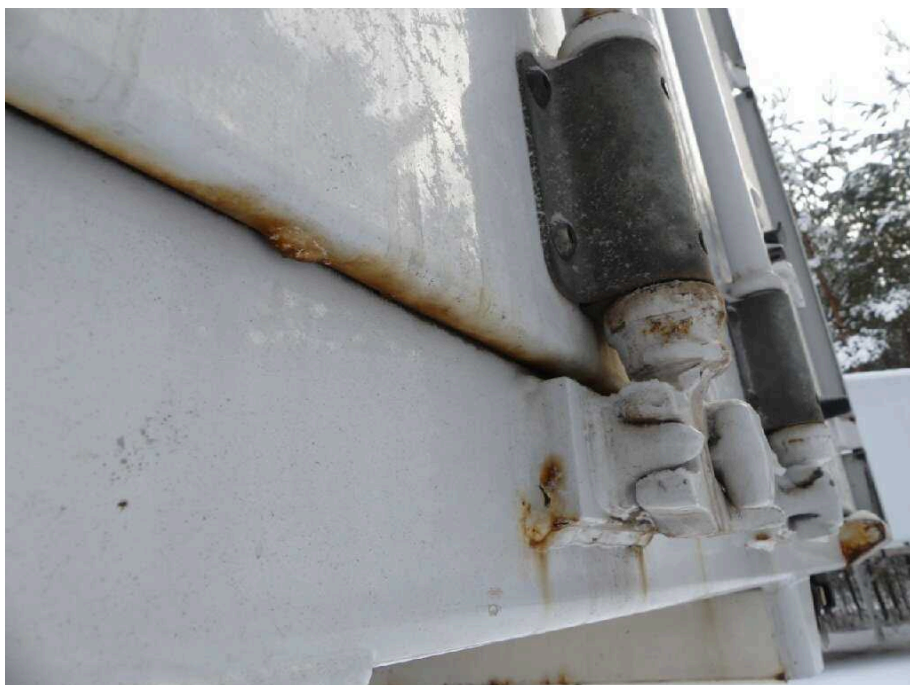
Bild 26 Fahrzeugheck Heckflügeltür links stark korrodiert
