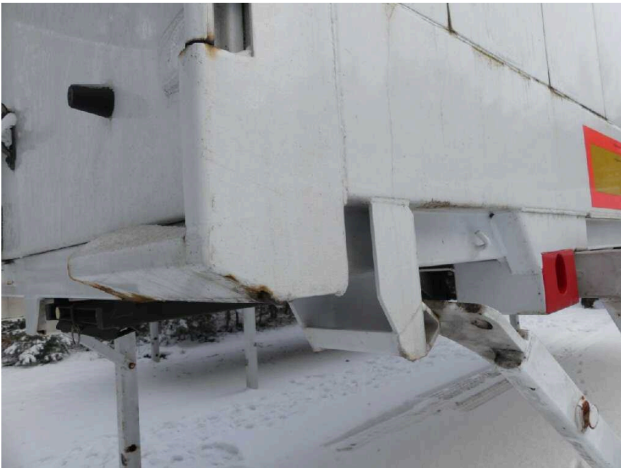
Bild 16 Fahrzeugheck Rahmen hinten hinten rechts stark korrodiert
