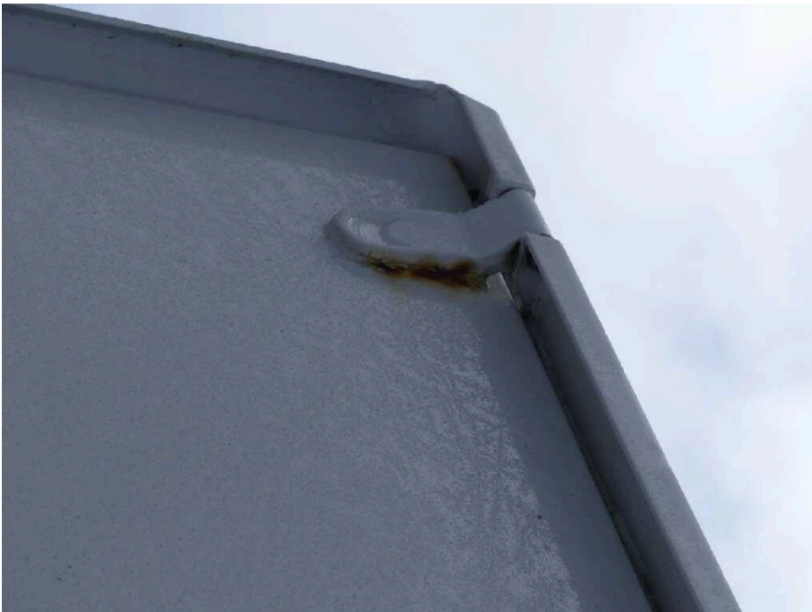
Bild 45 Fahrzeugheck Heckflügeltür rechts stark korrodiert
