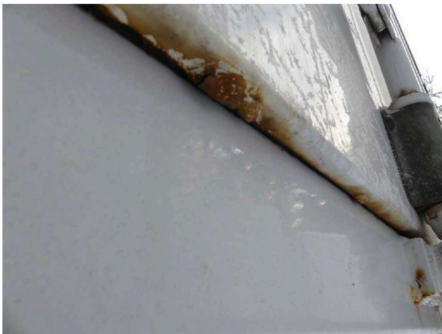
Bild 24 Fahrzeugheck Heckflügeltür links stark korrodiert
