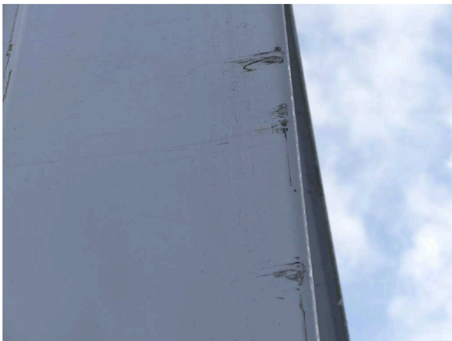
Bild 40 Fahrzeugheck Ecksäule hinten links verschürft
