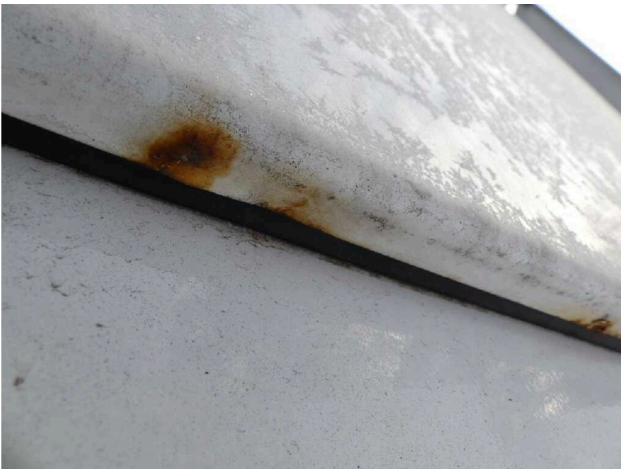
Bild 44 Fahrzeugheck Heckflügeltür rechts stark korrodiert
