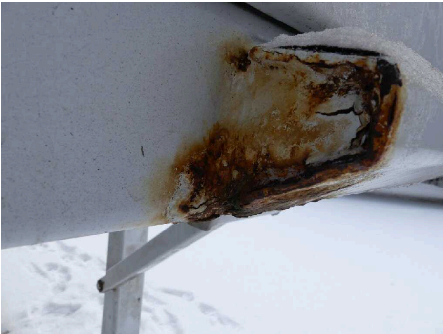
Bild 15 Fahrzeugheck Rahmen hinten hinten rechts stark korrodiert
