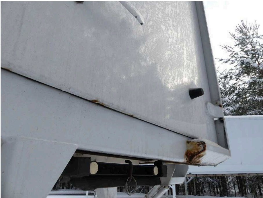
Bild 43 Fahrzeugheck Heckflügeltür rechts stark korrodiert
