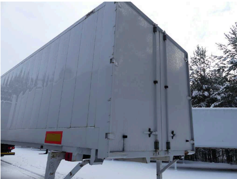
Bild 33 Fahrzeugheck Ecksäule hinten links verschürft
