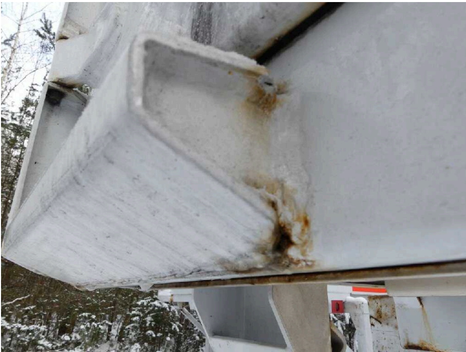
Bild 20 Fahrzeugheck Rahmen hinten hinten links korrodiert
