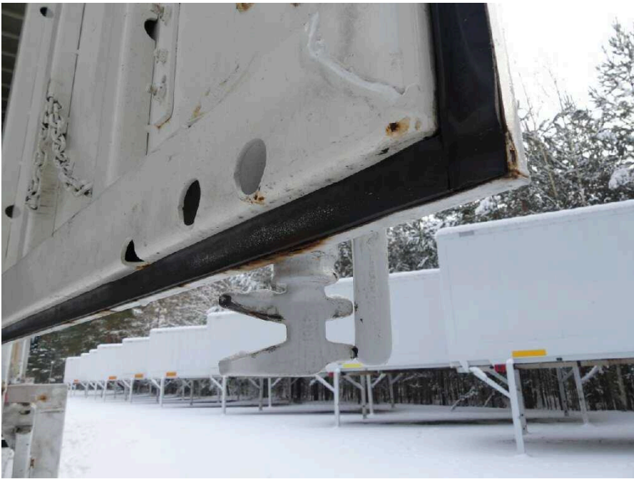
Bild 47 Fahrzeugheck Heckflügeltür rechts stark korrodiert
