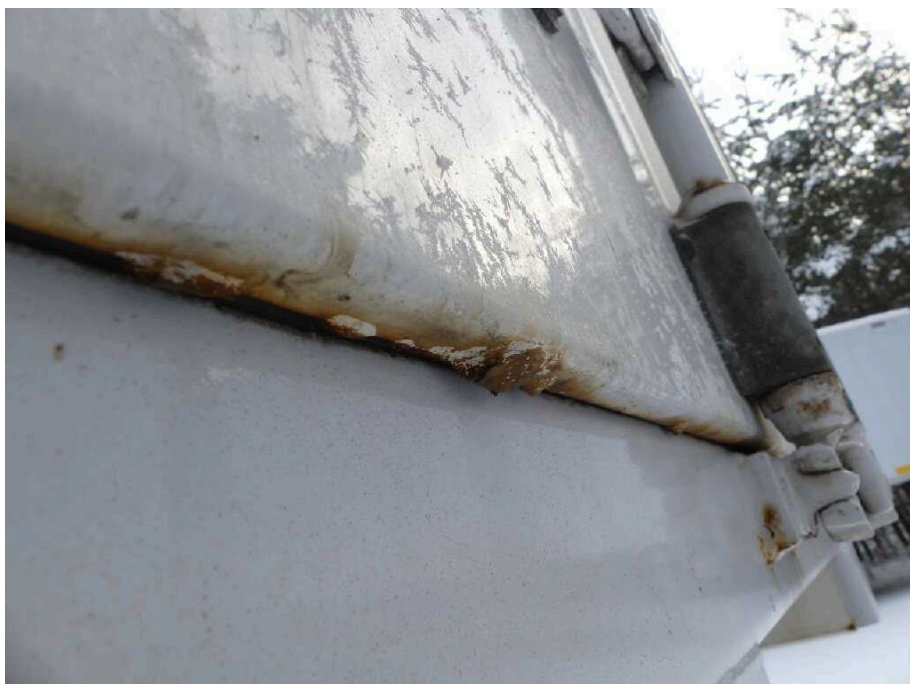
Bild 25 Fahrzeugheck Heckflügeltür links stark korrodiert
