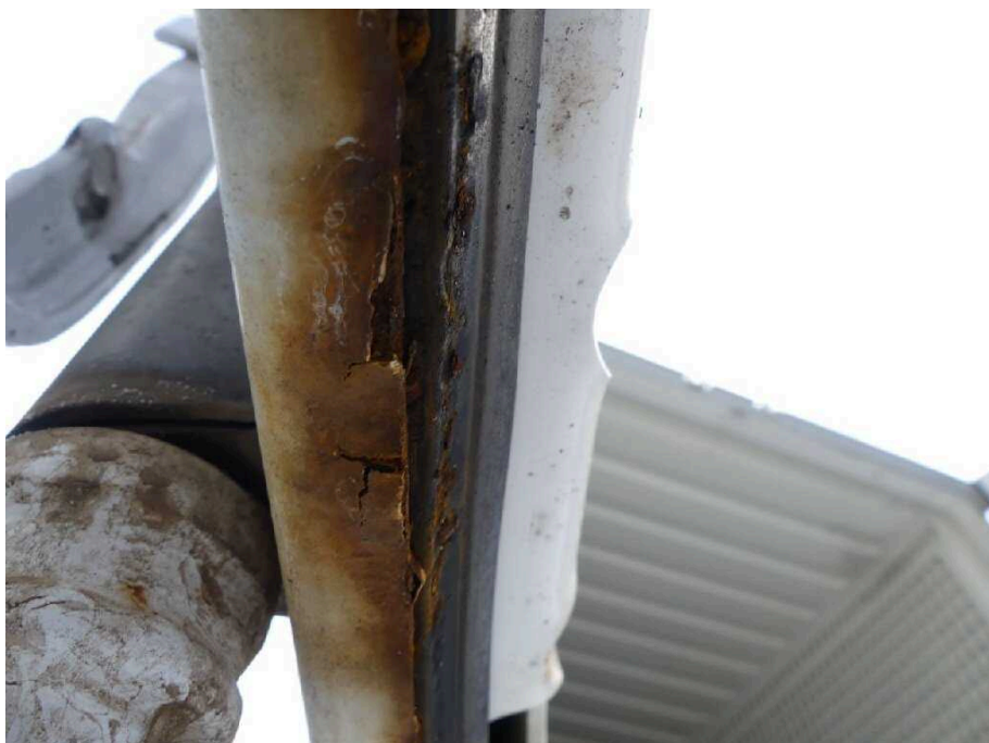
Bild 29 Fahrzeugheck Heckflügeltür links stark korrodiert
