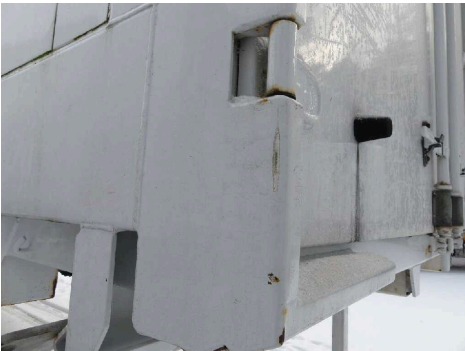
Bild 34 Fahrzeugheck Ecksäule hinten links verschürft
