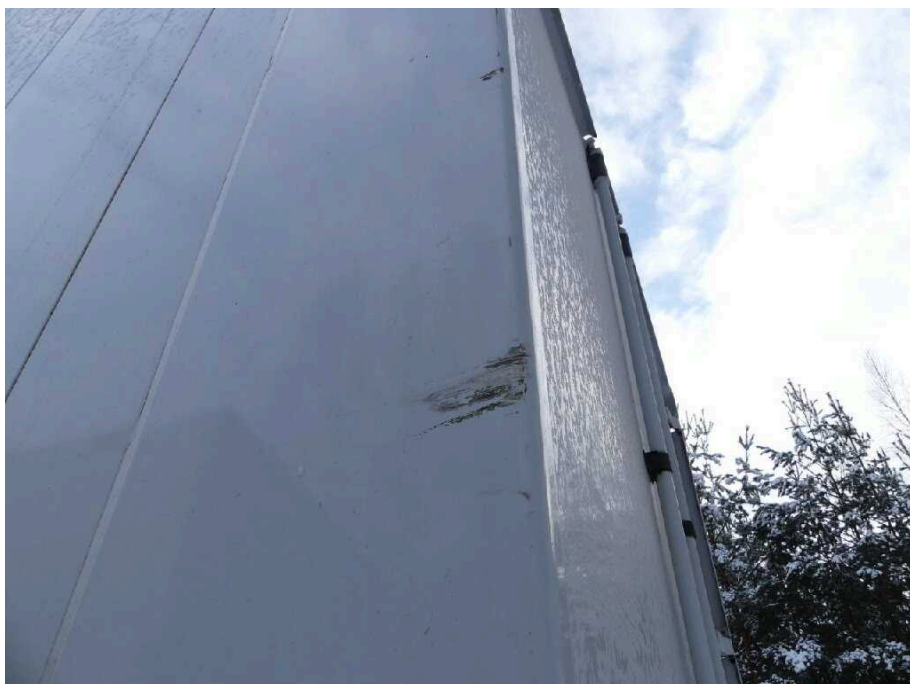
Bild 37 Fahrzeugheck Ecksäule hinten links verschürft
