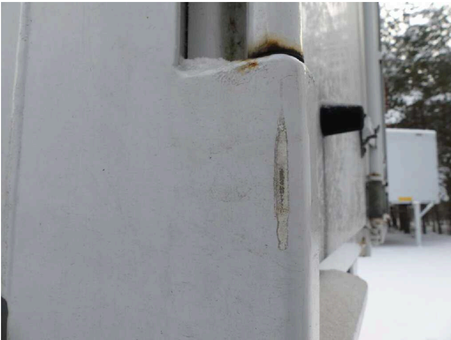
Bild 35 Fahrzeugheck Ecksäule hinten links verschürft
