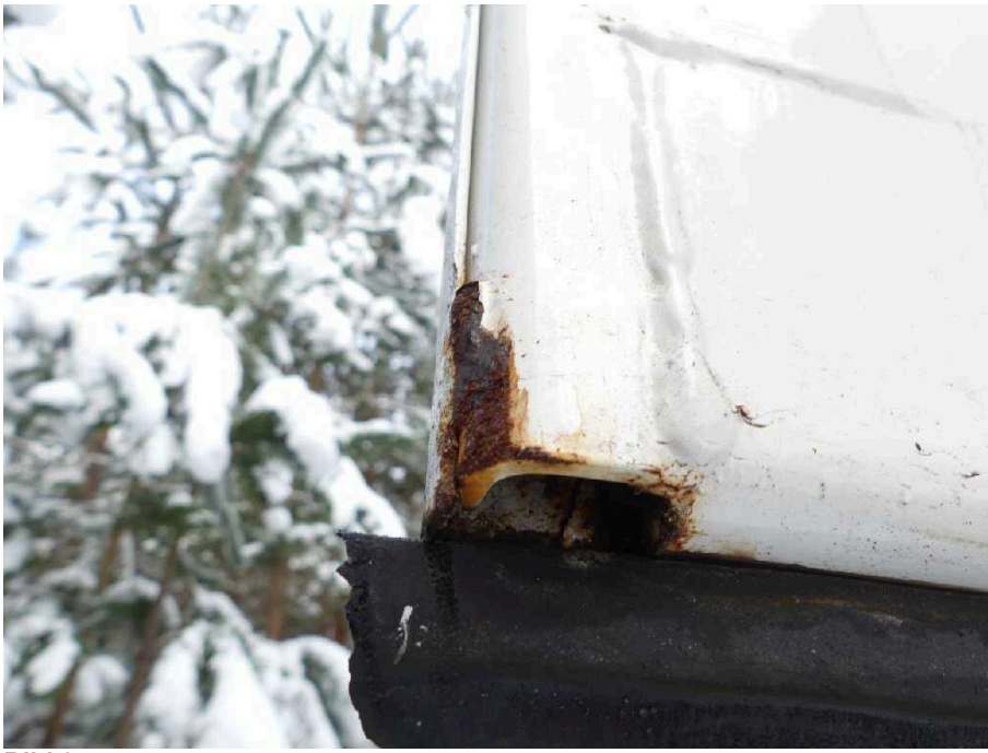
Bild 37 Fahrzeugheck Heckflügeltür links korrodiert
