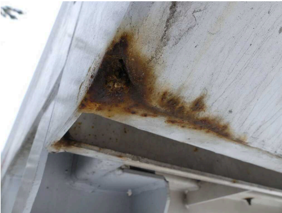
Bild 30 Fahrzeugheck Rahmen hinten hinten links stark korrodiert
