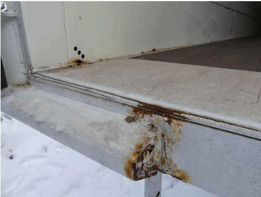
Bild 33 Fahrzeugheck Rahmen hinten hinten links stark korrodiert
