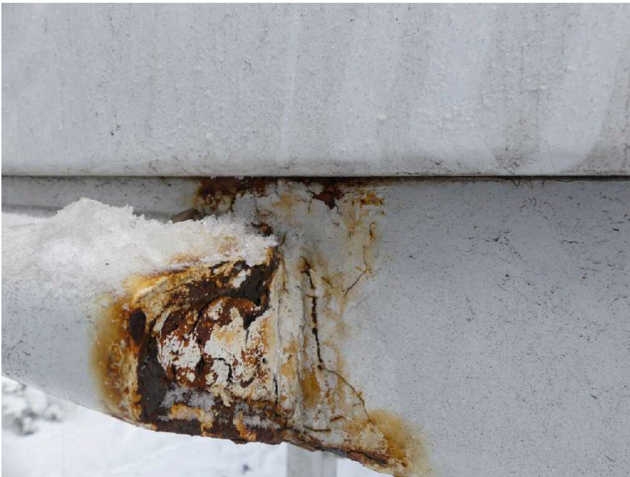
Bild 31 Fahrzeugheck Rahmen hinten hinten links stark korrodiert
