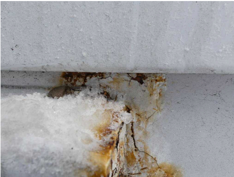
Bild 32 Fahrzeugheck Rahmen hinten hinten links stark korrodiert
