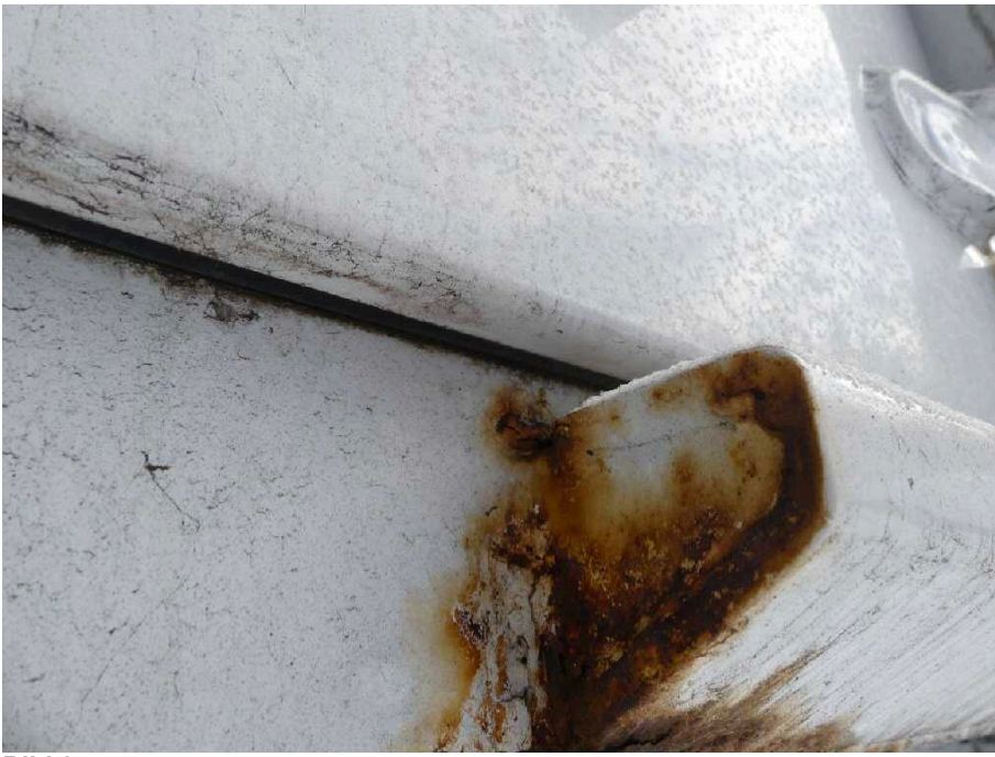
Bild 25 Fahrzeugheck Rahmen hinten hinten rechts stark korrodiert
