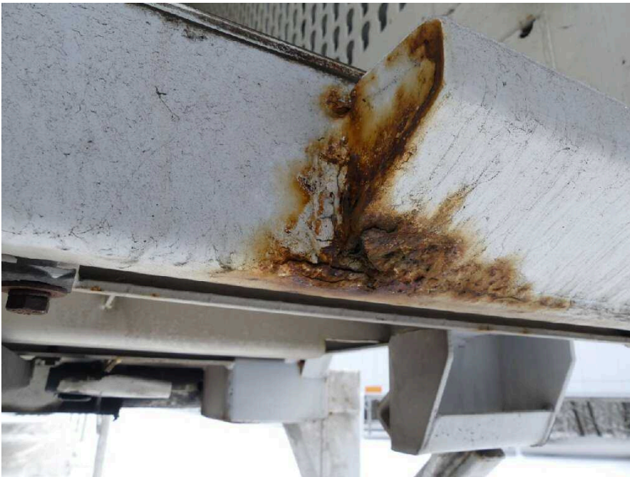
Bild 27 Fahrzeugheck Rahmen hinten hinten rechts stark korrodiert
