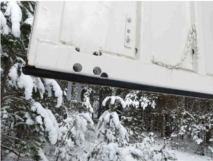
Bild 34 Fahrzeugheck Heckflügeltür links korrodiert
