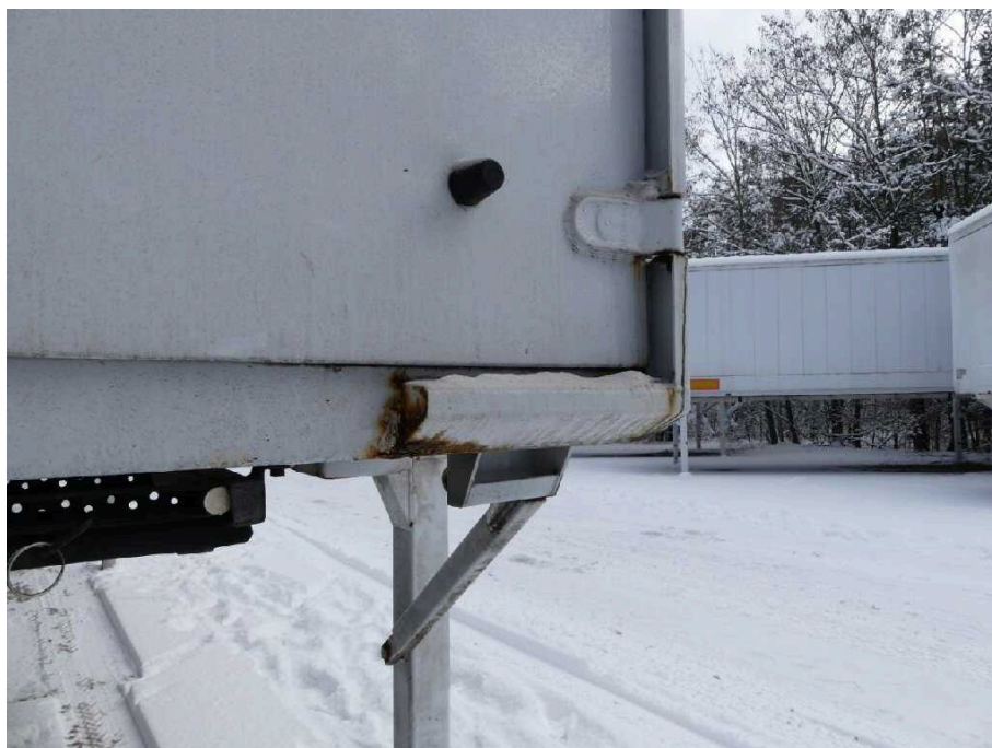
Bild 23 Fahrzeugheck Rahmen hinten hinten rechts stark korrodiert
