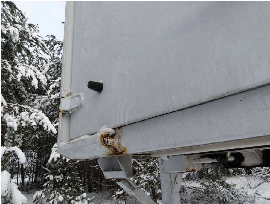
Bild 28 Fahrzeugheck Rahmen hinten hinten links stark korrodiert
