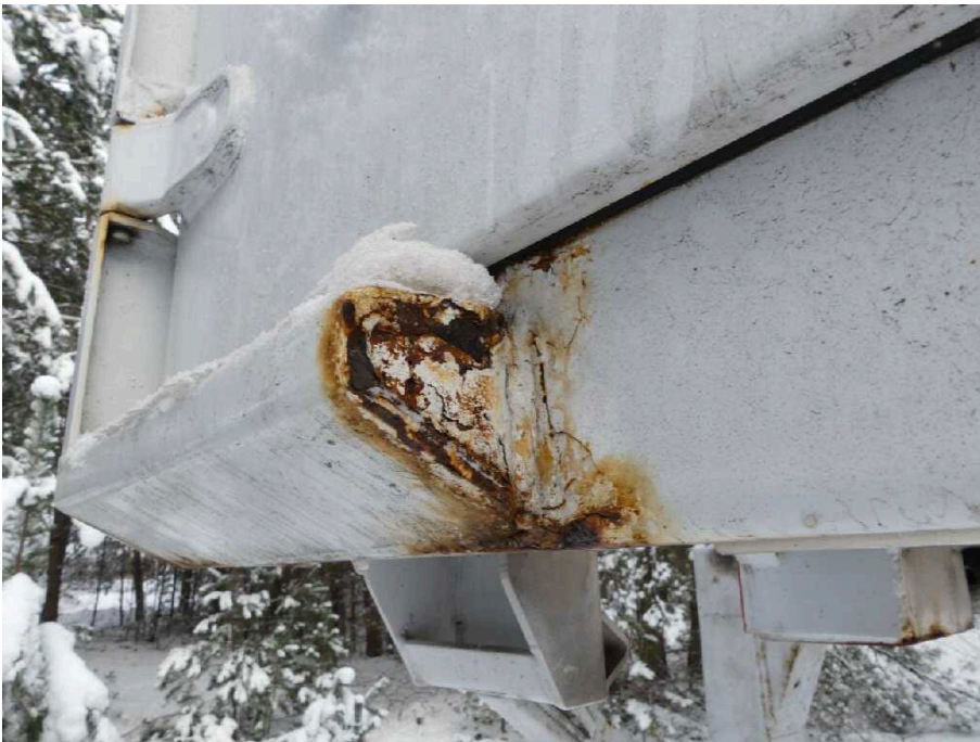
Bild 29 Fahrzeugheck Rahmen hinten hinten links stark korrodiert
