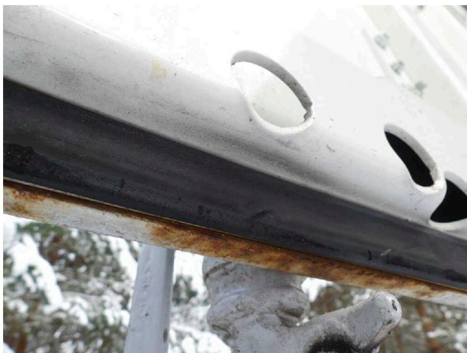
Bild 36 Fahrzeugheck Heckflügeltür links korrodiert
