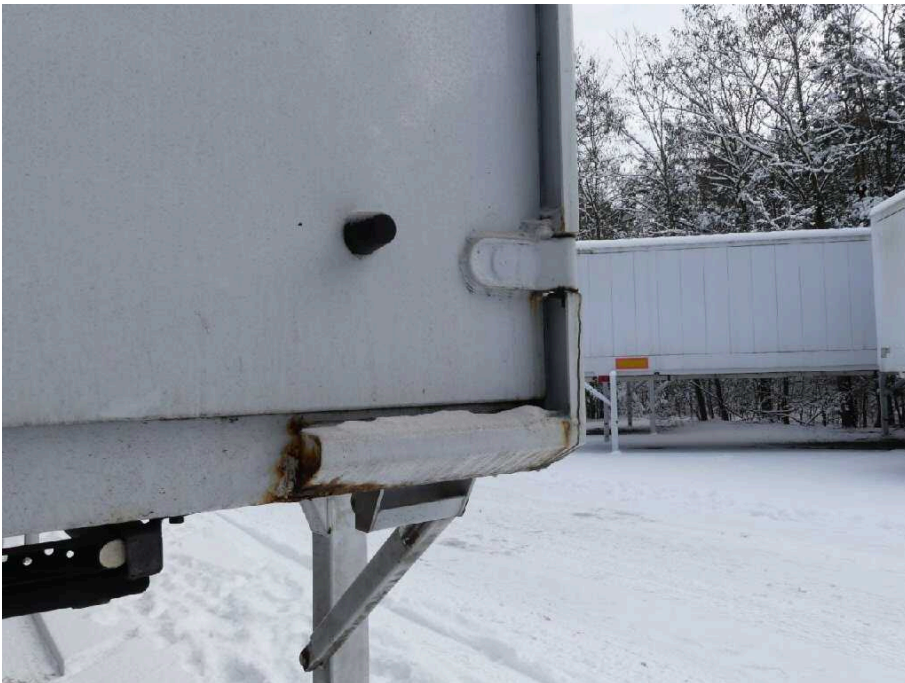
Bild 26 Fahrzeugheck Rahmen hinten hinten rechts stark korrodiert
