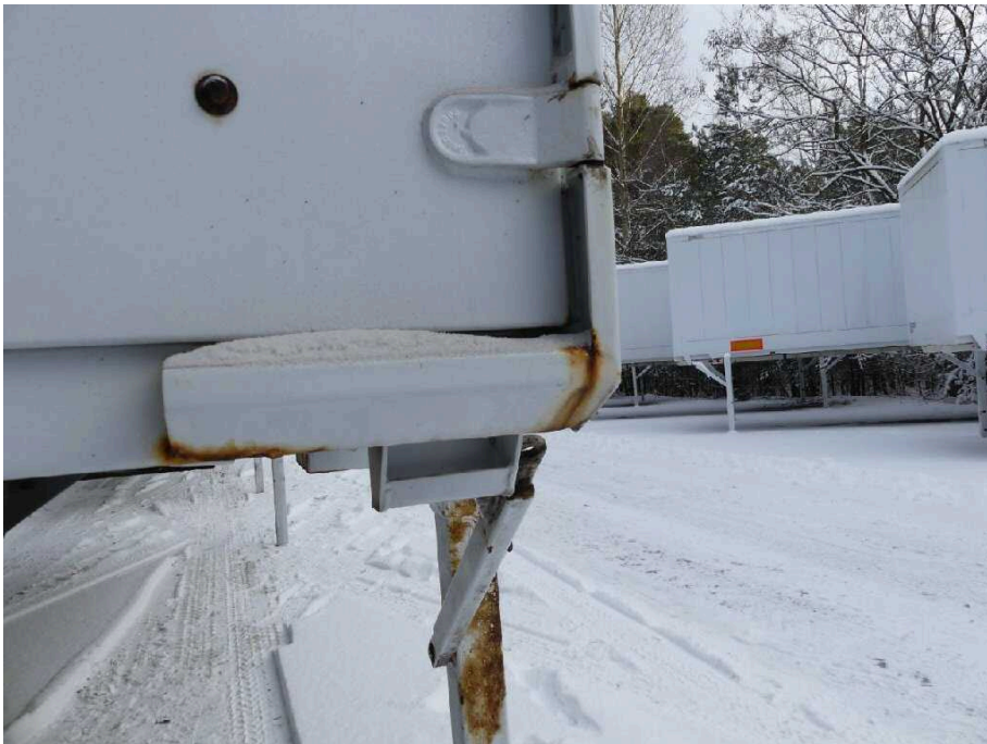
Bild 23 Fahrzeugheck Rahmen hinten rechts stark korrodiert
