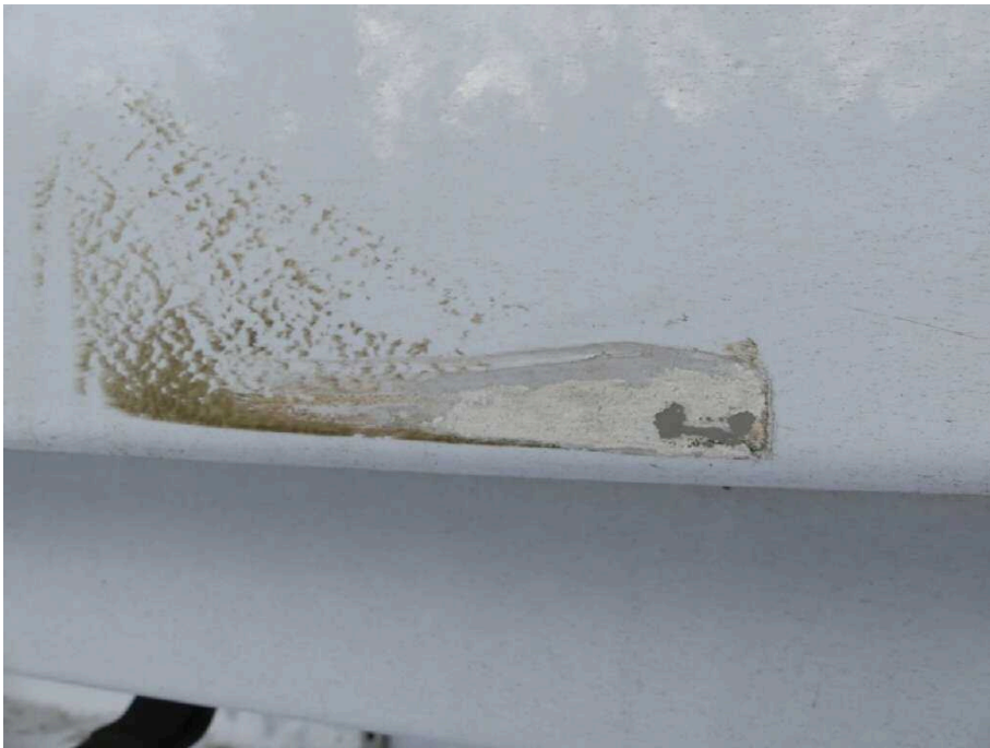
Bild 12 Aufbau Kofferseitenwand rechts hinten verkratzt
