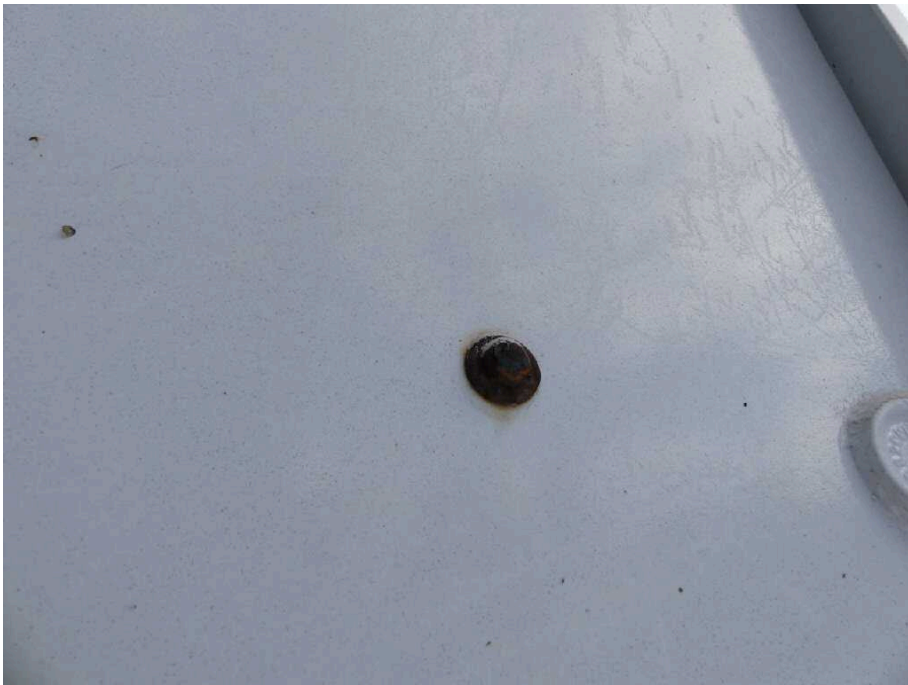
Bild 36 Fahrzeugheck Heckflügeltür rechts Anschlaggummi fehlt
