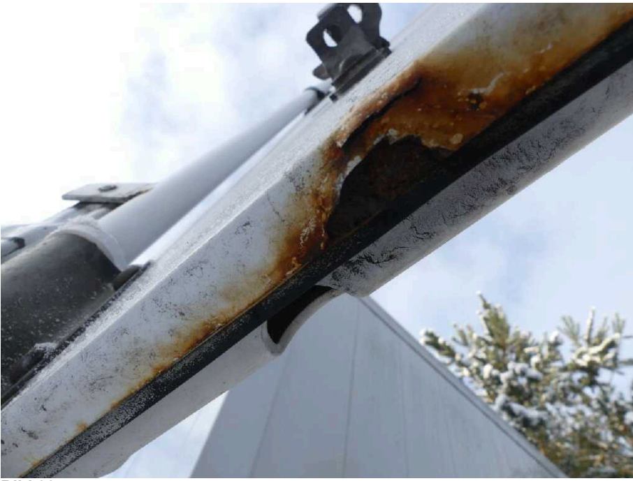
Bild 33 Fahrzeugheck Heckflügeltür rechts stark korrodiert
