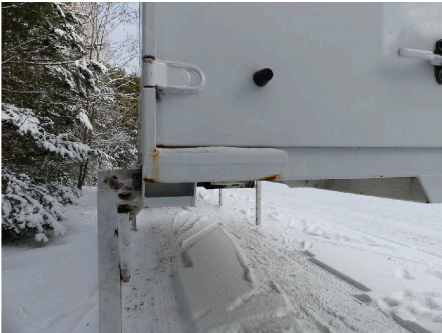
Bild 15 Fahrzeugheck Rahmen hinten links stark korrodiert
