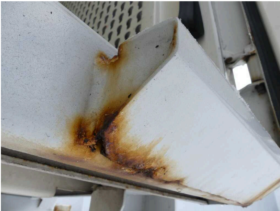
Bild 26 Fahrzeugheck Rahmen hinten rechts stark korrodiert
