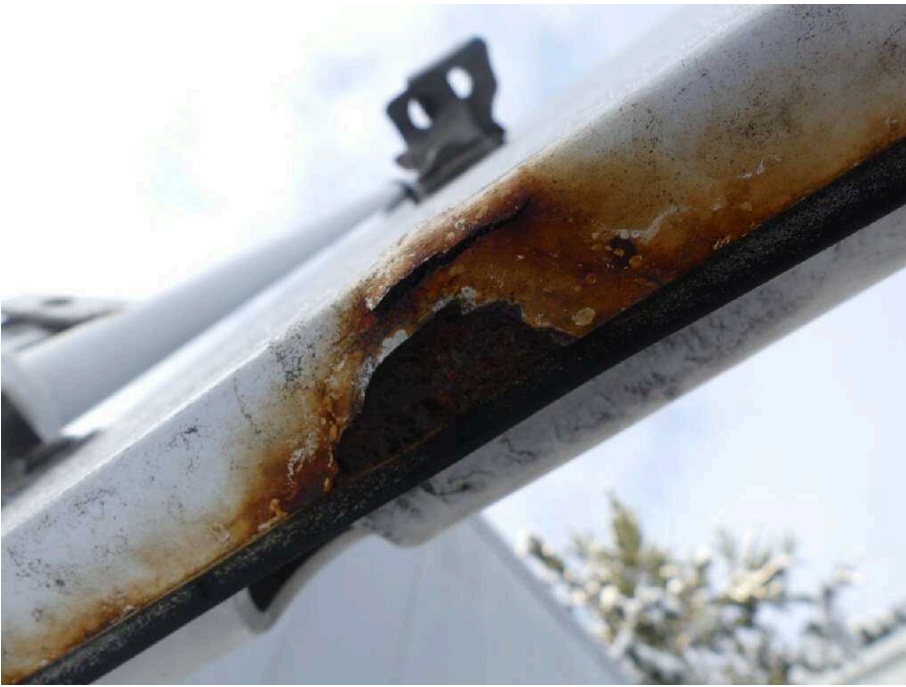
Bild 34 Fahrzeugheck Heckflügeltür rechts stark korrodiert
