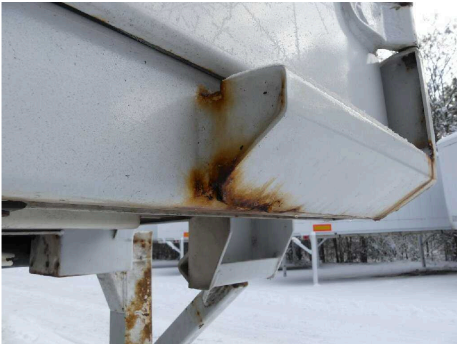
Bild 21 Fahrzeugheck Rahmen hinten rechts stark korrodiert
