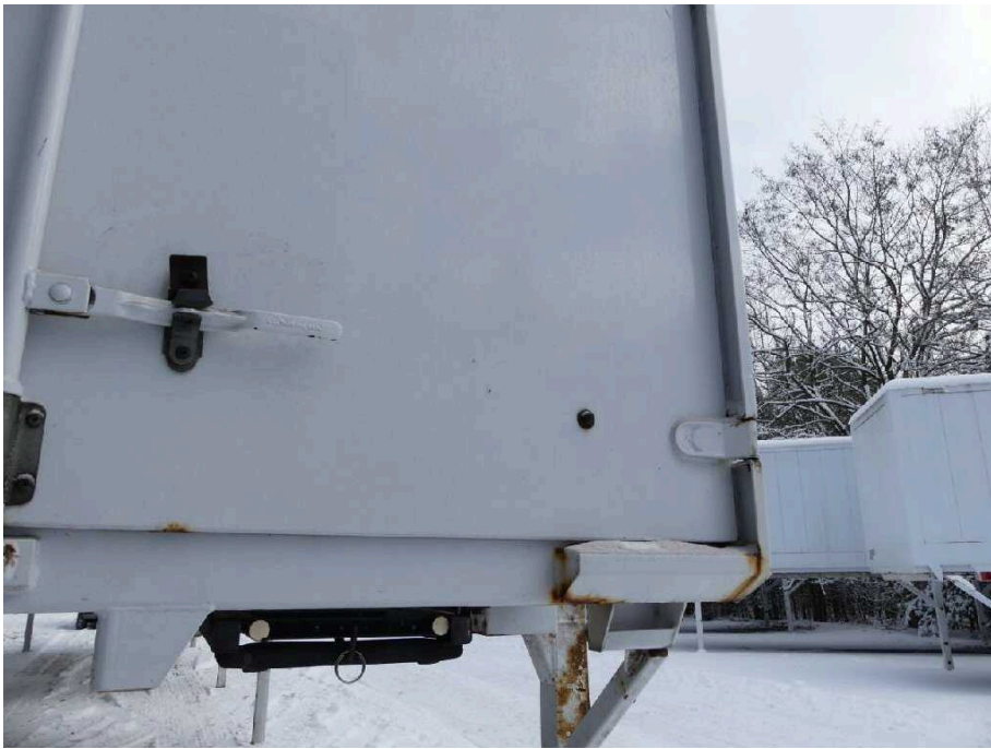
Bild 35 Fahrzeugheck Heckflügeltür rechts Anschlaggummi fehlt
