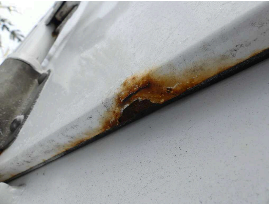
Bild 32 Fahrzeugheck Heckflügeltür rechts stark korrodiert
