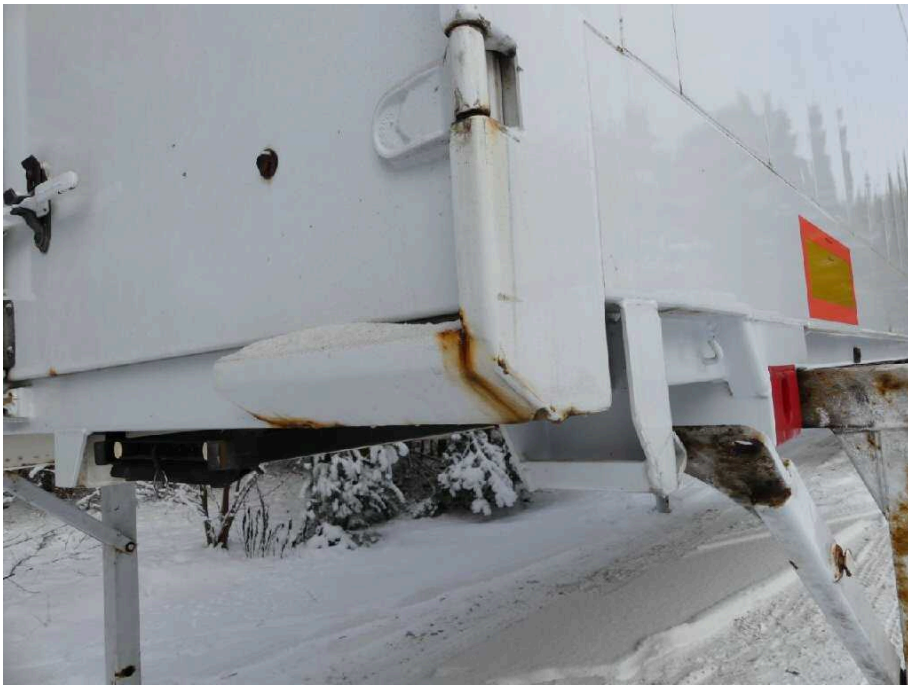
Bild 24 Fahrzeugheck Rahmen hinten rechts stark korrodiert
