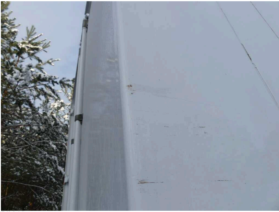
Bild 39 Aufbau Kofferseitenwand rechts hinten verkratzt
