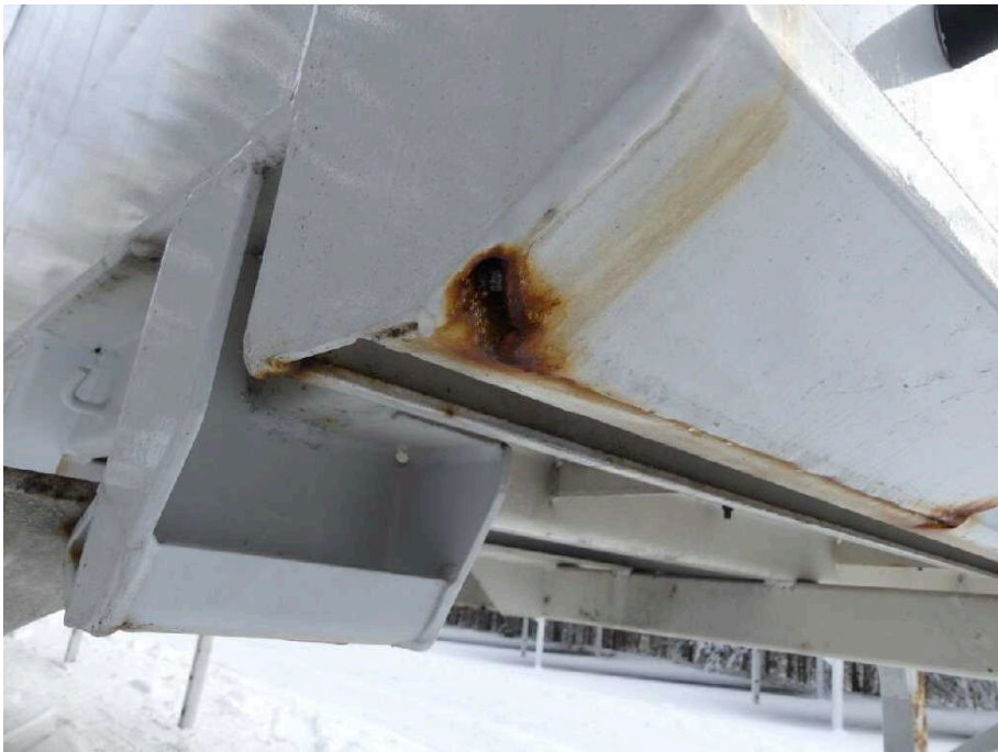
Bild 16 Fahrzeugheck Rahmen hinten links stark korrodiert
