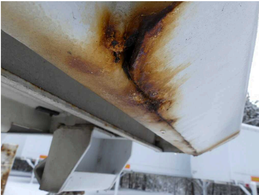
Bild 22 Fahrzeugheck Rahmen hinten rechts stark korrodiert
