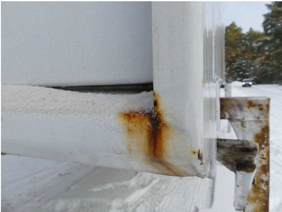
Bild 25 Fahrzeugheck Rahmen hinten rechts stark korrodiert
