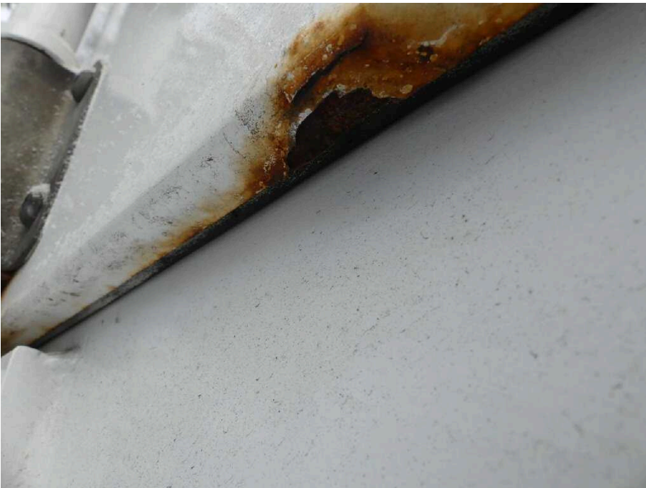
Bild 31 Fahrzeugheck Heckflügeltür rechts stark korrodiert
