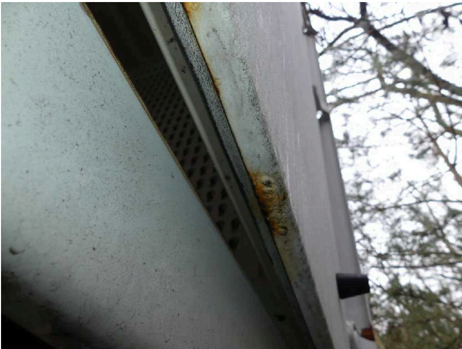
Bild 34 Fahrzeugheck Heckflügeltür rechts korrodiert
