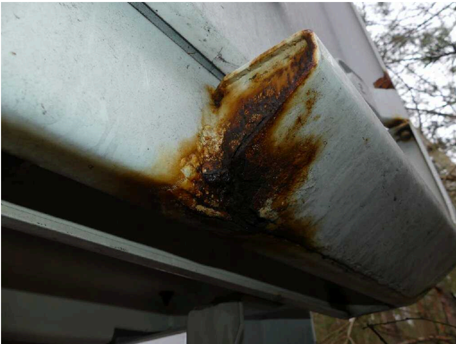
Bild 26 Fahrzeugheck Rahmen hinten rechts korrodiert
