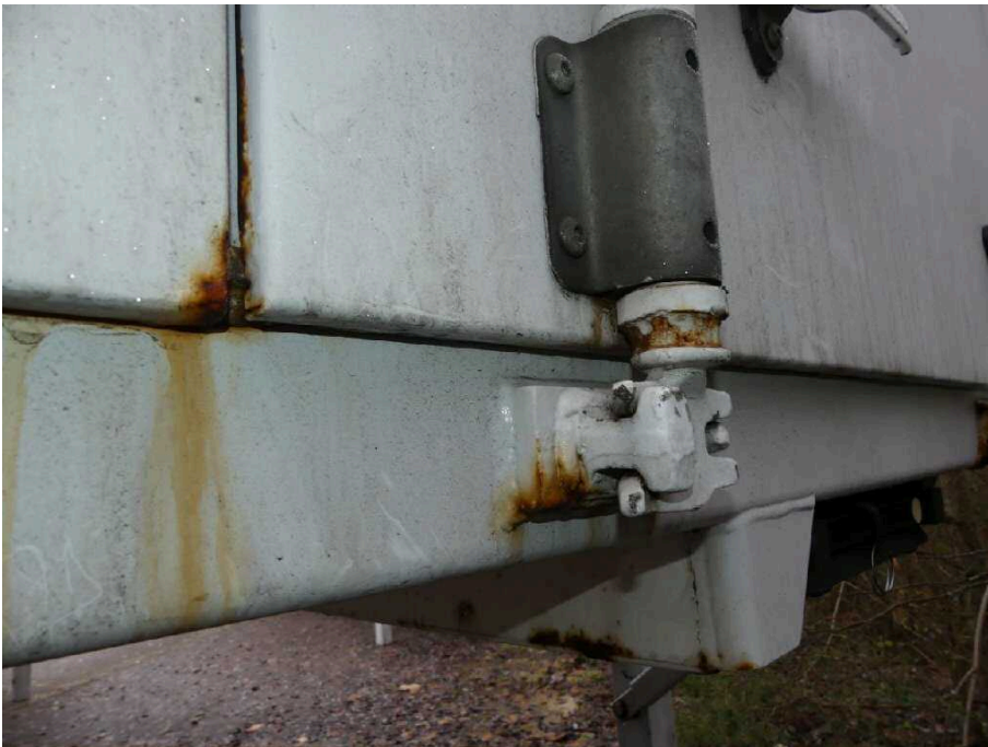
Bild 24 Fahrzeugheck Heckflügeltür links korrodiert
