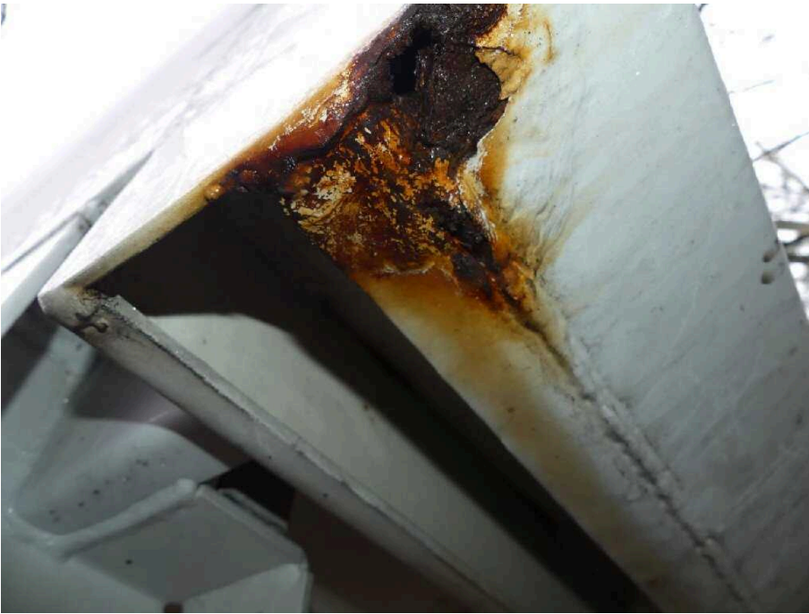
Bild 19 Fahrzeugheck Rahmen hinten links korrodiert
