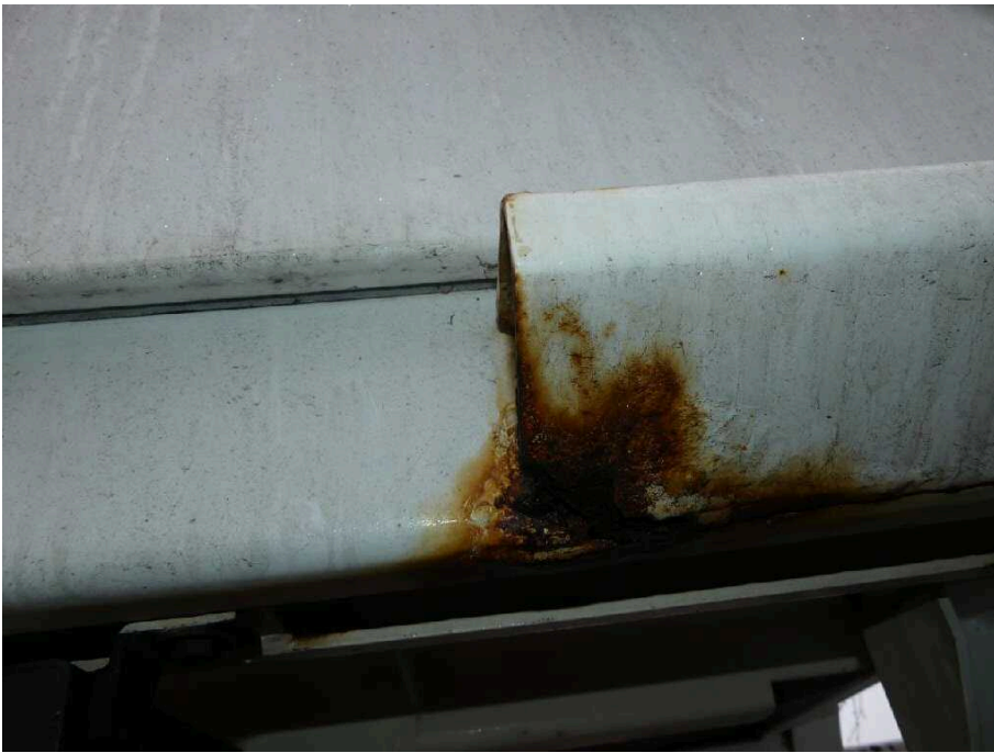
Bild 29 Fahrzeugheck Rahmen hinten rechts korrodiert
