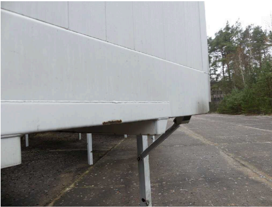
Bild 9 Aufbau Bodenrahmen vorne korrodiert
