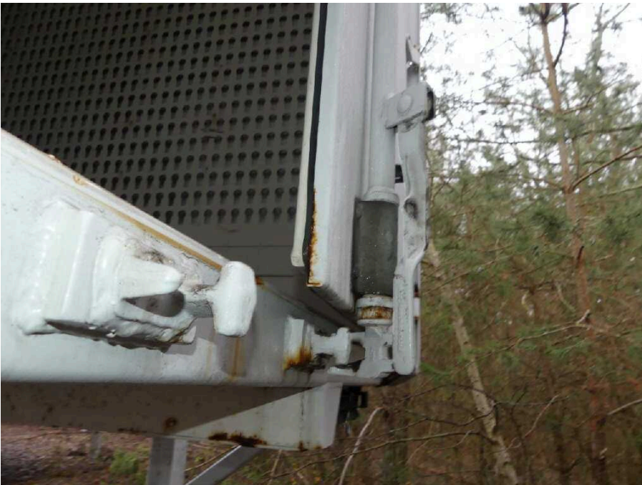
Bild 32 Fahrzeugheck Heckflügeltür rechts korrodiert
