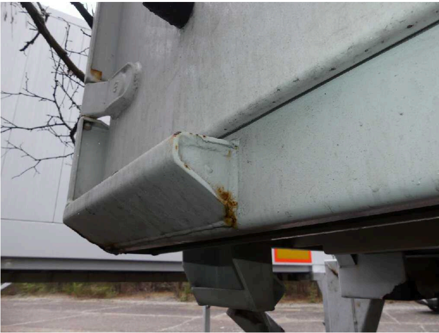
Bild 21 Fahrzeugheck Rahmen hinten links korrodiert
