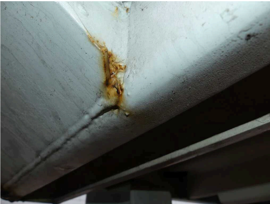
Bild 22 Fahrzeugheck Rahmen hinten links korrodiert
