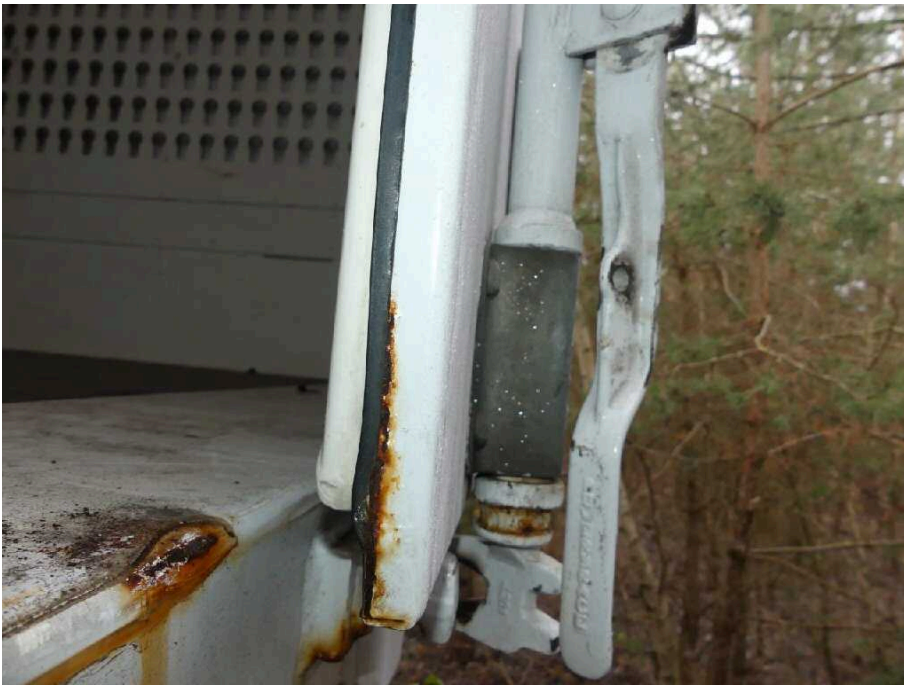
Bild 33 Fahrzeugheck Heckflügeltür rechts korrodiert
