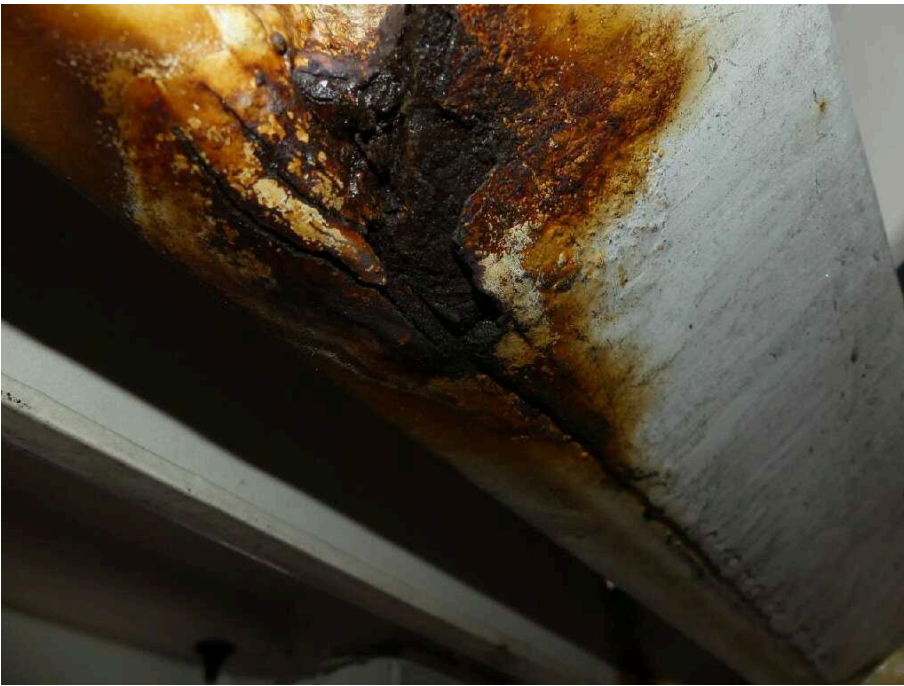
Bild 31 Fahrzeugheck Rahmen hinten rechts korrodiert
