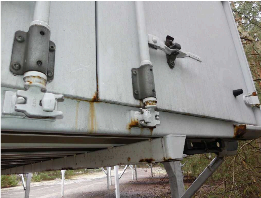
Bild 35 Fahrzeugheck Heckflügeltür rechts korrodiert
