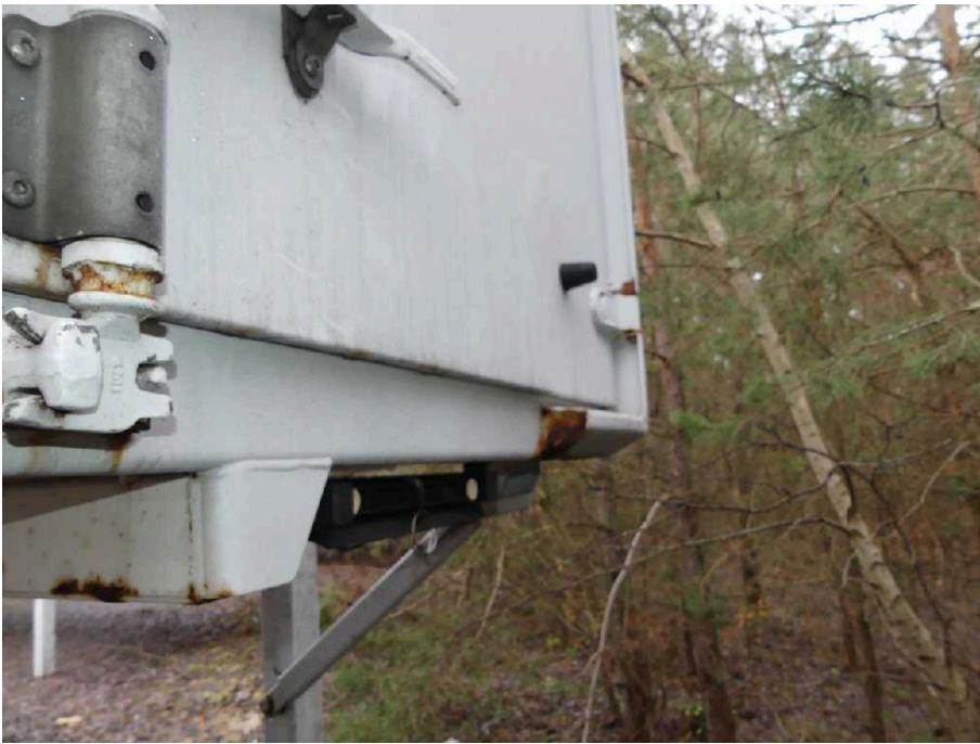
Bild 25 Fahrzeugheck Rahmen hinten rechts korrodiert
