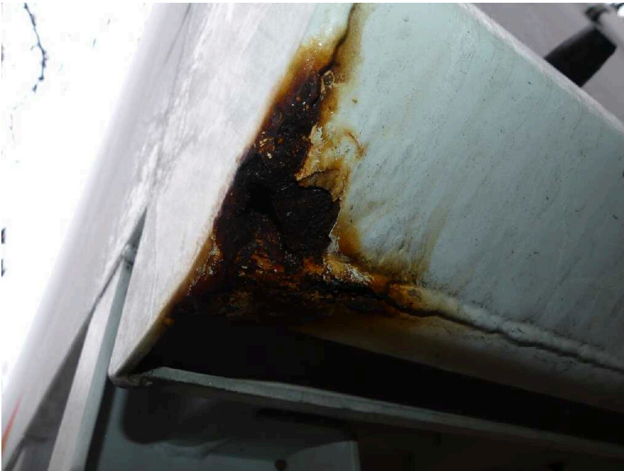
Bild 18 Fahrzeugheck Rahmen hinten links korrodiert
