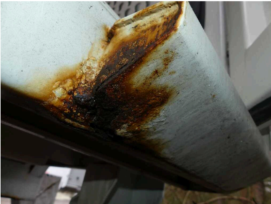
Bild 30 Fahrzeugheck Rahmen hinten rechts korrodiert
