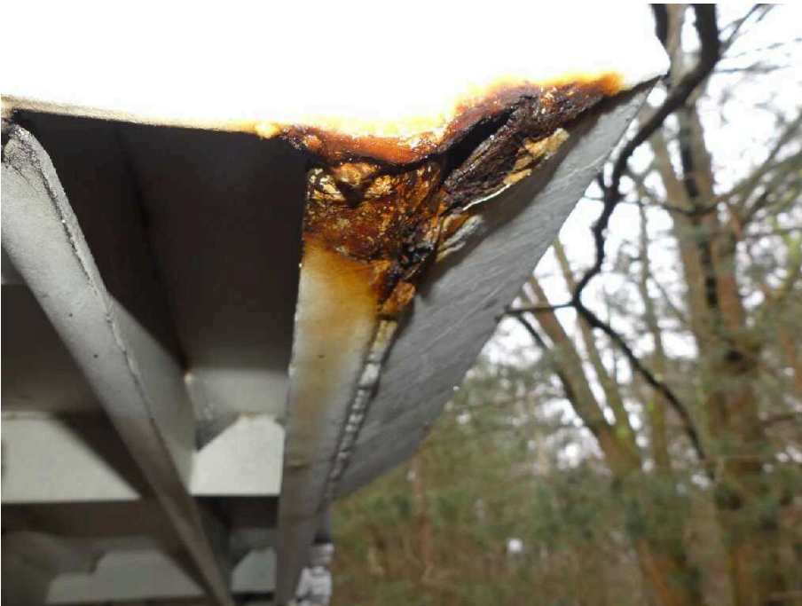
Bild 20 Fahrzeugheck Rahmen hinten links korrodiert
