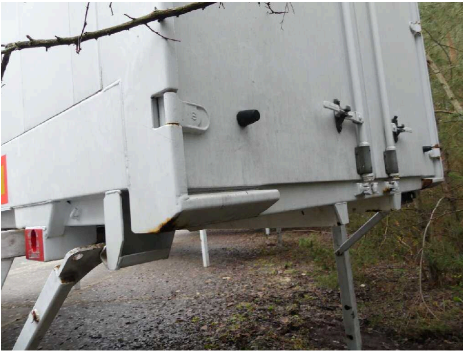
Bild 17 Fahrzeugheck Rahmen hinten links korrodiert
