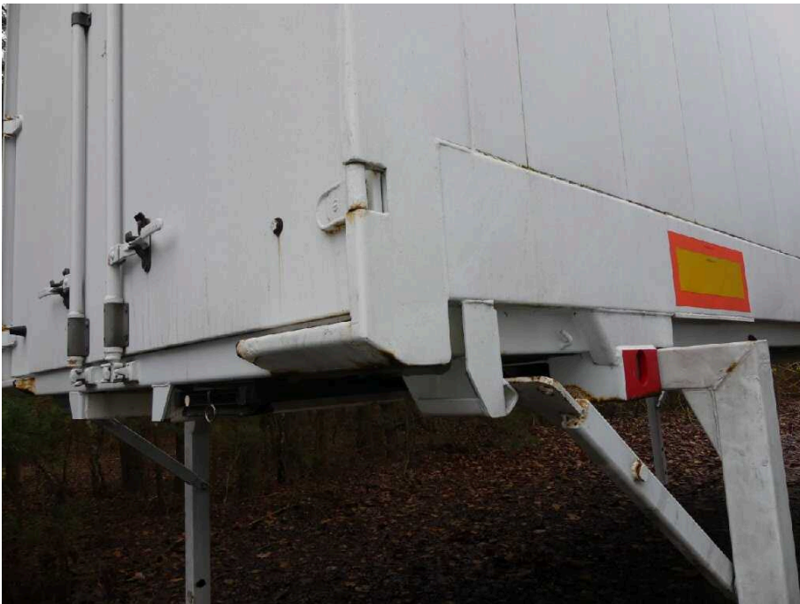
Bild 38 Fahrzeugheck Rahmen hinten rechts korrodiert
