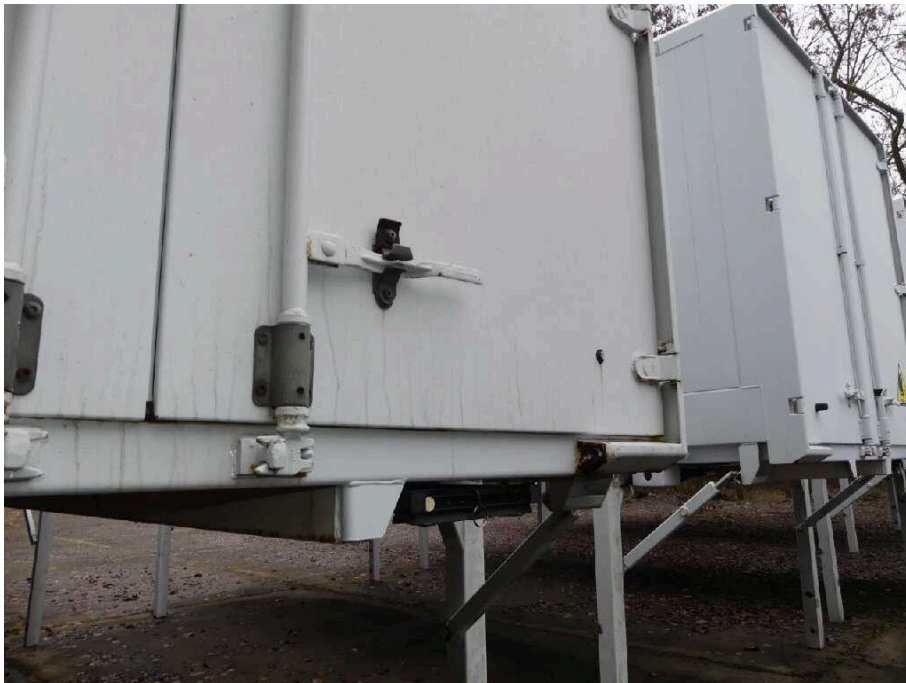
Bild 32 Fahrzeugheck Heckflügeltür rechts Anschlaggummi beschädigt
