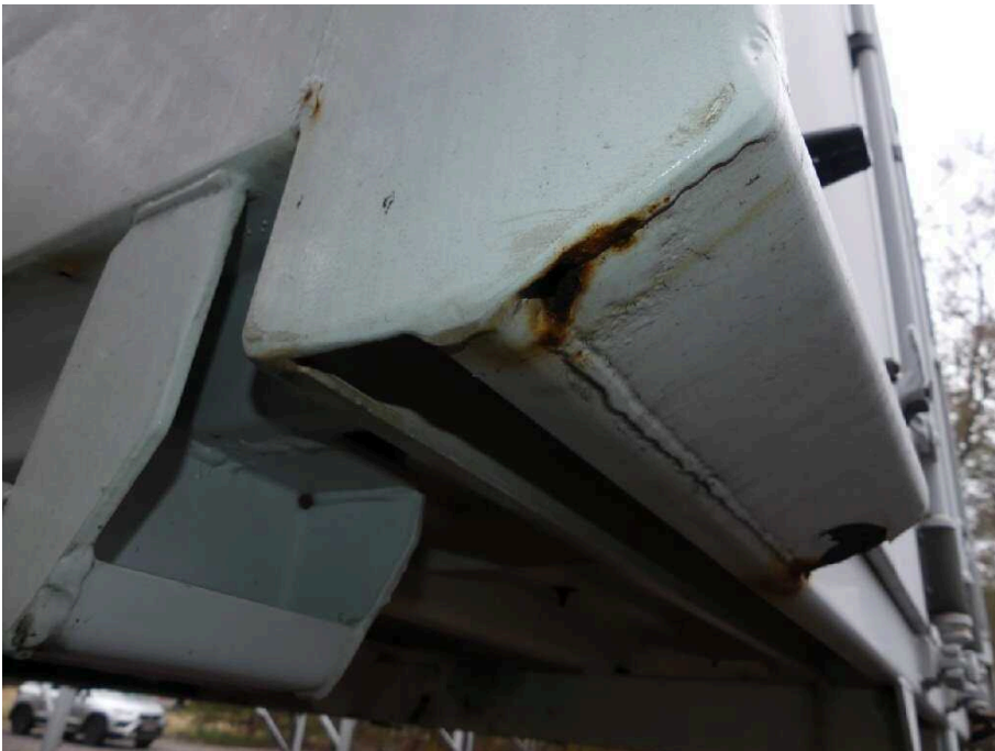
Bild 26 Fahrzeugheck Rahmen hinten links korrodiert
