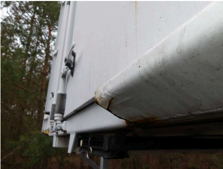
Bild 41 Fahrzeugheck Rahmen hinten rechts korrodiert
