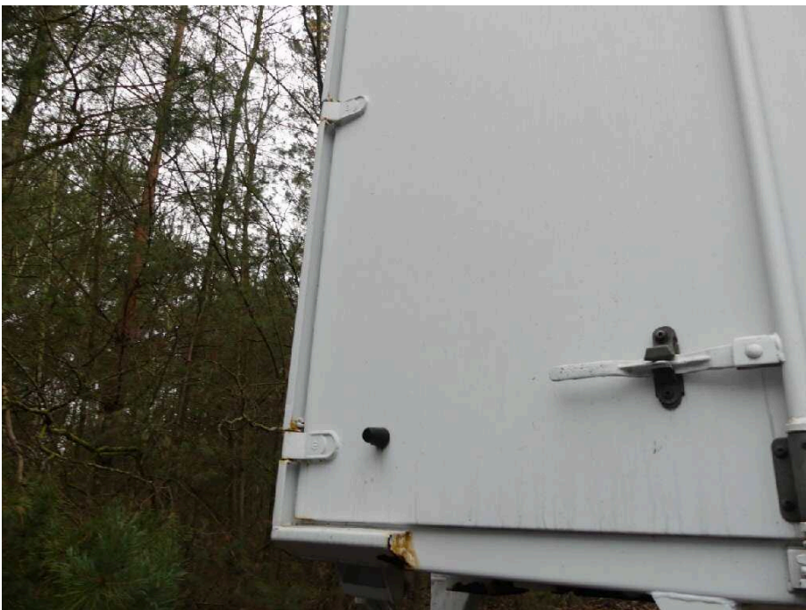
Bild 42 Fahrzeugheck Rahmen hinten Ecksäule links verformt
