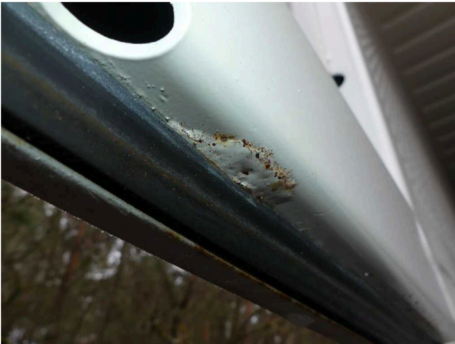
Bild 47 Fahrzeugheck Heckflügeltür links korrodiert
