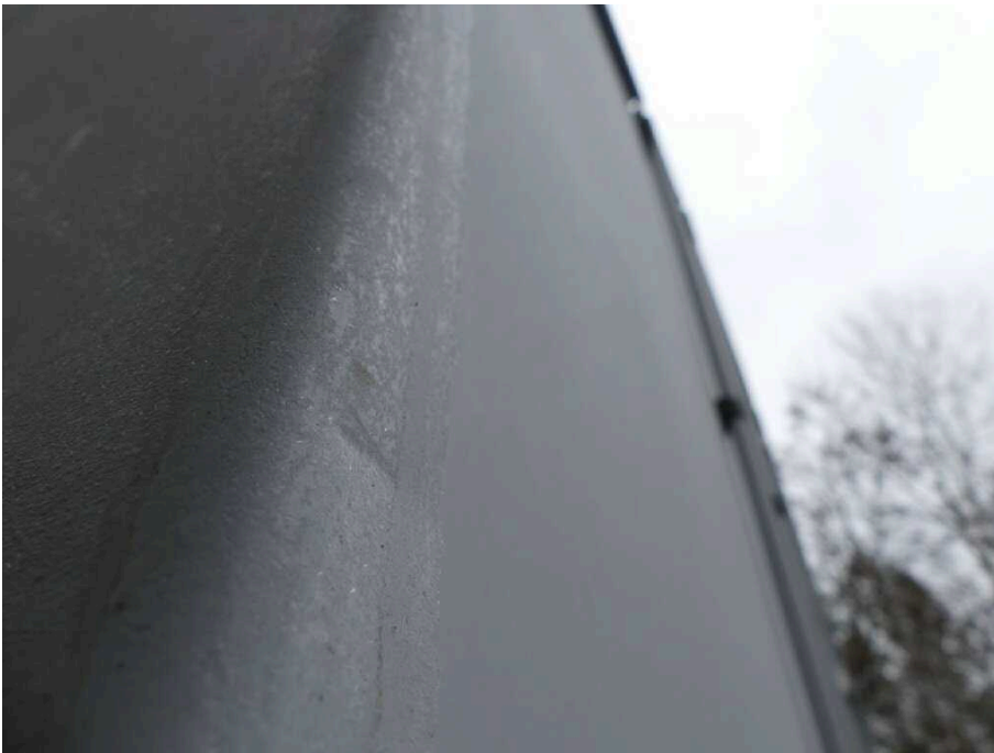
Bild 43 Fahrzeugheck Rahmen hinten Ecksäule links verformt
