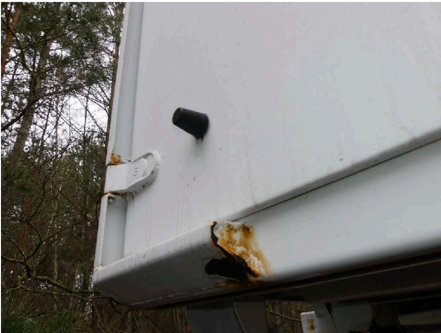
Bild 28 Fahrzeugheck Rahmen hinten links korrodiert
