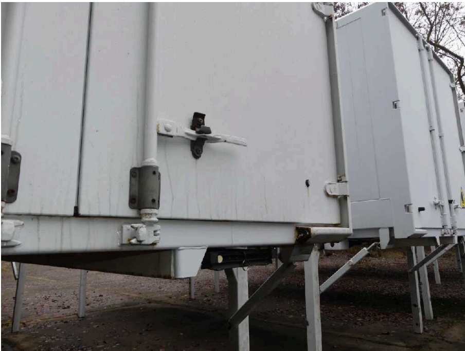
Bild 34 Fahrzeugheck Rahmen hinten rechts korrodiert
