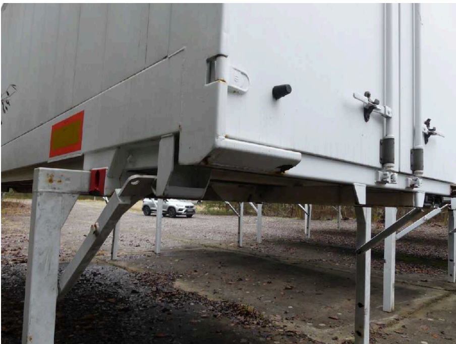
Bild 46 Fahrzeugheck Heckflügeltür links korrodiert
