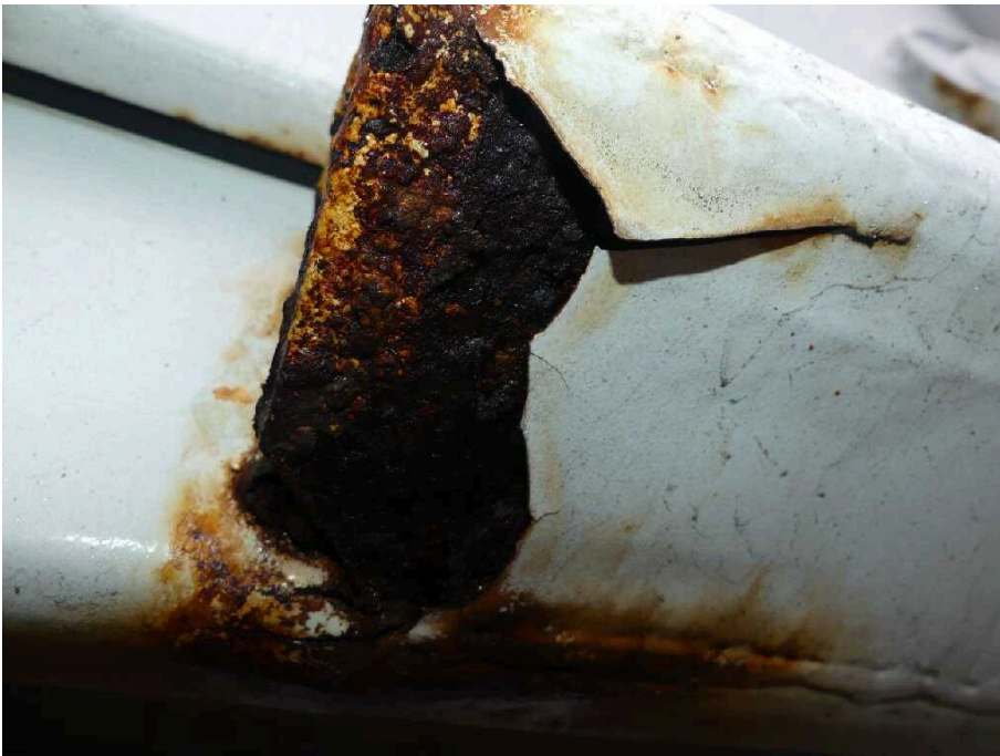
Bild 36 Fahrzeugheck Rahmen hinten rechts korrodiert
