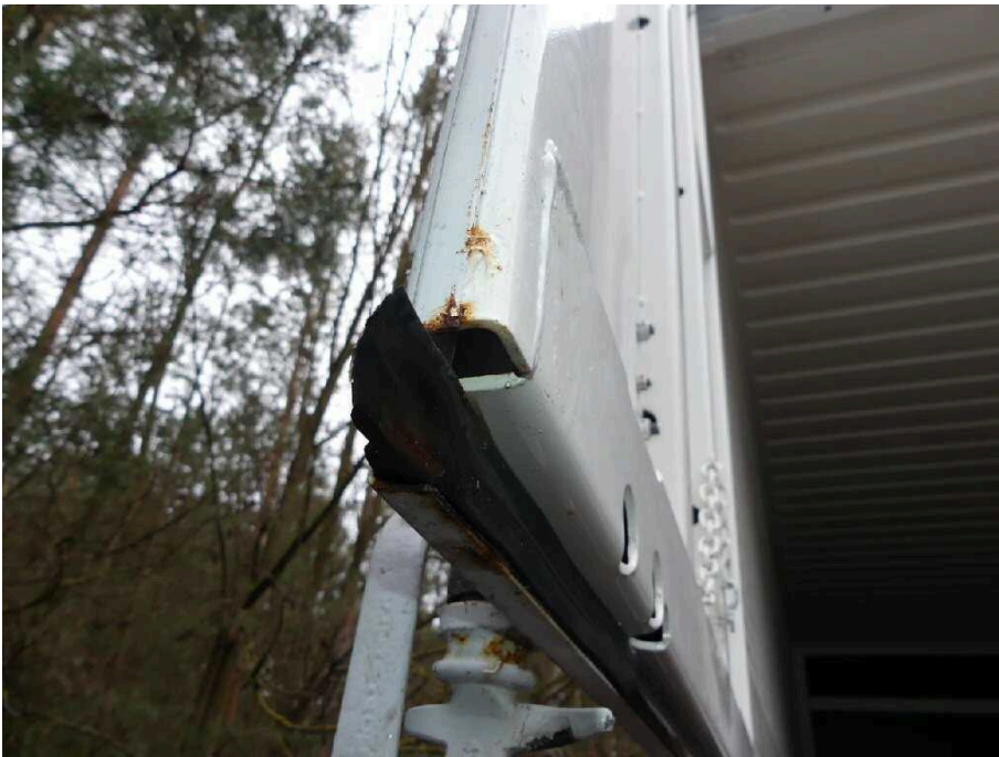
Bild 49 Fahrzeugheck Heckflügeltür links korrodiert
