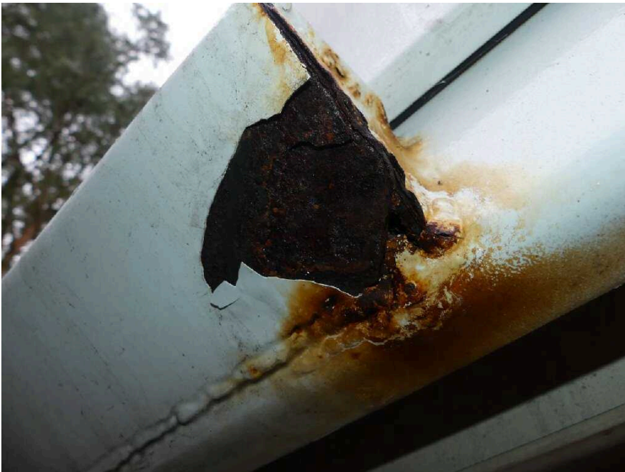
Bild 30 Fahrzeugheck Rahmen hinten links korrodiert
