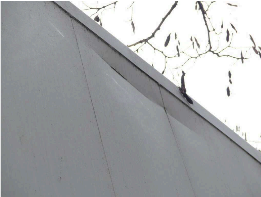
Bild 19 Fahrzeug Fahrzeug aussen Fahrzeugseite links deformiert
