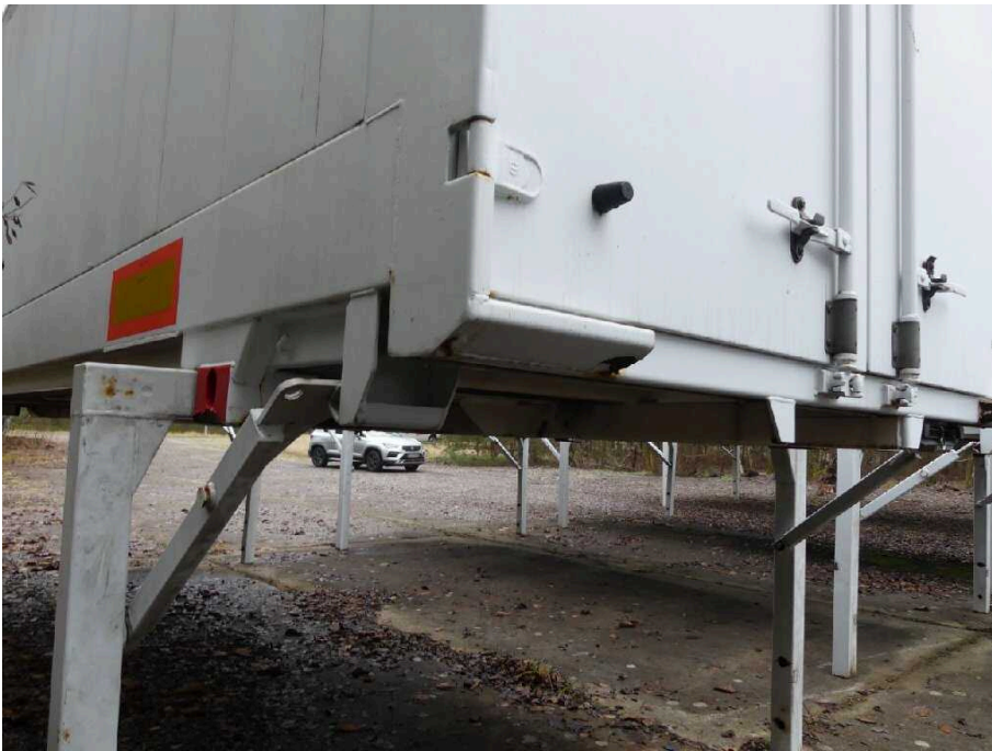
Bild 25 Fahrzeugheck Rahmen hinten links korrodiert
