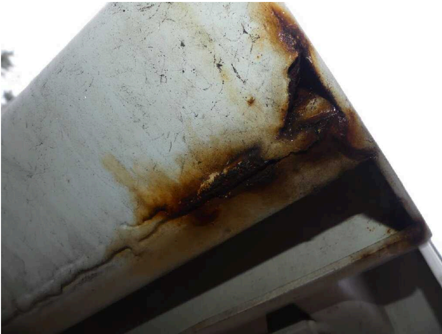
Bild 40 Fahrzeugheck Rahmen hinten rechts korrodiert
