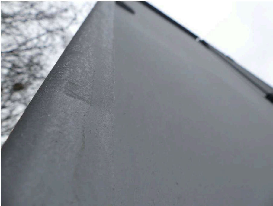
Bild 44 Fahrzeugheck Rahmen hinten Ecksäule links verformt
