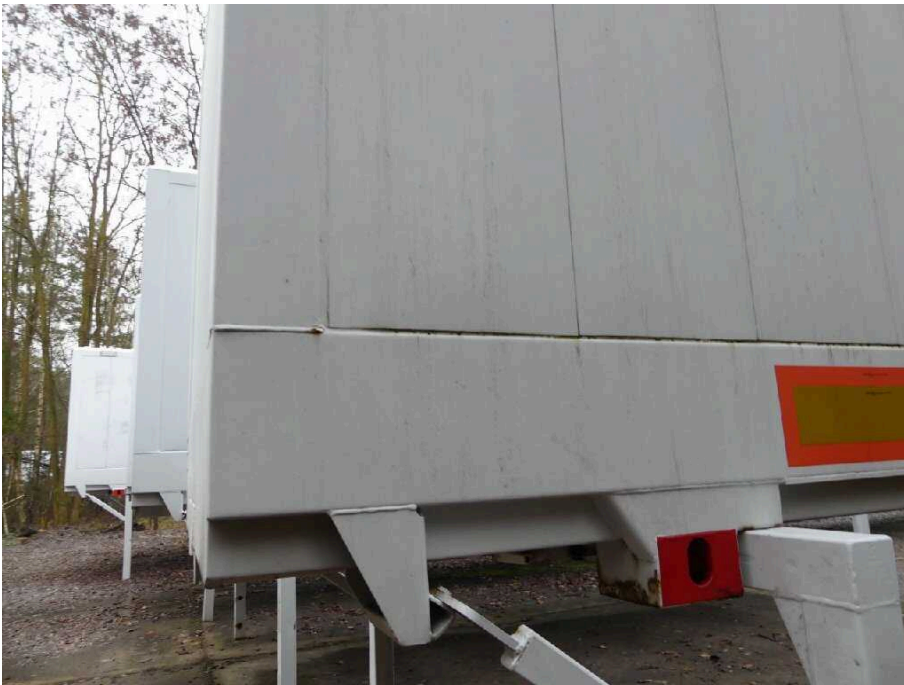
Bild 15 Fahrzeug aussen Fahrzeugseite links deformiert
