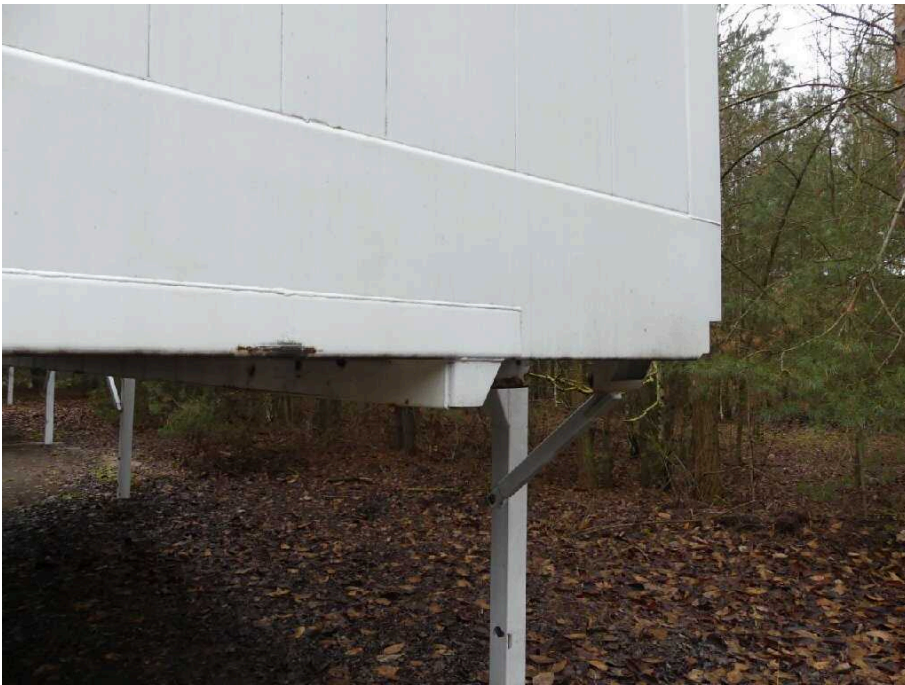
Bild 9 Aufbau Bodenrahmen vorne korrodiert
