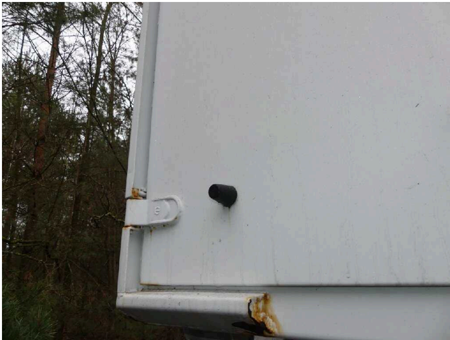
Bild 31 Fahrzeugheck Rahmen hinten links korrodiert
