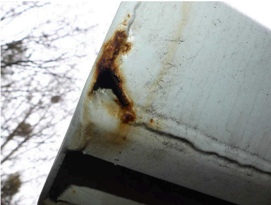
Bild 27 Fahrzeugheck Rahmen hinten links korrodiert
