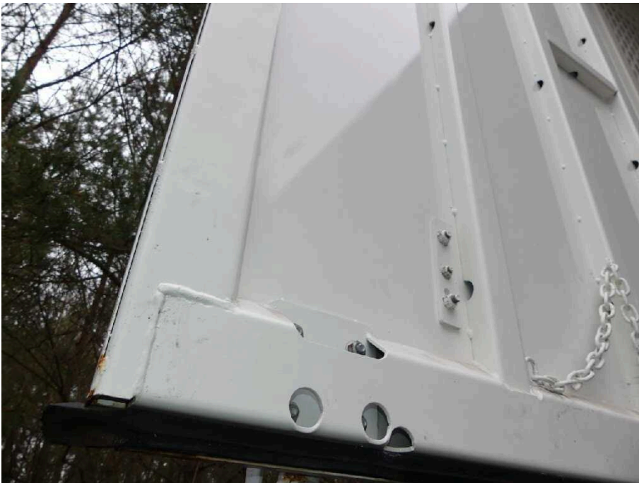
Bild 48 Fahrzeugheck Heckflügeltür links korrodiert
