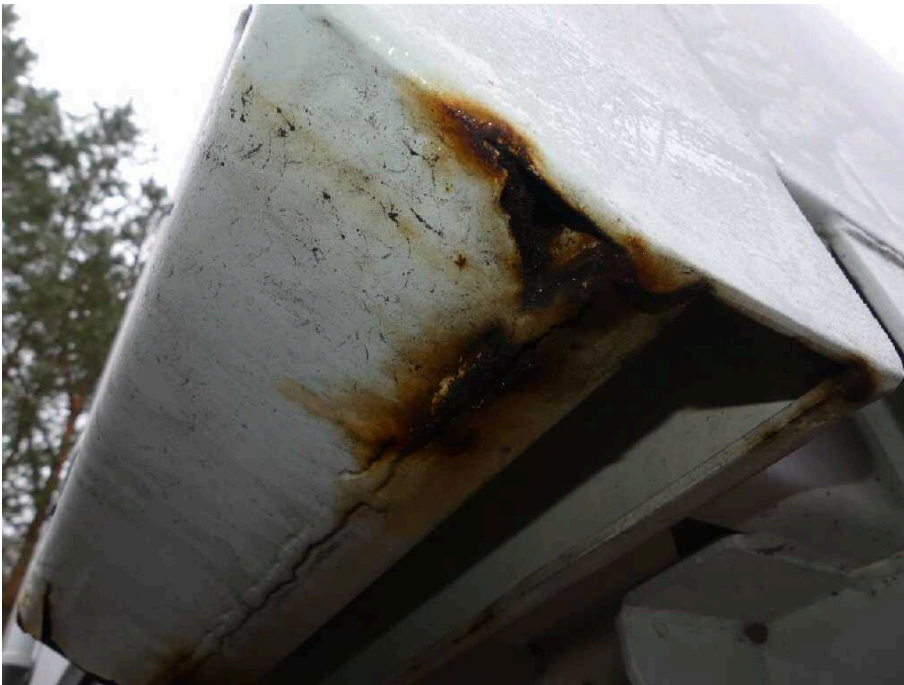
Bild 39 Fahrzeugheck Rahmen hinten rechts korrodiert
