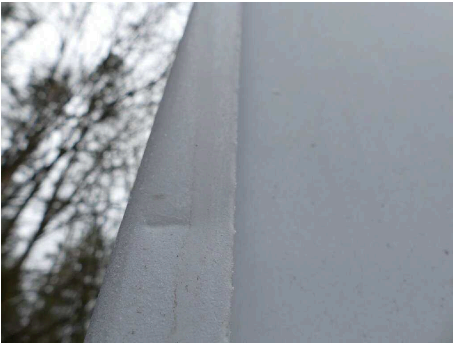
Bild 45 Fahrzeugheck Rahmen hinten Ecksäule links verformt
