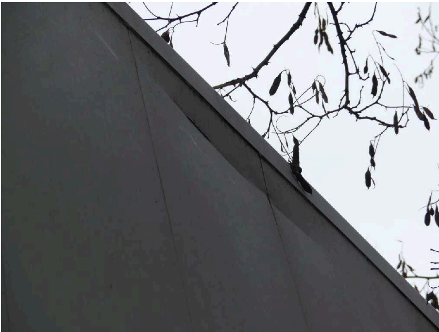
Bild 18 Fahrzeug Fahrzeug aussen Fahrzeugseite links deformiert
