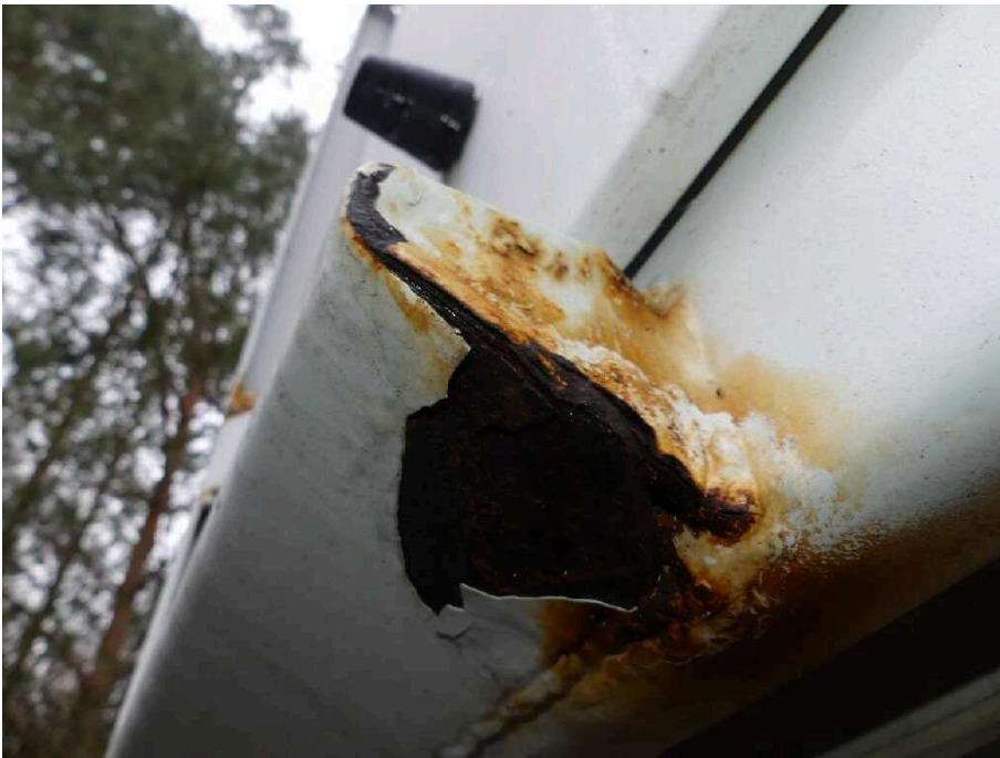
Bild 29 Fahrzeugheck Rahmen hinten links korrodiert
