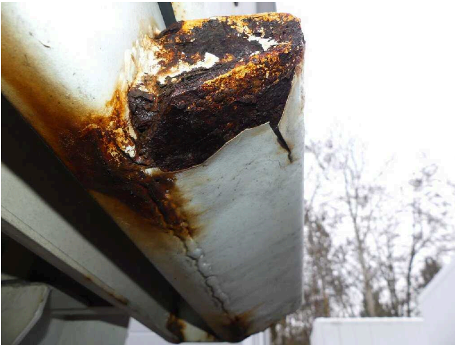
Bild 37 Fahrzeugheck Rahmen hinten rechts korrodiert
