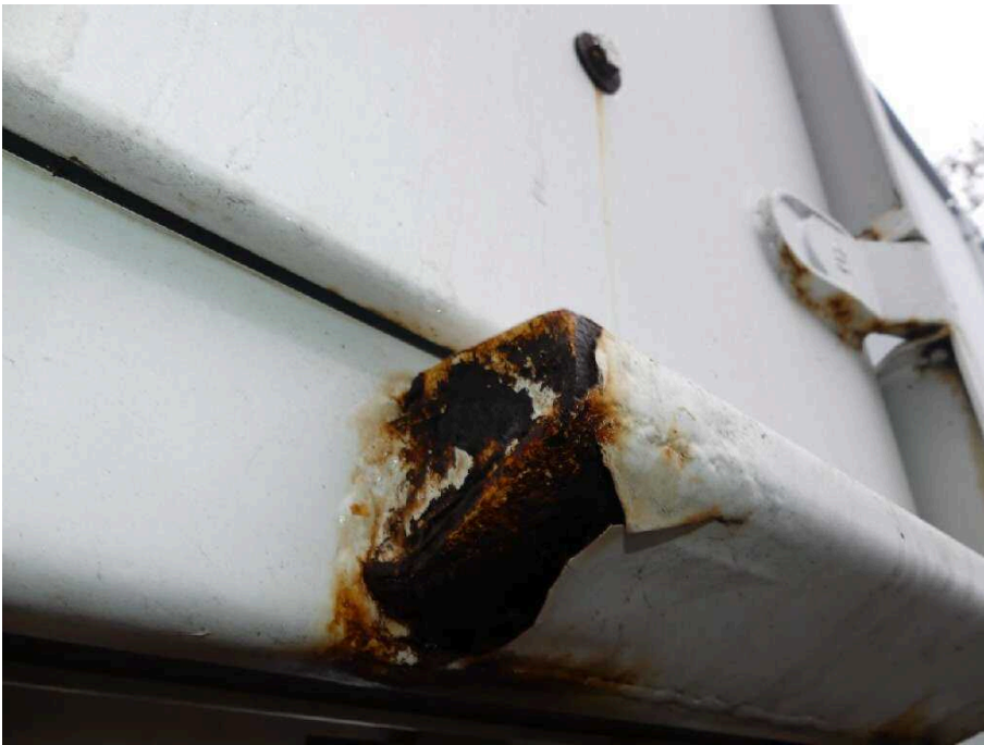
Bild 35 Fahrzeugheck Rahmen hinten rechts korrodiert
