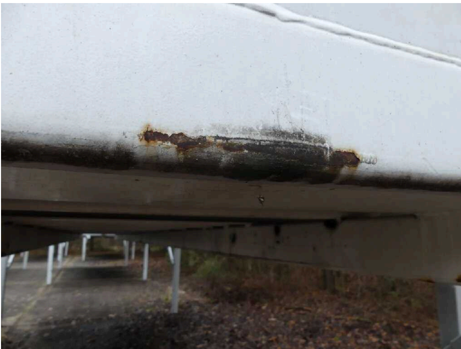
Bild 10 Aufbau Bodenrahmen vorne korrodiert
