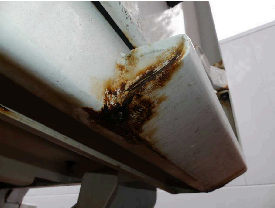
Bild 50 Fahrzeugheck Rahmen hinten rechts korrodiert
