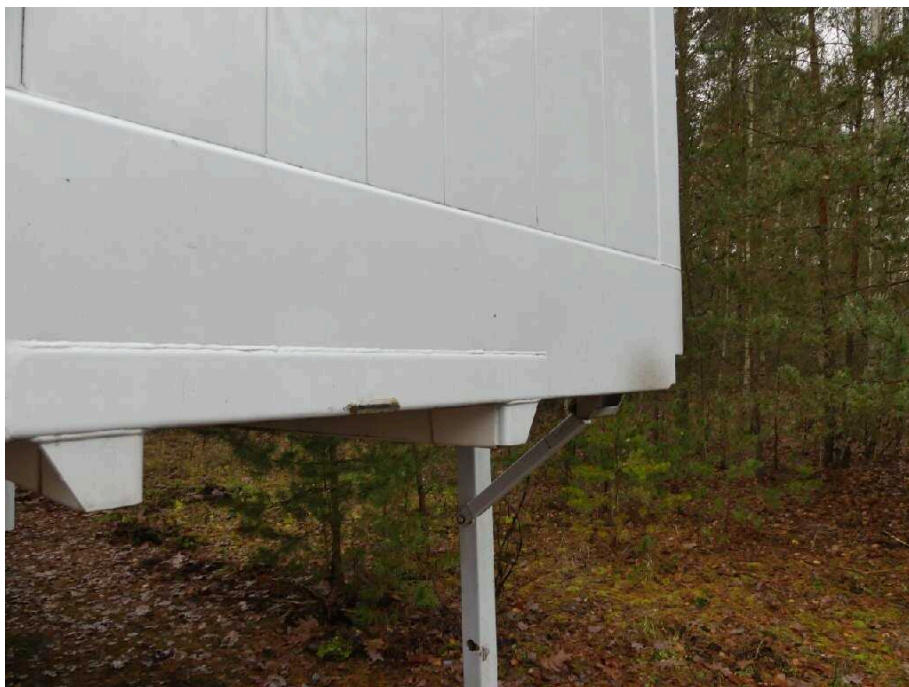
Bild 14 Aufbau Bodenrahmen vorne korrodiert
