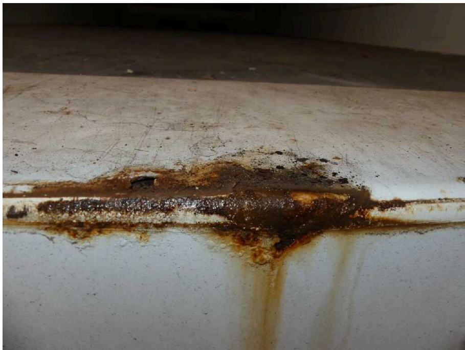
Bild 13 Fahrzeugheck Rahmen hinten Mitte korrodiert
