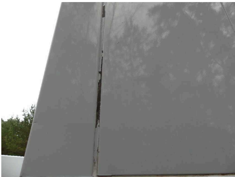
Bild 29 Fahrzeug Fahrzeug aussen links korrodiert
