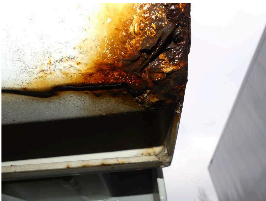
Bild 56 Fahrzeugheck Rahmen hinten rechts korrodiert
