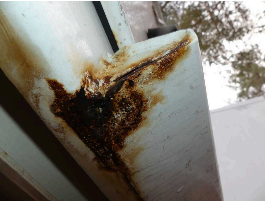
Bild 51 Fahrzeugheck Rahmen hinten rechts korrodiert
