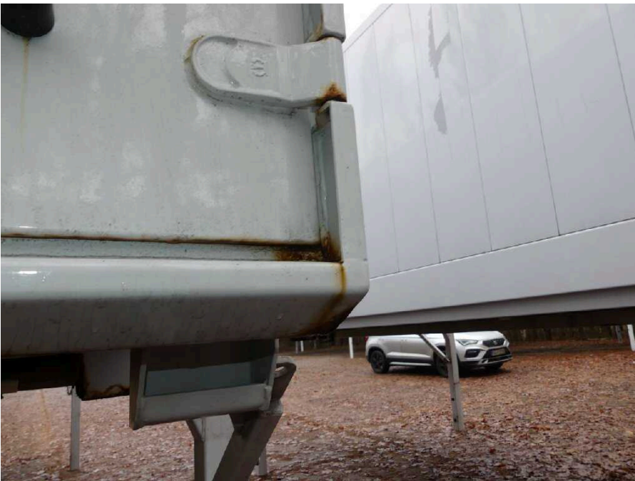
Bild 52 Fahrzeugheck Rahmen hinten rechts korrodiert
