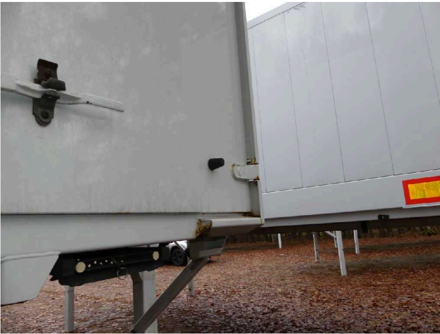
Bild 49 Fahrzeugheck Rahmen hinten rechts korrodiert
