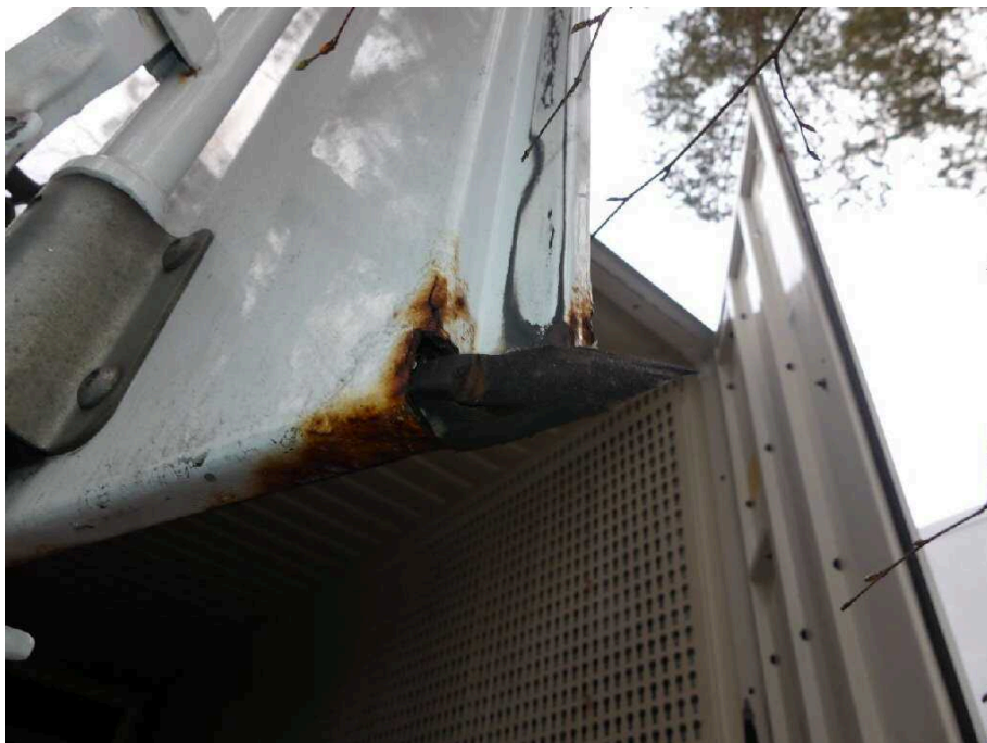
Bild 45 Fahrzeugheck Heckflügeltür links und rechts korrodiert
