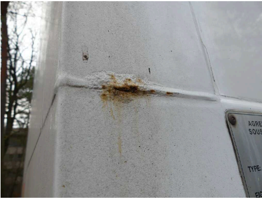
Bild 17 Fahrzeug Rahmen Eckrahmen vorn rechts korrodiert
