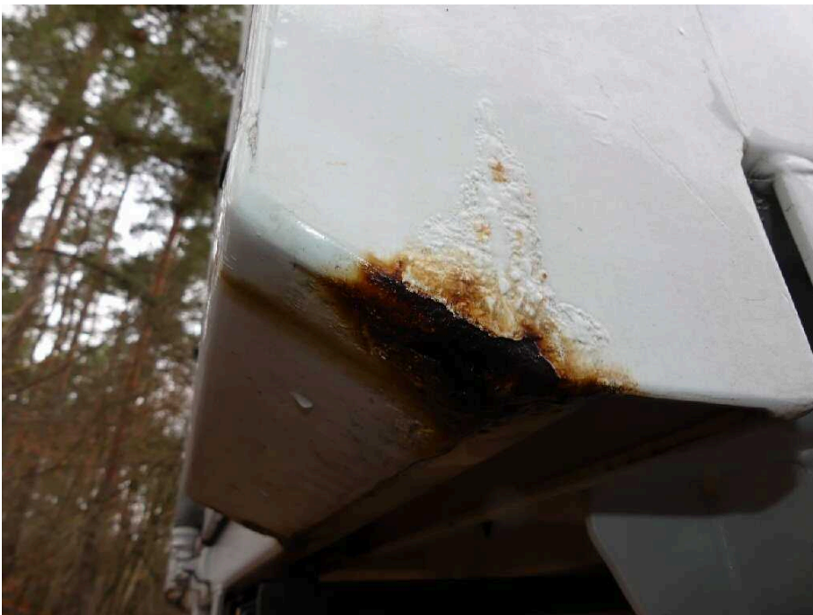
Bild 54 Fahrzeugheck Rahmen hinten rechts korrodiert
