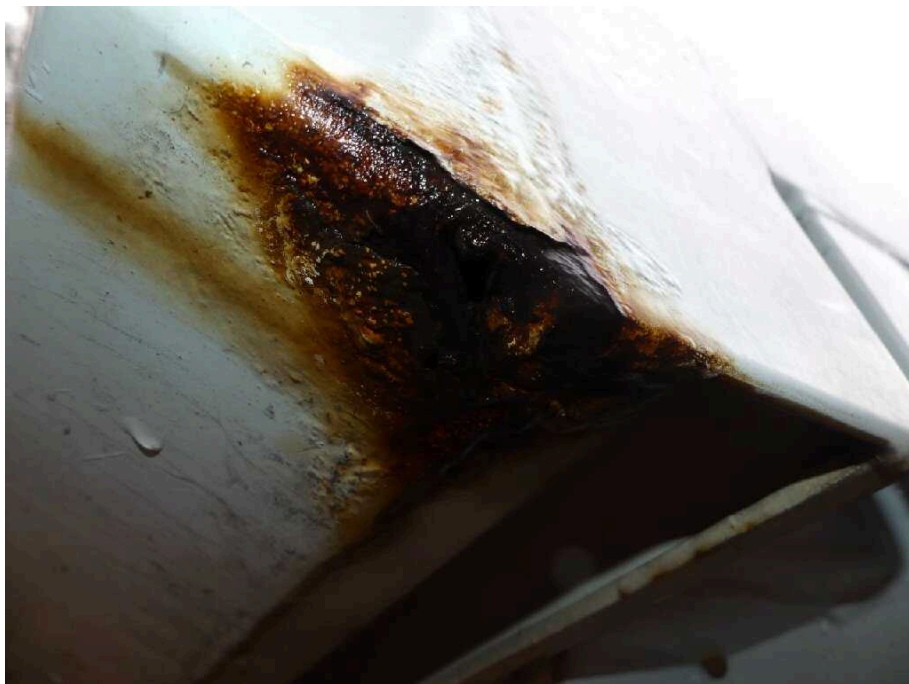
Bild 55 Fahrzeugheck Rahmen hinten rechts korrodiert
