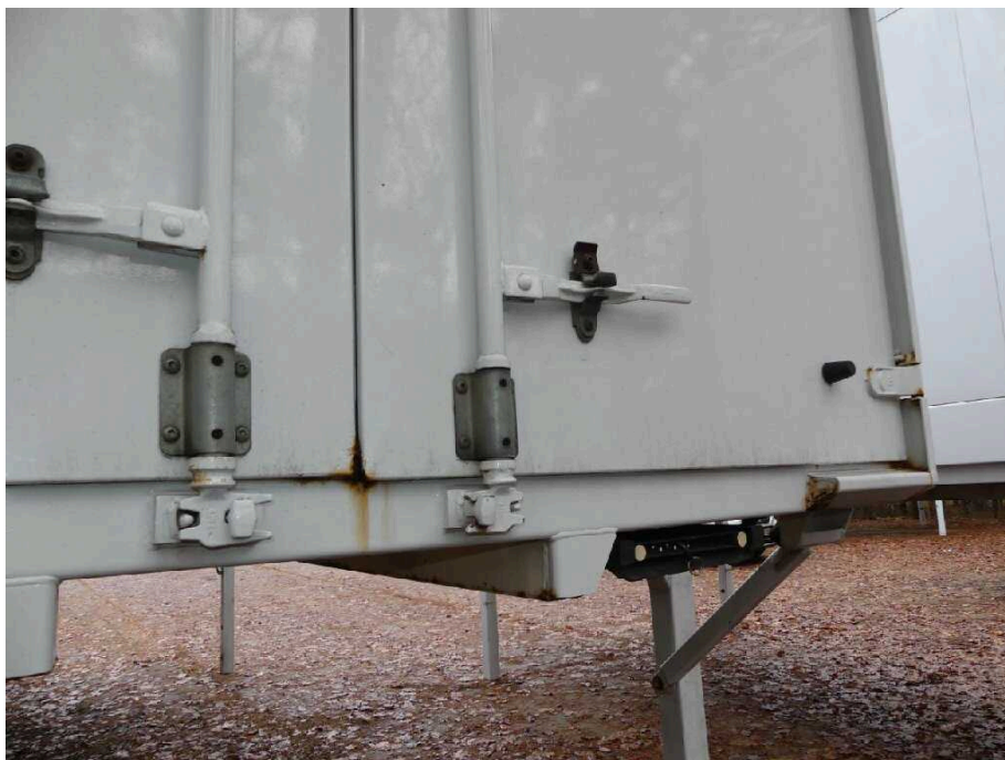
Bild 40 Fahrzeugheck Heckflügeltür links und rechts korrodiert
