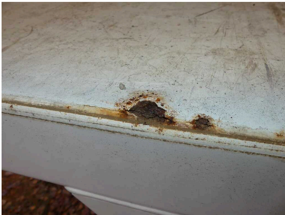
Bild 11 Fahrzeugheck Rahmen hinten Mitte korrodiert
