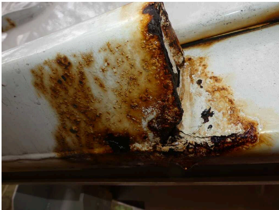
Bild 39 Fahrzeugheck Rahmen hinten links korrodiert
