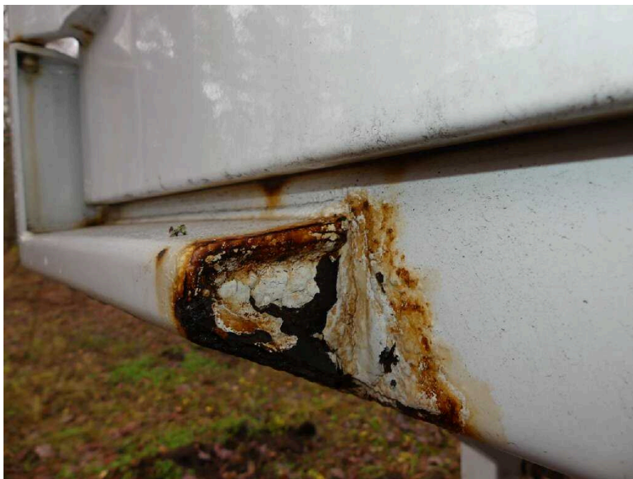
Bild 38 Fahrzeugheck Rahmen hinten links korrodiert
