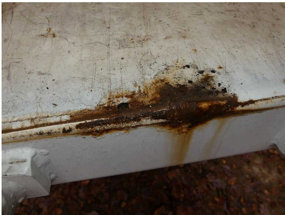
Bild 12 Fahrzeugheck Rahmen hinten Mitte korrodiert
