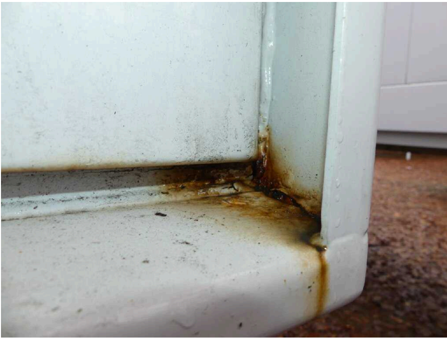
Bild 53 Fahrzeugheck Rahmen hinten rechts korrodiert
