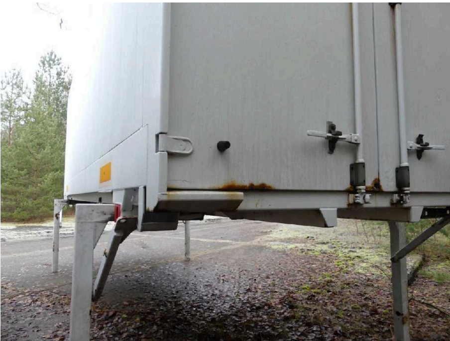
Bild 46 Fahrzeugheck Rahmen hinten links korrodiert
