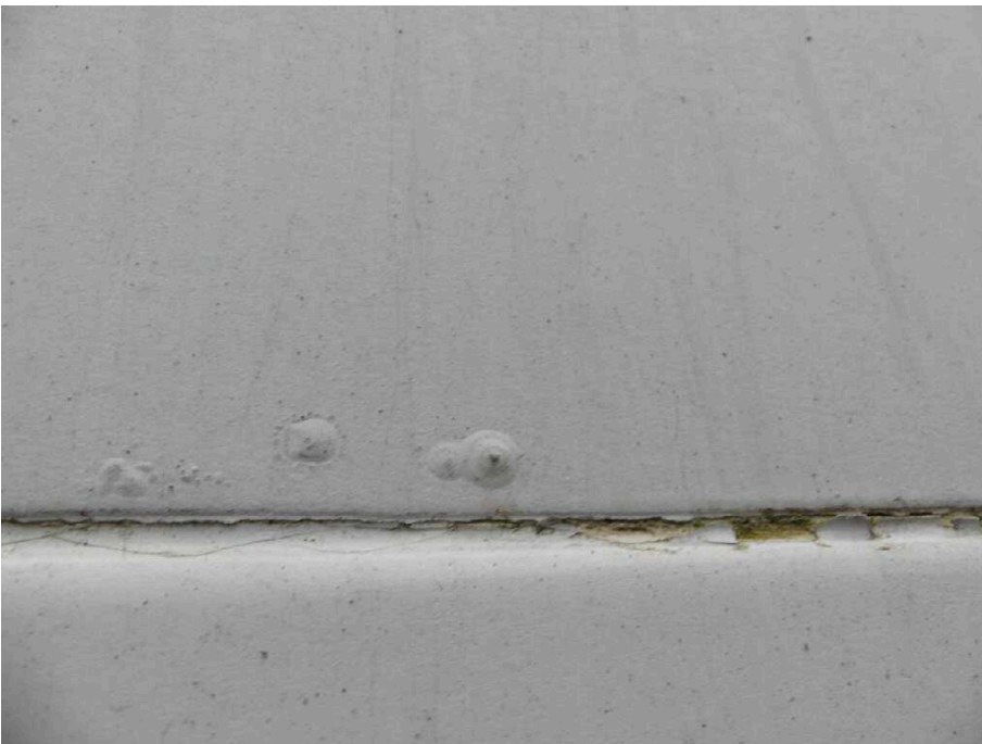
Bild 26 Fahrzeug Fahrzeug aussen Seite links korrodiert
