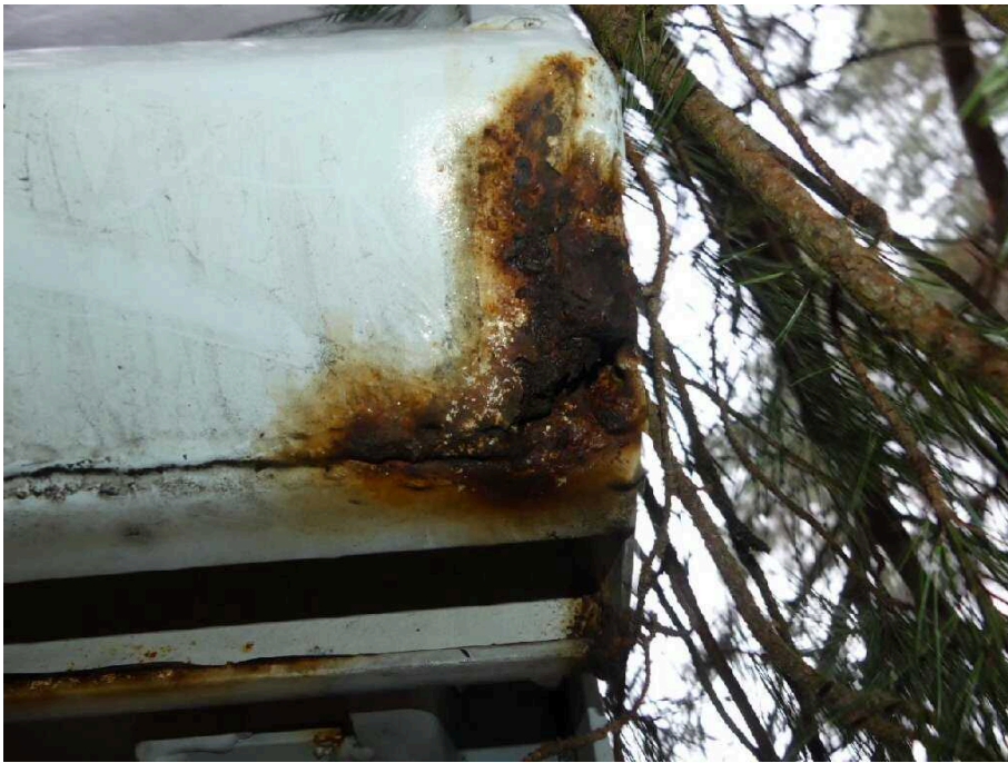
Bild 55 Fahrzeugheck Rahmen hinten rechts korrodiert
