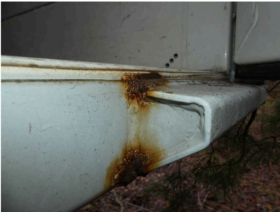
Bild 58 Fahrzeugheck Rahmen hinten rechts korrodiert
