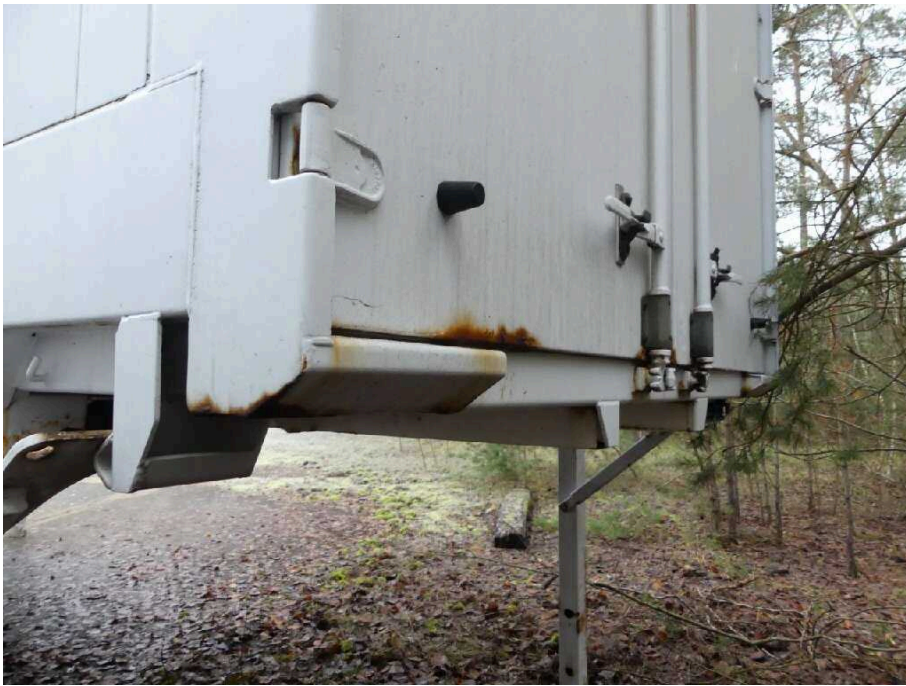
Bild 47 Fahrzeugheck Rahmen hinten links korrodiert
