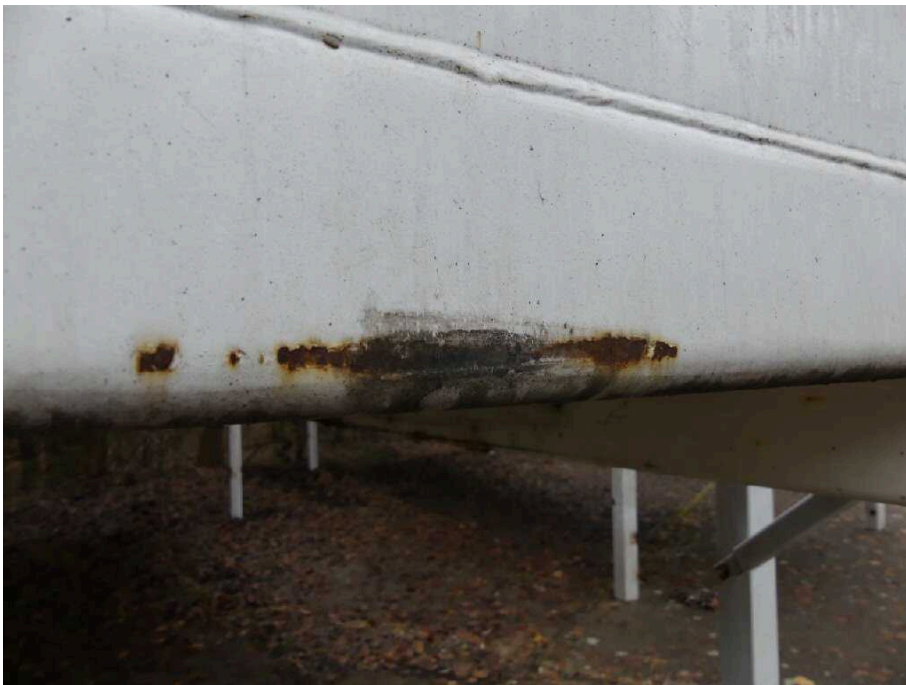
Bild 10 Aufbau Bodenrahmen vorne korrodiert
