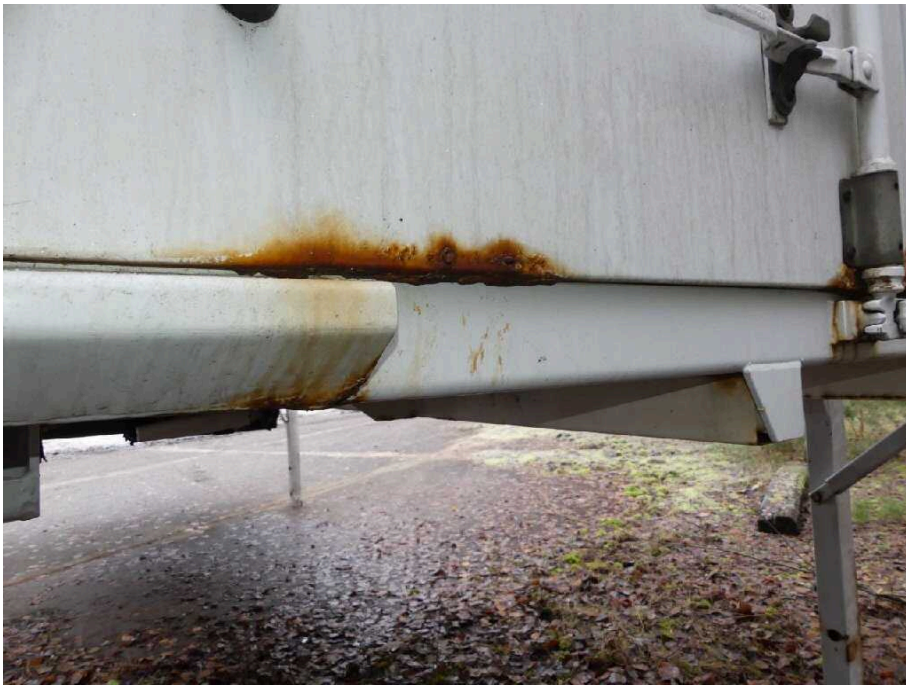
Bild 31 Fahrzeugheck Hecktür links stark korrodiert
