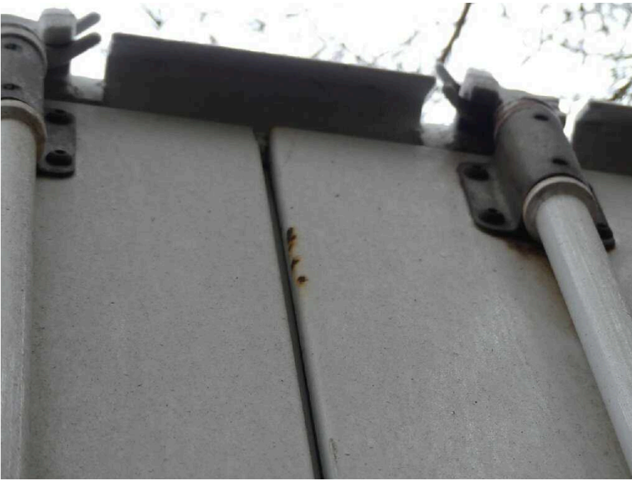
Bild 63 Fahrzeugheck Heckflügeltür rechts korrodiert
