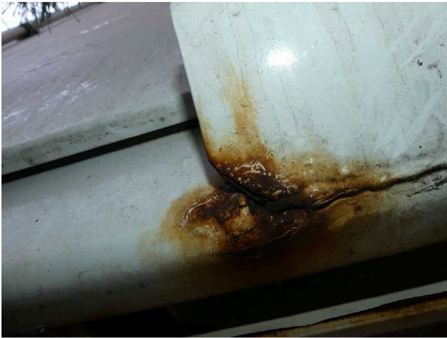
Bild 57 Fahrzeugheck Rahmen hinten rechts korrodiert
