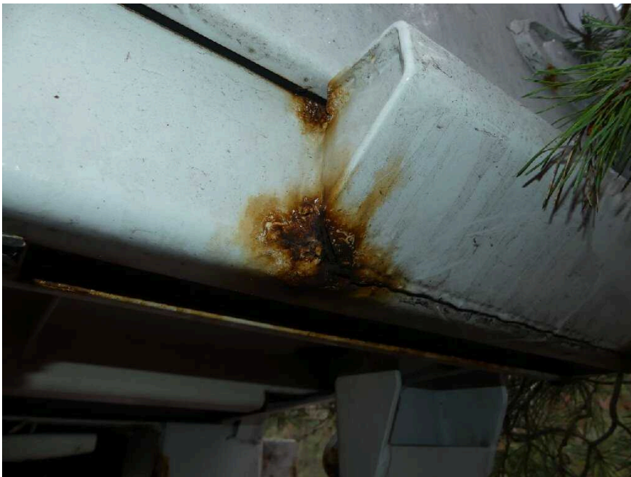
Bild 52 Fahrzeugheck Rahmen hinten rechts korrodiert
