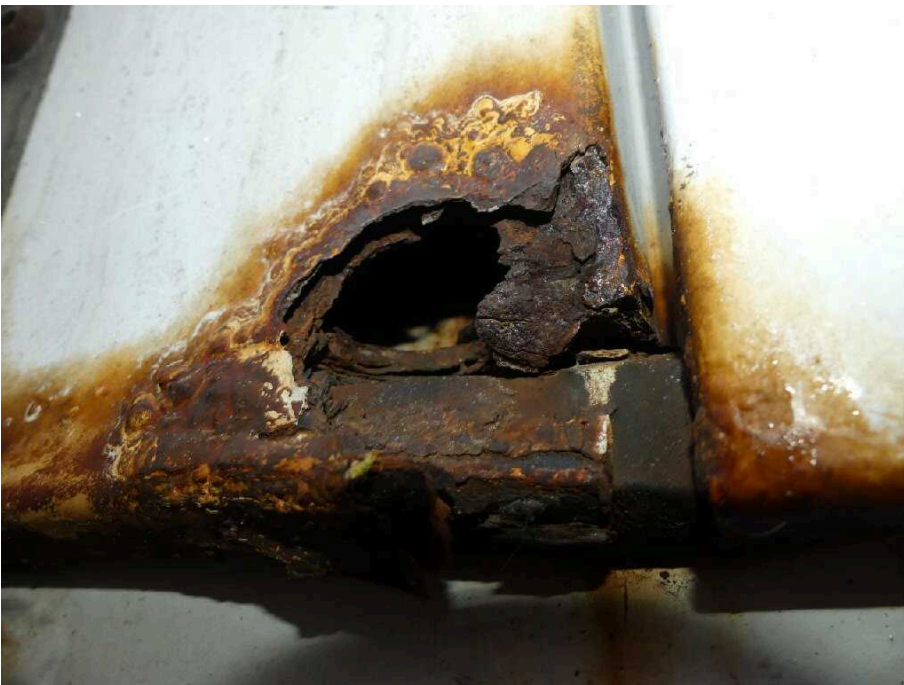
Bild 36 Fahrzeugheck Hecktür links stark korrodiert
