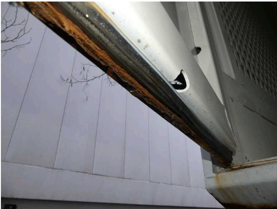
Bild 40 Fahrzeugheck Hecktür links stark korrodiert
