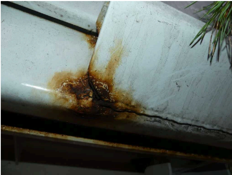
Bild 53 Fahrzeugheck Rahmen hinten rechts korrodiert
