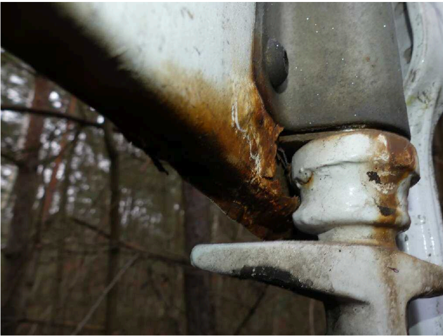
Bild 45 Fahrzeugheck Hecktür links stark korrodiert
