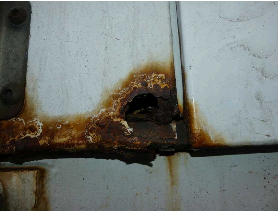
Bild 35 Fahrzeugheck Hecktür links stark korrodiert
