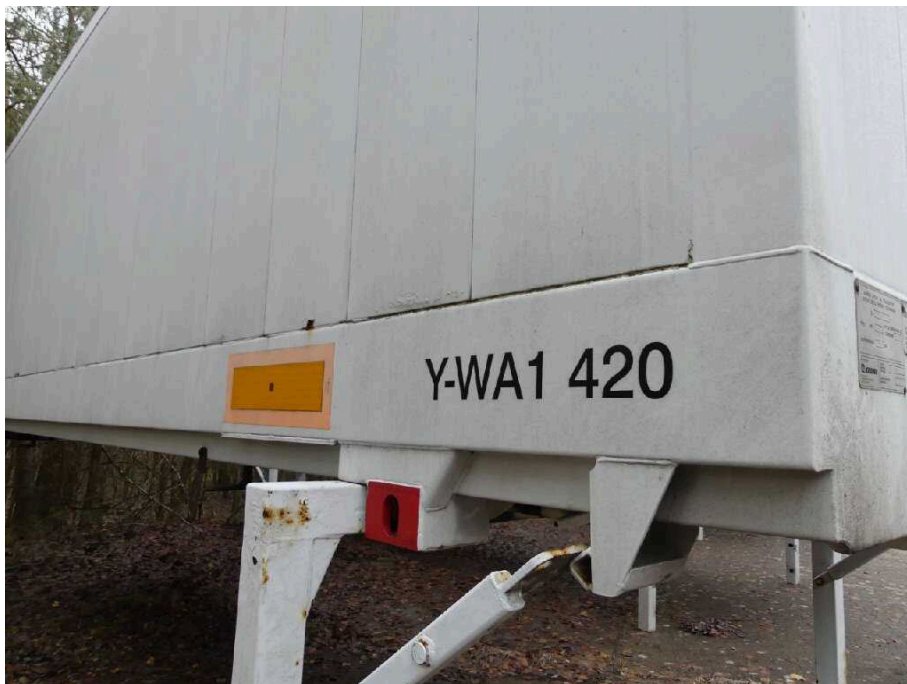
Bild 11 Fahrzeug Fahrzeug aussen Seite rechts, einzelne Elemente durchgerostet , teilweise erneuern und instandsetzen stark korrodiert
