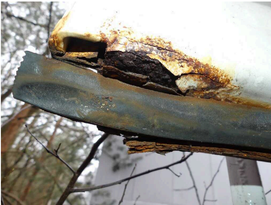
Bild 42 Fahrzeugheck Hecktür links stark korrodiert
