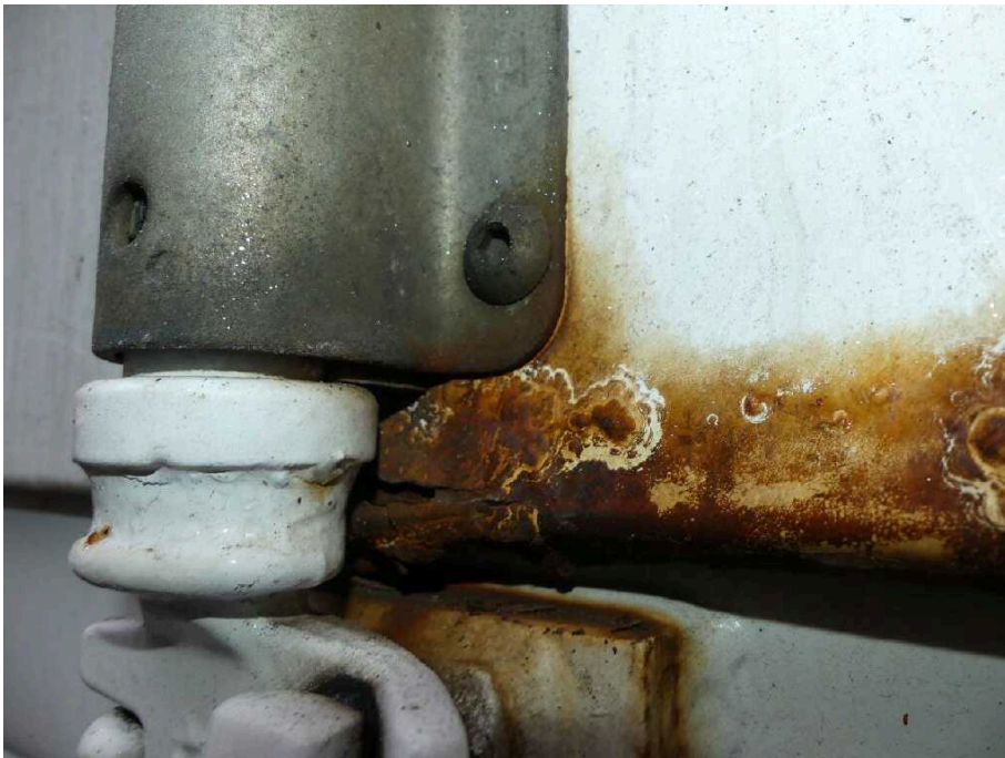
Bild 37 Fahrzeugheck Hecktür links stark korrodiert
