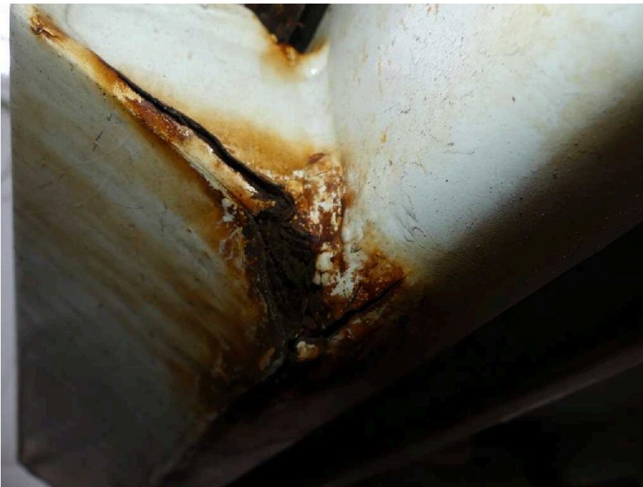
Bild 50 Fahrzeugheck Rahmen hinten links korrodiert
