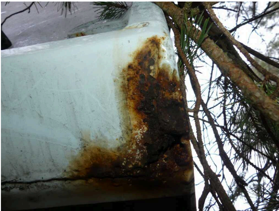
Bild 54 Fahrzeugheck Rahmen hinten rechts korrodiert
