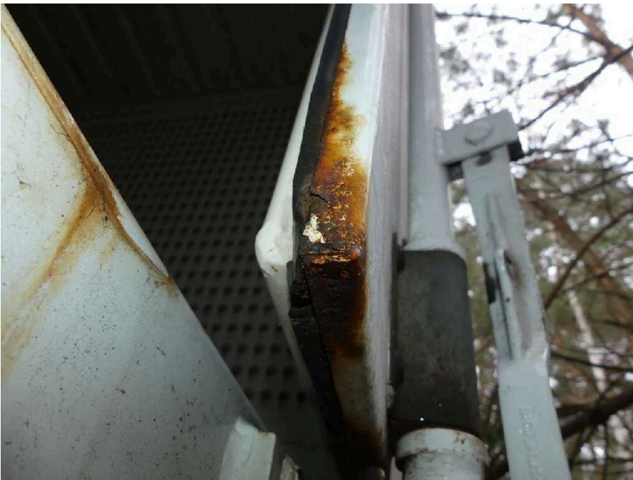
Bild 64 Fahrzeugheck Heckflügeltür rechts korrodiert
