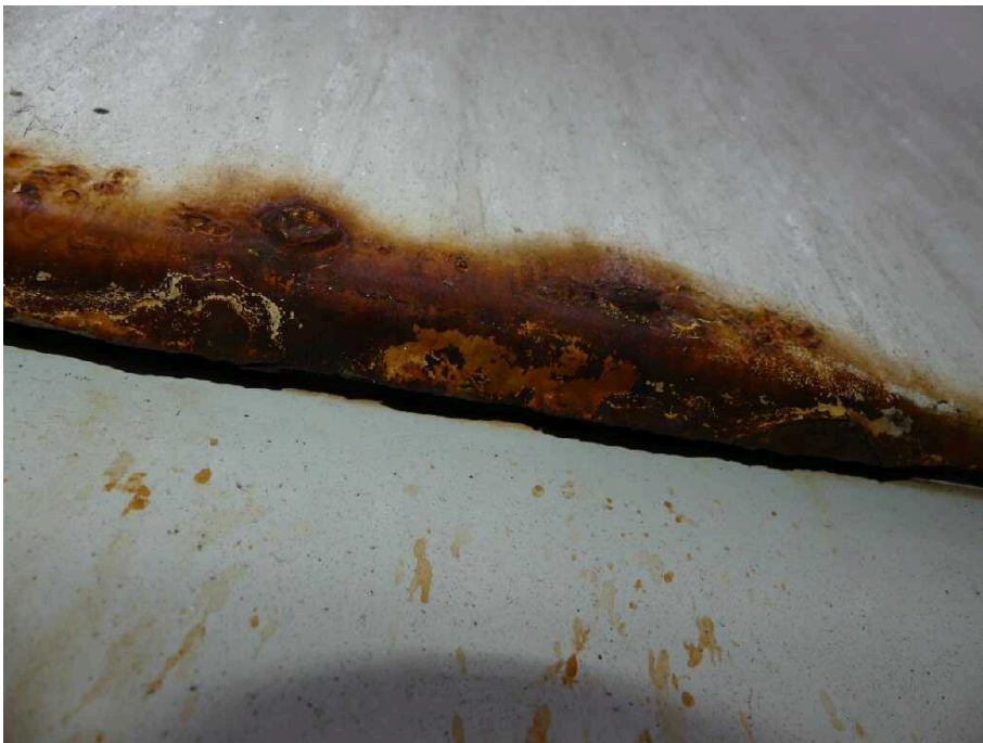
Bild 32 Fahrzeugheck Hecktür links stark korrodiert
