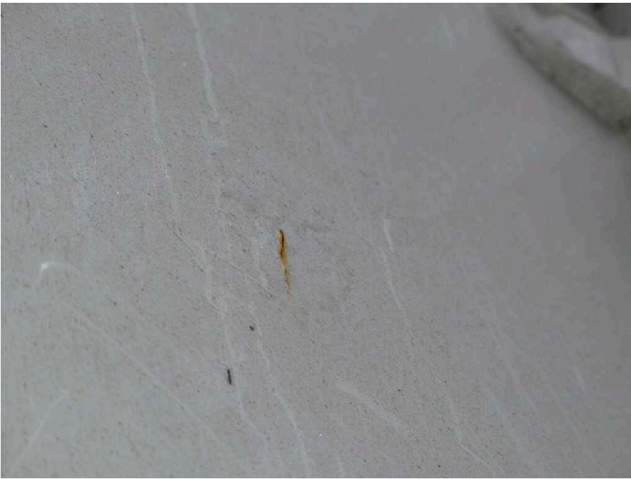
Bild 61 Fahrzeugheck Heckflügeltür rechts korrodiert
