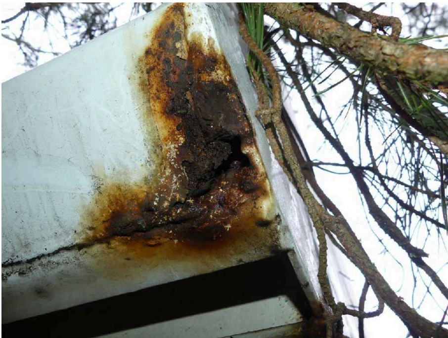
Bild 56 Fahrzeugheck Rahmen hinten rechts korrodiert
