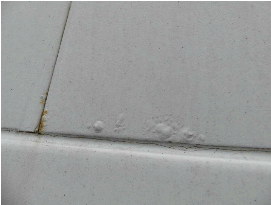
Bild 27 Fahrzeug aussen Seite links korrodiert
