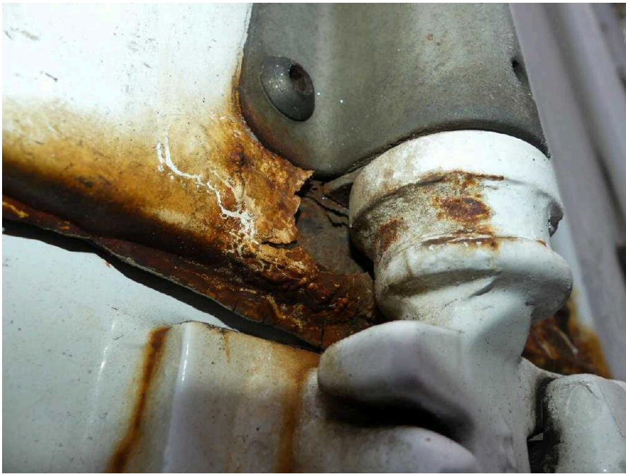
Bild 39 Fahrzeugheck Hecktür links stark korrodiert
