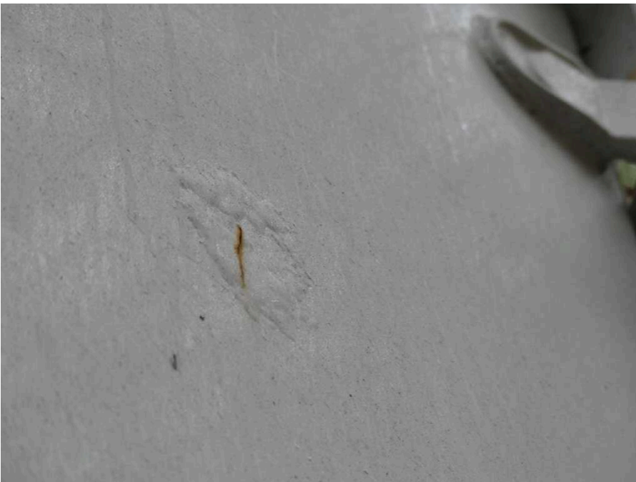
Bild 62 Fahrzeugheck Heckflügeltür rechts korrodiert
