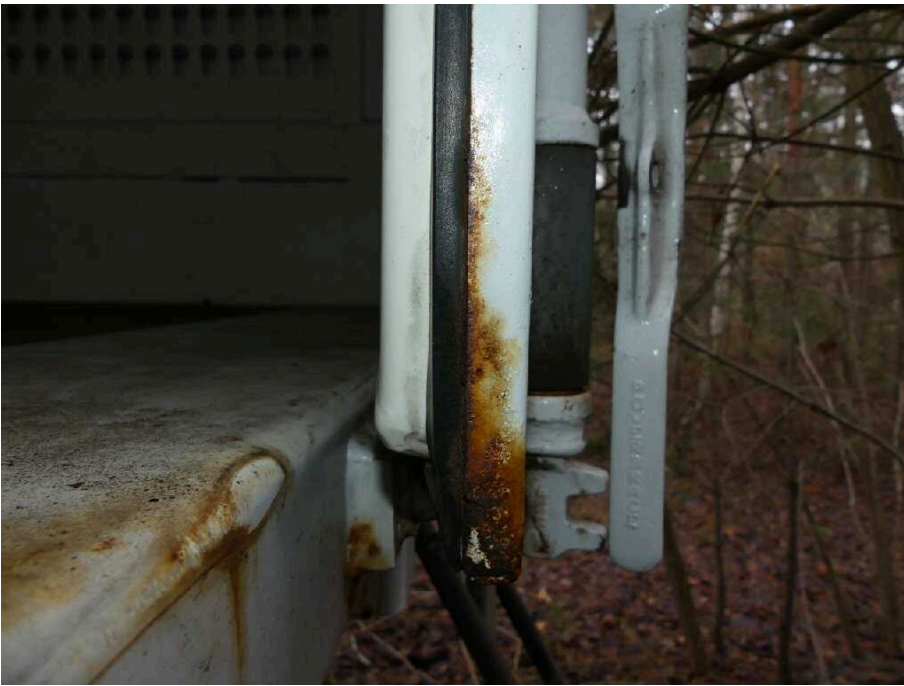
Bild 65 Fahrzeugheck Heckflügeltür rechts korrodiert
