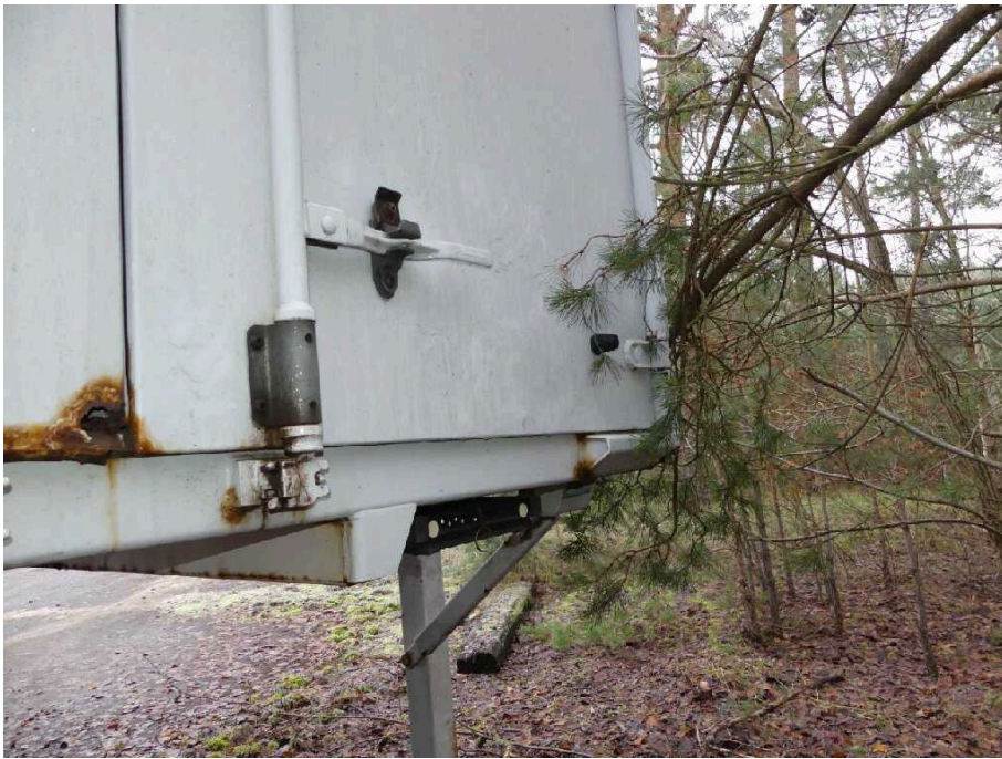
Bild 51 Fahrzeugheck Rahmen hinten rechts korrodiert
