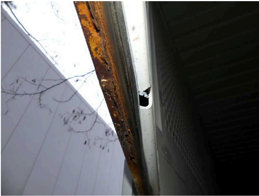
Bild 41 Fahrzeugheck Hecktür links stark korrodiert
