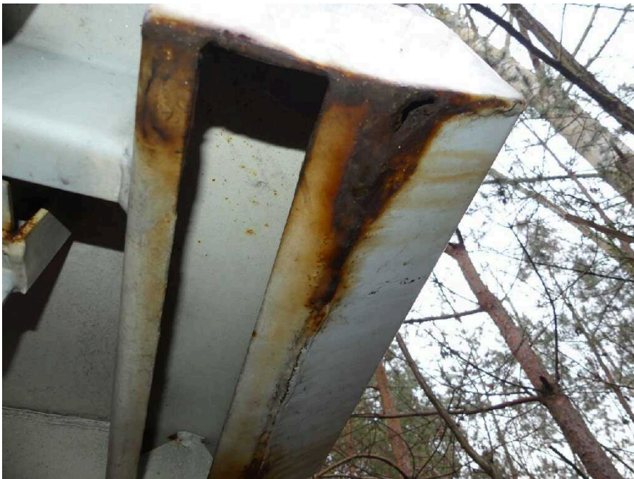
Bild 48 Fahrzeugheck Rahmen hinten links korrodiert
