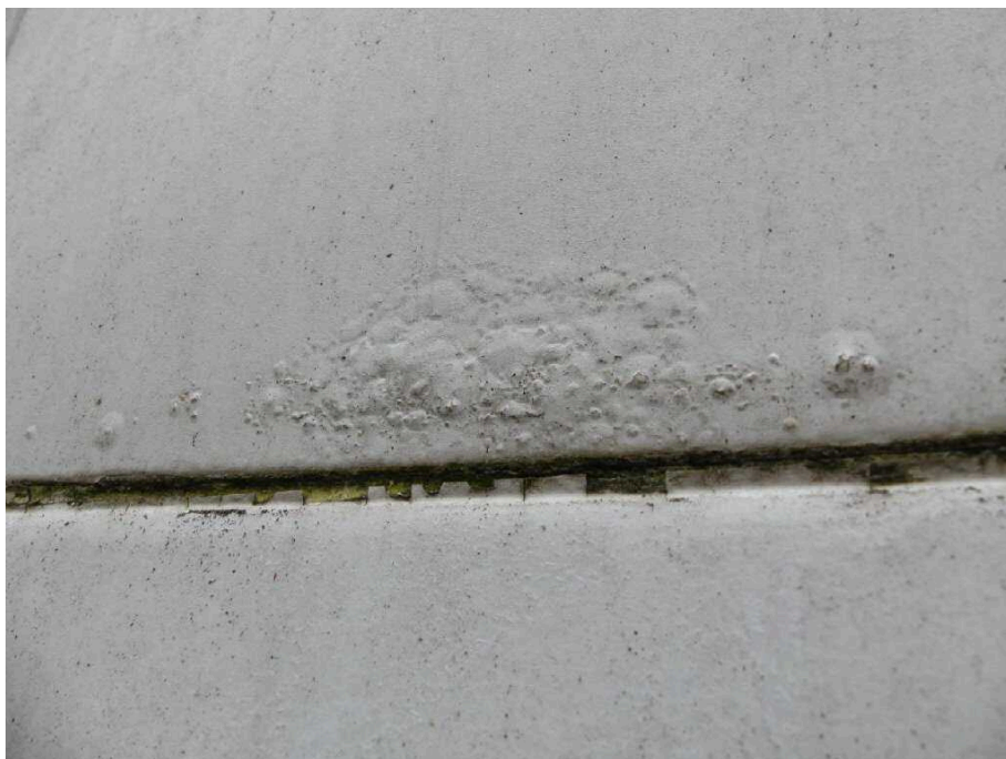
Bild 12 Fahrzeug Fahrzeug aussen Seite rechts, einzelne Elemente durchgerostet , teilweise erneuern und instandsetzen stark korrodiert
