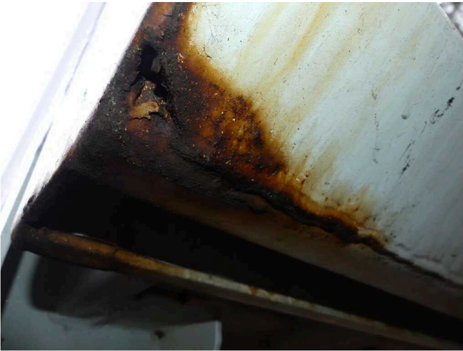
Bild 49 Fahrzeugheck Rahmen hinten links korrodiert
