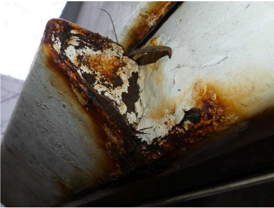
Bild 35 Fahrzeugheck Rahmen hinten links korrodiert
