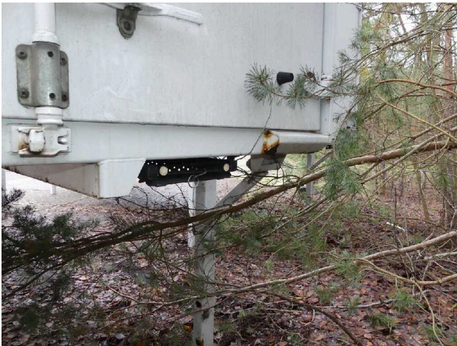
Bild 42 Aufbau Aufstiegsleiter hinten Sicherung beschädigt
