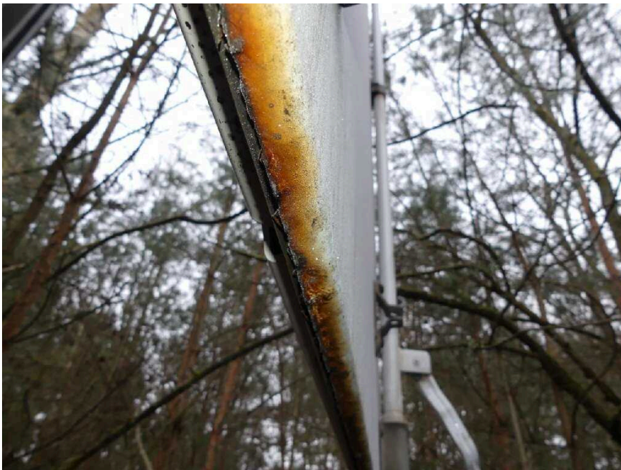
Bild 30 Fahrzeugheck Hecktür links stark korrodiert
