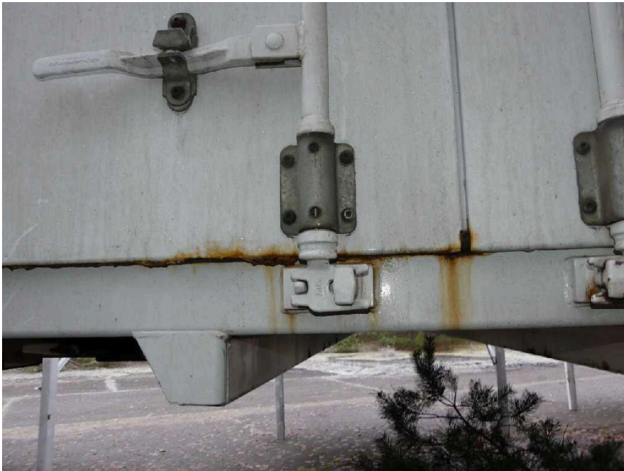
Bild 26 Fahrzeugheck Hecktür links stark korrodiert
