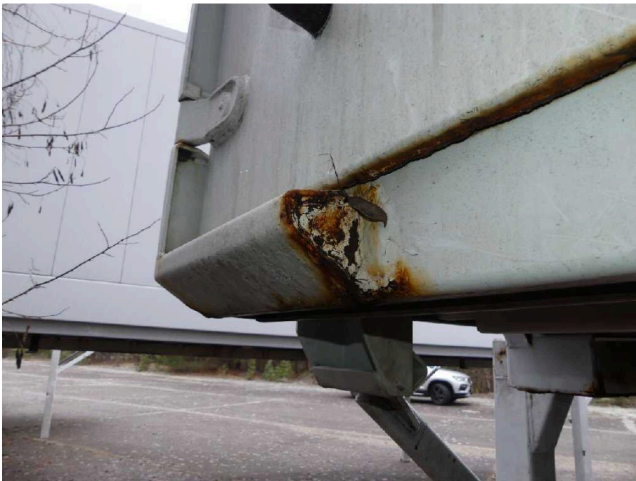
Bild 34 Fahrzeugheck Rahmen hinten links korrodiert
