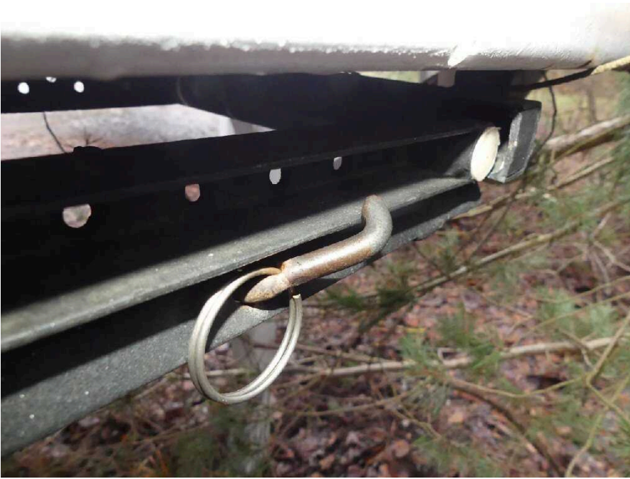
Bild 43 Aufbau Aufstiegsleiter hinten Sicherung beschädigt
