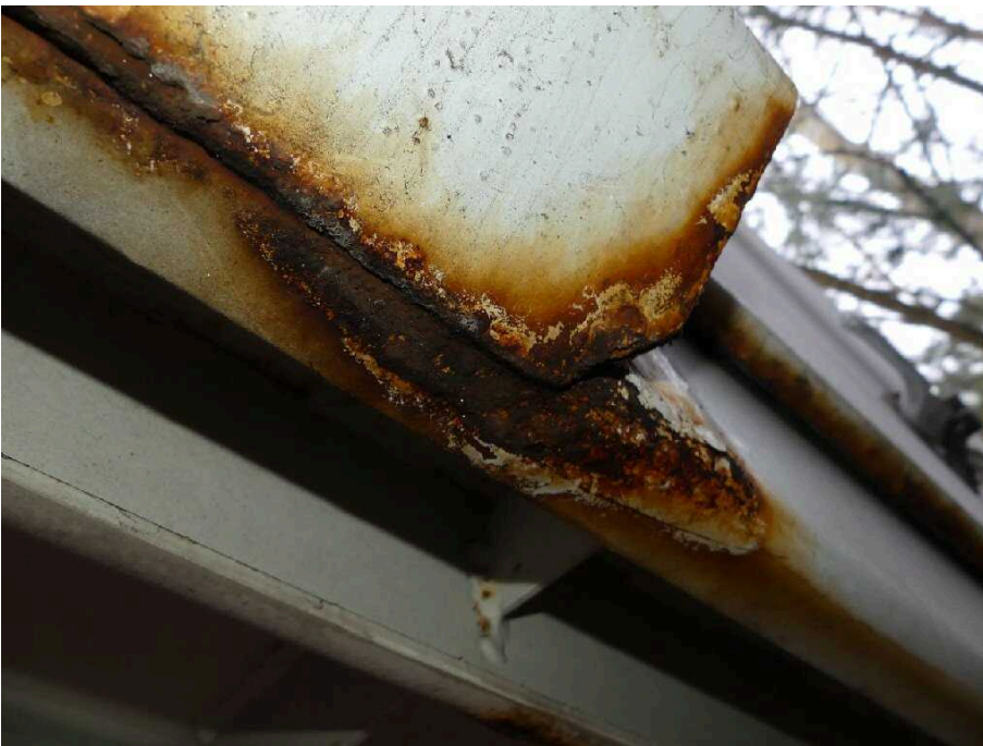
Bild 38 Fahrzeugheck Rahmen hinten links korrodiert
