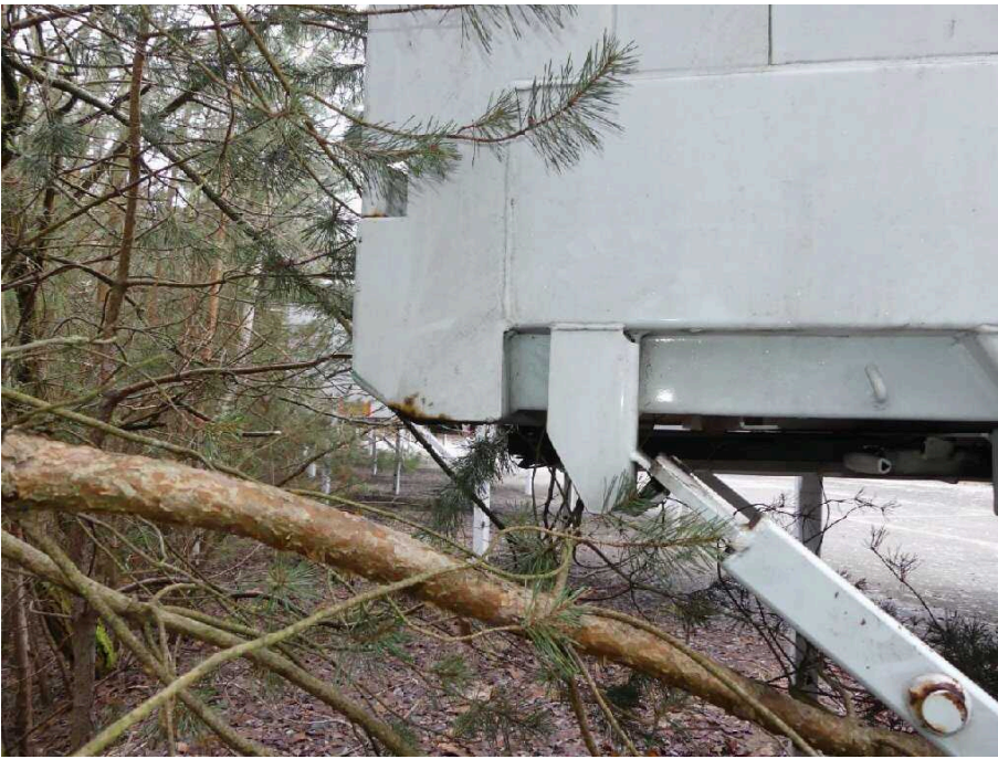
Bild 11 Fahrzeugheck Rahmen hinten rechts stark korrodiert
