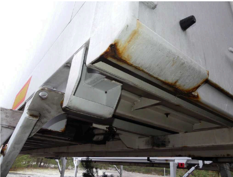
Bild 36 Fahrzeugheck Rahmen hinten links korrodiert
