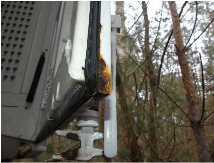
Bild 41 Fahrzeugheck Hecktür rechts korrodiert
