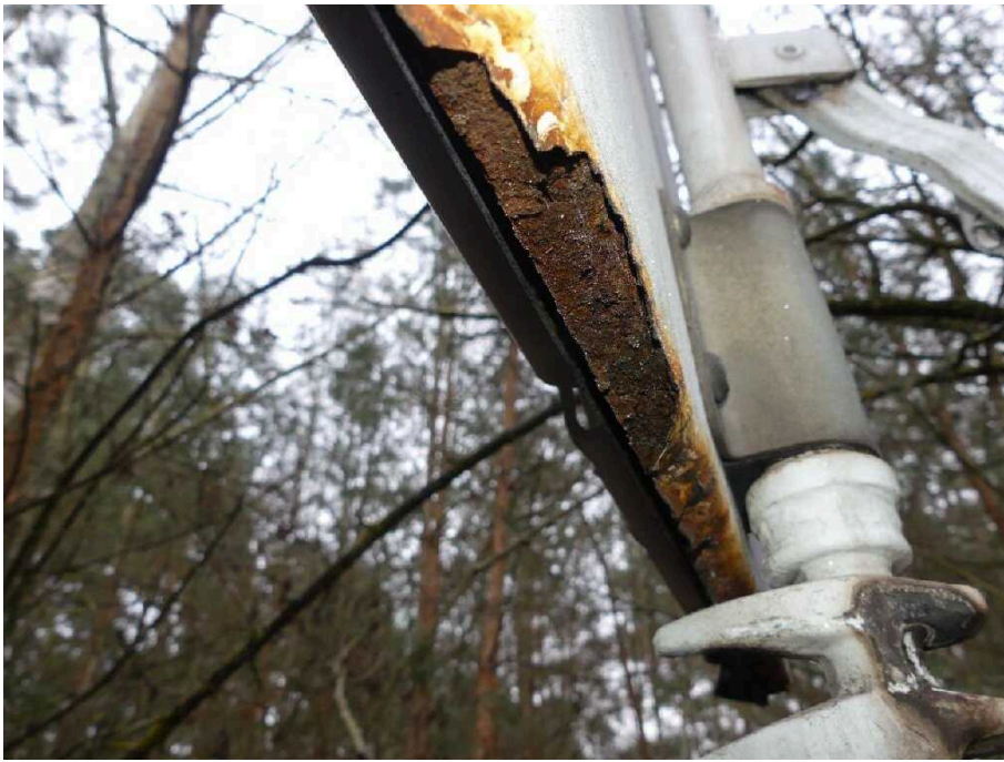
Bild 31 Fahrzeugheck Hecktür links stark korrodiert
