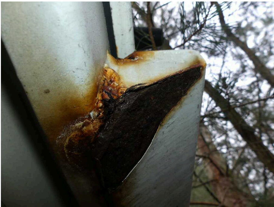
Bild 16 Fahrzeugheck Rahmen hinten rechts stark korrodiert
