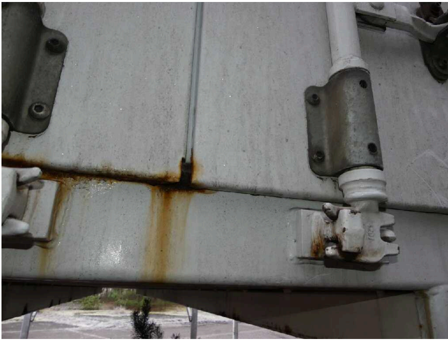
Bild 39 Fahrzeugheck Hecktür rechts korrodiert
