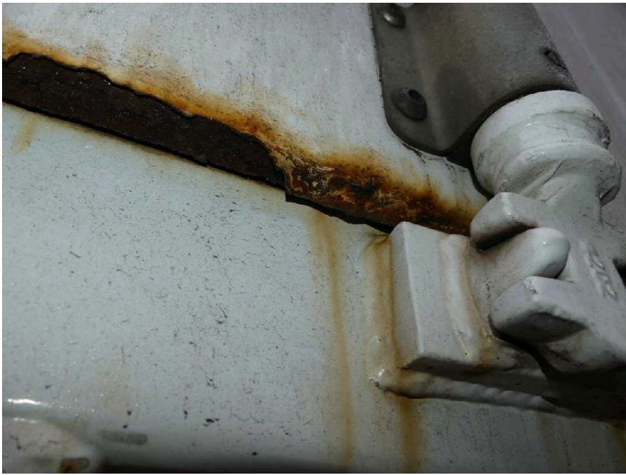
Bild 33 Fahrzeugheck Hecktür links stark korrodiert
