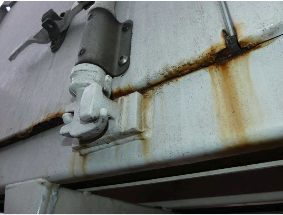
Bild 27 Fahrzeugheck Hecktür links stark korrodiert
