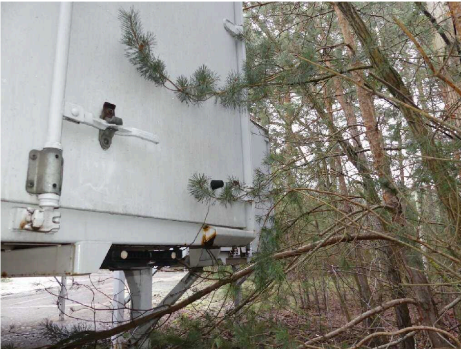
Bild 14 Fahrzeugheck Rahmen hinten rechts stark korrodiert
