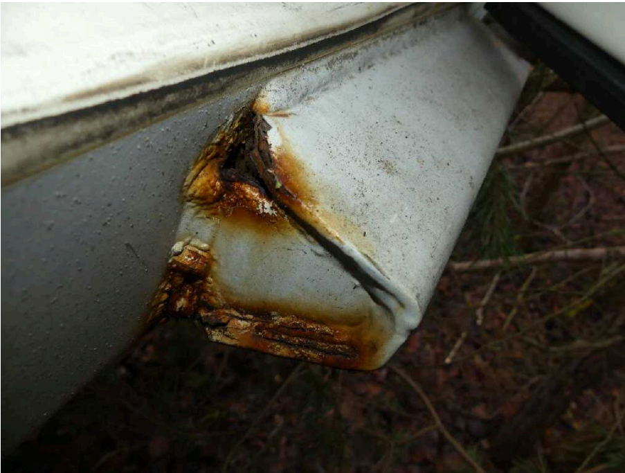
Bild 18 Fahrzeugheck Rahmen hinten rechts stark korrodiert
