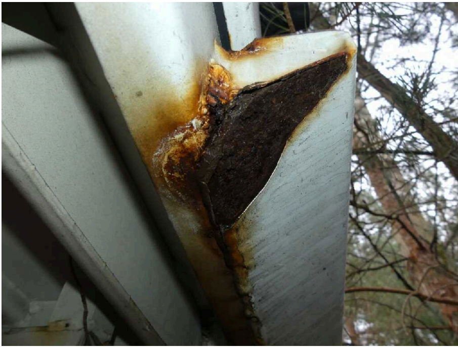
Bild 15 Fahrzeugheck Rahmen hinten rechts stark korrodiert
