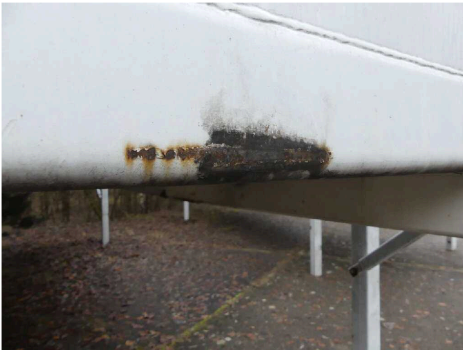
Bild 10 Aufbau Bodenrahmen vorne korrodiert
