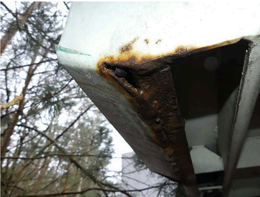
Bild 12 Fahrzeugheck Rahmen hinten rechts stark korrodiert
