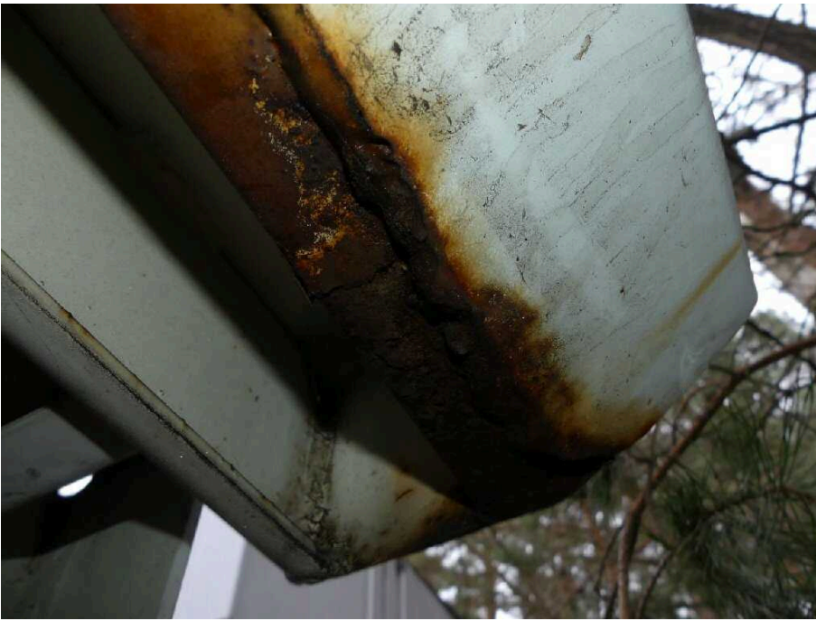
Bild 17 Fahrzeugheck Rahmen hinten rechts stark korrodiert
