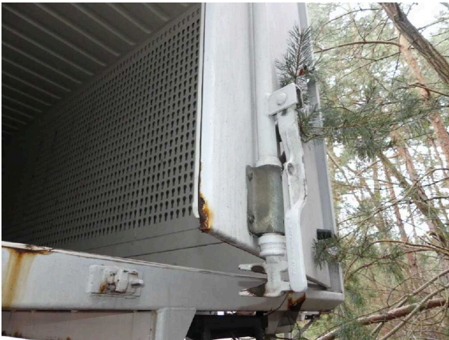
Bild 40 Fahrzeugheck Hecktür rechts korrodiert
