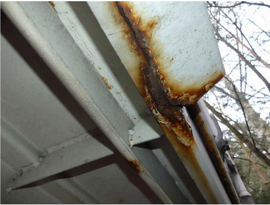
Bild 37 Fahrzeugheck Rahmen hinten links korrodiert
