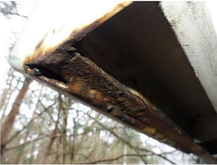
Bild 13 Fahrzeugheck Rahmen hinten rechts stark korrodiert
