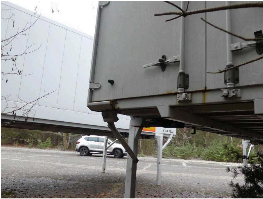
Bild 25 Fahrzeugheck Hecktür links stark korrodiert
