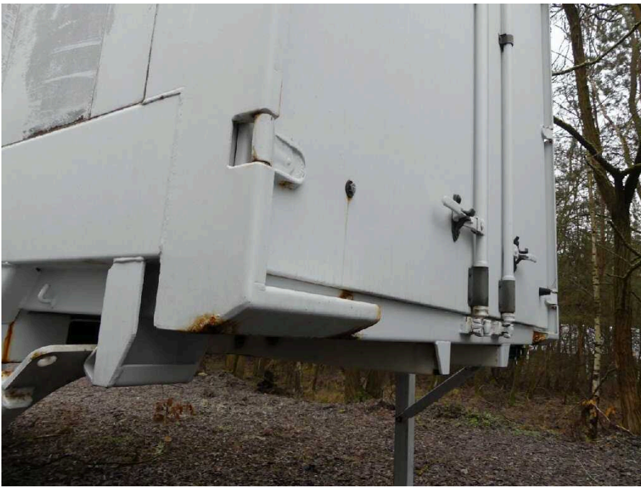
Bild 45 Fahrzeugheck Rahmen hinten links korrodiert
