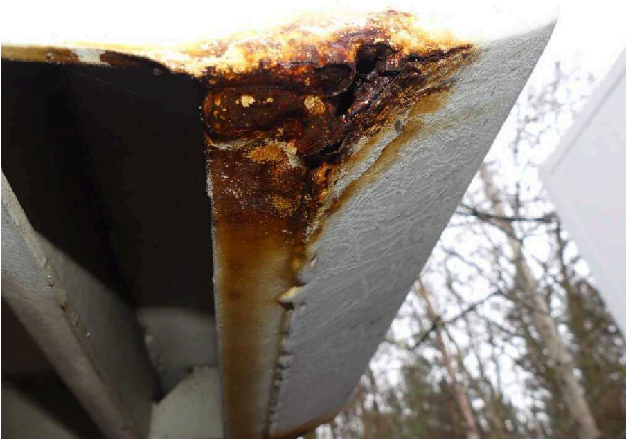
Bild 48 Fahrzeugheck Rahmen hinten links korrodiert
