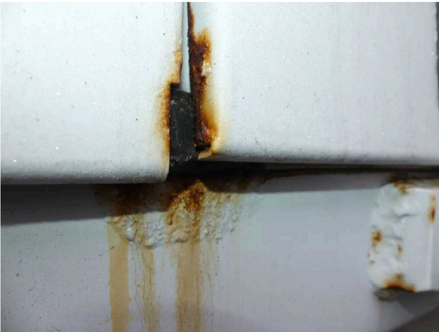
Bild 72 Fahrzeugheck Heckflügeltür links und rechts korrodiert
