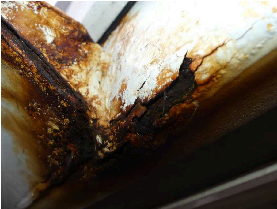
Bild 50 Fahrzeugheck Rahmen hinten links korrodiert
