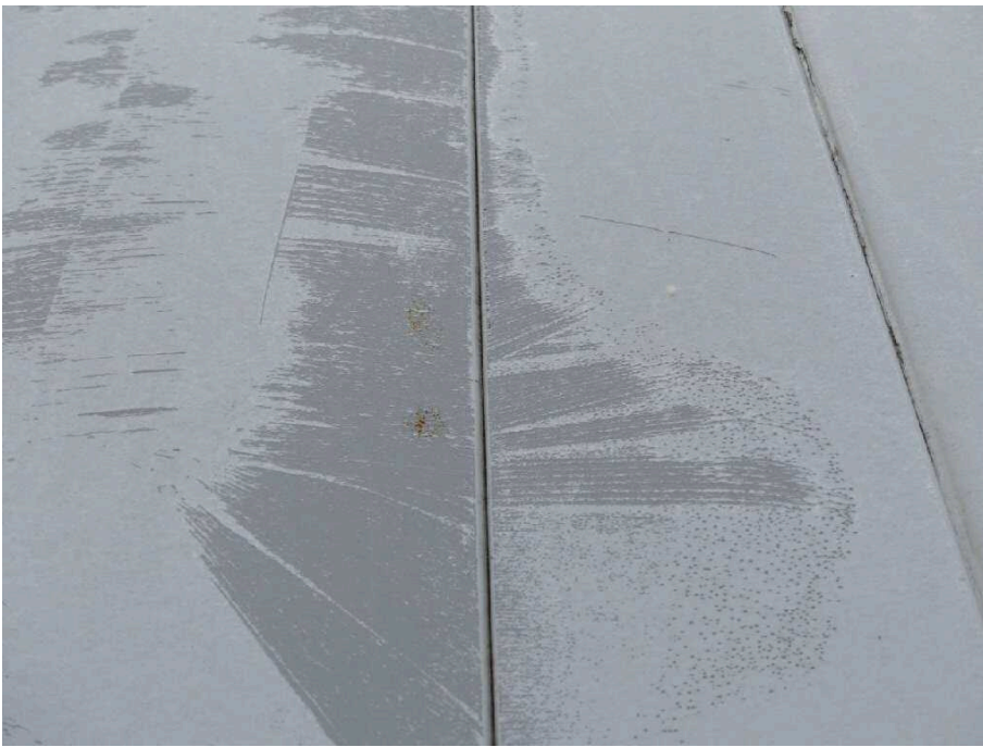
Bild 29 Fahrzeug Fahrzeug aussen Seite links, Lackablösung und verkratzt
