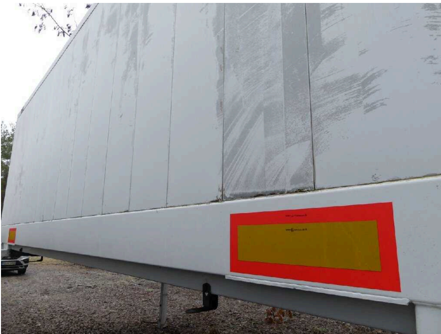
Bild 30 Fahrzeug Fahrzeug aussen Seite links, Lackablösung und verkratzt
