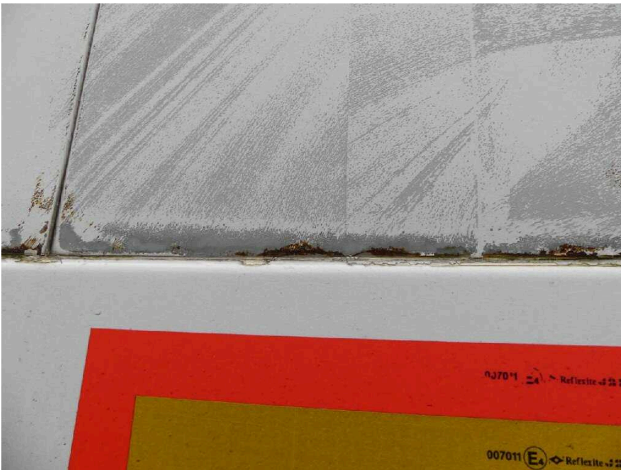
Bild 31 Fahrzeug Fahrzeug aussen Seite links, Lackablösung und verkratzt
