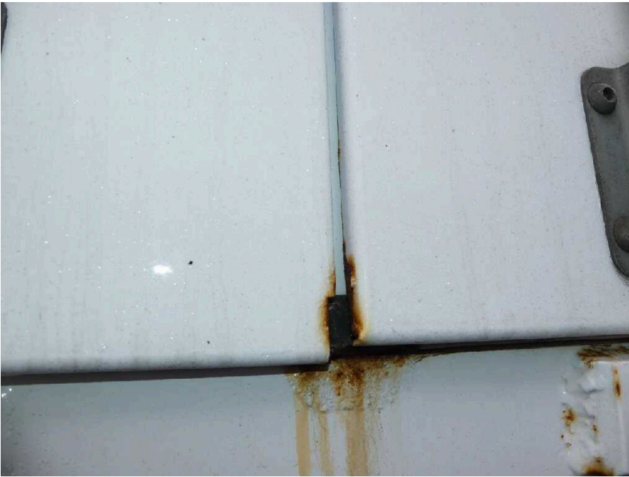
Bild 71 Fahrzeugheck Heckflügeltür links und rechts korrodiert
