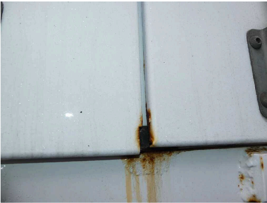
Bild 63 Fahrzeugheck Rahmen hinten Mitte korrodiert
