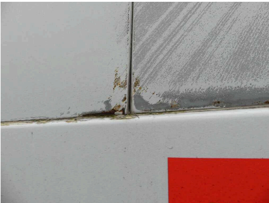
Bild 32 Fahrzeug Fahrzeug aussen Seite links, Lackablösung und verkratzt
