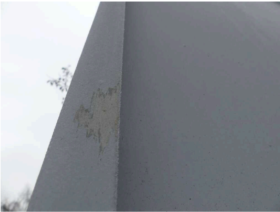
Bild 69 Fahrzeugheck Rahmen hinten Eckrahmen links angestoßen
