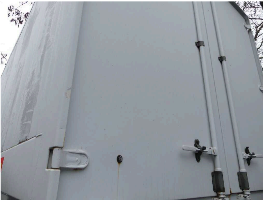
Bild 67 Fahrzeugheck Rahmen hinten Eckrahmen links angestoßen
