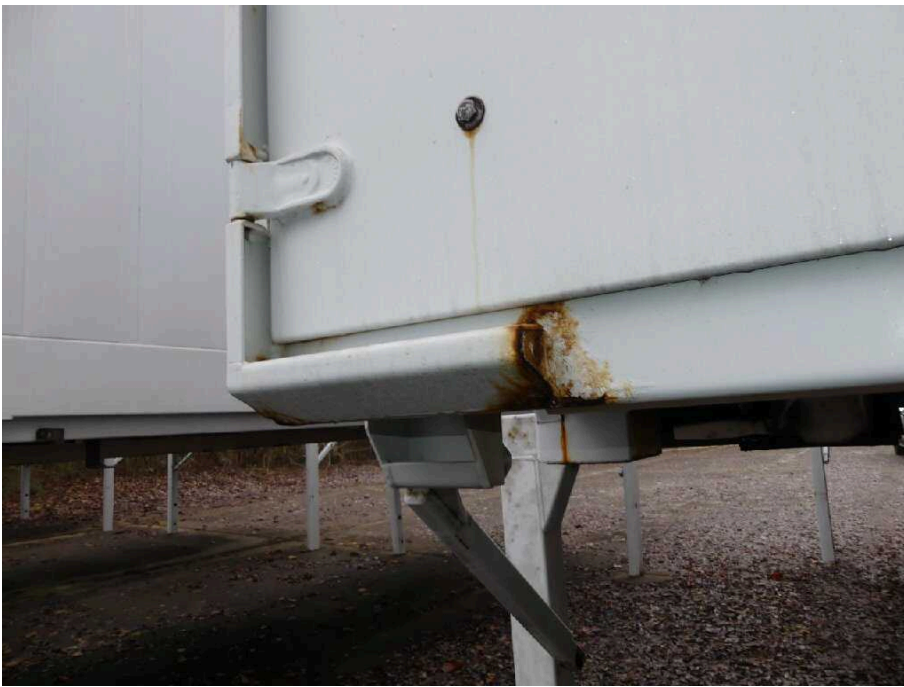
Bild 49 Fahrzeugheck Rahmen hinten links korrodiert
