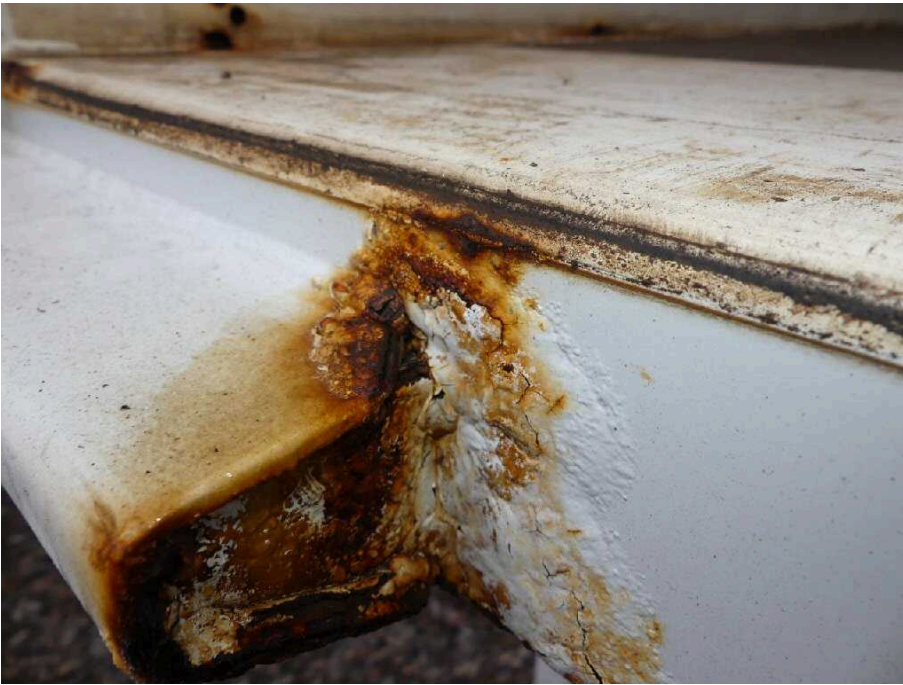
Bild 53 Fahrzeugheck Rahmen hinten links korrodiert
