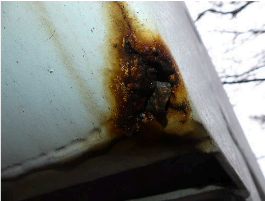
Bild 59 Fahrzeugheck Rahmen hinten rechts korrodiert
