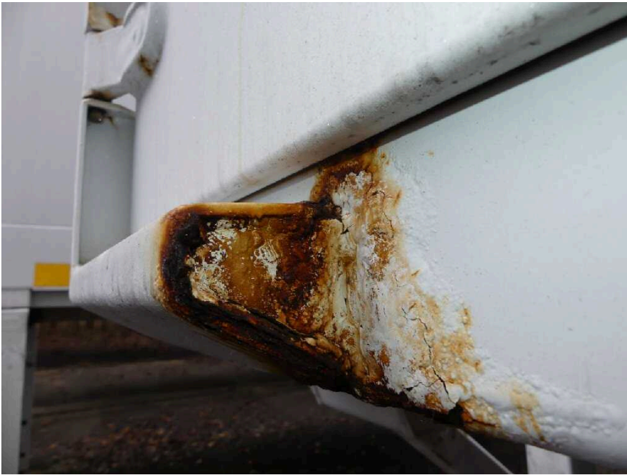
Bild 51 Fahrzeugheck Rahmen hinten links korrodiert
