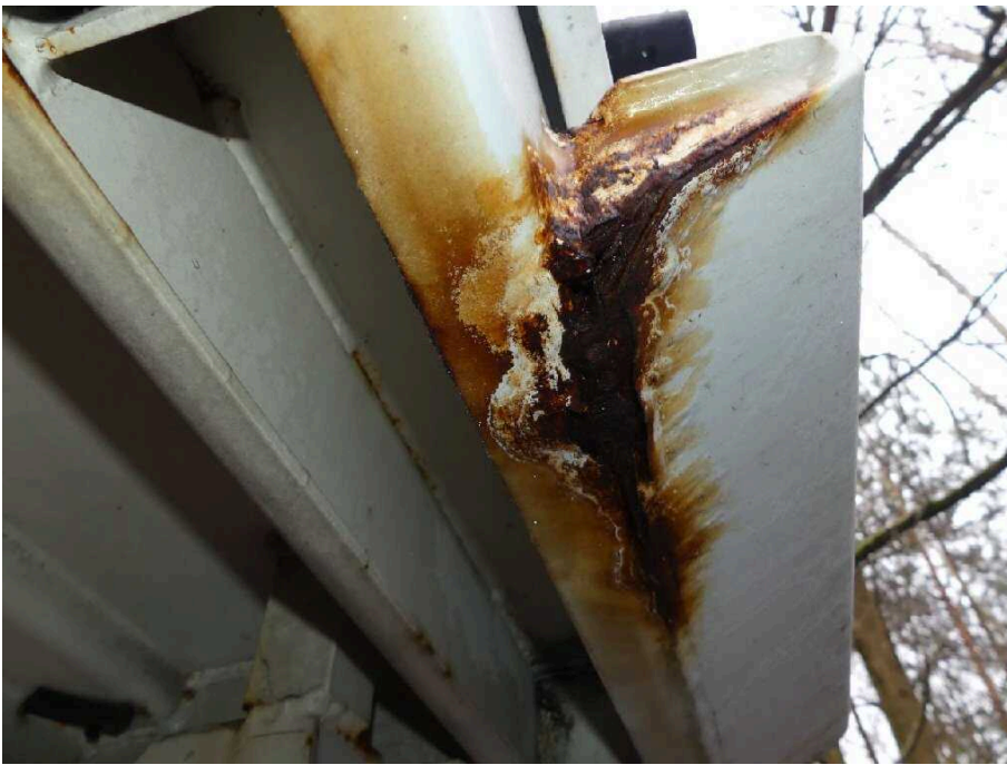
Bild 61 Fahrzeugheck Rahmen hinten rechts korrodiert
