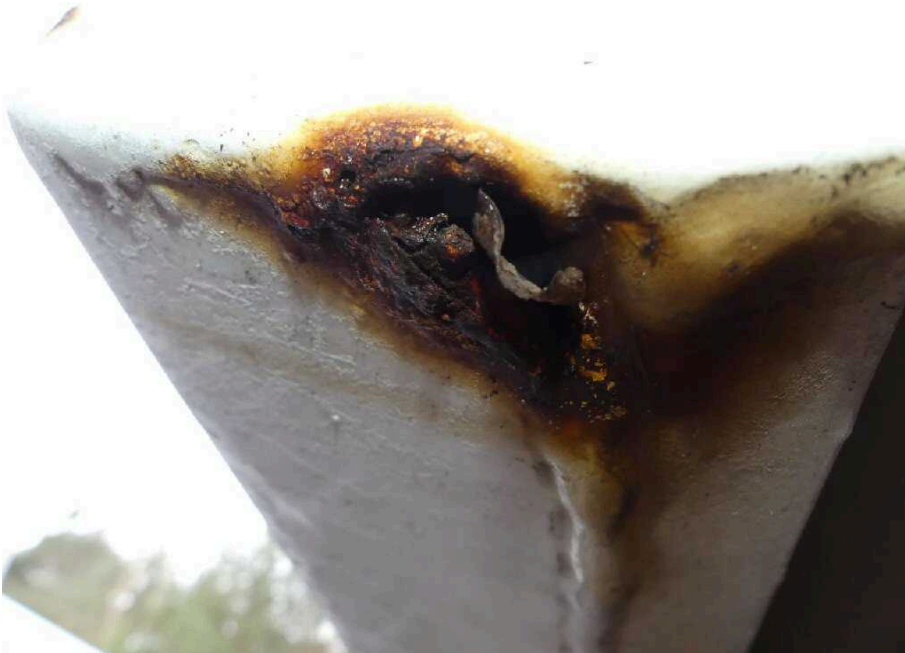
Bild 60 Fahrzeugheck Rahmen hinten rechts korrodiert
