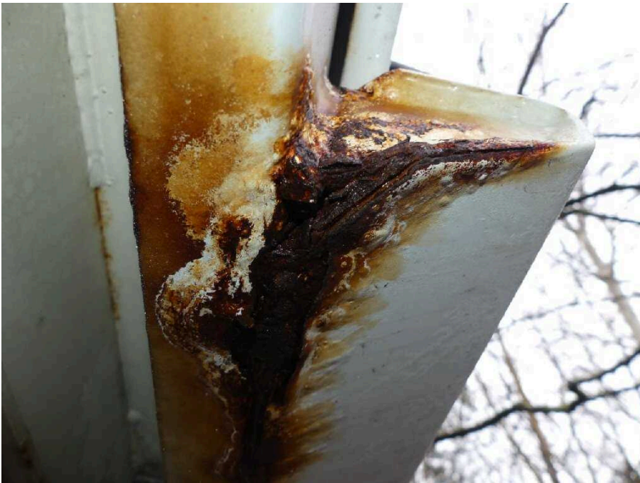
Bild 58 Fahrzeugheck Rahmen hinten rechts korrodiert
