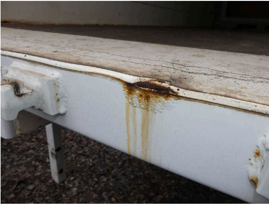
Bild 65 Fahrzeugheck Rahmen hinten Mitte korrodiert
