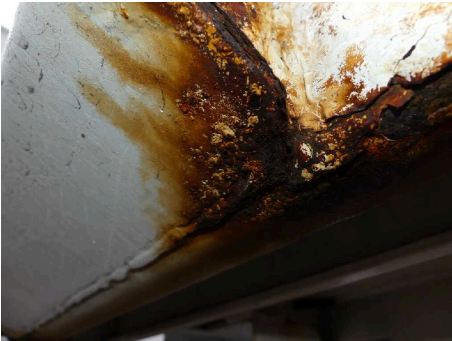
Bild 52 Fahrzeugheck Rahmen hinten links korrodiert
