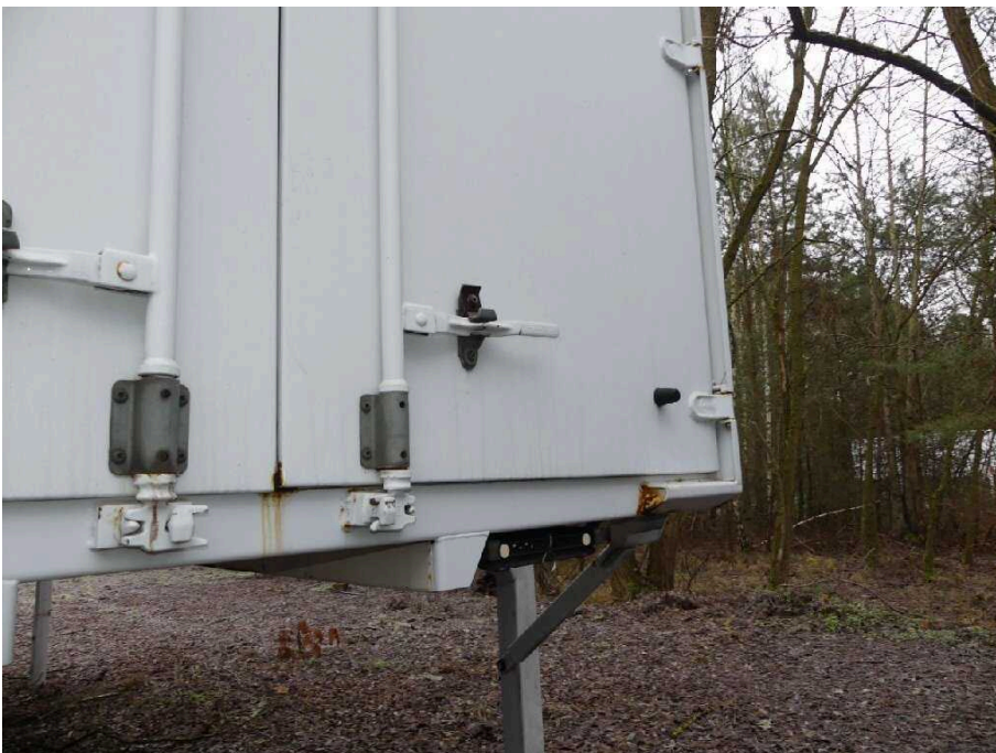
Bild 62 Fahrzeugheck Rahmen hinten Mitte korrodiert
