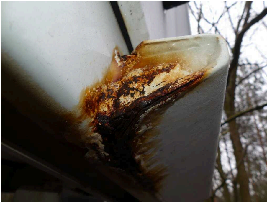
Bild 57 Fahrzeugheck Rahmen hinten rechts korrodiert
