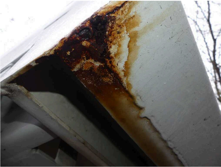
Bild 47 Fahrzeugheck Rahmen hinten links korrodiert
