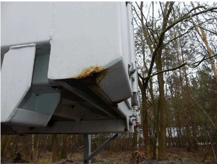
Bild 46 Fahrzeugheck Rahmen hinten links korrodiert
