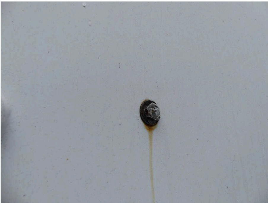
Bild 55 Fahrzeugheck Heckflügeltür links Anschlaggummi fehlt
