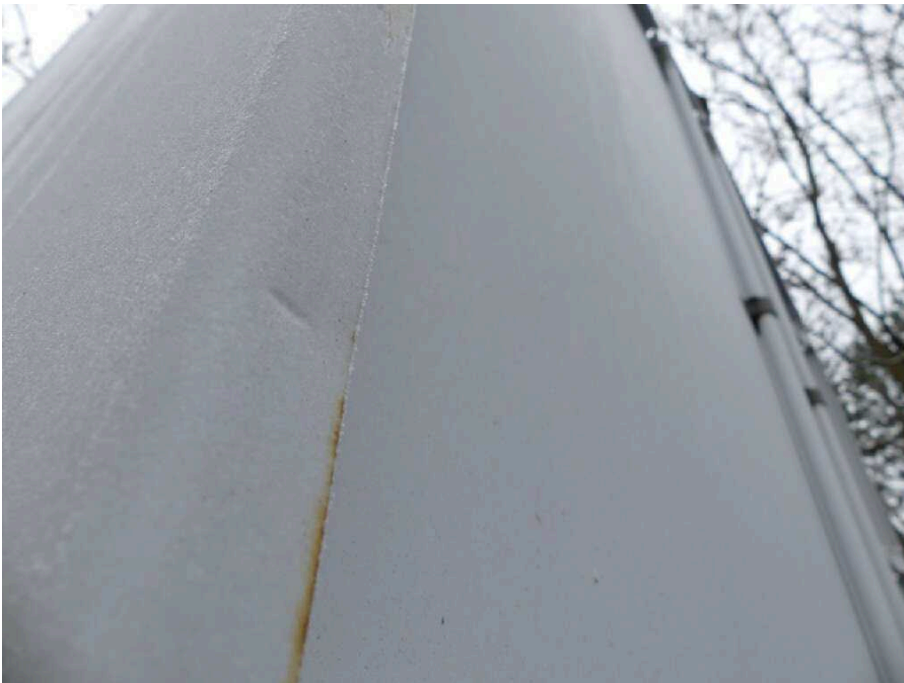
Bild 68 Fahrzeugheck Rahmen hinten Eckrahmen links angestoßen
