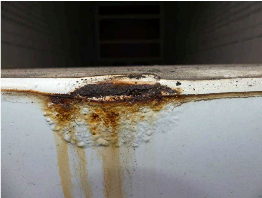
Bild 66 Fahrzeugheck Rahmen hinten Mitte korrodiert
