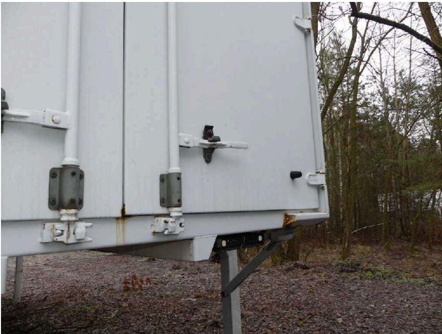
Bild 70 Fahrzeugheck Heckflügeltür links und rechts korrodiert
