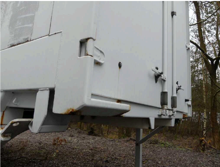
Bild 54 Fahrzeugheck Heckflügeltür links Anschlaggummi fehlt
