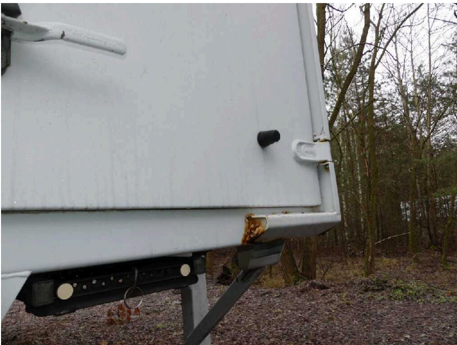
Bild 56 Fahrzeugheck Rahmen hinten rechts korrodiert
