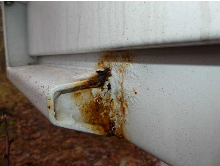
Bild 37 Fahrzeugheck Rahmen hinten links korrodiert
