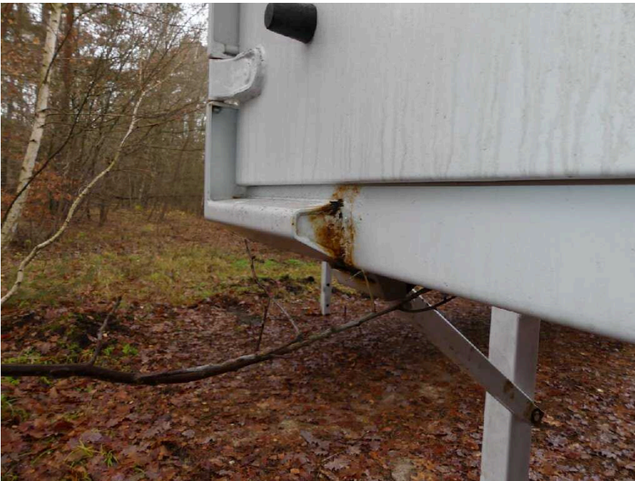
Bild 36 Fahrzeugheck Rahmen hinten links korrodiert
