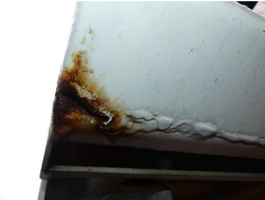
Bild 34 Fahrzeugheck Rahmen hinten links korrodiert
