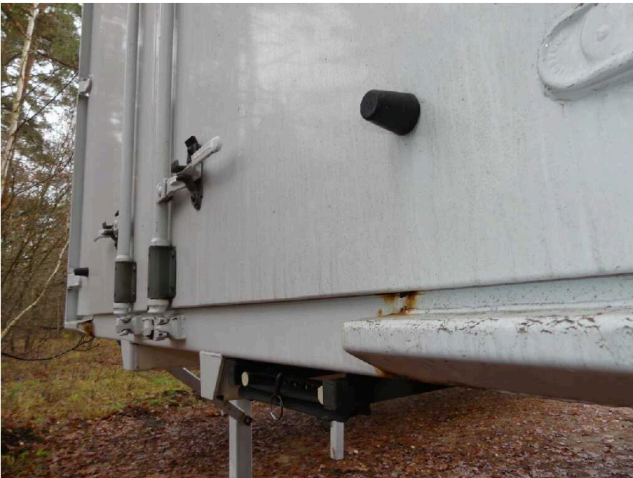
Bild 42 Fahrzeugheck Rahmen hinten rechts korrodiert
