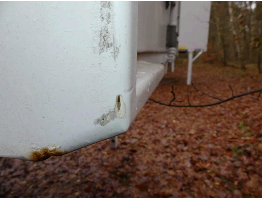
Bild 35 Fahrzeugheck Rahmen hinten links korrodiert
