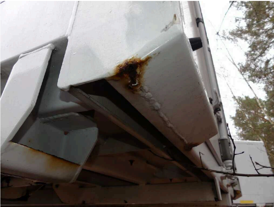
Bild 33 Fahrzeugheck Rahmen hinten links korrodiert
