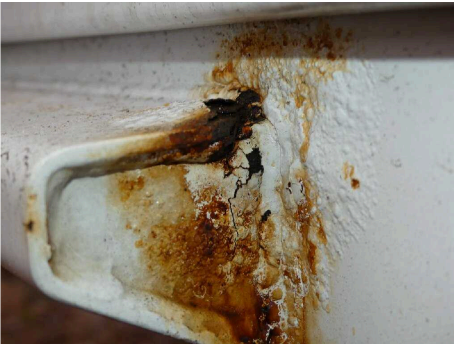
Bild 38 Fahrzeugheck Rahmen hinten links korrodiert
