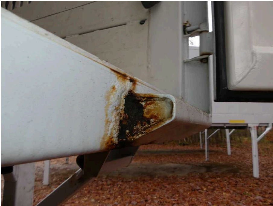
Bild 43 Fahrzeugheck Rahmen hinten rechts korrodiert
