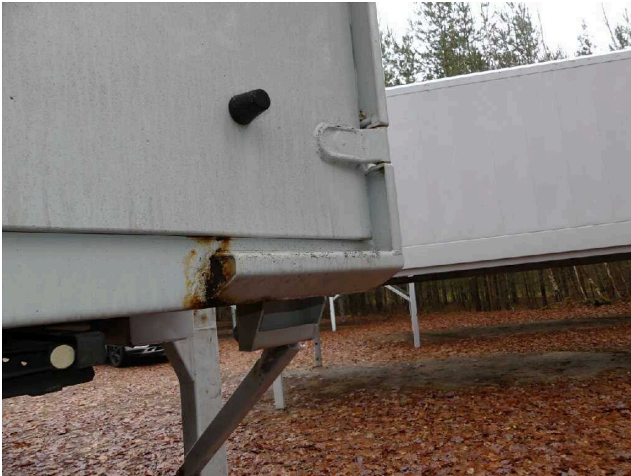
Bild 39 Fahrzeugheck Rahmen hinten rechts korrodiert
