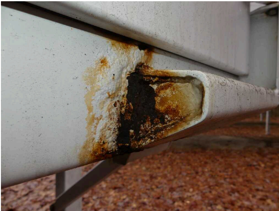
Bild 40 Fahrzeugheck Rahmen hinten rechts korrodiert
