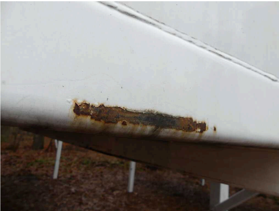
Bild 10 Aufbau Bodenrahmen vorne korrodiert
