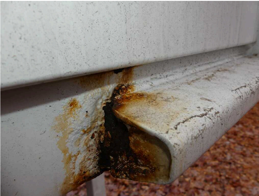
Bild 41 Fahrzeugheck Rahmen hinten rechts korrodiert
