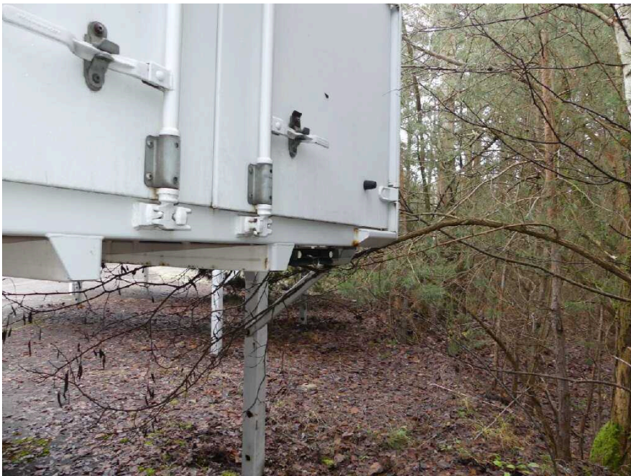
Bild 17 Fahrzeugheck Rahmen hinten hinten rechts korrodiert
