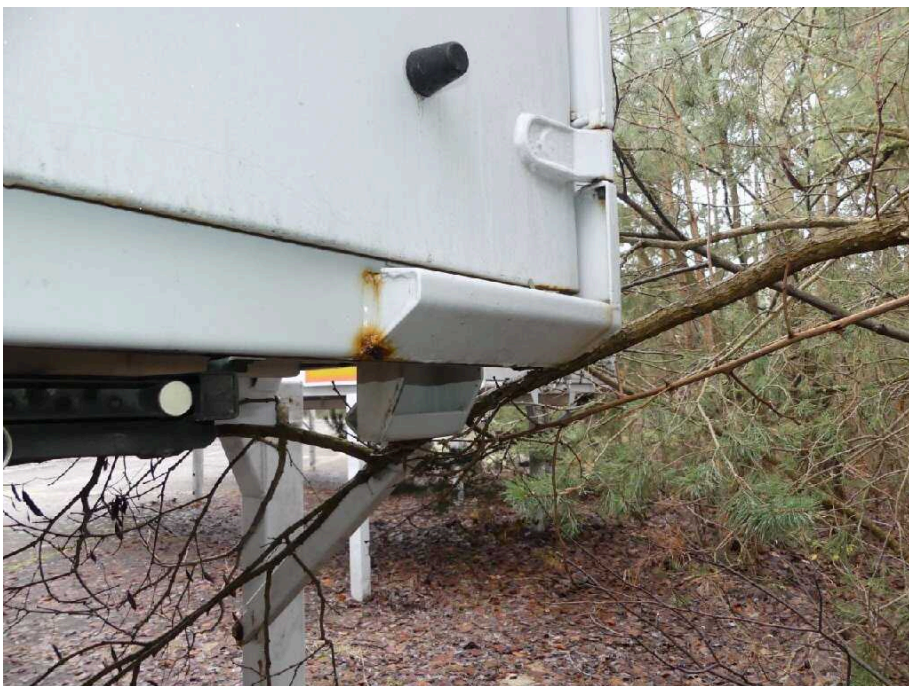
Bild 18 Fahrzeugheck Rahmen hinten hinten rechts korrodiert
