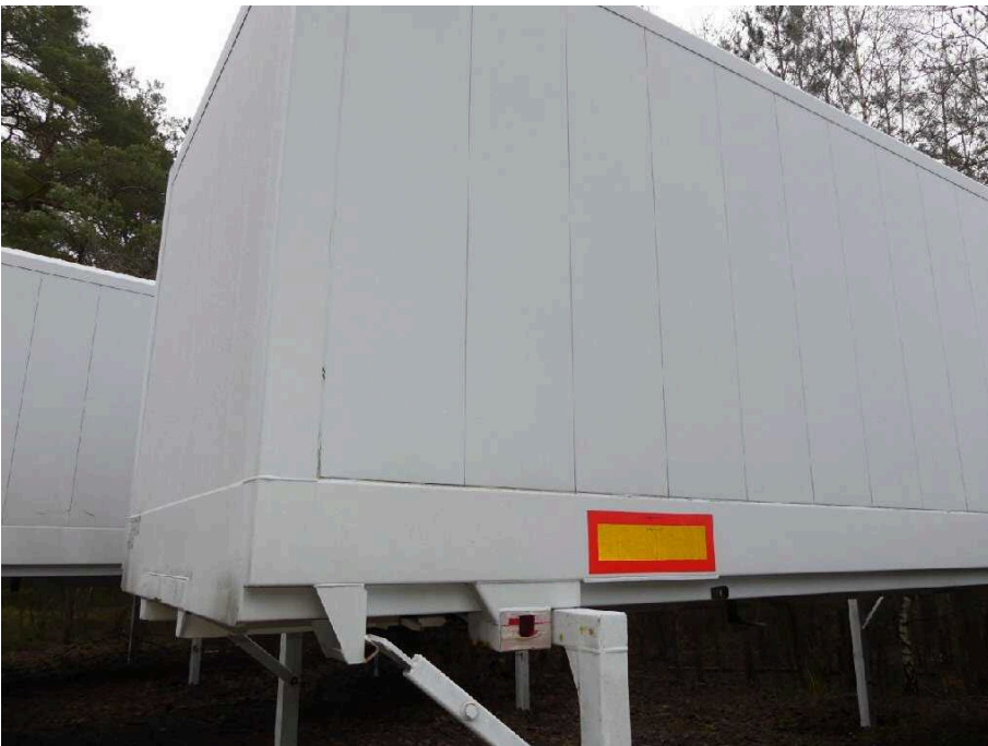
Bild 28 Fahrzeug aussen Seite links Lackablösung und verkratzt
