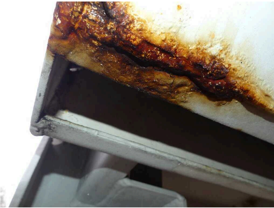
Bild 27 Fahrzeugheck Rahmen hinten links korrodiert
