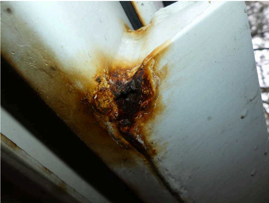
Bild 19 Fahrzeugheck Rahmen hinten hinten rechts korrodiert
