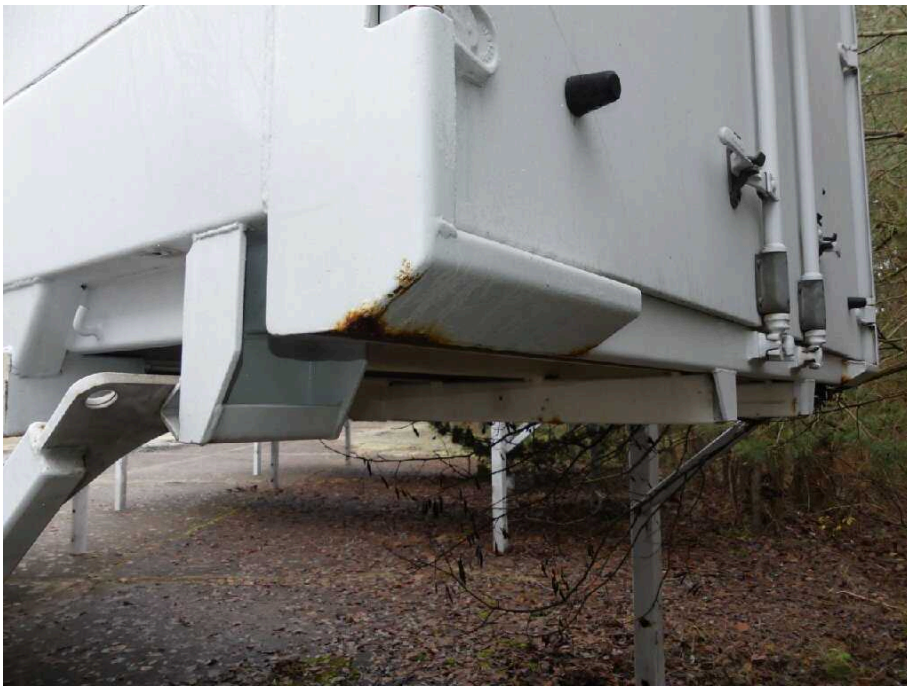
Bild 25 Fahrzeugheck Rahmen hinten links korrodiert
