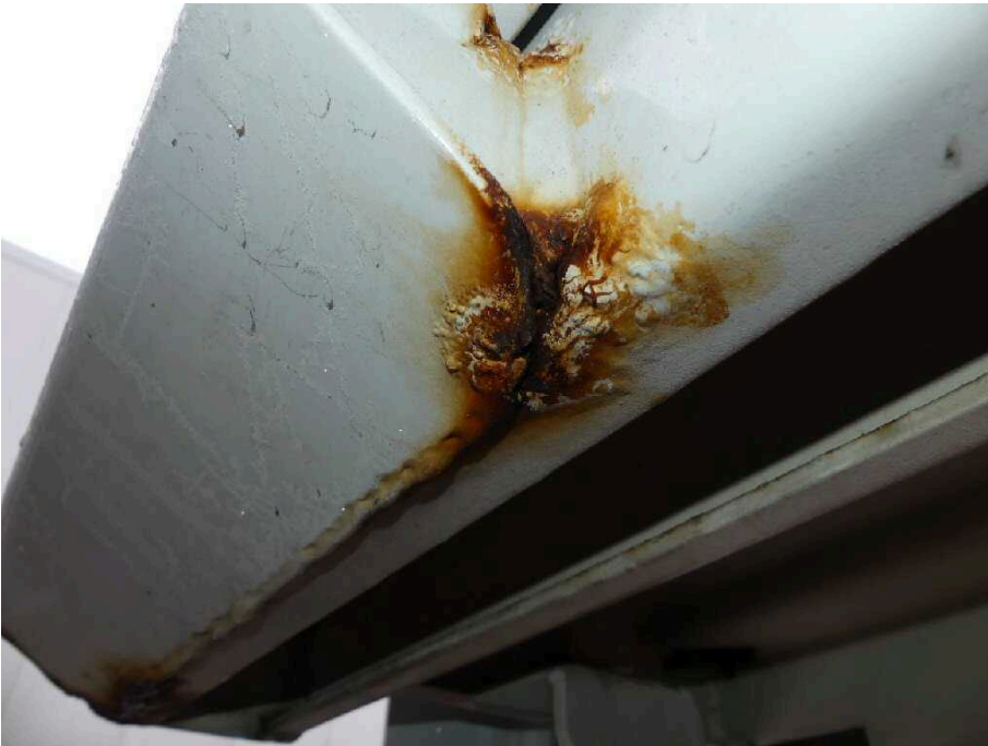
Bild 23 Fahrzeugheck Rahmen hinten links korrodiert
