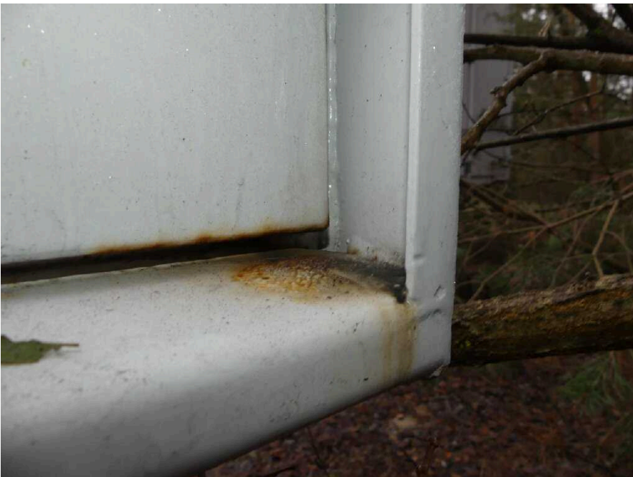
Bild 20 Fahrzeugheck Rahmen hinten hinten rechts korrodiert
