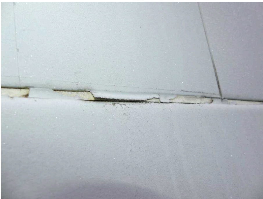
Bild 38 Fahrzeug Fahrzeug aussen Seite links Lackablösung und verkratzt
