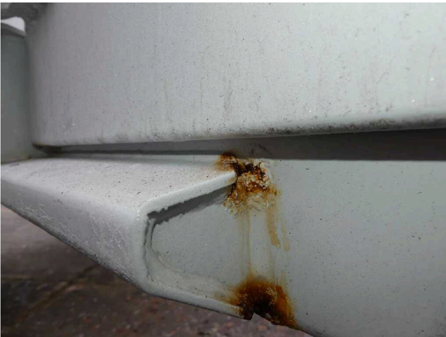
Bild 24 Fahrzeugheck Rahmen hinten links korrodiert
