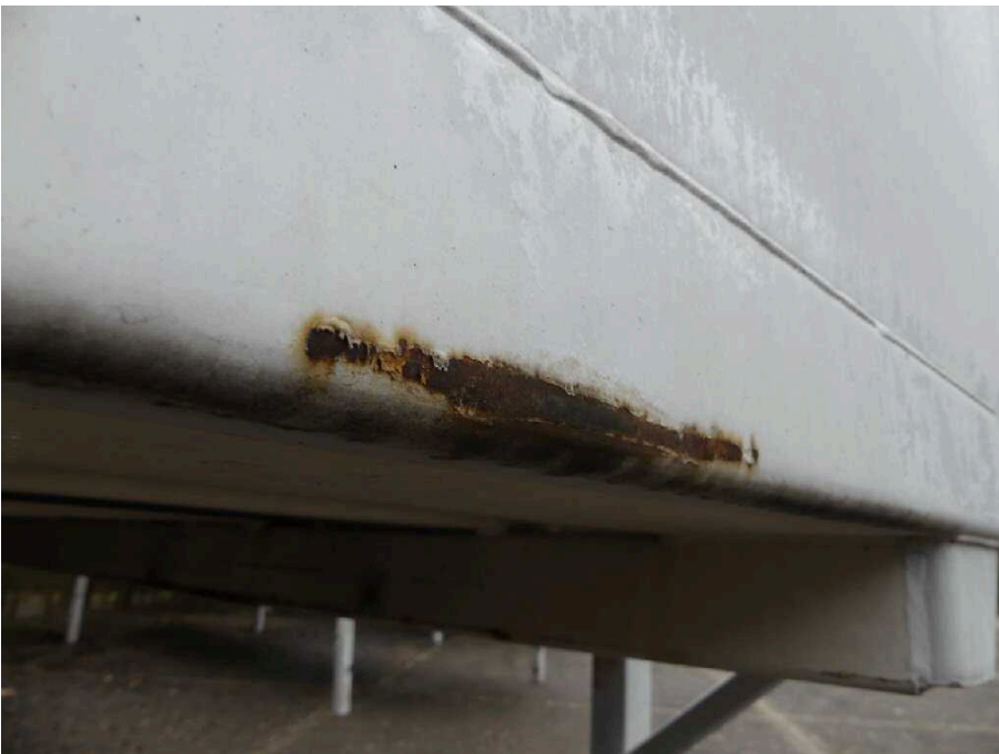
Bild 10 Aufbau Bodenrahmen vorne korrodiert
