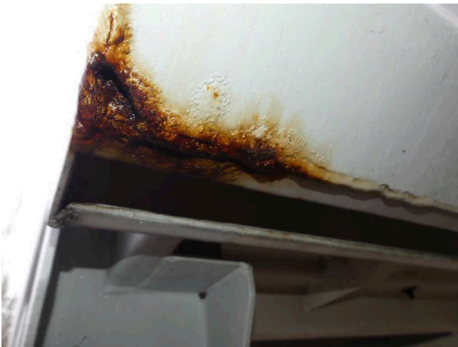
Bild 26 Fahrzeugheck Rahmen hinten links korrodiert
