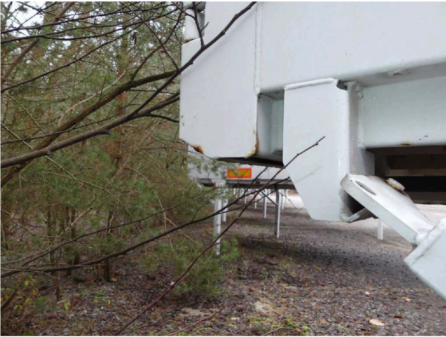
Bild 15 Fahrzeugheck Rahmen hinten hinten rechts korrodiert
