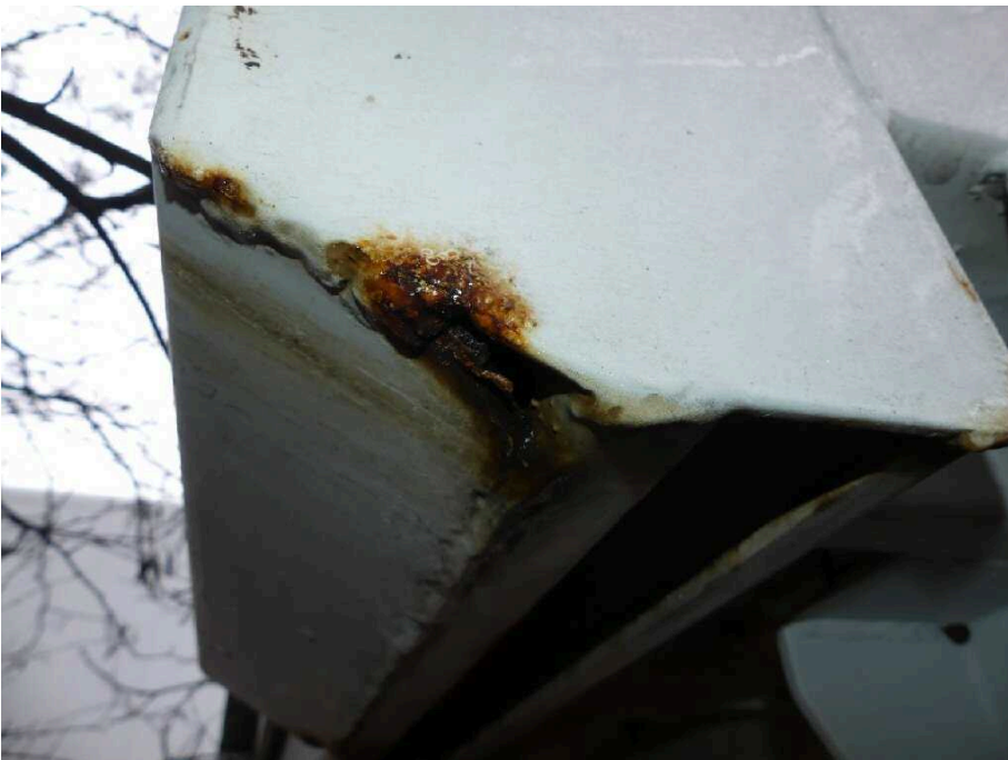
Bild 16 Fahrzeugheck Rahmen hinten hinten rechts korrodiert
