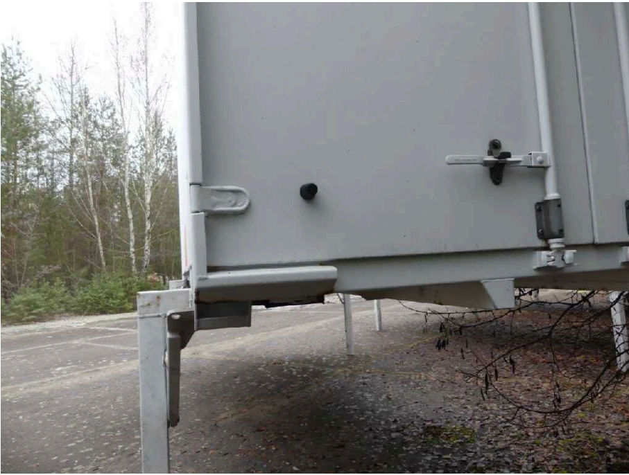
Bild 21 Fahrzeugheck Rahmen hinten links korrodiert
