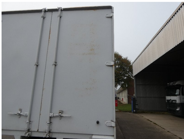
Bild 19: Tür Korrosion - instandsetzen und lackieren
