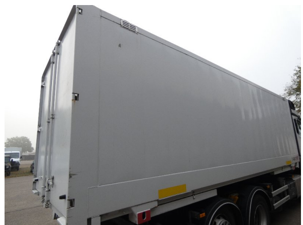
Bild 12: Seitenwand beschädigt - instandsetzen und lackieren
