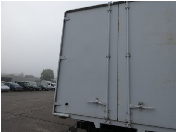
Bild 23: Tür Korrosion - instandsetzen und lackieren
