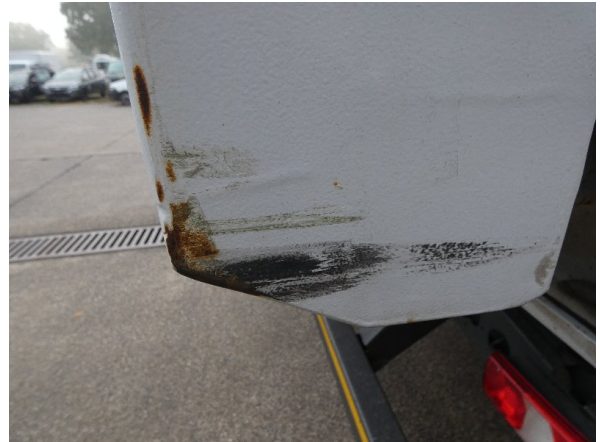
Bild 14: Seitenwand beschädigt - instandsetzen und lackieren
