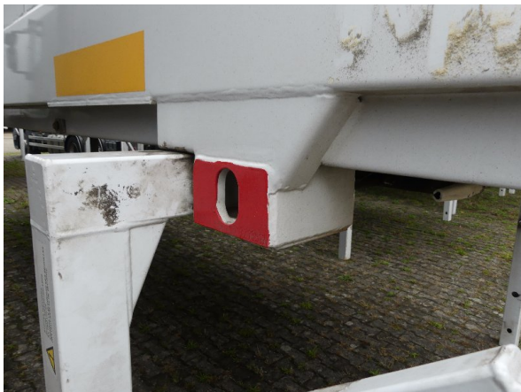
Bild 25: Aufnahmen Korrosion - instandsetzen und lackieren
