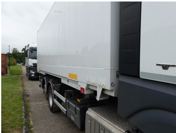
Bild 21: Abdichtung Seitenwand beschädigt - erneuern
