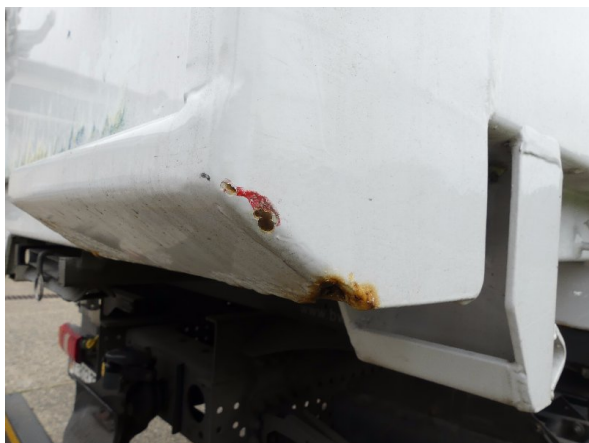
Bild 15: Eckbeplankung rechts Korrosion - instandsetzen und lackieren
