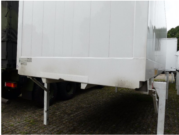
Bild 23: Frontwand Korrosion - instandsetzen und lackieren
