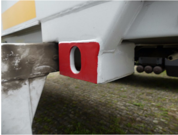
Bild 29: Aufnahmen Korrosion-instandsetzen und lackieren
