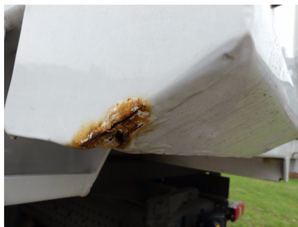
Bild 18: Eckbeplankung links Korrosion - instandsetzen und lackieren
