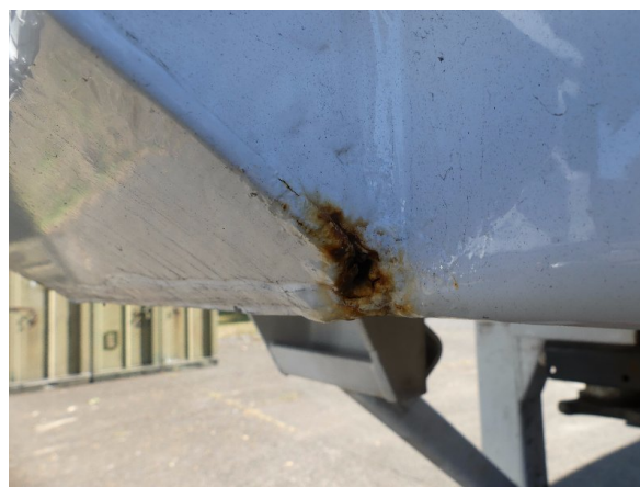
Bild 18: Eckbeplankung links Korrosion - instandsetzen und lackieren
