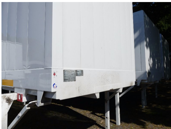
Bild 11: Frontwand Korrosion - instandsetzen und lackieren
