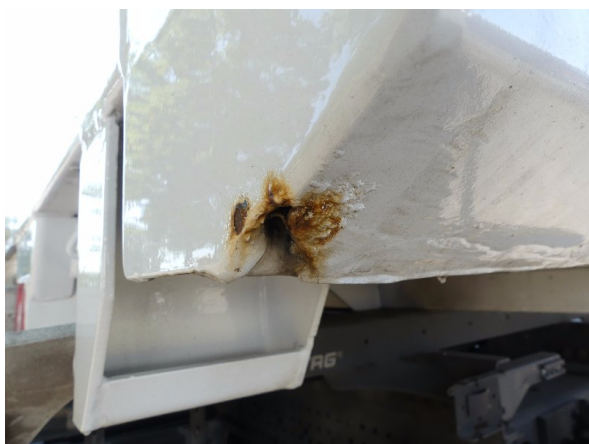
Bild 17: Eckbeplankung links Korrosion - instandsetzen und lackieren
