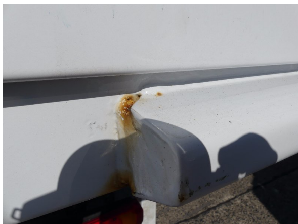
Bild 15: Eckbeplankung rechts Korrosion - instandsetzen und lackieren
