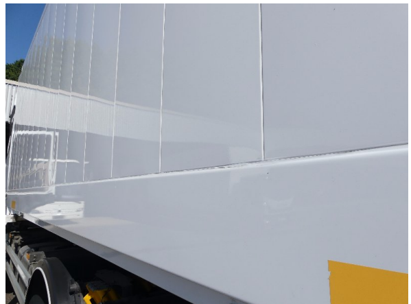
Bild 22: Abdichtung links und rechts beschädigt - erneuern
