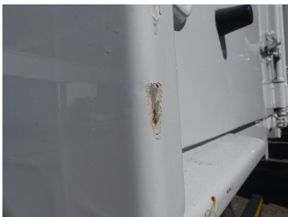
Bild 17: Eckbeplankung links Korrosion - instandsetzen und lackieren
