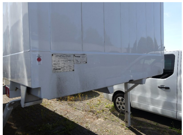
Bild 26: Frontwand Korrosion - instandsetzen und lackieren
