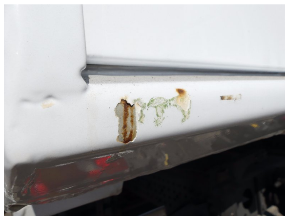
Bild 18: Eckbeplankung links Korrosion - instandsetzen und lackieren
