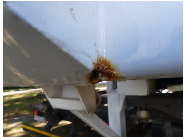
Bild 14: Eckbeplankung links Korrosion - instandsetzen und lackieren
