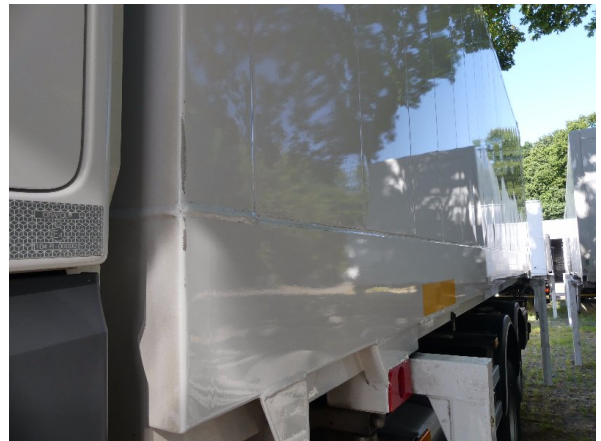
Bild 22: Seitenwand Lackmangel - Smart Repair
