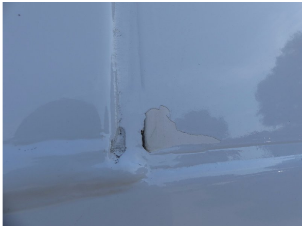
Bild 21: Seitenwand Lackmangel - Smart Repair
