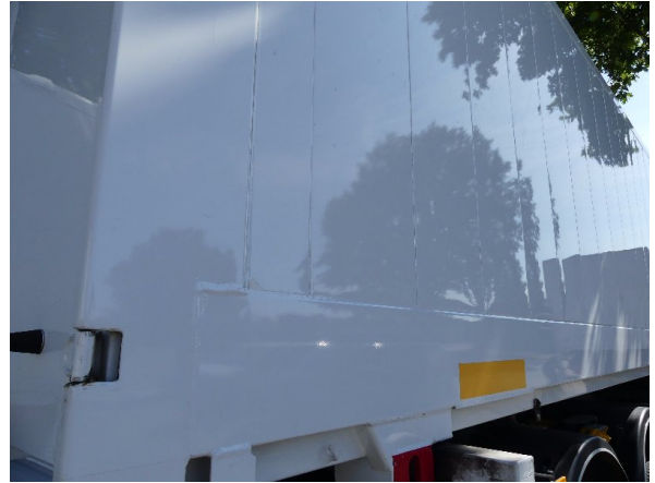
Bild 20: Seitenwand Lackmangel - Smart Repair
