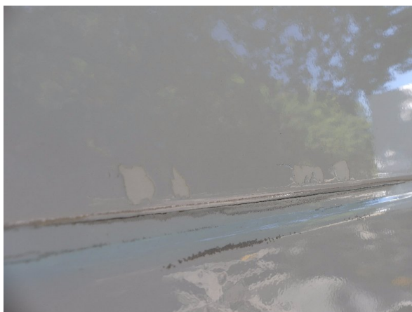
Bild 23: Seitenwand Lackmangel - Smart Repair
