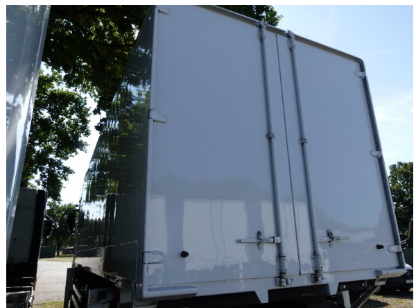
Bild 12: Eckbeplankung links Korrosion - instandsetzen und lackieren
