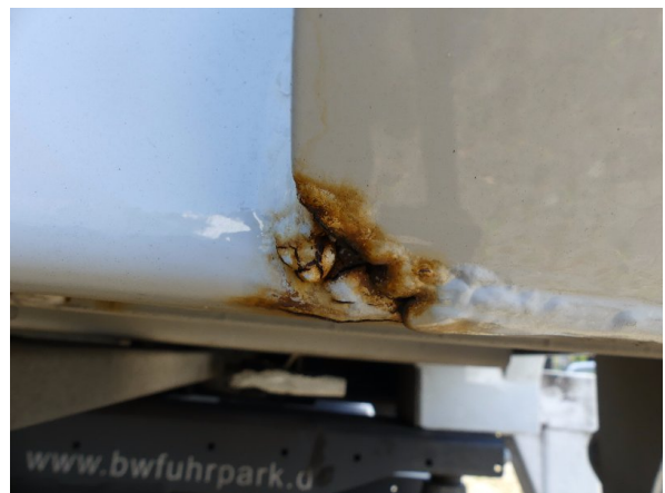
Bild 16: Eckbeplankung rechts Korrosion - instandsetzen und lackieren
