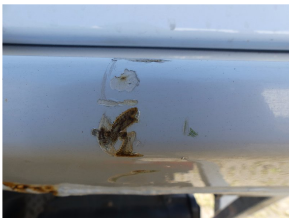
Bild 17: Eckbeplankung rechts Korrosion - instandsetzen und lackieren
