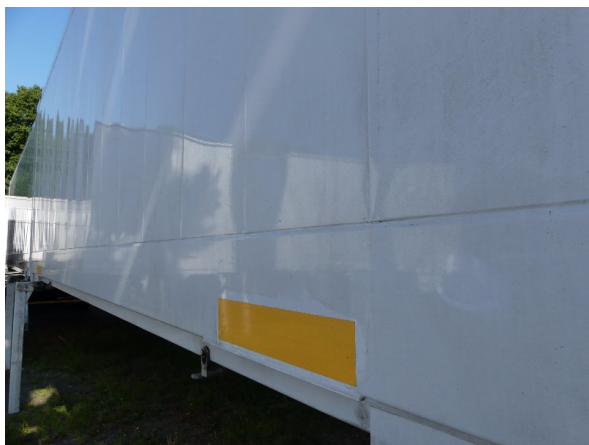
Bild 23: Abdichtungen rechts und links beschädigt - erneuern
