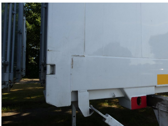
Bild 27: Seitenwand Lackmangel - lackieren
