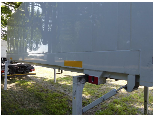
Bild 25: Abdichtungen rechts und links beschädigt - erneuern
