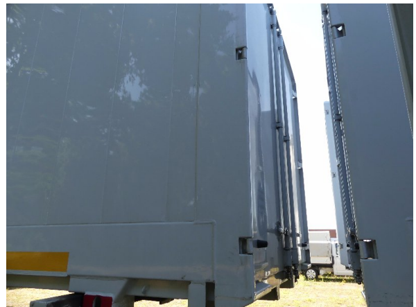
Bild 32: Eckbeplankung links Korrosion - instandsetzen und lackieren
