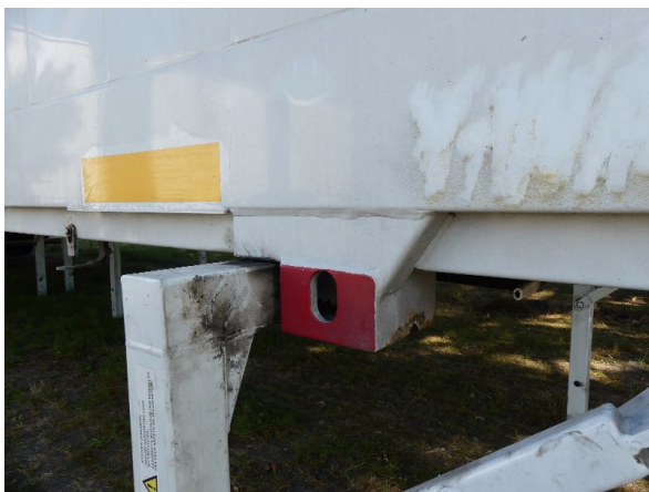
Bild 17: Aufnahmen Korrosion - instandsetzen und lackieren
