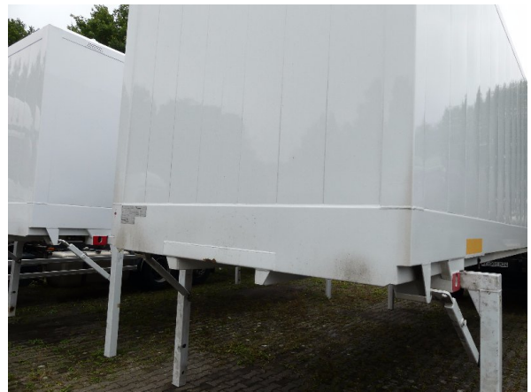
Bild 22: Frontwand Korrosion - instandsetzen und lackieren
