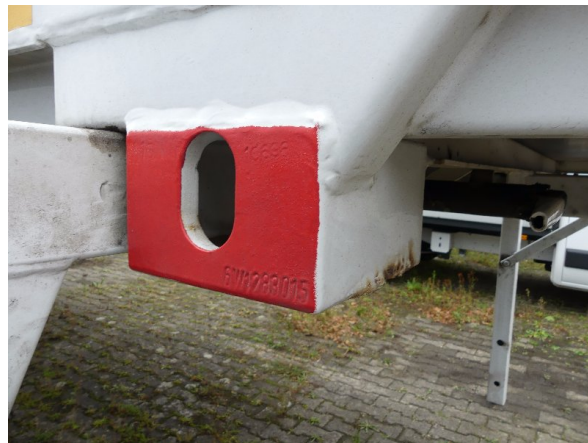
Bild 30: Aufnahmen Korrosion-instandsetzen und lackieren
