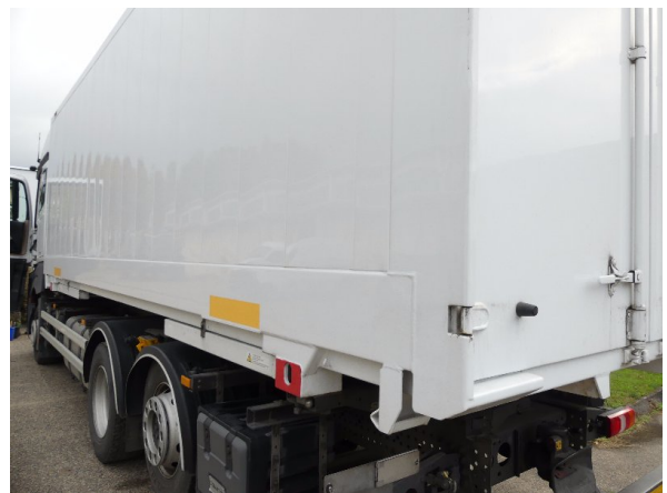
Bild 18: Abdichtung links und rechts beschädigt - erneuern
