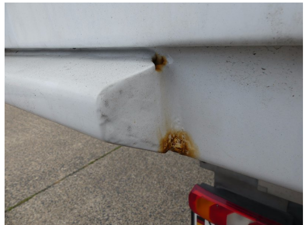
Bild 16: Eckbeplankung links Korrosion - instandsetzen und lackieren
