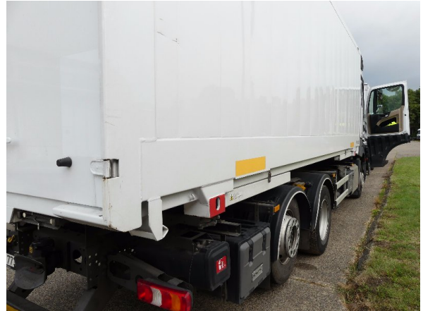
Bild 20: Abdichtung links und rechts beschädigt - erneuern
