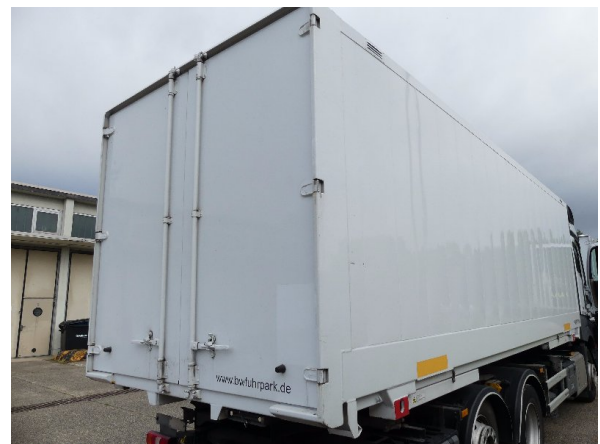
Bild 12: Eckbeplankung rechts Korrosion - instandsetzen und lackieren
