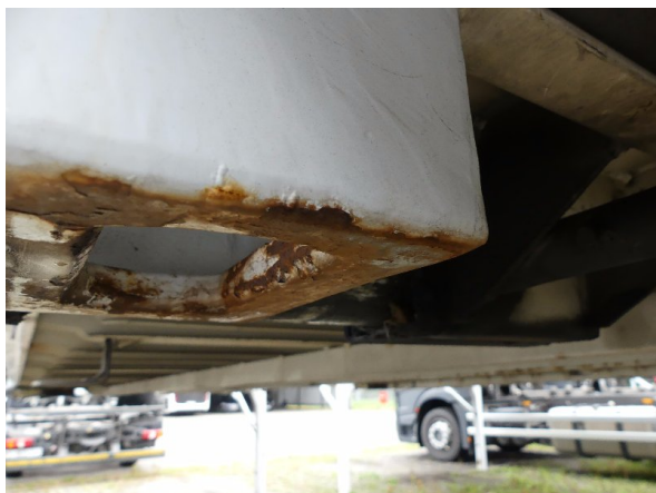
Bild 25: Aufnahmen Korrosion-instandsetzen und lackieren
