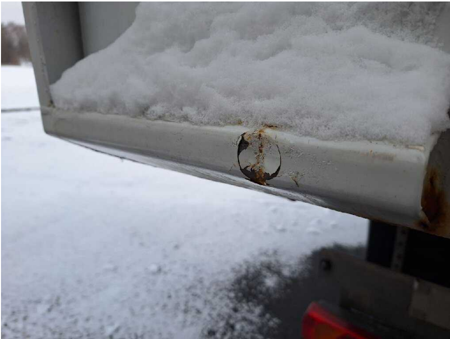
Bild 10 Fahrzeugfront Fahrzeugrahmen korrodiert
