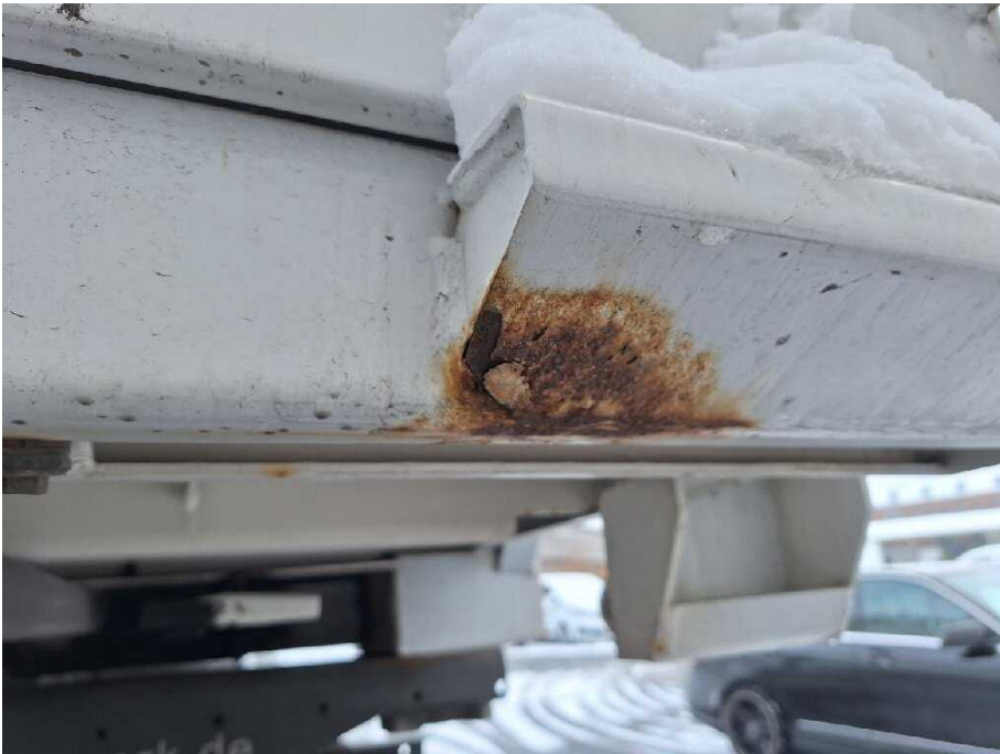
Bild 12 Fahrzeugfront Fahrzeugrahmen korrodiert
