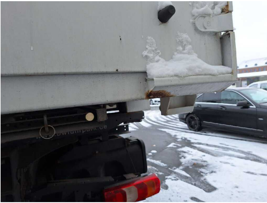
Bild 11 Fahrzeugfront Fahrzeugrahmen korrodiert
