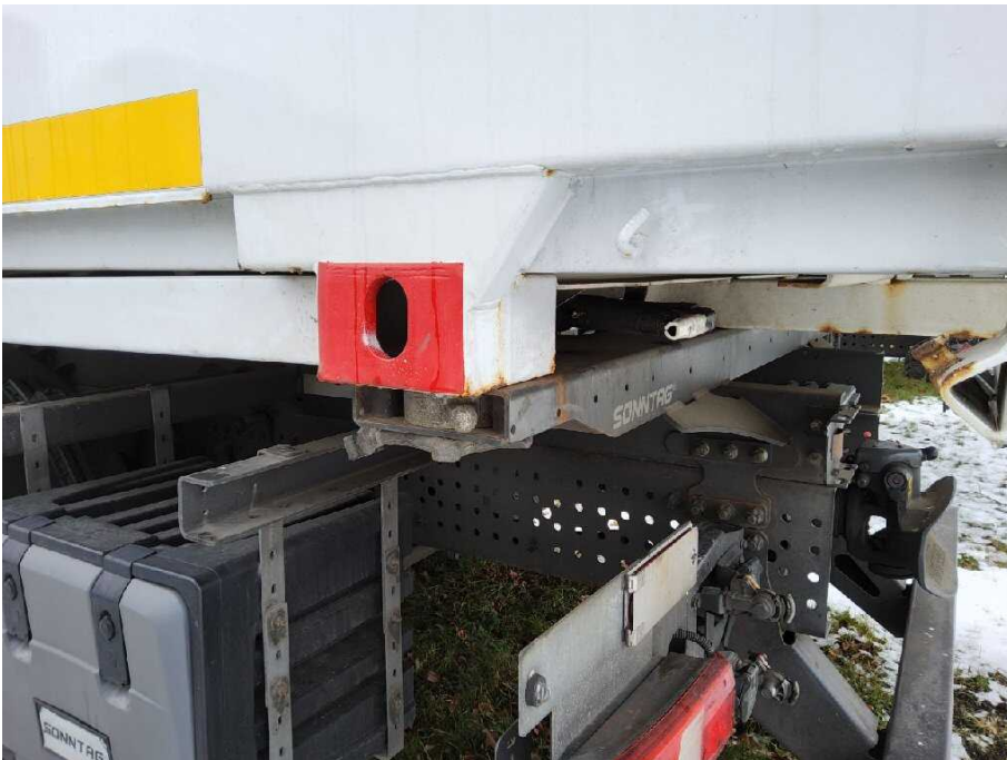
Bild 18 Aufbau Containerverriegelung korrodiert
