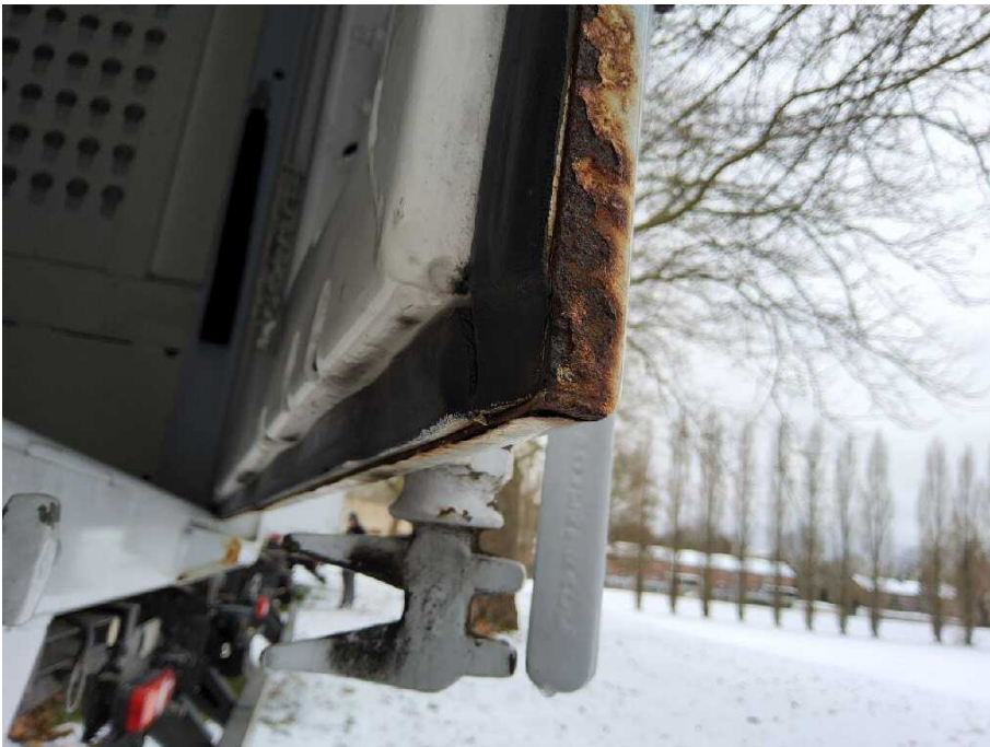
Bild 10 Fahrzeugheck Tür hinten rechts korrodiert
