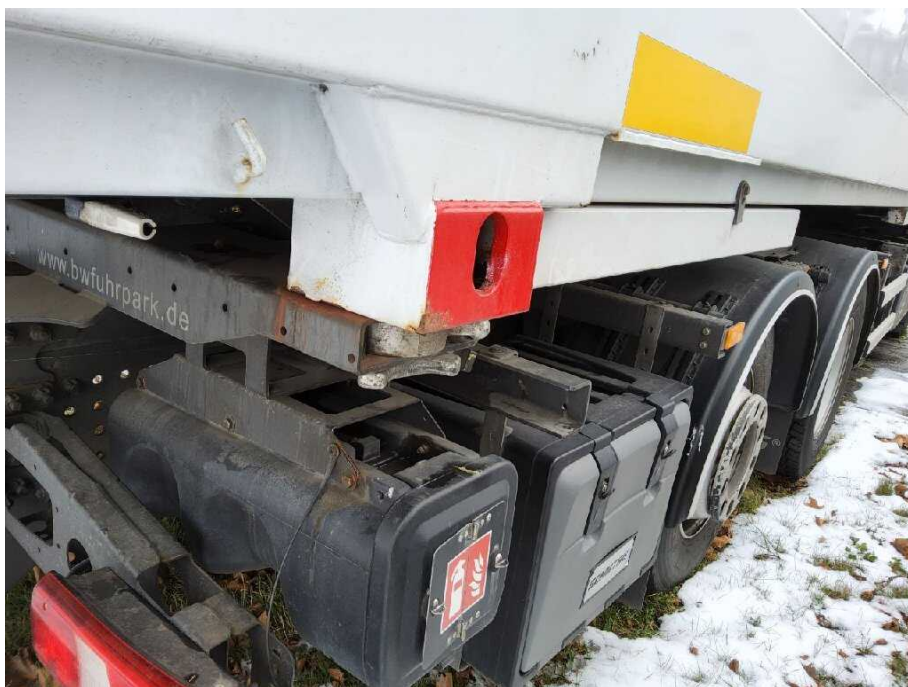
Bild 14 Aufbau Containerverriegelung korrodiert
