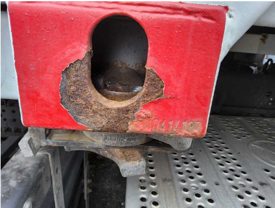
Bild 17 Aufbau Containerverriegelung korrodiert
