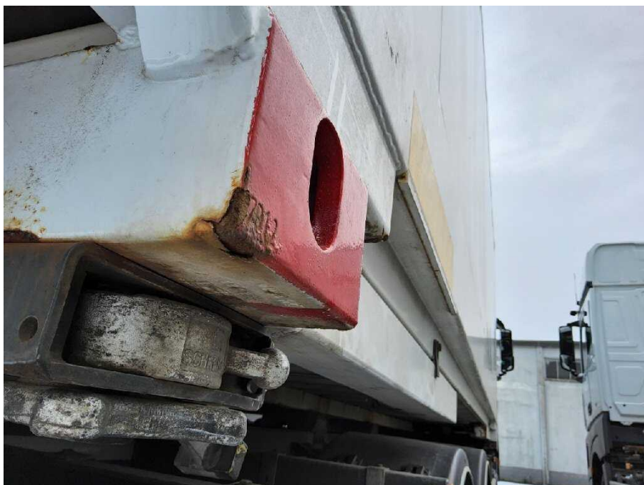
Bild 15 Aufbau Containerverriegelung korrodiert
