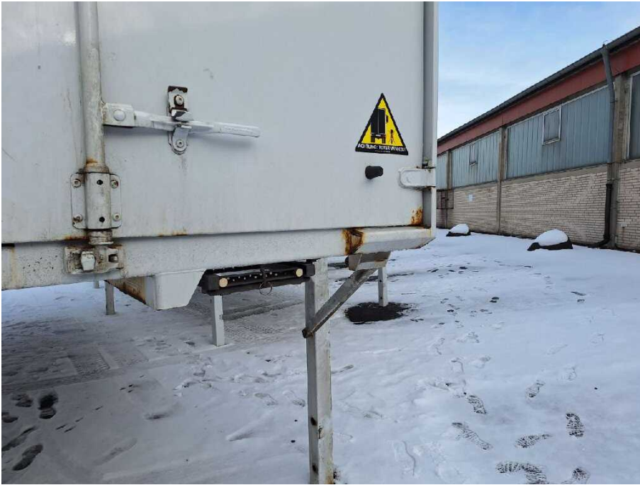
Bild 9 Fahrzeugfront Fahrzeugrahmen korrodiert
