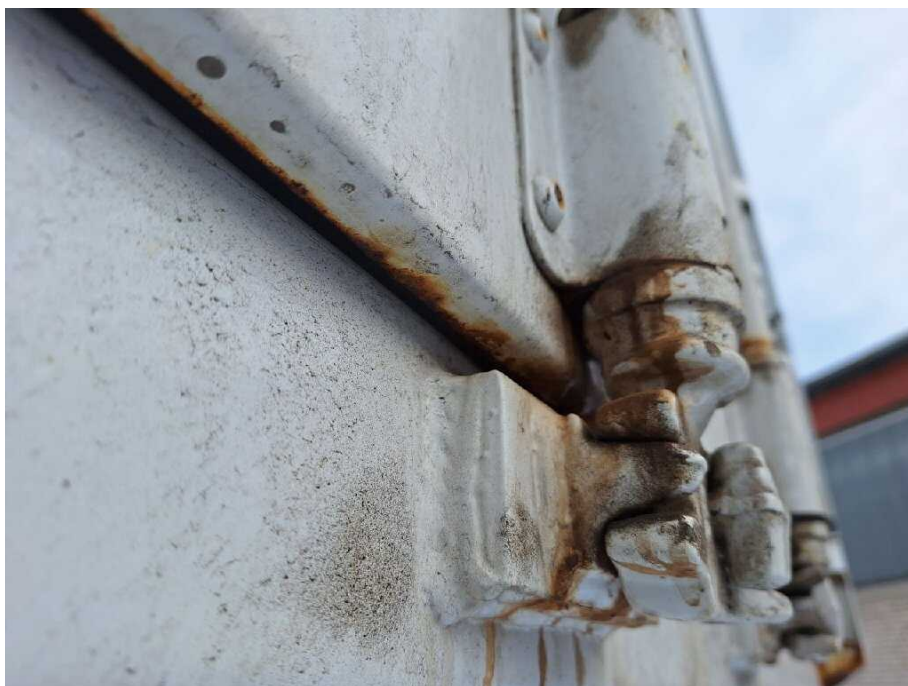
Bild 17 Fahrzeugheck Heckflügeltür links korrodiert
