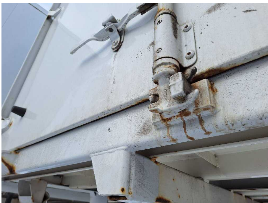
Bild 16 Fahrzeugheck Heckflügeltür links korrodiert
