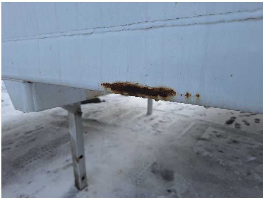
Bild 19 Fahrzeugfront Fahrzeugrahmen korrodiert
