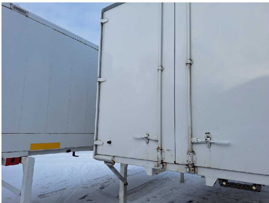
Bild 15 Fahrzeugheck Heckflügeltür links korrodiert
