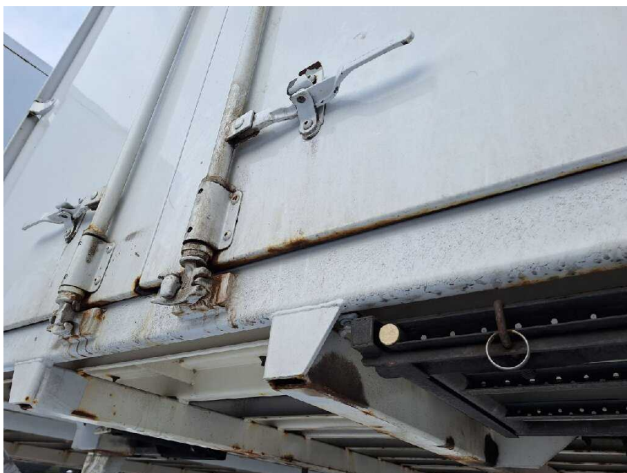
Bild 14 Fahrzeugheck Heckflügeltür rechts korrodiert
