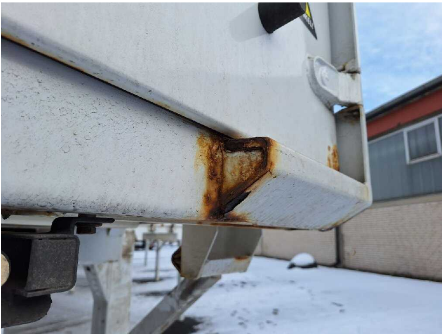
Bild 10 Fahrzeugfront Fahrzeugrahmen korrodiert
