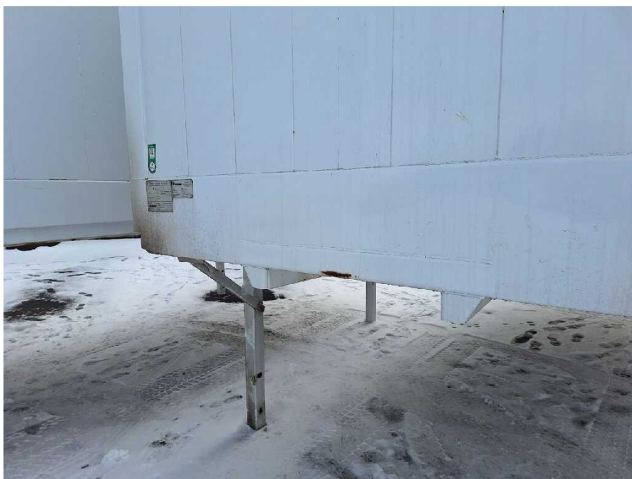
Bild 18 Fahrzeugfront Fahrzeugrahmen korrodiert
