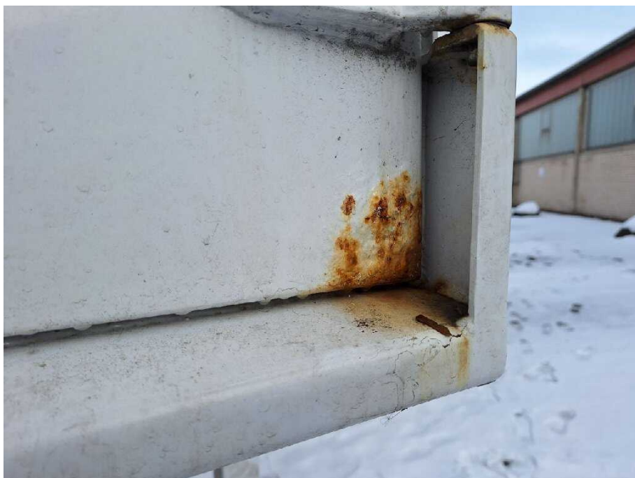
Bild 13 Fahrzeugheck Heckflügeltür rechts korrodiert
