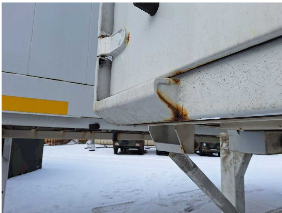
Bild 11 Fahrzeugfront Fahrzeugrahmen korrodiert
