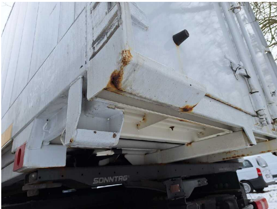
Bild 17 Fahrzeugfront Fahrzeugrahmen beschädigt
