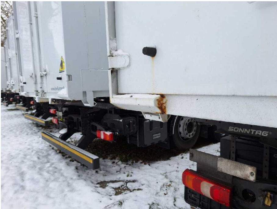
Bild 16 Fahrzeugfront Fahrzeugrahmen beschädigt
