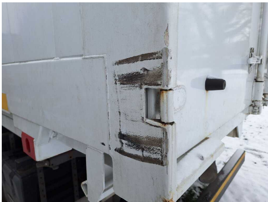
Bild 20 Fahrzeugfront Fahrzeugrahmen beschädigt
