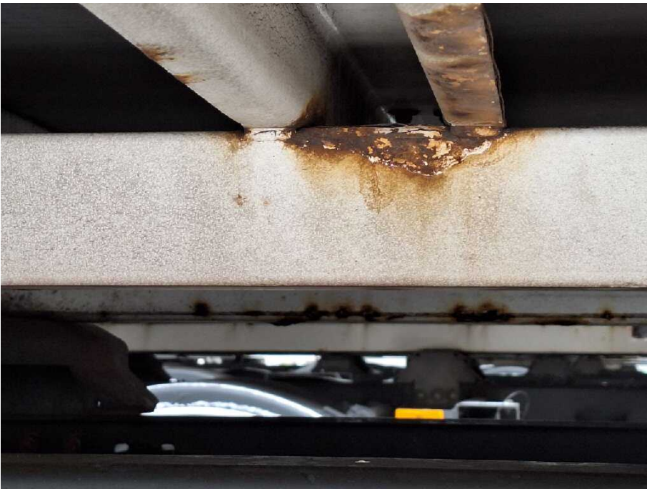
Bild 10 Fahrzeugheck Rahmen hinten korrodiert
