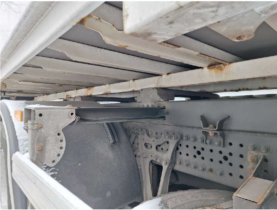
Bild 9 Fahrzeugheck Rahmen hinten korrodiert
