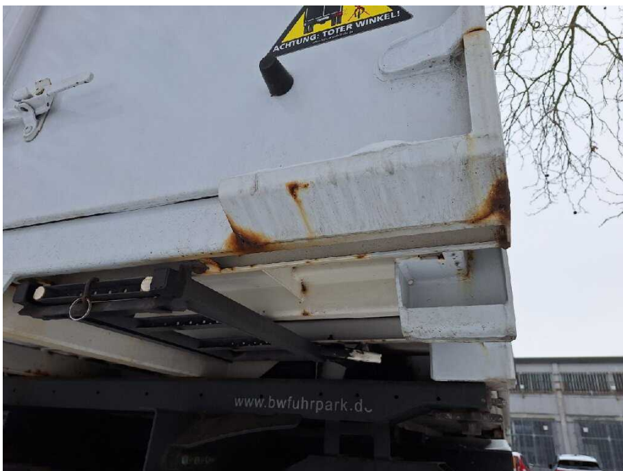
Bild 18 Fahrzeugfront Fahrzeugrahmen beschädigt
