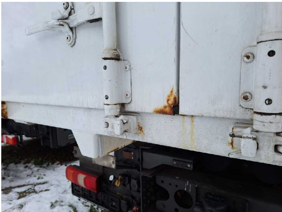
Bild 13 Fahrzeugheck Heckflügeltür links korrodiert
