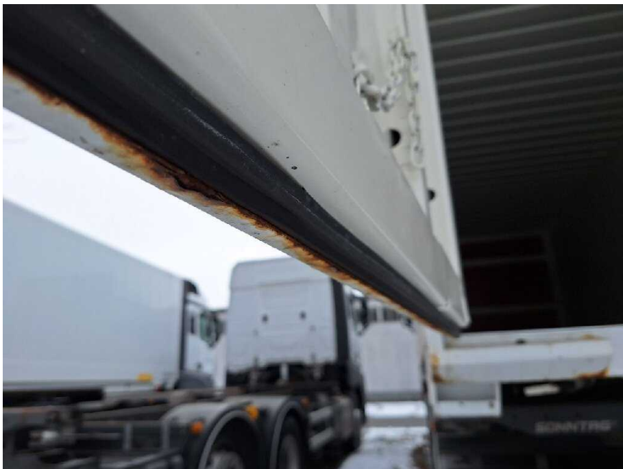
Bild 21 Fahrzeugheck Heckflügeltür links korrodiert
