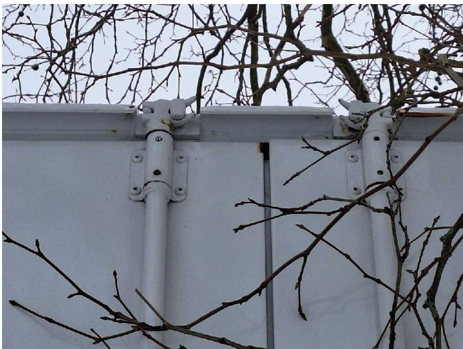
Bild 14 Fahrzeugheck Heckflügeltür links korrodiert
