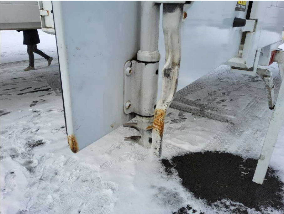
Bild 22 Fahrzeugheck Tür hinten rechts korrodiert
