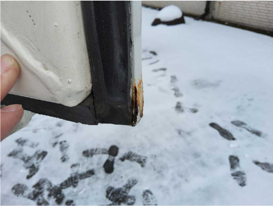
Bild 23 Fahrzeugheck Tür hinten rechts korrodiert
