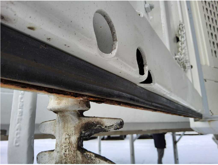
Bild 21 linke Seite Tür hinten links korrodiert
