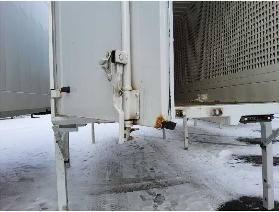
Bild 19 linke Seite Tür hinten links korrodiert
