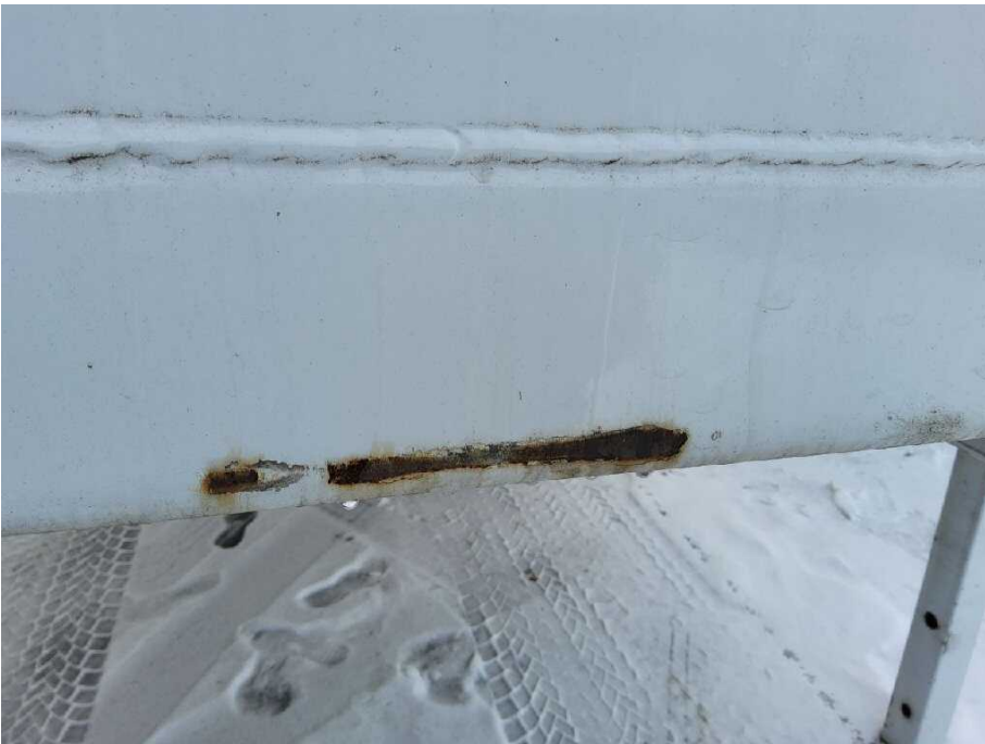
Bild 10 Fahrzeug sonstige Karosserieteile korrodiert
