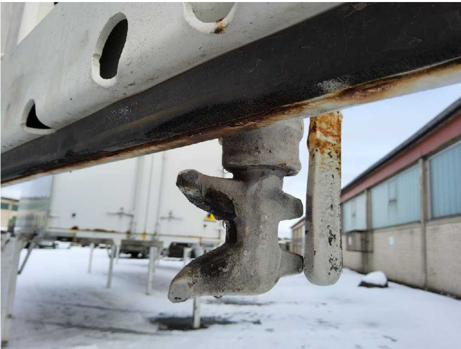
Bild 24 Fahrzeugheck Tür hinten rechts korrodiert
