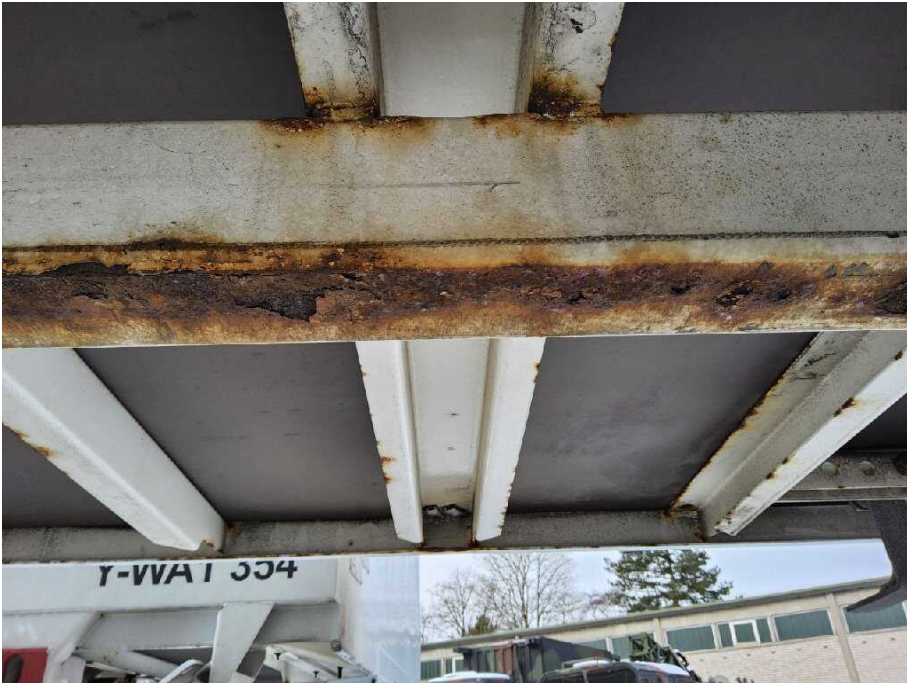
Bild 13 Aufbau Bodenrahmen hinten korrodiert
