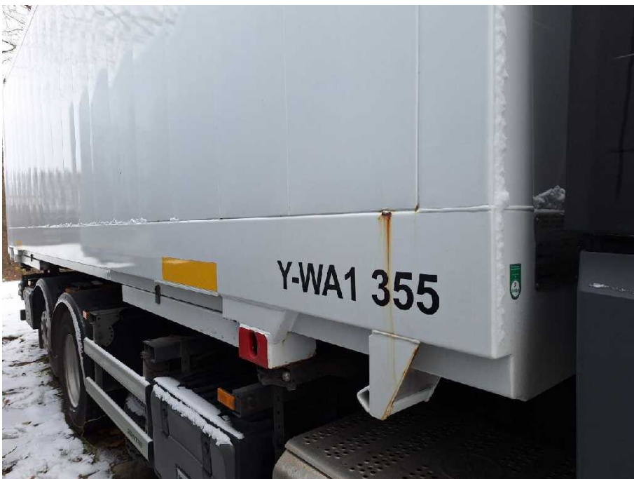
Bild 10 Fahrzeugfront Fahrzeugrahmen korrodiert
