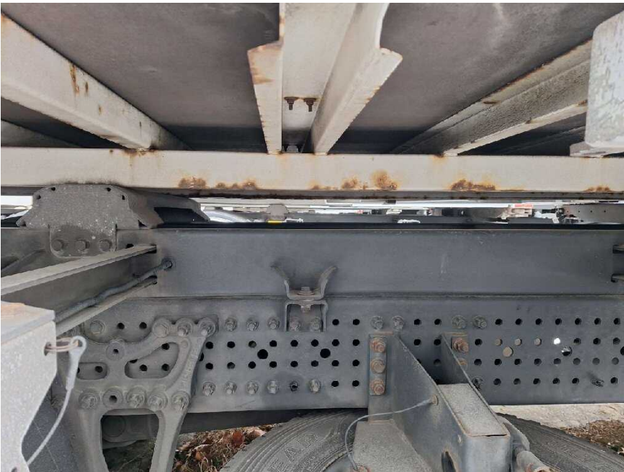
Bild 15 Aufbau Bodenrahmen hinten korrodiert
