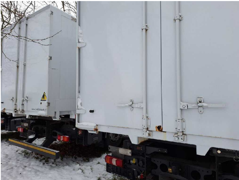
Bild 19 Fahrzeugheck Heckflügeltür links stark korrodiert
