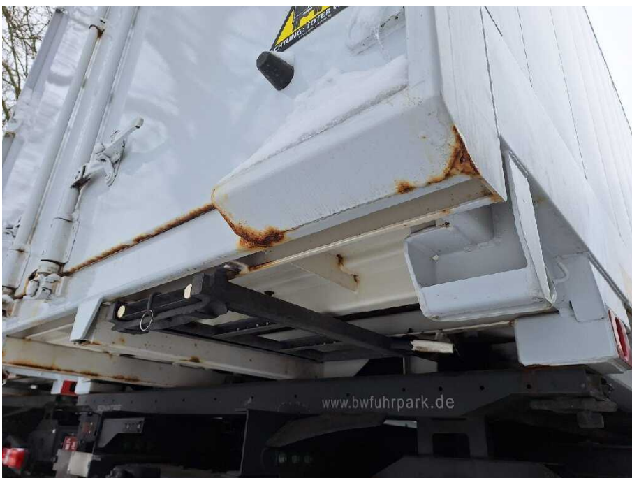
Bild 22 Fahrzeugfront Fahrzeugrahmen korrodiert
