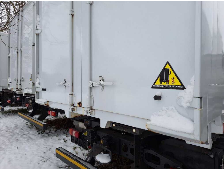
Bild 23 Fahrzeugheck Heckflügeltür rechts korrodiert
