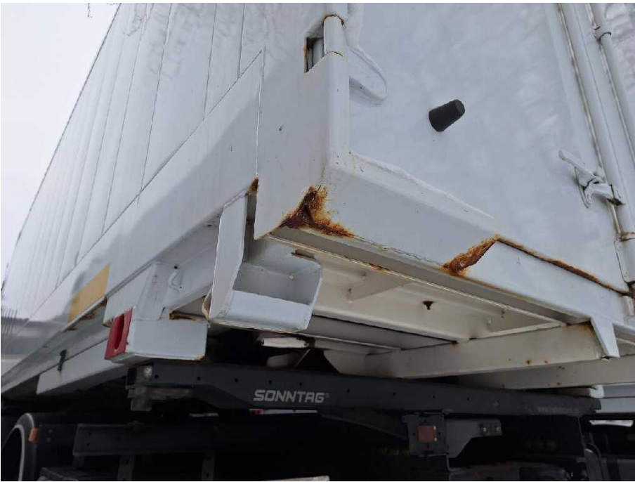
Bild 25 Fahrzeugfront Fahrzeugrahmen korrodiert
