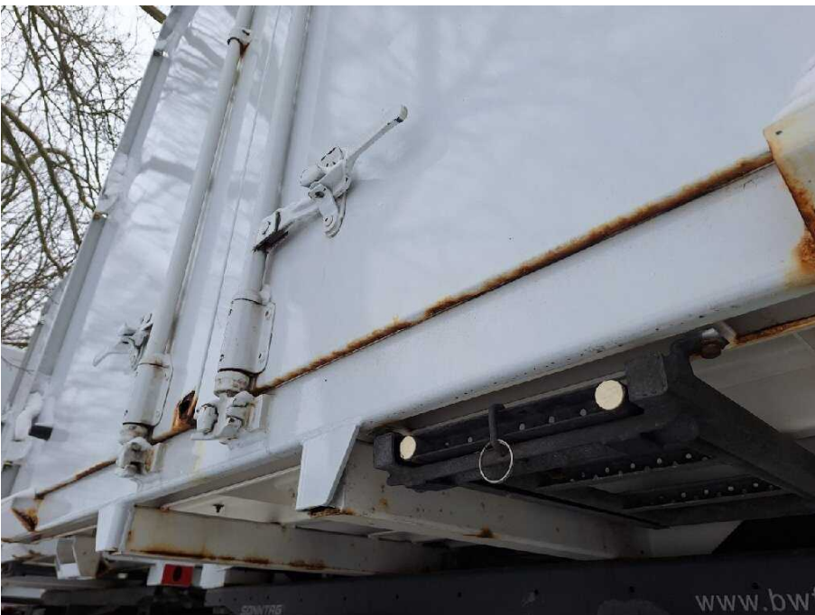
Bild 24 Fahrzeugheck Heckflügeltür rechts korrodiert
