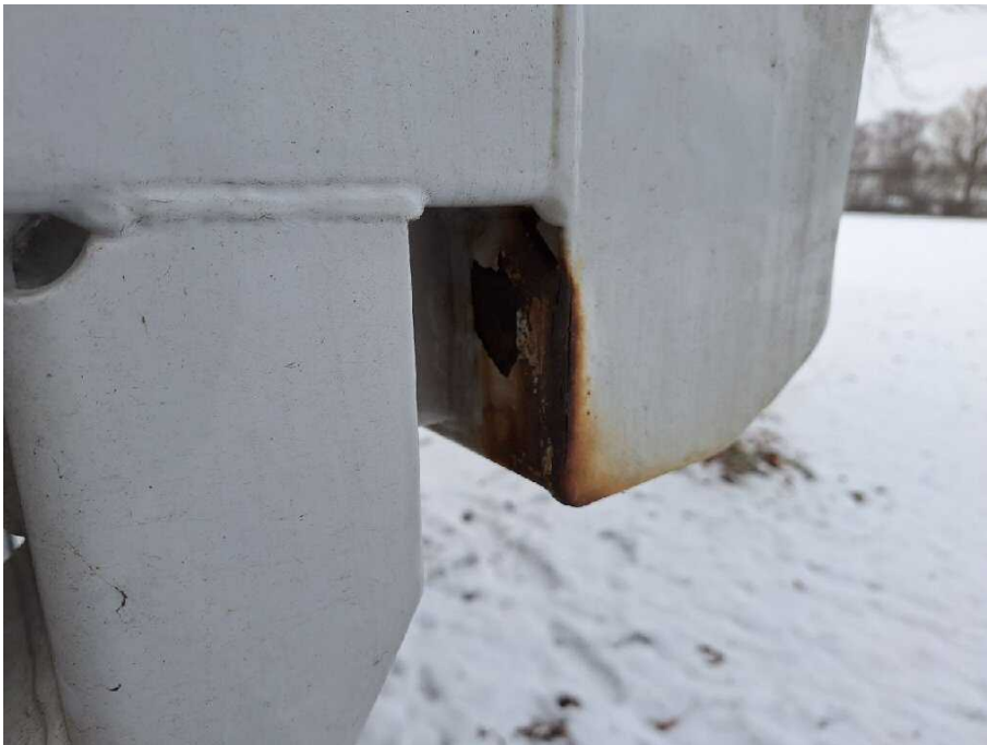
Bild 17 Fahrzeugfront Fahrzeugrahmen korrodiert
