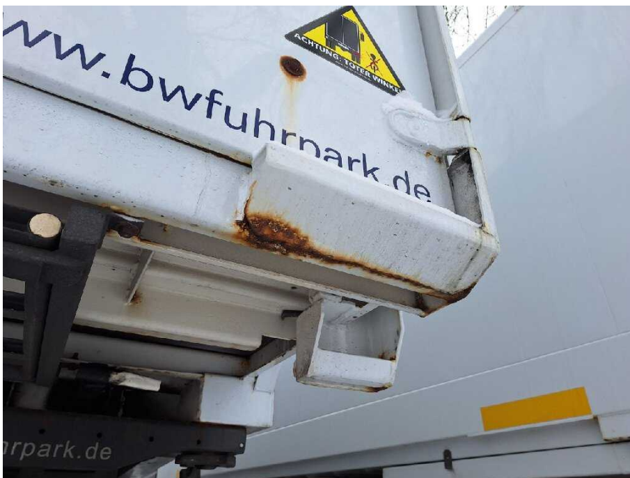
Bild 18 Fahrzeugfront Fahrzeugrahmen korrodiert
