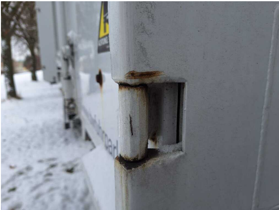
Bild 19 Fahrzeugfront Fahrzeugrahmen korrodiert
