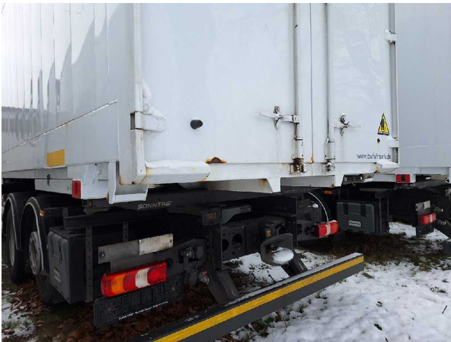
Bild 15 Fahrzeugfront Fahrzeugrahmen korrodiert
