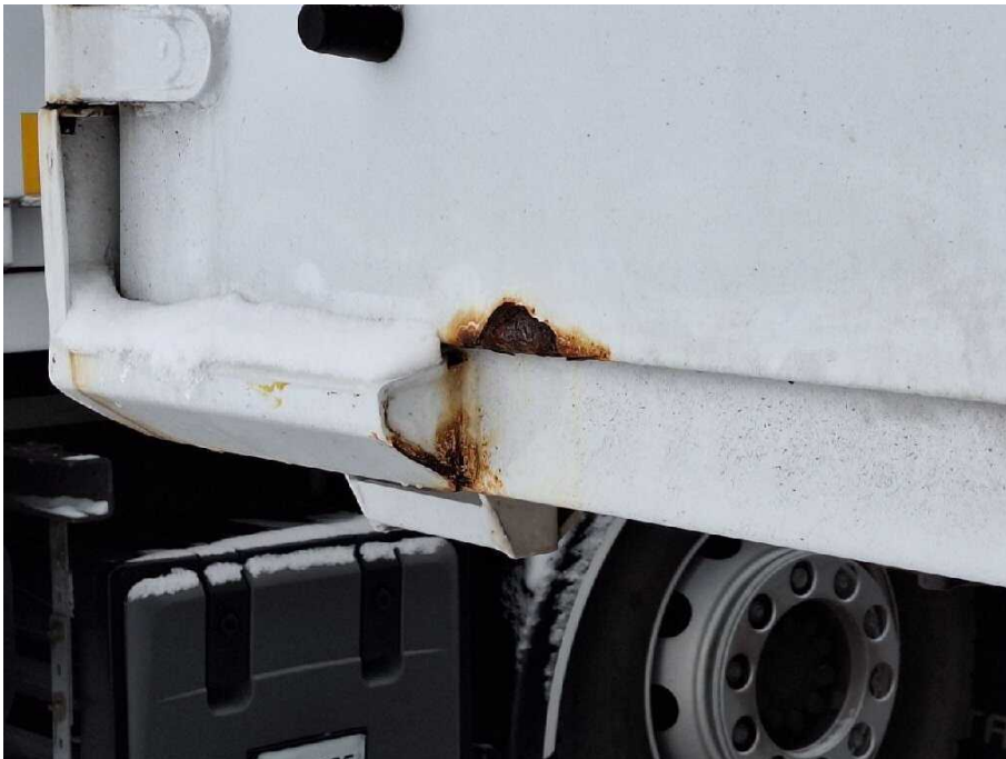
Bild 13 Fahrzeugheck Heckflügeltür links stark korrodiert
