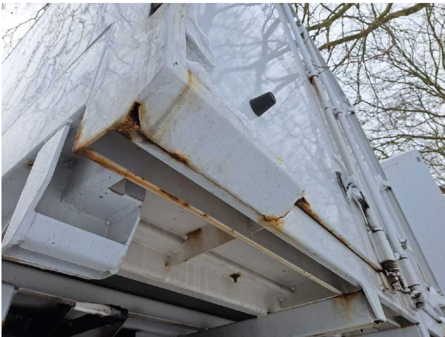
Bild 16 Fahrzeugfront Fahrzeugrahmen korrodiert
