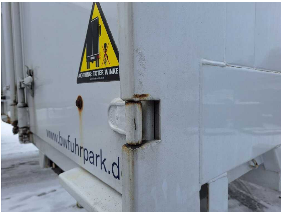
Bild 25 Fahrzeugfront Fahrzeugrahmen korrodiert
