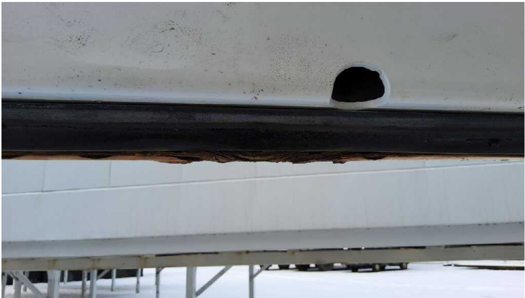
Bild 21 Fahrzeugheck Heckflügeltür links stark korrodiert
