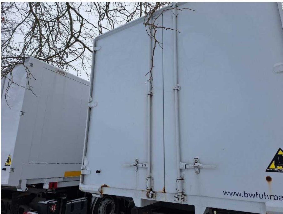
Bild 11 Fahrzeugheck Heckflügeltür links stark korrodiert
