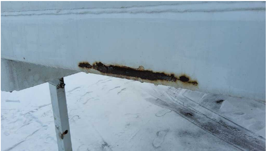
Bild 23 Fahrzeugfront Fahrzeugrahmen korrodiert
