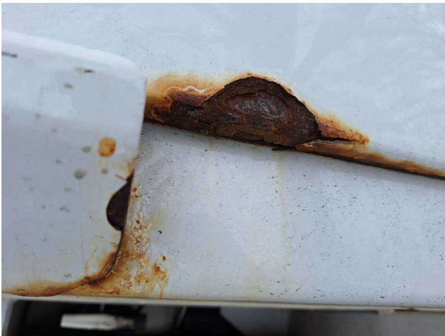
Bild 14 Fahrzeugheck Heckflügeltür links stark korrodiert
