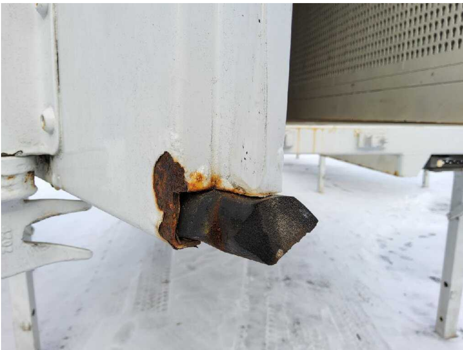
Bild 10 linke Seite Tür hinten links korrodiert
