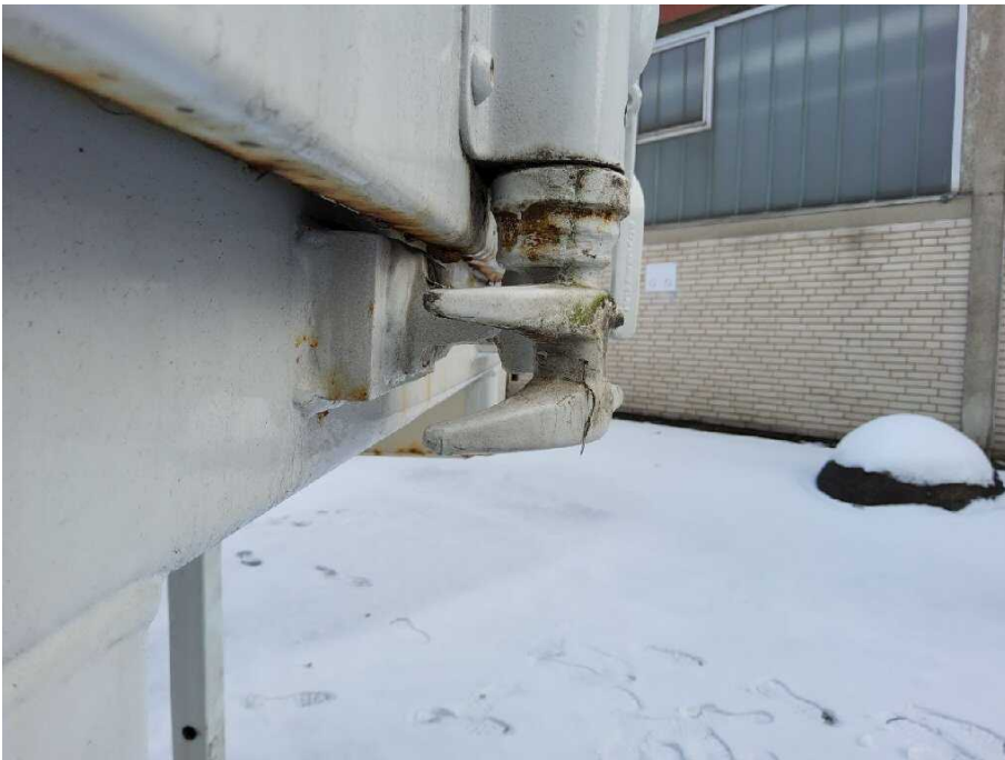
Bild 12 linke Seite Tür hinten links falsche Passgenauigkeit
