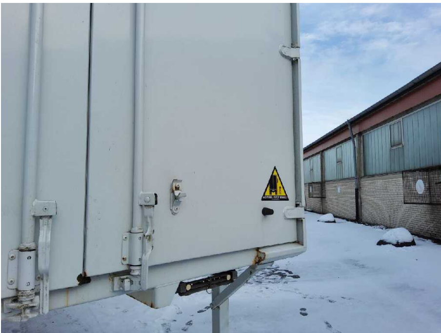
Bild 26 rechte Seite Tür hinten rechts korrodiert
