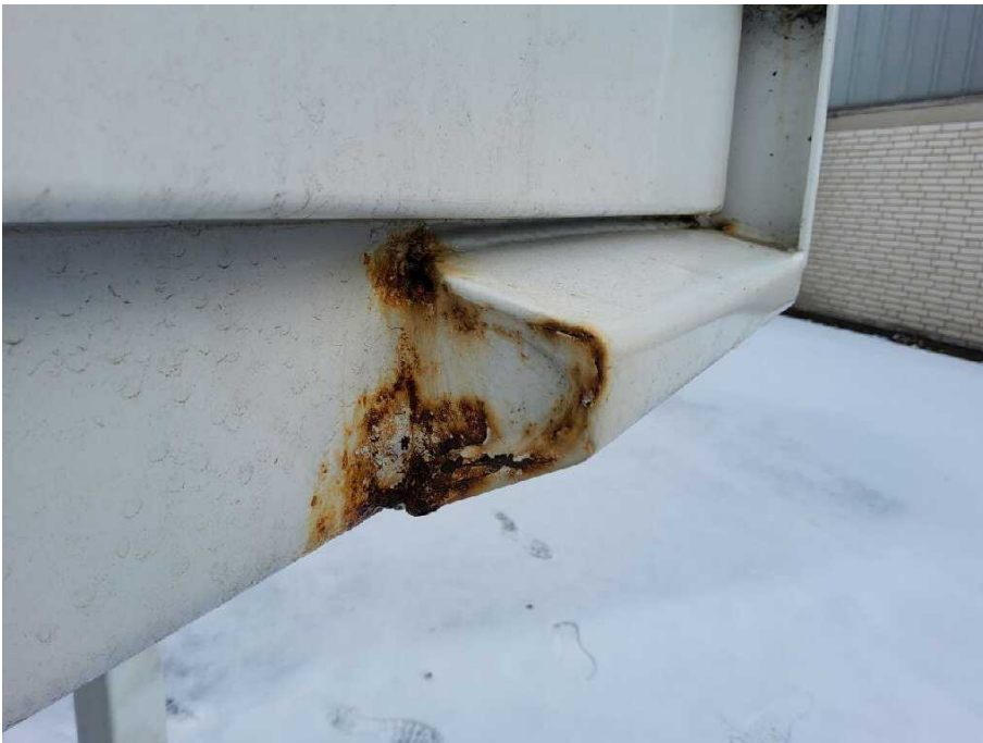
Bild 15 Fahrzeugfront Fahrzeugrahmen korrodiert
