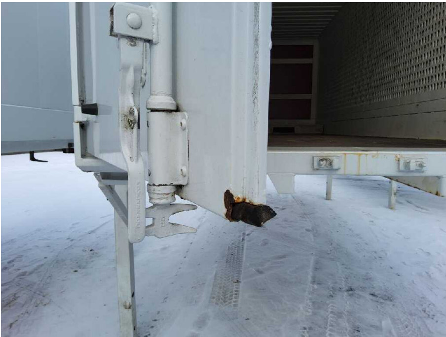
Bild 9 linke Seite Tür hinten links korrodiert
