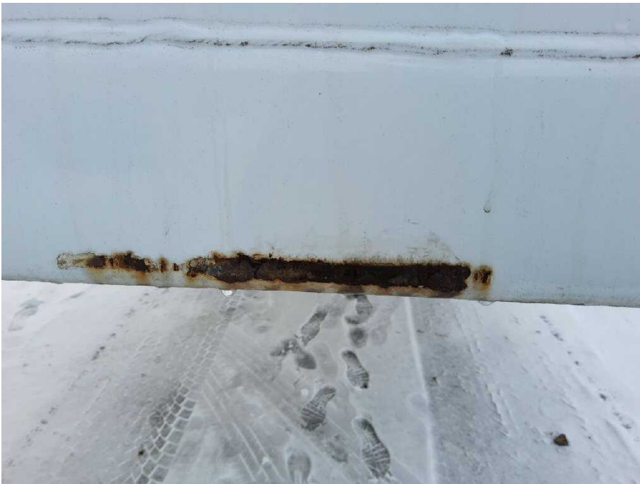
Bild 25 Fahrzeug sonstige Karosserieteile korrodiert
