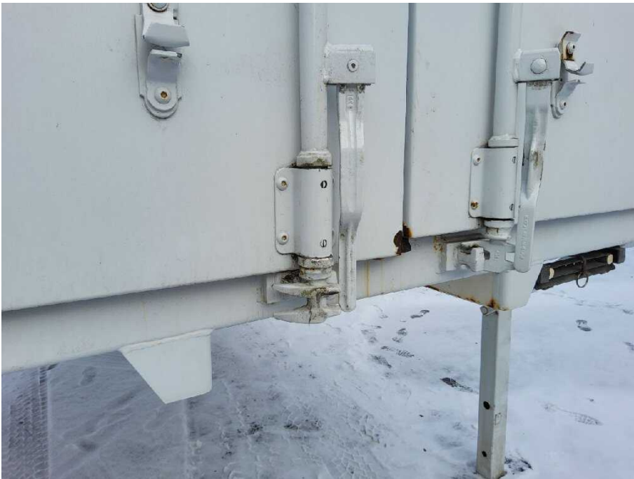
Bild 13 linke Seite Tür hinten links falsche Passgenauigkeit
