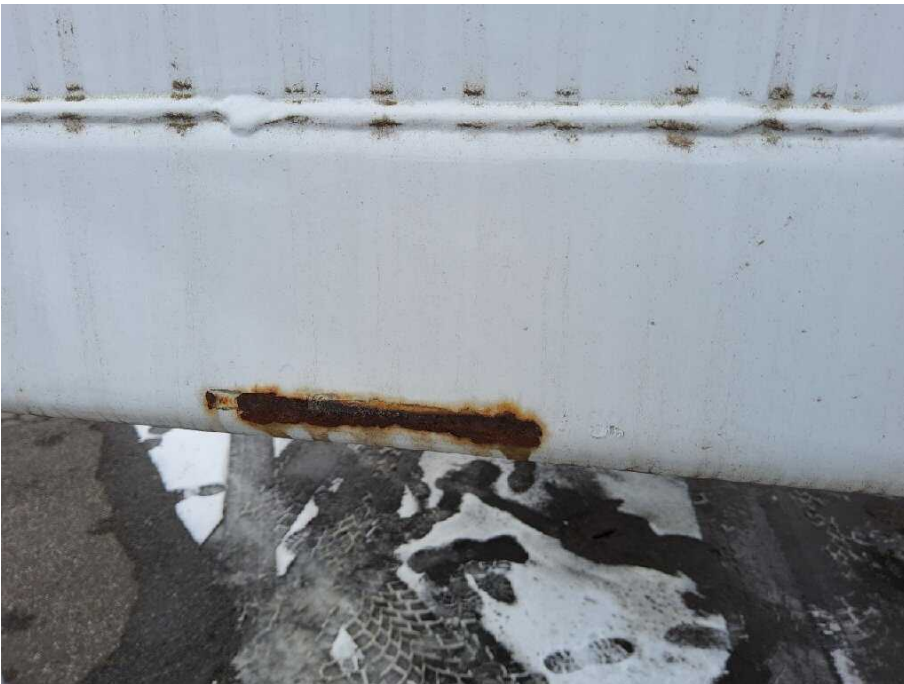
Bild 10 Fahrzeug sonstige Karosserieteile korrodiert
