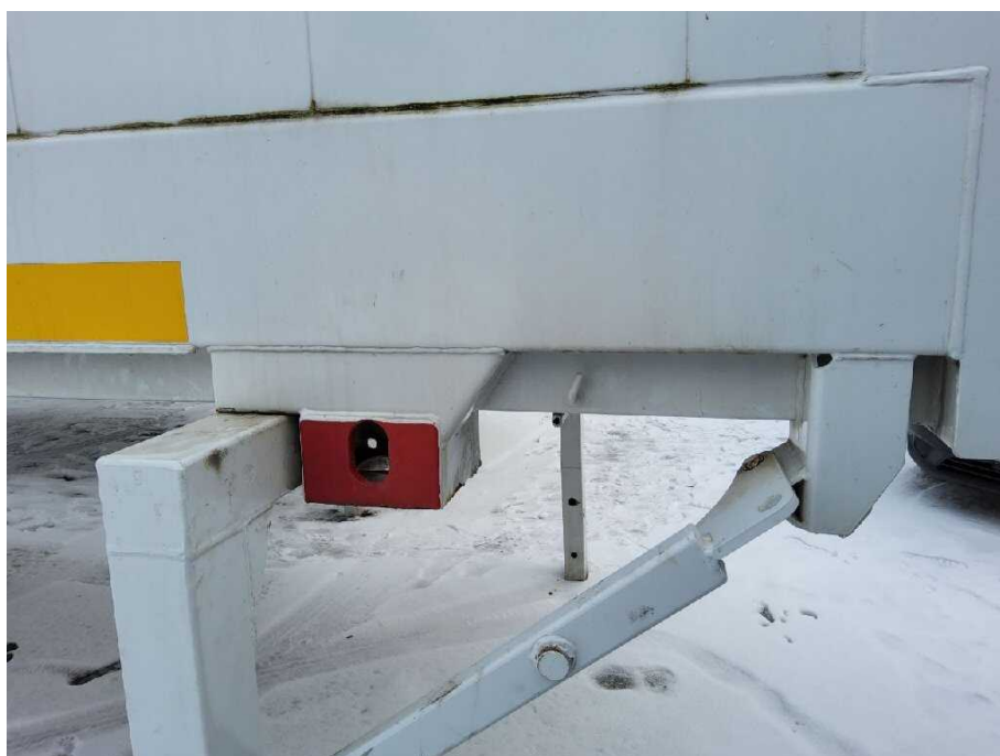
Bild 14 Aufbau Containerverriegelung korrodiert
