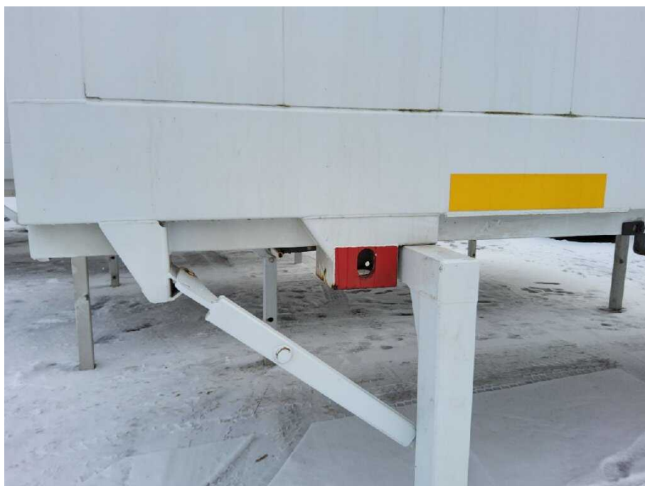
Bild 13 Aufbau Containerverriegelung korrodiert
