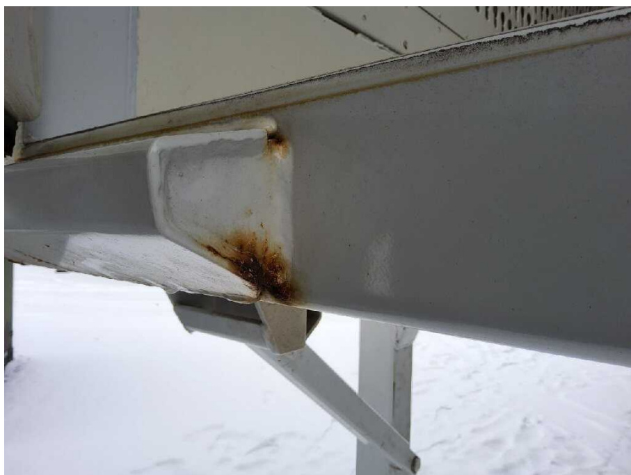
Bild 29 Fahrzeugfront Fahrzeugrahmen korrodiert
