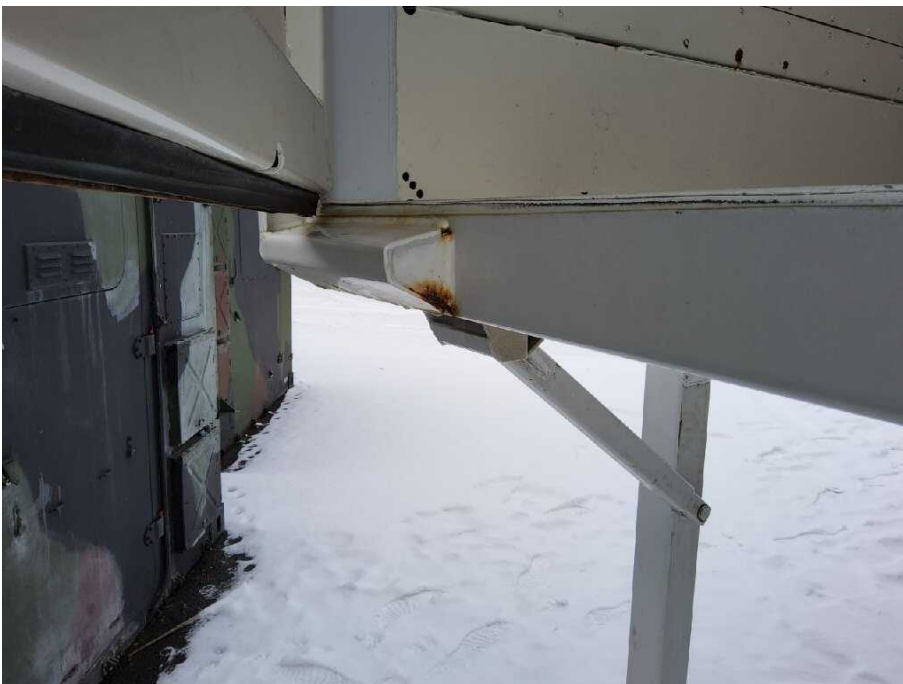
Bild 28 Fahrzeugfront Fahrzeugrahmen korrodiert
