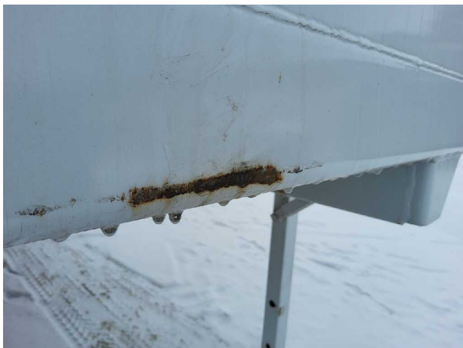
Bild 11 Fahrzeug sonstige Karosserieteile korrodiert
