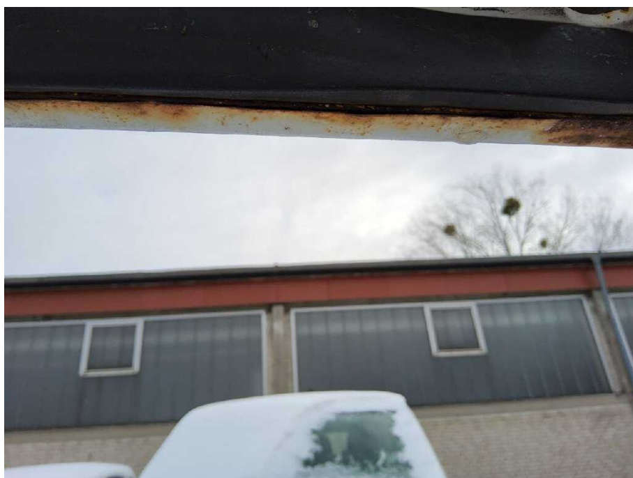
Bild 32 Fahrzeugheck Tür hinten rechts korrodiert
