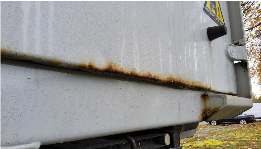
Bild 10 Fahrzeugheck Heckflügeltür rechts stark korrodiert
