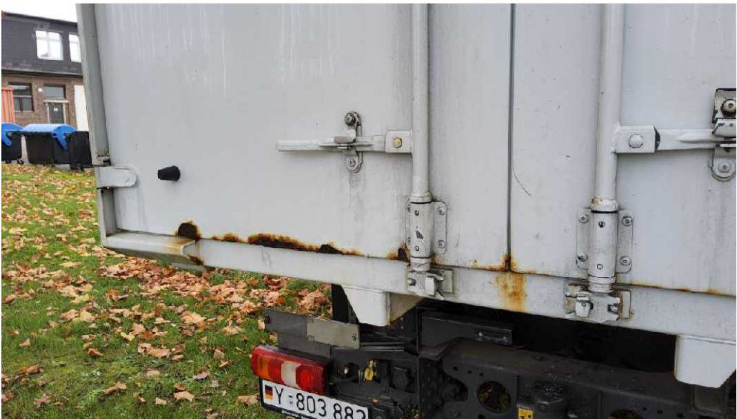
Bild 11 Fahrzeugheck Heckflügeltür rechts stark korrodiert
