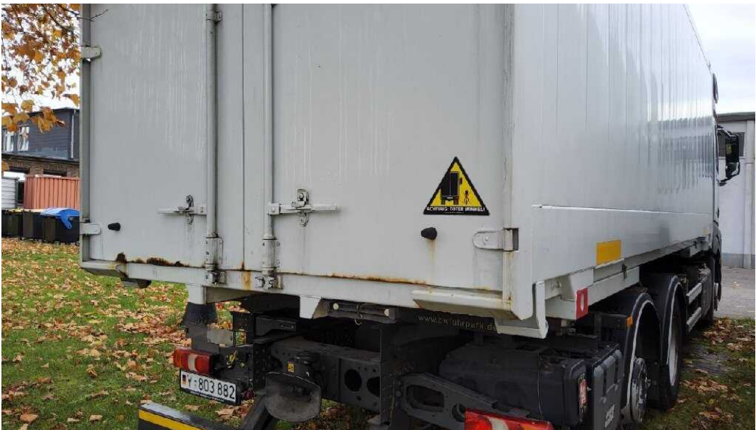
Bild 9 Fahrzeugheck Heckflügeltür rechts stark korrodiert
