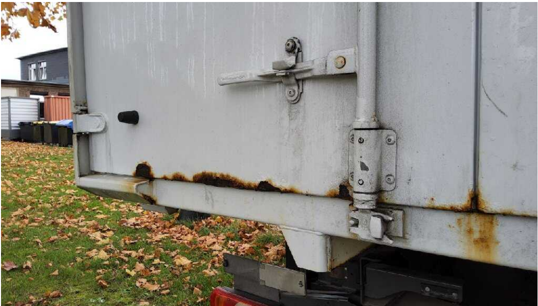
Bild 12 Fahrzeugheck Heckflügeltür rechts stark korrodiert
