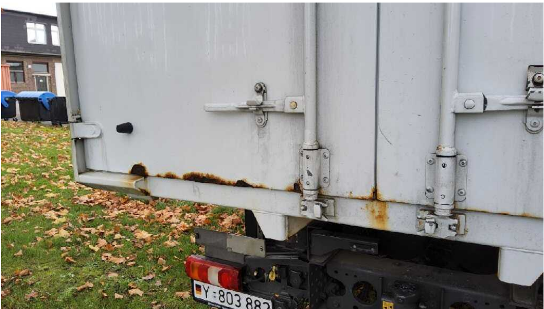
Bild 13 Fahrzeugheck Heckflügeltür links stark korrodiert
