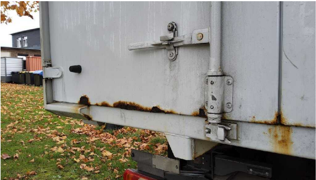
Bild 14 Fahrzeugheck Heckflügeltür links stark korrodiert
