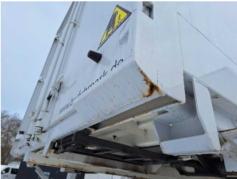
Bild 23 Fahrzeugfront Fahrzeugrahmen korrodiert
