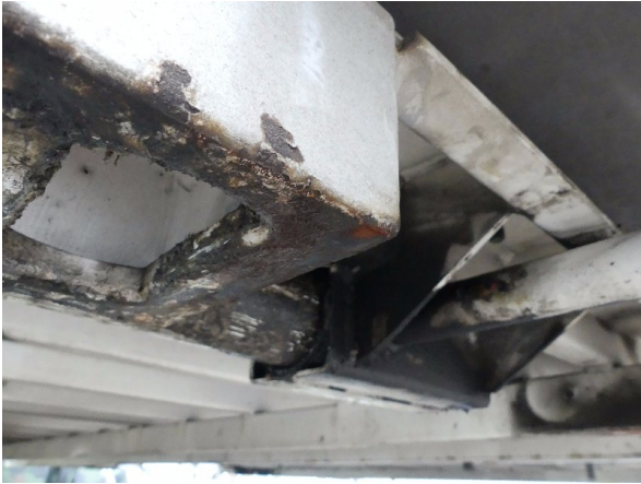
Bild 33: Karosserie Delle / Kratzer / Abschürfung- ohne Reparatur
