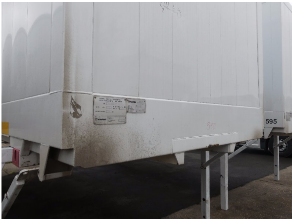
Bild 12: Frontwand Korrosion - instandsetzen und lackieren
