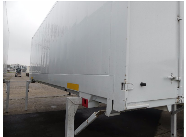
Bild 16: Abdichtung Seitenwand beschädigt - erneuern
