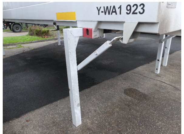
Bild 38: Karosserie Delle / Kratzer / Abschürfung- ohne Reparatur
