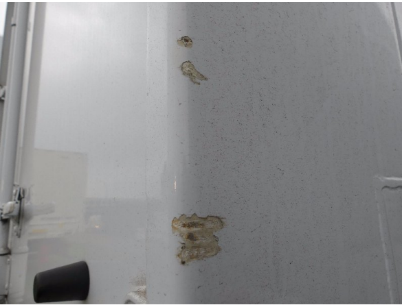
Bild 19: Eckbeplankung rechts Korrosion - instandsetzen und lackieren
