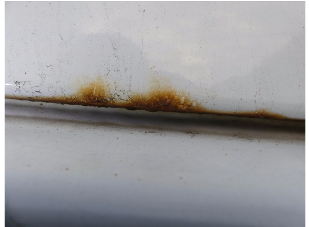
Bild 26: Tür rechts Korrosion - instandsetzen und lackieren
