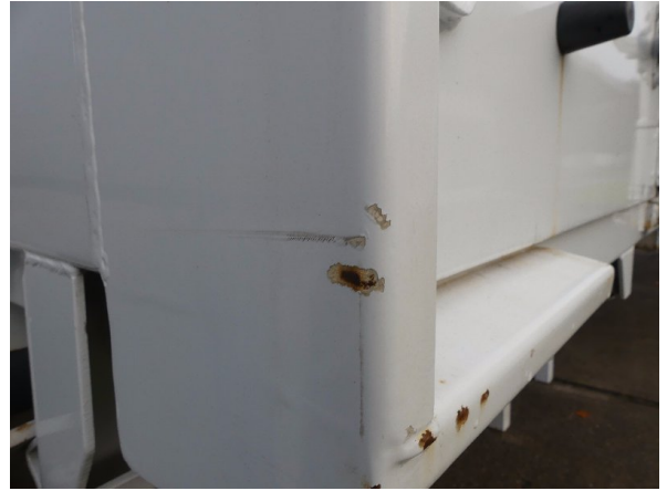
Bild 30: Eckbeplankung links Korrosion - instandsetzen und lackieren
