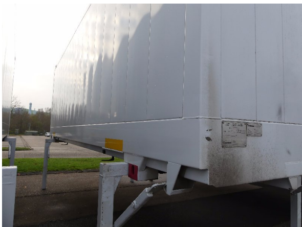
Bild 17: Abdichtung Seitenwand links und rechts beschädigt - erneuern
