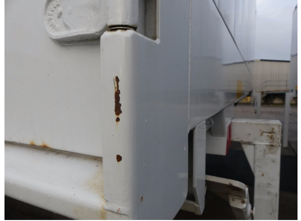
Bild 24: Eckbeplankung rechts Korrosion - instandsetzen und lackieren
