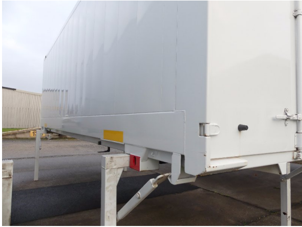
Bild 19: Abdichtung Seitenwand links und rechts beschädigt - erneuern
