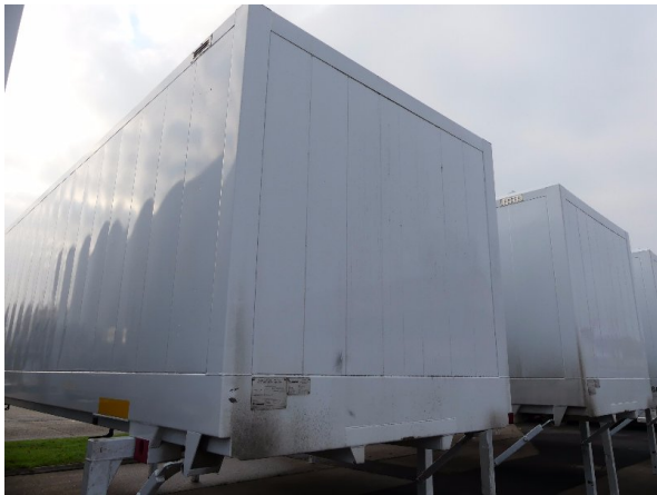
Bild 15: Frontwand Korrosion - instandsetzen und lackieren
