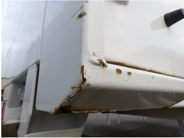
Bild 29: Eckbeplankung links Korrosion - instandsetzen und lackieren
