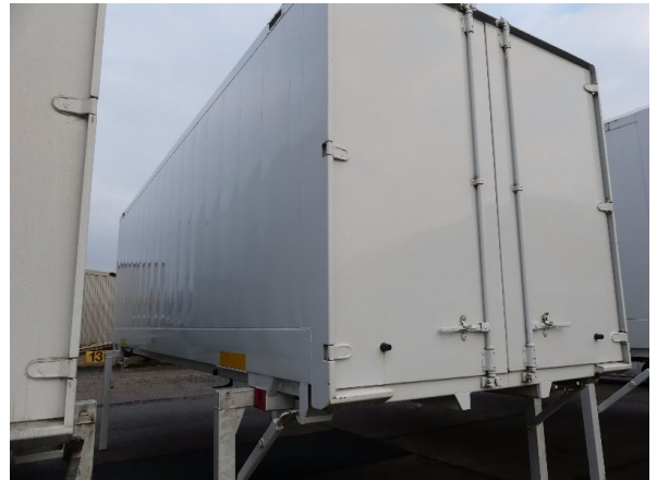
Bild 28: Eckbeplankung links Korrosion - instandsetzen und lackieren
