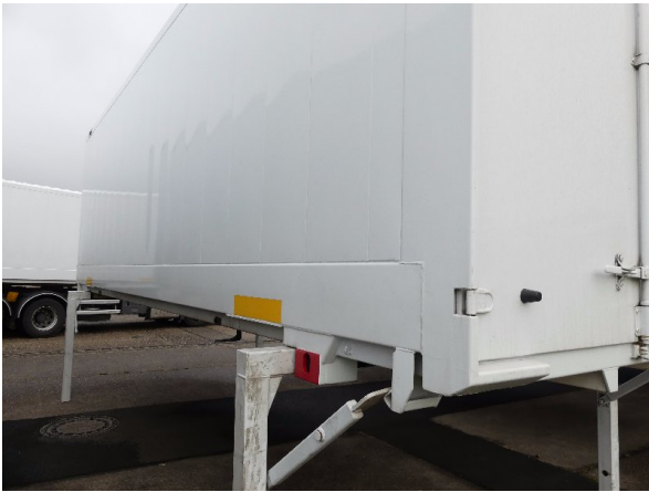
Bild 16: Abdichtung links und rechts beschädigt - erneuern
