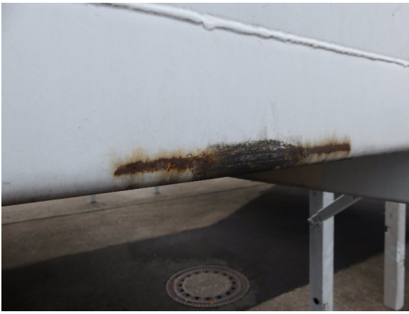
Bild 13: Frontwand Korrosion - instandsetzen und lackieren
