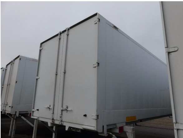
Bild 18: Eckbeplankung rechts Korrosion - instandsetzen und lackieren
