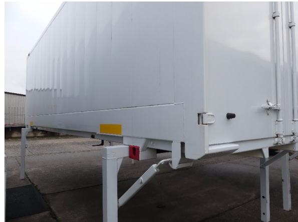
Bild 16: Abdichtung Seitenwand links und rechts beschädigt - erneuern
