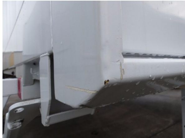
Bild 22: Eckbeplankung unterhalb links Korrosion - instandsetzen und lackieren
