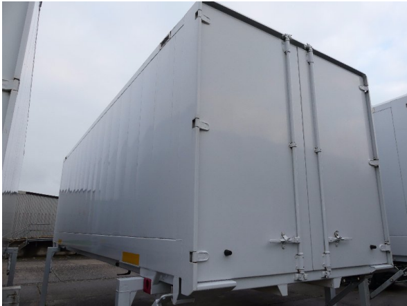
Bild 21: Eckbeplankung unterhalb links Korrosion - instandsetzen und lackieren
