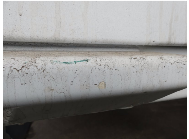
Bild 20: Eckbeplankung unterhalb links Korrosion - instandsetzen und lackieren
