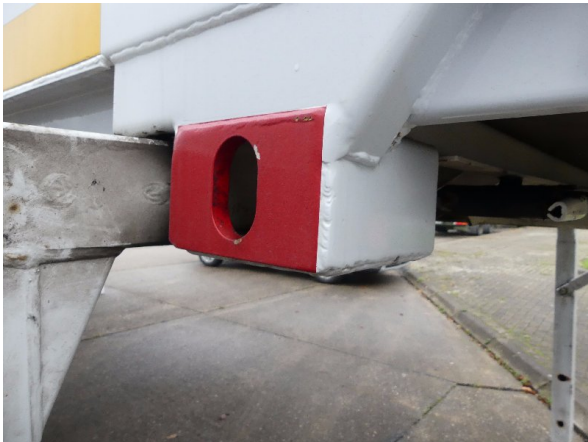
Bild 35: Karosserie Delle / Kratzer / Abschürfung ohne Reparatur
