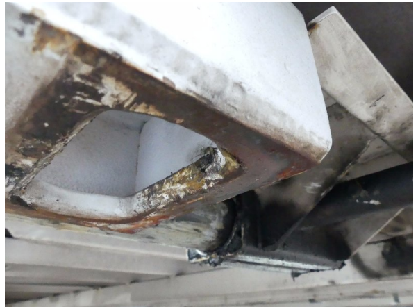
Bild 32: Karosserie Delle / Kratzer / Abschürfung ohne Reparatur
