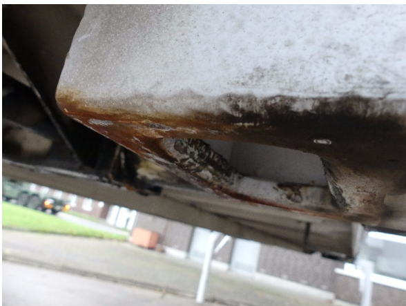
Bild 37: Karosserie Delle / Kratzer / Abschürfung ohne Reparatur
