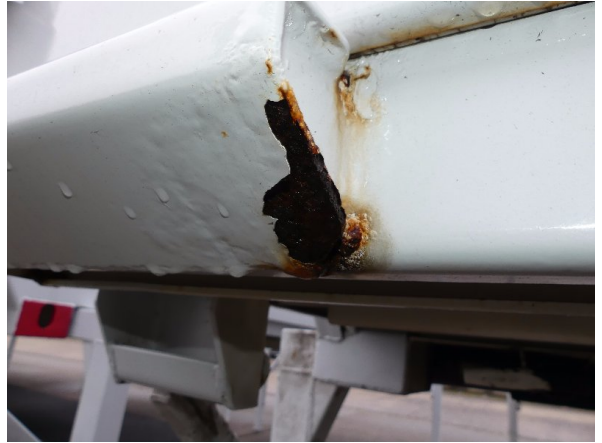
Bild 24: Eckbeplankung unterhalb links Korrosion - instandsetzen und lackieren
