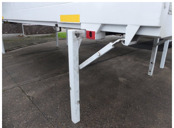
Bild 28: Karosserie Delle / Kratzer / Abschürfung - ohne Reparatur
