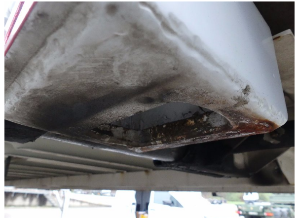
Bild 36: Karosserie Delle / Kratzer / Abschürfung ohne Reparatur
