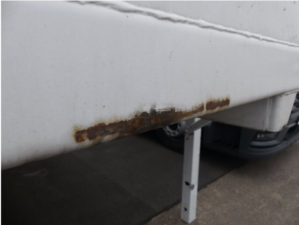
Bild 13: Frontwand Korrosion - instandsetzen und lackieren
