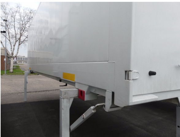
Bild 17: Abdichtung links und rechts beschädigt - erneuern
