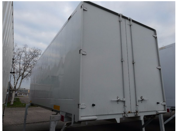
Bild 26: Eckbeplankung unterhalb links Korrosion - instandsetzen und lackieren
