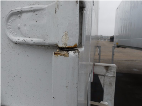
Bild 21: Eckbeplankung rechts Korrosion - instandsetzen und lackieren
