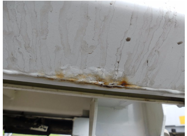
Bild 22: Eckbeplankung rechts Korrosion - instandsetzen und lackieren
