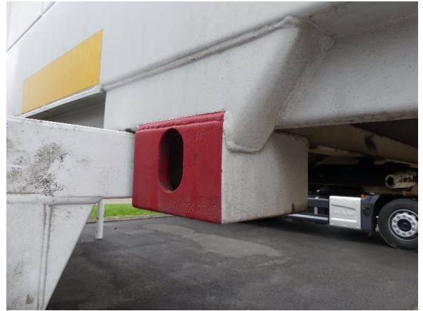
Bild 34: Karosserie Delle / Kratzer / Abschürfung- ohne Reparatur
