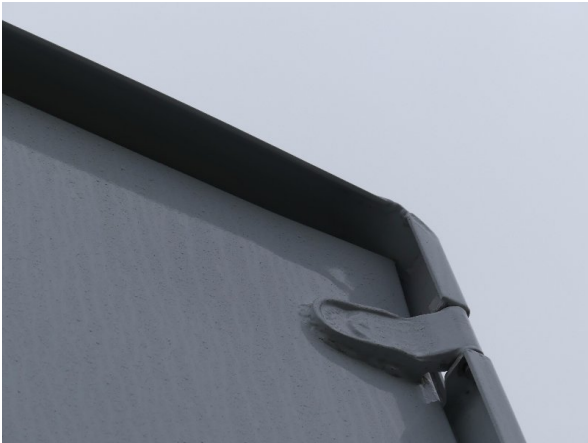
Bild 19: Hecktür rechts verformt - instandsetzen und lackieren
