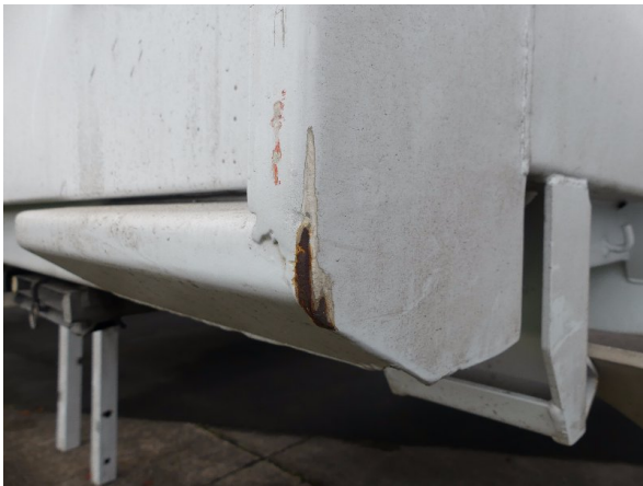
Bild 21: Eckbeplankung unterhalb rechts Korrosion - instandsetzen und lackieren
