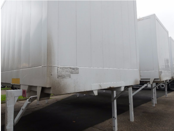
Bild 15: Frontwand Korrosion - instandsetzen und lackieren
