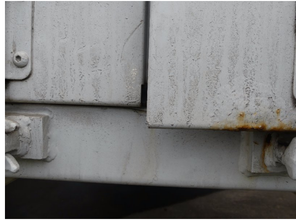
Bild 14: Hecktür rechts Korrosion / schließt nicht - instandsetzen und lackieren
