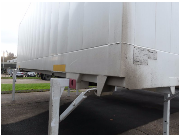
Bild 17: Abdichtung links und rechts beschädigt - erneuern
