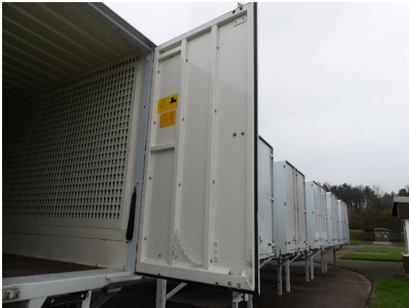
Bild 12: Hecktür rechts Korrosion / schließt nicht - instandsetzen und lackieren
