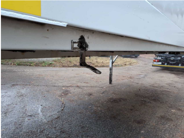
Beschädigung 1: Sonstiges: Sonstiges (Halter Stützfuß HR) - verformt - instandsetzen
