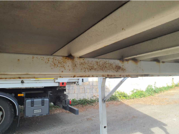
Beschädigung 1: Aufbau: Aufbau - Korrosion - instandsetzen und lackieren
