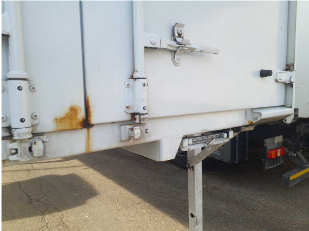
Beschädigung 1: Aufbau: Aufbau - Korrosion - instandsetzen und lackieren
